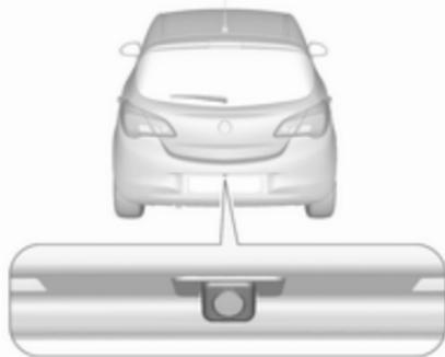
La caméra est montée entre les lampes d'éclairage de la plaque d'immatriculation et a un angle de vision de 130°.
