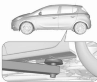
Position du bras arrière du pont élévateur centralisée sous le creux du seuil.
