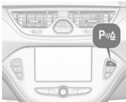
Une LED allumée dans le bouton de l'aide au stationnement **P**▲ indique que le système est prêt à fonctionner. Si **P**▲ est éteint pendant un cycle d'allumage, l'aide au stationnement avant est désactivée. Si la vitesse du véhicule a dépassé 25 km/h auparavant, l'aide au stationnement est réactivée lorsque la vitesse repasse en dessous de 11 km/h.
