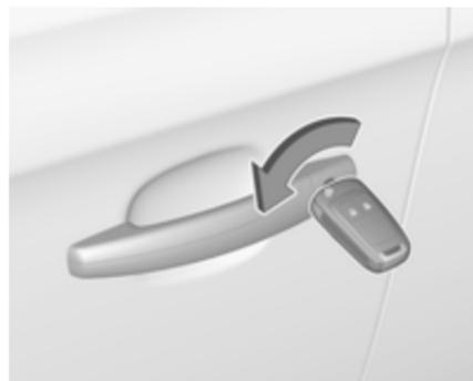
Déverrouiller manuellement la porte du conducteur en tournant la clé dans la serrure. Mettre le contact et appuyer sur le bouton de verrouillage central
