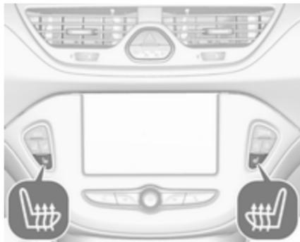
Activer le chauffage du siège en appuyant sur
