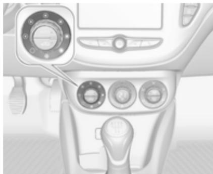
Tourner le bouton rotatif gauche pour réduire ou augmenter la vitesse de soufflerie. La vitesse de soufflerie est indiquée dans l'affichage d'informations.
