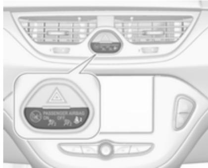
🚗<sup>2</sup> pour le siège passager avant s'allume ou clignote en rouge sur la console centrale quand le siège est occupé.
