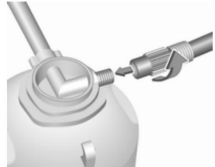
4. Visser le flexible d'air du compresseur sur le raccord sur la bouteille de produit d'étanchéité.
