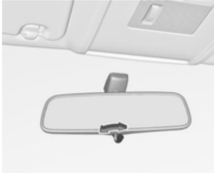
Pour réduire l'éblouissement, ajuster le levier sous le boîtier du rétroviseur.
