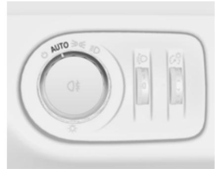
Quand la fonction de commande automatique des feux est activée et que le moteur tourne, le système bascule automatiquement entre les feux de jour et les phares en fonction des conditions d'éclairage et de l'information communiquée par le système de détecteur de pluie.
