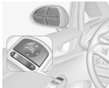
Sélectionner le rétroviseur extérieur souhaité en appuyant sur le commutateur à bascule vers la gauche (**L**) ou la droite (**R**). Puis pivoter la commande
