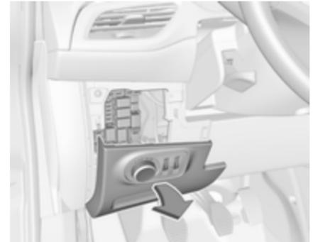
La boîte à fusibles se trouve derrière le commutateur d'éclairage du tableau de bord. Tenir la poignée, puis tirer et rabattre le commutateur d'éclairage.
