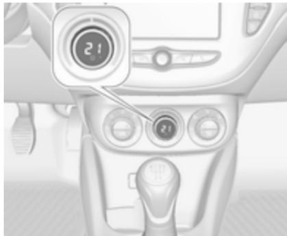
Si la température minimale **Lo** est réglée, le système de commande de climatisation fonctionne à sa capacité maximale de refroidissement, si le refroidissement
