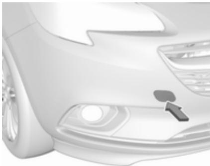
Envelopper d'un linge l'extrémité d'un tournevis plat pour ne pas endommager la peinture. Insérer le tournevis dans la fente sur la partie basse du capuchon. Dégager le capuchon en enfonçant avec précaution le tournevis vers le bas.
