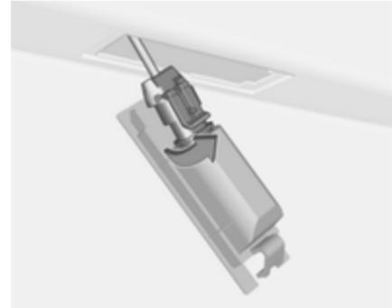
2. Sortir l'ampoule par le bas en veillant à ne pas tirer sur le câble.
