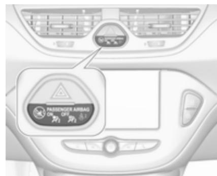
Si le témoin
