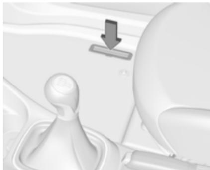
Le numéro d'identification du véhicule est frappé sur la plaque signalétique et sur le plancher, sous le tapis de sol, abrité par un cache.
