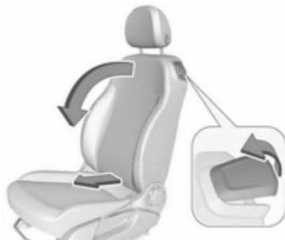
Tirer la poignée de déverrouillage vers l'avant et plier le dossier vers l'avant. Glisser ensuite le siège vers l'avant jusqu'à ce qu'il soit bloqué.
