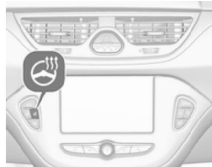
Activer le chauffage en appuyant sur
