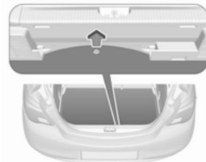
Relever le recouvrement du plancher arrière pour accéder aux équipements de dépannage d'urgence.
