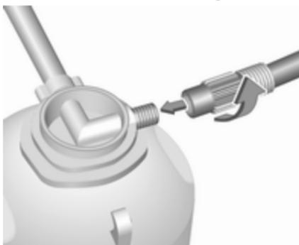
2. Dérouler le flexible d'air du support et le visser sur l'orifice de la bouteille de produit d'étanchéité.
