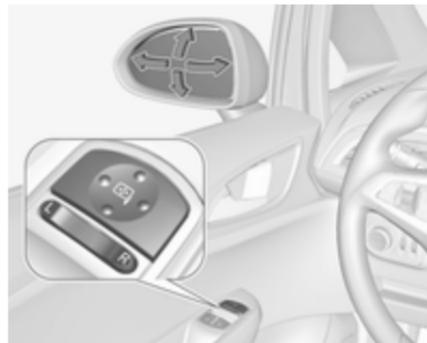
Sélectionner le rétroviseur extérieur concerné avec le commutateur à bascule et régler le rétroviseur avec la commande
