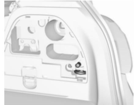
Sur la version GPL, l'outillage et l'œillet de remorquage sont situés sur le côté droit du coffre derrière un cache.
