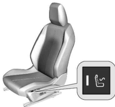
Activer la fonction de massage du dos en appuyant sur
