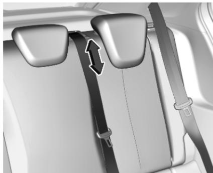
La ceinture de sécurité du siège central pourrait coincée lorsque le dossier est soulevé trop rapidement. Pour débloquer l'enrouleur, rentrer la ceinture de sécurité ou la sortir d'environ 20 mm, puis relâcher.
