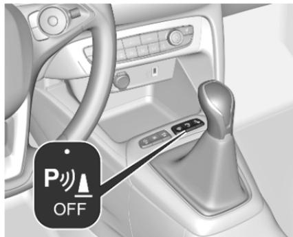
Le système est désactivé lorsque la marche arrière est désengagée. Appuyer sur  $P_{OFF}^{MA}$  pour désactiver manuellement le système. La diode du bouton s'allume lorsque le système est désactivé. Si le système a été désactivé manuellement, il n'est pas réactivé automatiquement lors de la suivante mise du contact du véhicule.
