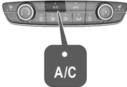
Appuyer sur **A/C** pour mettre le refroidissement en marche. L'activation est signalée par l'éclairage de la LED dans le bouton. Le refroidissement ne fonctionne que lorsque le moteur est en marche et que la soufflerie est allumée.
