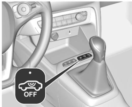
Désactiver la surveillance de l'habitacle quand des animaux sont laissés dans le véhicule en raison de la grande quantité de signaux ultrasoniques ou de leurs mouvements déclenchant l'alarme. Le désactiver également quand le véhicule est à bord d'un ferry ou d'un train.
