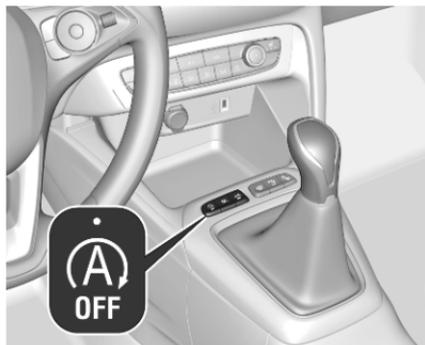
Le système est prêt à fonctionner lorsque la LED du bouton
