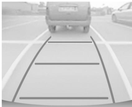
La zone derrière le véhicule est affichée à l'écran. Les lignes verticales représentent la largeur du véhicule
