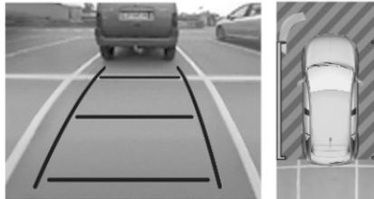
L'écran d'affichage est divisé en deux sections. La droite présente une vue depuis le haut du véhicule et la gauche, une vue depuis l'arrière. Les capteurs de stationnement complètent l'information sur la vue depuis le haut du véhicule.
