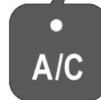
Appuyer sur **A/C** pour mettre le refroidissement en marche. L'activation est signalée par l'éclairage de la LED dans le bouton. Le refroidissement ne fonctionne que lorsque le moteur est
