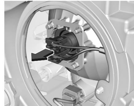
2. Retirer la douille de l'ampoule du boîtier de réflecteur.
