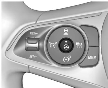
Activer le chauffage en appuyant sur
