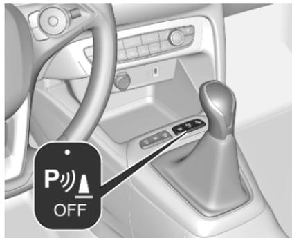
Le système est prêt à fonctionner lorsque la diode du bouton d'aide au stationnement  $P_{OFF}$  est allumée. L'état du système est mémorisé lorsque le contact est coupé.
