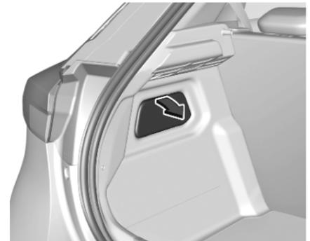
1. Ouvrir le hayon puis déposer le couvercle d'accès du côté correspondant.
