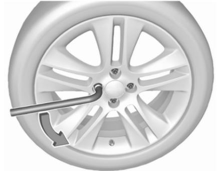
2. Placer la clé de roue et desserrer chaque boulon de roue d'un demi-tour.
