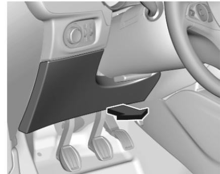
Dans les véhicules avec direction à gauche, la boîte à fusibles se trouve derrière un cache du tableau de bord. Dégager le cache sur le côté inférieur et le déposer.
