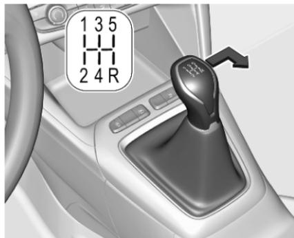
Pour sélectionner la marche arrière d'une boîte de vitesses à 5 rapports, enfoncer la pédale d'embrayage et déplacer le levier sélecteur vers la droite et l'arrière.
