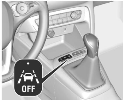
Si le système est activé, la LED intégrée au bouton
