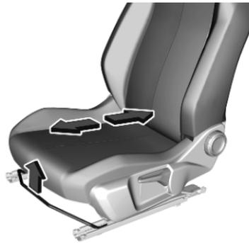
Tirer la poignée, déplacer le siège et relâcher la poignée. Essayer de déplacer le siège vers l'arrière et l'avant pour s'assurer que le siège est verrouillé en place.
