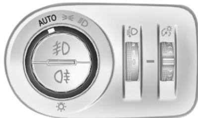
Quand la fonction de commande automatique des feux est activée et que le moteur tourne, le système bascule automatiquement entre les feux de jour et les phares, en fonction des conditions d'éclairage extérieur et des informations communiquées par le système d'essuie-glaces.
