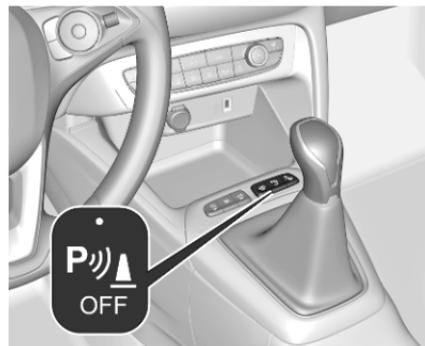
Le système est prêt à fonctionner lorsque la diode du bouton d'aide au stationnement  $P_{OFF}^{MA}$  est allumée. L'état du système est mémorisé lorsque le contact est coupé.
