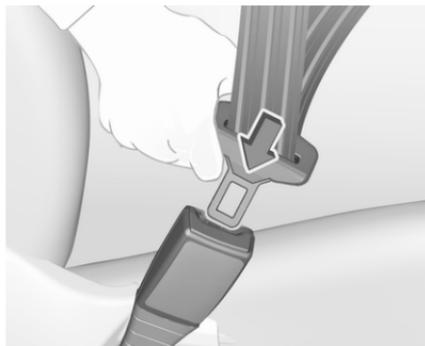
Le port de vêtements larges ou épais gêne la position serrée de la ceinture. Ne pas placer d'objets, comme un sac à main ou un téléphone portable, entre la ceinture et le corps.
