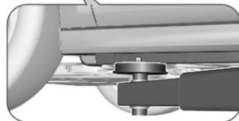
Position de centrage du bras porteur avant du pont élévateur sous le point de levage du véhicule.
