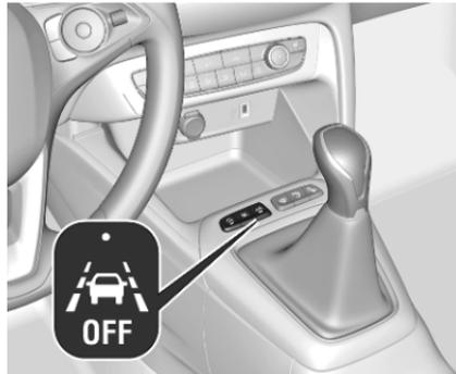
Si le système est activé, la LED du bouton
