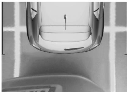
La caméra enregistre les abords du véhicule pendant la manœuvre pour reconstituer une vue depuis le haut de l'arrière ou de l'avant du véhicule dans son environnement proche. Le véhicule peut alors être manœuvré en évitant les obstacles à proximité. Cette vue est disponible avec le mode automatique ou dans le menu de sélection de vue.
