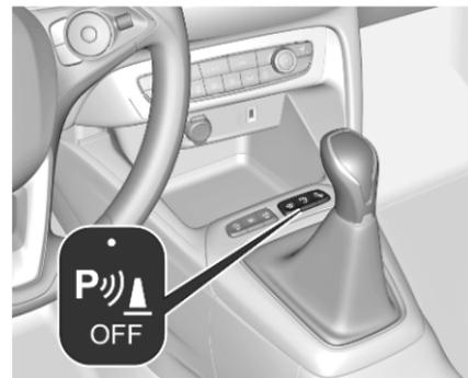
Le système est prêt à fonctionner lorsque la LED du bouton d'aide au stationnement  $P_{OFF}^{WA}$  est éteinte. L'état du système est mémorisé lorsque le contact est coupé.
