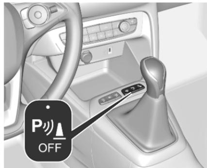
Le système est désactivé lorsque la marche arrière est désengagée. Appuyer sur  $P_{OFF}^{WA}$  pour désactiver manuellement le système. La LED du bouton s'allume lorsque le système est désactivé. Si le système a été désactivé manuellement, il n'est pas réactivé automatiquement lorsque le contact est remis.
