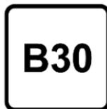
L'utilisation d'un carburant B20 ou B30 conforme à la norme EN16709 est possible dans nos moteurs diesel. Toutefois, cette utilisation, même occasionnelle, exige une application
