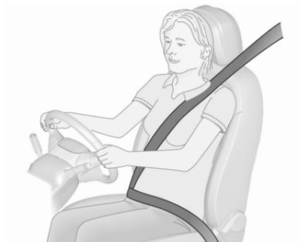
Les ceintures de sécurité sont bloquées lors d'accélération ou de décélération fortes du véhicule, ce qui assure le maintien des occupants en position assise. Le risque de blessure est ainsi sensiblement réduit.
