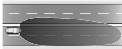
Activé automatiquement à une vitesse supérieure à 105 km/h. L'éclairage est adapté à la vitesse de conduite plus élevée sur autoroutes. Si aucun véhicule ne circule en sens inverse, la visibilité latérale du véhicule est augmentée. Lorsque vous suivez des véhicules en avant ou de passage, l'éblouissement pour ces véhicules est réduit.
