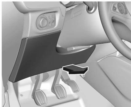
Dans les véhicules avec direction à gauche, la boîte à fusibles se trouve derrière un cache du tableau de bord. Dégager le cache sur le côté inférieur et le déposer.
