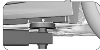
Position de centrage du bras porteur arrière du pont élévateur sous le point de levage du véhicule.
