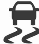
L'Electronic Stability Control et le système antipatinage sont opérationnels après chaque démarrage du moteur, dès que le témoin
