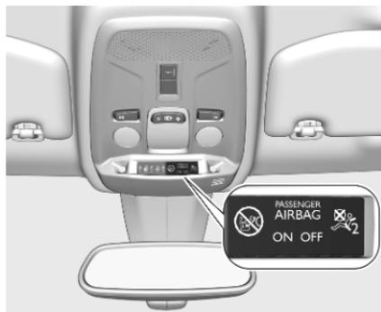
Si le témoin
