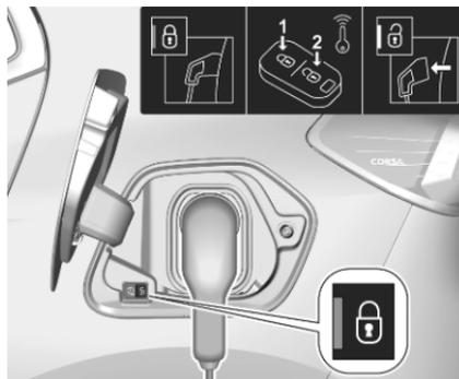
Pendant le chargement, la fiche du véhicule est verrouillée sur le port de chargement et ne peut être débranchée en cours de chargement. L'indicateur
