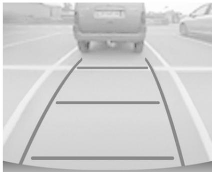
La zone derrière le véhicule s'affiche à l'écran. Les lignes verticales représentent la largeur du véhicule avec les rétroviseurs dépliés. La direction des lignes change avec la position du volant de direction.
