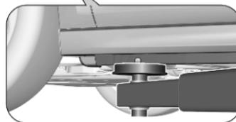
La position de bras avant de la plateforme de levage est centrale sous le point concerné de levage du véhicule.
