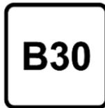
L'utilisation d'un carburant B20 ou B30 conforme à la norme EB16709 est possible dans nos moteurs diesel. Toutefois, cette utilisation, même occasionnelle, exige une application
