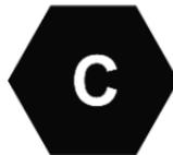
Fiche ou prise de type 2 utilisée pour la recharge en courant alternatif
