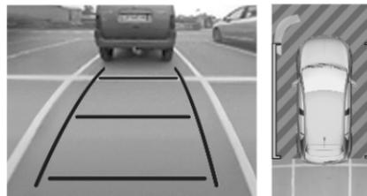
L'écran d'affichage est divisé en deux parties. Celle de droite affiche une vue depuis le haut du véhicule et celle de gauche, une vue depuis l'arrière. Si le véhicule est équipé de capteurs de stationnement à ultrasons, ils complètent les informations sur la vue depuis le dessus du véhicule.
