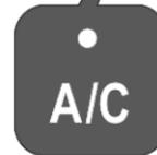
Appuyer sur **A/C** pour mettre le refroidissement en marche. L'activation est signalée par l'éclairage de la LED du bouton. Le refroidissement ne fonctionne que lorsque le moteur est en marche et que le ventilateur de climatisation est en marche.
