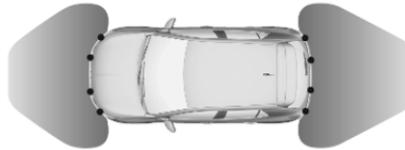
Si le véhicule est équipé de quatre capteurs de stationnement à ultrasons dans le pare-chocs avant et arrière, l'aide au stationnement avant-arrière mesure la distance entre le véhicule et les obstacles présents devant et derrière le véhicule. Elle informe et avertit le conducteur par des signaux sonores et une indication à l'écran.
