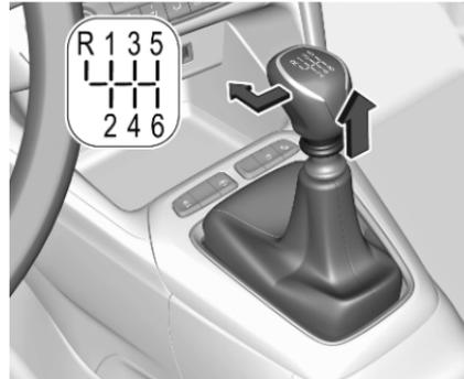
Pour engager la marche arrière d'une boîte de vitesses à 6 rapports, le véhicule étant à l'arrêt et le moteur au ralenti, enfoncer la pédale d'embrayage, tirer sur l'anneau sous le levier sélecteur et déplacer le levier sélecteur complètement vers la gauche et l'avant.
