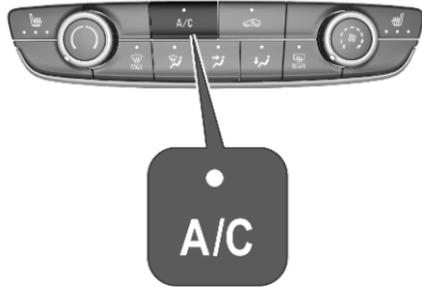
Appuyer sur **A/C** pour mettre le refroidissement en marche. La LED du bouton s'allume pour signaler l'activation. Le refroidissement ne fonctionne que lorsque le moteur est en marche et le ventilateur aussi.
