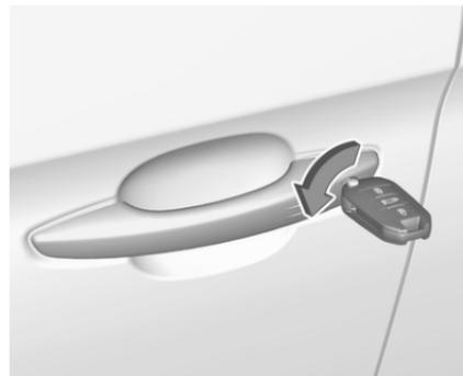
Déverrouiller manuellement la porte avant en introduisant et en tournant la clé dans le barillet de la serrure.
