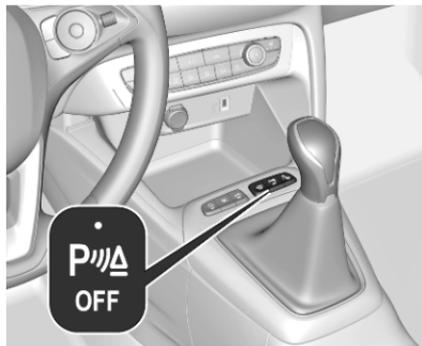
Le système est prêt à fonctionner lorsque la LED du bouton d'aide au stationnement  $P_{OFF}$  n'est pas allumée ou lorsque  $P_{OFF}$  s'éteint dans le centre d'informations du conducteur. L'état du système est mémorisé lorsque le contact est coupé.
