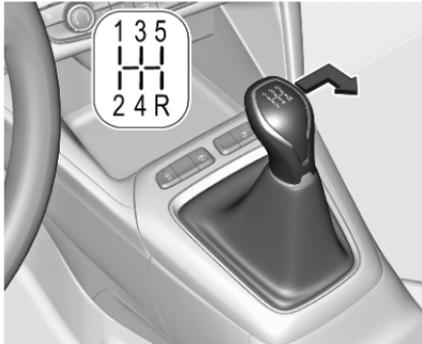
Pour engager la marche arrière d'une boîte de vitesses à 5 rapports, le véhicule étant à l'arrêt et le moteur au ralenti, enfoncer la pédale d'embrayage et déplacer le levier sélecteur vers la droite et l'arrière.
