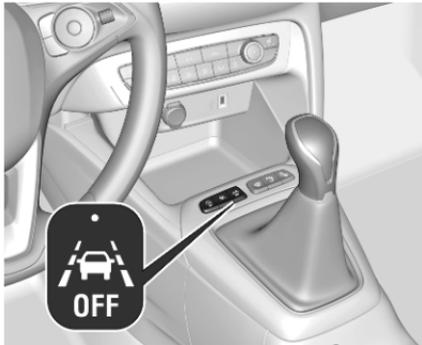
Si le système est activé, la LED du bouton
