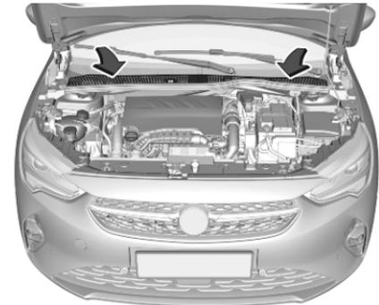
La prise d'air dans le compartiment moteur, à l'extérieur devant le pare-brise, ne doit pas être encombrée. Le cas échéant, enlever les feuilles, les saletés ou la neige.
