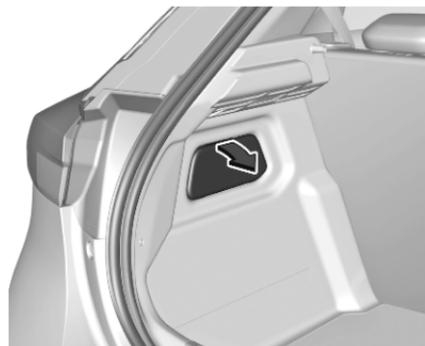
1. Ouvrir le hayon puis déposer le couvercle d'accès du côté correspondant.
