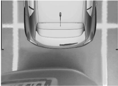
La caméra enregistre les environs du véhicule pendant la manœuvre pour reconstruire une vue depuis le haut du véhicule dans son environnement proche. Le véhicule peut alors être manœuvré en évitant les obstacles à proximité. Cette vue est disponible avec le mode automatique ou dans le menu de sélection de vue.
