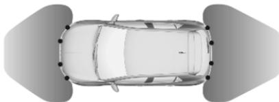
Si le véhicule est équipé de quatre capteurs de stationnement à ultrasons dans le pare-chocs avant et arrière, l'aide au stationnement avant-arrière mesure la distance entre le véhicule et les obstacles
