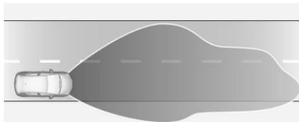
Activé automatiquement à une vitesse supérieure à 50 km/h en conduisant dans des zones rurales. L'éclairage de la voie et du bas-côté est adapté. Les véhicules qui arrivent et qui précèdent ne sont pas éblouis.
