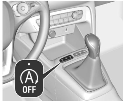
Le système est prêt à fonctionner lorsque la LED du bouton
