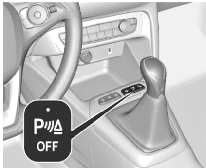
Appuyer sur  $P_{OFF}$  pour désactiver manuellement le système. La LED du bouton s'allume lorsque le système est désactivé. Si le système a été désactivé manuellement, il n'est pas réactivé automatiquement lorsque le contact est remis.
