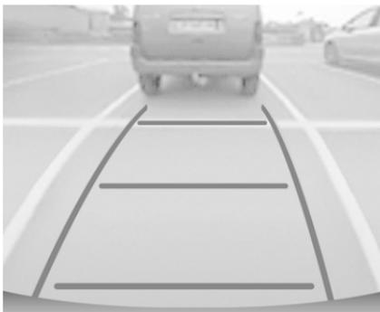
La zone derrière le véhicule s'affiche à l'écran. Les lignes verticales représentent la largeur du véhicule avec
