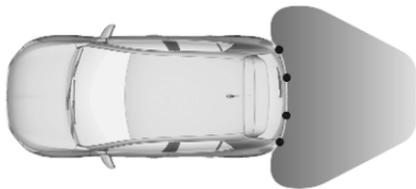
Le système fonctionne avec des capteurs ultrasoniques de stationnement dans le pare-chocs arrière.
