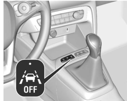
Si le système est activé, la LED du bouton
