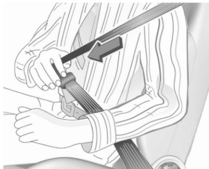
Tirer la ceinture hors de l'enrouleur, la guider sur le corps sans la vriller et insérer le verrou plat dans la serrure. La ceinture de sécurité doit passer sur l'épaule et s'ajuster au corps pendant la conduite.
