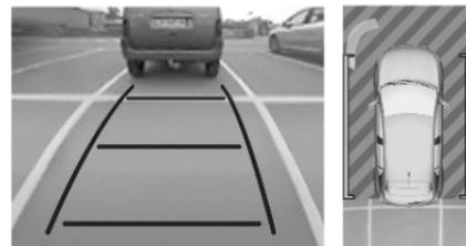
L'écran d'affichage est divisé en deux parties. Celle de droite affiche une vue depuis le haut du véhicule et celle gauche, une vue depuis l'arrière. Si le véhicule est équipé de capteurs de stationnement à ultrasons, ils complètent les informations sur la vue depuis le dessus du véhicule.
