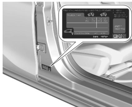
L'étiquette d'informations sur la pression des pneus apposée indique l'équipement pneumatique d'origine du véhicule et les pressions de gonflage correspondantes.
