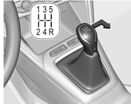
Pour engager la marche arrière d'une boîte de vitesses à 5 rapports, le véhicule étant à l'arrêt et le moteur au ralenti, enfoncer la pédale d'embrayage et déplacer le levier sélectionneur vers la droite et l'arrière.
