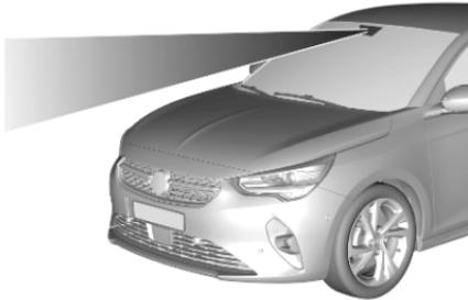
Le système d'avertissement de franchissement de ligne aide le conducteur à éviter une sortie de voie involontaire. Le caméra avant observe les bords de la chaussée, ainsi que les marquages de voie entre lesquels le véhicule circule. Si le véhicule s'approche du bord d'une route ou d'un marquage de voie, le système avertit le conducteur.
