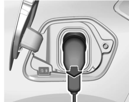
2. Débrancher du port de chargement la fiche côté véhicule du câble de chargement dans les 30 secondes suivant le déverrouillage.
