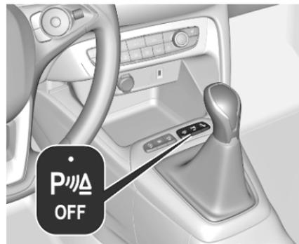
Selon la version, le système est prêt à fonctionner lorsque la LED du bouton d'aide au stationnement  $P_{OFF}^{PWA}$  n'est pas allumée. L'état du système est mémorisé lorsque le contact est coupé.
