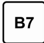
Carburant diesel conforme à la norme EN590 mélangé à un biocarburant conforme à la norme EN14214 (pouvant contenir jusqu'à 7 % d'ester méthylique d'acide gras).
