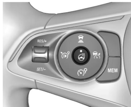
Activer le chauffage en appuyant sur
