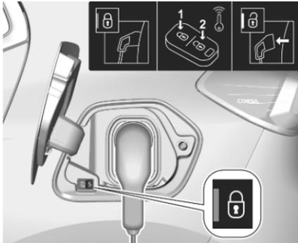
Pendant le chargement, la fiche du véhicule est verrouillée sur le port de chargement et ne peut être débranchée en cours de chargement. L'indicateur
