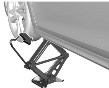
Quand le cric est correctement aligné, soulever le véhicule jusqu'à ce que la roue ne touche plus le sol.
