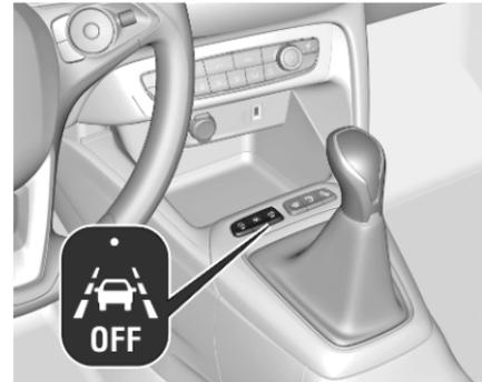
Selon la version, le système est automatiquement activé lorsque le contact est mis. Si le système est activé, la LED du bouton
