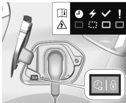
Le début du chargement est indiqué par le clignotement en vert de l'indicateur d'état sur le port de chargement et sur son boîtier de commande, le cas échéant.
