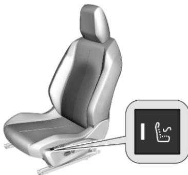
Activer la fonction de massage du dos en appuyant sur
