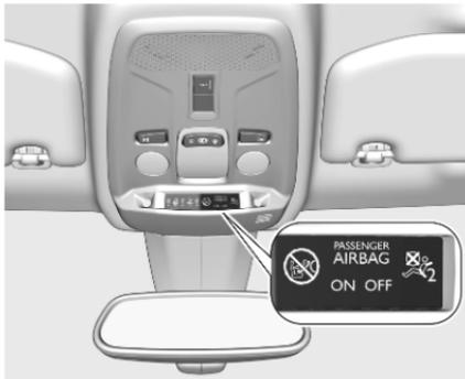
Si le témoin
