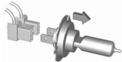
4. Remplacer l'ampoule et la pousser dans le bloc de réflecteur en plaçant la patte.
