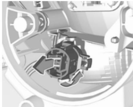
2. Faire tourner la douille d'ampoule inférieure dans le sens antihoraire pour la désengager. Retirer la douille de l'ampoule du boîtier du réflecteur.
