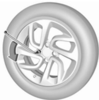
2. Sortir la clé de roue et la poser en s'assurant qu'elle est bien positionnée, puis desserrer chaque vis de roue d'un demi-tour.
