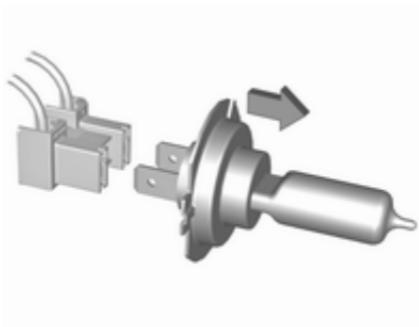
3. Retirer l'ampoule du connecteur enfichable en tirant.
