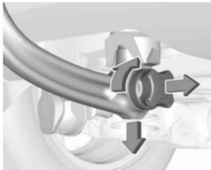
Ouvrir le volet de protection et tourner la clé en position
