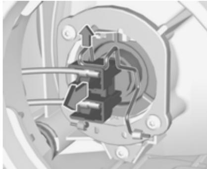
2. Lever la pièce de retenue puis retirer le connecteur de prise.
