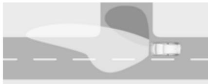
En retour de virage, en fonction de l'angle de braquage et du feu de direction, des diodes particulières sont allumées dans le sens du déplacement. Il est activé jusqu'à une vitesse de 40 km/h.
