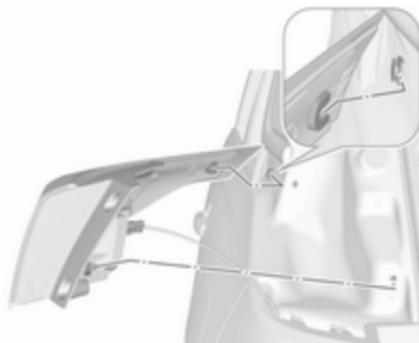
2. Fixer l'ensemble de feu à la carrosserie du véhicule et fixer à l'aide des deux vis.
