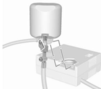
4. Visser le flexible d'air du compresseur sur le raccord sur la bouteille de produit d'étanchéité.
