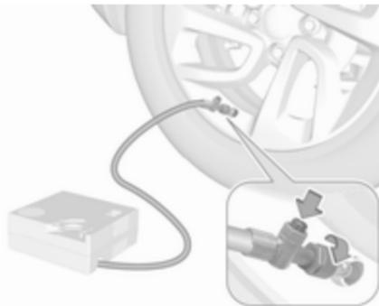
16. Reprendre la route sans délai afin que le produit d'étanchéité se répartisse uniformément dans le pneu. Après un trajet d'environ 5 km (mais pas plus de 10 min), s'arrêter et contrôler la pression des pneus. À cet effet, visser directement le flexible d'air sur la valve du pneu. Remplir le pneu comme décrit plus haut. Réduire l'excédent de pression de pneu au moyen du bouton du flexible pneumatique.
