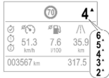
Lorsqu'il est recommandé de passer au rapport supérieur pour économiser du carburant, ▲ est affiché avec le chiffre d'un rapport supérieur.
