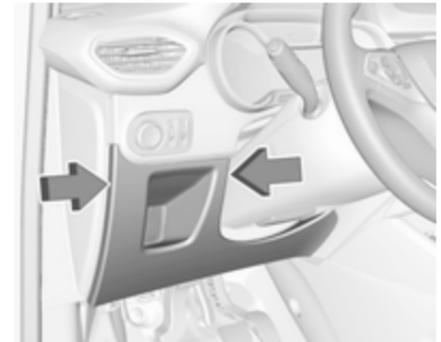
Dans les véhicules avec direction à gauche, la boîte à fusibles se trouve derrière un cache du tableau de bord. Dégager le cache sur le côté, puis l'enlever.
