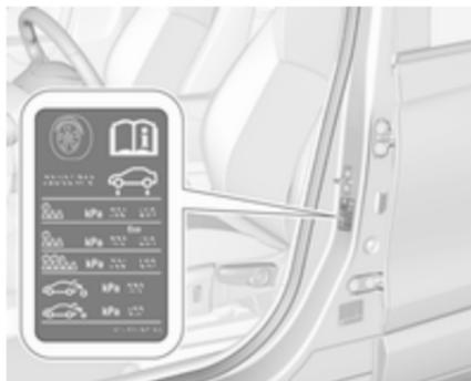
L'étiquette d'informations sur la pression des pneus apposée sur l'encadrement de la porte gauche indique l'équipement pneumatique d'origine du véhicule et les pressions de gonflage correspondantes.
