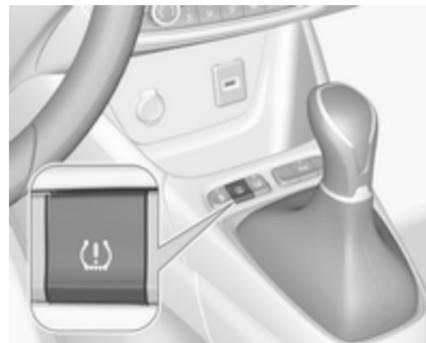
Après la correction de la pression de pneu ou le changement de roue, le système doit être initialisé pour apprendre les nouvelles valeurs de référence de circonférence :
