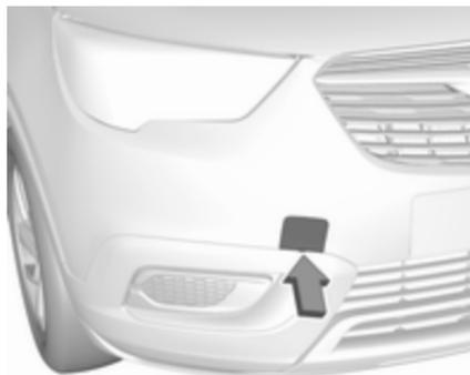
Envelopper d'un linge l'extrémité d'un tournevis plat pour ne pas endommager la peinture. Insérer un tournevis dans la fente du bas du capuchon. Dégager le capuchon en enfonçant avec précaution le tournevis vers le bas.
