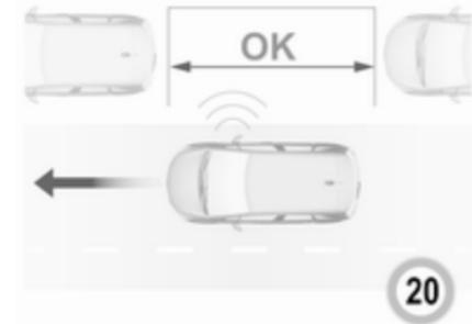
Lorsqu'un emplacement libre est détecté, une information visuelle en retour apparaît sur l'affichage d'informations en couleur et un premier signal sonore est émis. Rouler lentement en avant. Lorsque le second signal sonore retentit, arrêter le véhicule, sélectionner la marche arrière, lâcher le volant et commencer à se déplacer sans dépasser 7 km/h.
