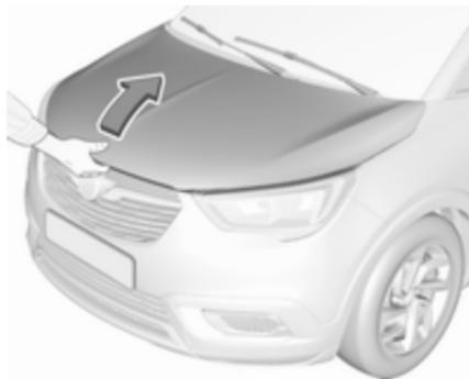
Déplacer le verrou de sécurité sur le côté gauche du véhicule et ouvrir le capot.
