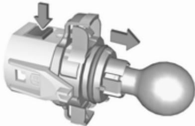
3. Appuyer sur le loquet et déposer l'ampoule de la douille.
