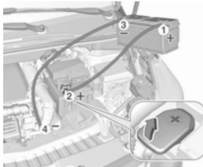
Ouvrir les capuchons de protection de borne positive des deux batteries de véhicule.
