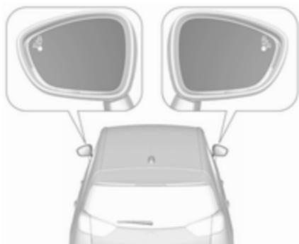
Lorsque le système détecte un véhicule dans la zone aveugle en roulant en avant, une diode s'allume dans le rétroviseur concerné.
