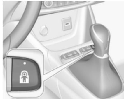
Système télécommandé pour empêcher l'ouverture des portes arrière à l'aide des poignées intérieures.
