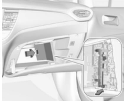
Dans les véhicules avec direction à gauche, la boîte à fusibles se trouve derrière un cache dans la boîte à gants. Ouvrir la boîte à gants et retirer le couvercle. Déposer le support.
