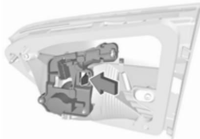
Appuyer sur le loquet pour le relâcher et déposer la douille d'ampoule.
