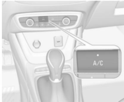
Appuyer sur **A/C** pour mettre le refroidissement en marche. L'activation est signalée par la LED dans le bouton. Le refroidissement ne fonctionne que lorsque le moteur est en marche et que la soufflerie de la climatisation est allumée.
