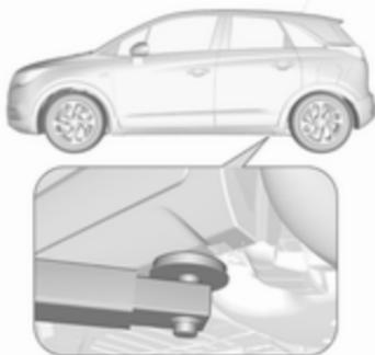
Position de centrage du bras porteur arrière du pont élévateur sous le point de levage du véhicule.
