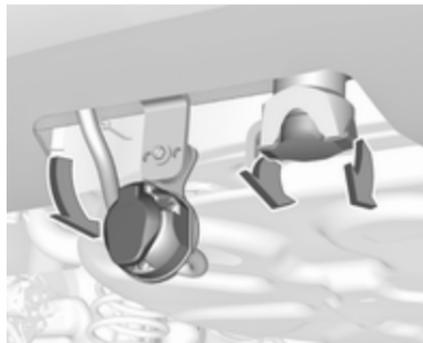
Faire pivoter la douille de connexion vers le bas. Enlever le bouchon de l'ouverture de barre d'attelage et l'engager.
