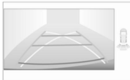
Les lignes verticales représentent la largeur du véhicule sans rétroviseurs et la direction générale du véhicule. Les lignes horizontales représentent une distance d'environ 30 cm, 1 m et 2 m au-delà du pare-chocs arrière. Les courbes transversales représentent le rayon de braquage maximum.
