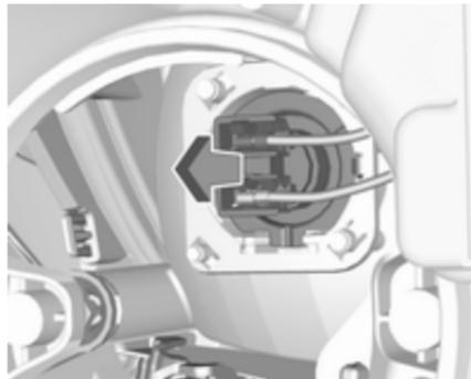
2. Extraire la douille d'ampoule supérieure du bloc de réflecteur.
