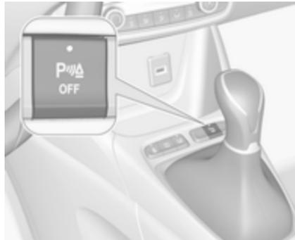
Le système est désactivé automatiquement lorsque la vitesse du véhicule dépasse 10 km/h ou si le véhicule est arrêté pendant plus de 3 secondes avec un rapport avant engagé ou si aucun obstacle n'est détecté.
