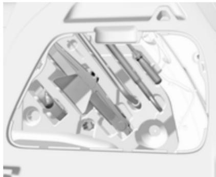
Le cric, les outils, une sangle de fixation de roue endommagée et l'œillet de remorquage sont rangés dans la boîte à outils, dans le flanc droit du coffre.
