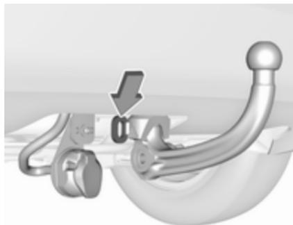
Attacher le câble de rupture d'attelage à l'œillet.
