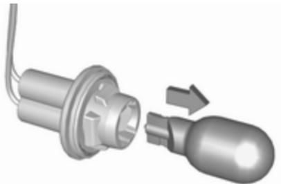
Tirer tout droit pour la retirer de la douille et la remplacer.
