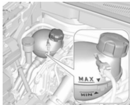
Si le système de refroidissement est froid, le niveau de liquide de refroidissement doit se trouver au-dessus du repère **MIN**. Faire l'appoint si le niveau est bas.
