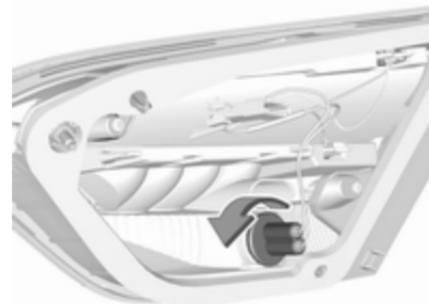
Déposer la douille de l'ampoule de feu de recul de l'ensemble de feu en la tournant en sens antihoraire.
