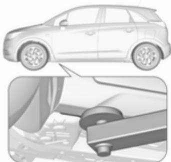
Position de centrage du bras porteur avant du pont élévateur sous le point de levage du véhicule.
