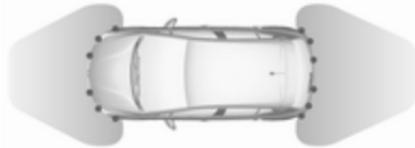
Le système avancé d'assistance au stationnement est toujours associé à l'aide au stationnement avant-arrière.
