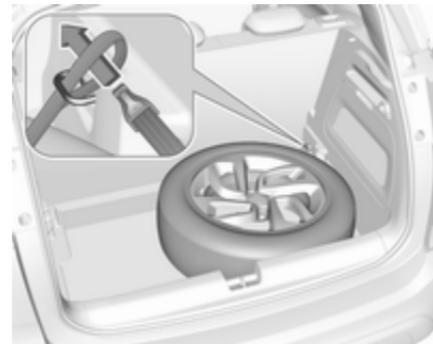
2. Placer l'extrémité libre de la sangle à travers l'anneau d'arrimage avant du côté approprié.
