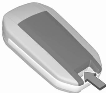
1. Pour déclipser le couvercle au dos de la commande à distance, insérer un petit tournevis entre le couvercle et la commande à distance.
