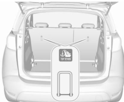
En plus des supports ISOFIX, attacher la sangle du Top-tether aux ancrages du Top-tether.
