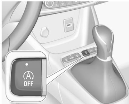
Pour désactiver le système Stop/Start manuellement, appuyer sur
