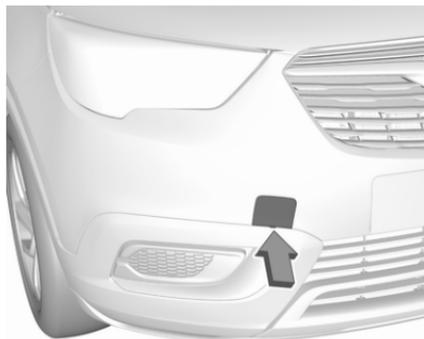
Envelopper d'un linge l'extrémité d'un tournevis plat pour ne pas endommager la peinture. Insérer un tournevis dans la fente du bas du capuchon. Dégager le capuchon en enfonçant avec précaution le tournevis vers le bas.
