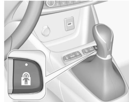
Système télécommandé pour empêcher l'ouverture des portes arrière à l'aide des poignées intérieures.
