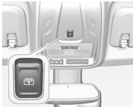
Appuyer doucement sur
