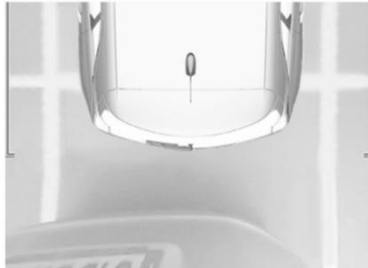
La caméra enregistre les environs du véhicule pendant la manœuvre pour reconstruire une vue depuis le haut de l'arrière du véhicule dans son environnement proche, permettant au véhicule d'être manœuvré autour des
