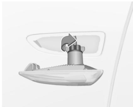
2. Tourner la douille d'ampoule dans le sens antihoraire et l'extraire du bloc optique.
