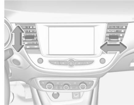
Régler la direction du flux d'air en faisant basculer et pivoter les lamelles.
