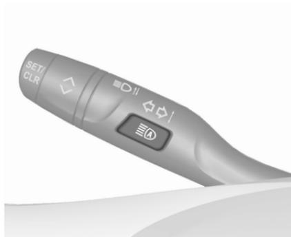
Activer les feux de route automatiques en appuyant sur
