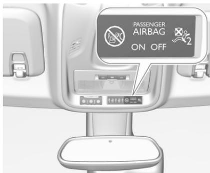
Si le témoin
