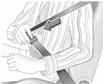
Tirer la ceinture de sécurité hors de l'enrouleur, la guider sur le corps sans la vriller et insérer la languette de verrouillage dans la boucle. En roulant, tendre régulièrement la sangle abdominale en tirant sur la sangle thoracique de la ceinture de sécurité.
