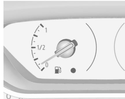
Indique le niveau de carburant dans le réservoir.
