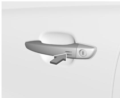
Système à clé électronique : Le déverrouillage du véhicule en appuyant sur le marquage d'une des poignées de porte avant désactive l'alarme antivol.
