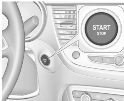
La clé électronique doit se trouver à l'intérieur du véhicule.
