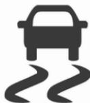
L'ESC et le système antipatinage fonctionnent après chaque démarrage du moteur, dès que le témoin
