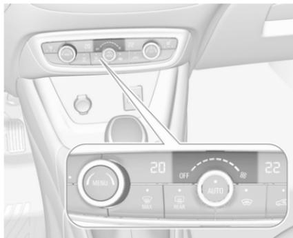
Régler le débit d'air en tournant le bouton rotatif ☼ sur la vitesse souhaitée.
