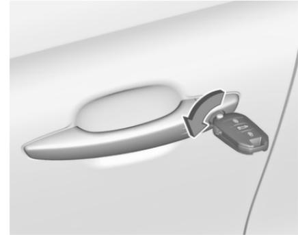
Déverrouiller manuellement la porte du conducteur en introduisant et en tournant la clé dans le barillet de la serrure. Avec un système de verrouillage central fonctionnel, le véhicule sera déverrouillé.
