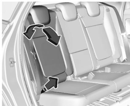
Tirer la boucle, ajuster l'inclinaison et relâcher la boucle. Ne pas s'appuyer sur le dossier pendant le réglage.
