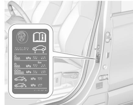
L'étiquette d'informations sur la pression des pneus apposée sur l'encadrement de la porte gauche indique l'équipement pneumatique d'origine du véhicule et les pressions de gonflage correspondantes.
