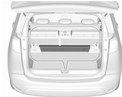
Ranger le triangle de présignalisation dans l'espace arrière du coffre et le fixer au moyen de la bande Velcro®
