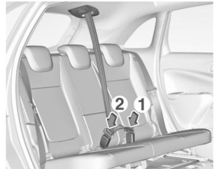
Insérer la languette de verrouillage inférieure dans la boucle du côté gauche (1) du siège central. Guider la languette de verrouillage supérieure avec la ceinture de sécurité par-dessus la zone de l'abdomen et l'épaule (sans vriller) et l'insérer dans la boucle du côté droit (2) du siège central.
