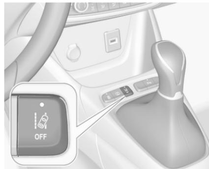
Le système d'avertissement de franchissement de ligne est activé en appuyant sur . Le système est activé lorsque la diode du bouton n'est pas allumée.
