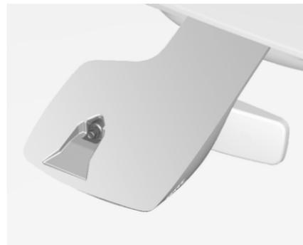
Ne pas fixer d'autocollants comme des autocollants de péage ou tout autre autocollant identique dans la zone du rétroviseur intérieur du pare-brise. Le champ du capteur de pluie doit rester propre, c'est-à-dire sans poussière, saletés, ni givre. Sinon, la zone de détection du détecteur de pluie / capteur de luminosité et la zone de vision de la caméra dans le boîtier du rétroviseur peuvent être restreintes.
