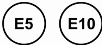
Essence conforme à la norme EN228 mélangée à un biocarburant conforme à la norme EN15376.
