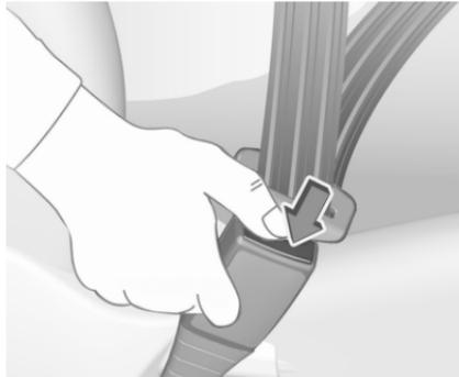
Pour déboucler la ceinture de sécurité, appuyer sur le bouton rouge de la boucle de ceinture de sécurité.
