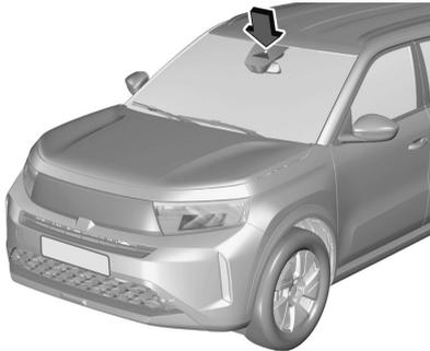
Ne pas fixer d'autocollants sur le pare-brise comme des autocollants de péage ou tout autre élément identique dans la zone du rétroviseur intérieur du pare-brise. Le champ du capteur de pluie doit rester propre, c'est-à-dire sans poussière, saletés, ni givre. Sinon, la zone de détection du capteur de pluie / capteur de luminosité et la zone de vision de la caméra dans le boîtier du rétroviseur peuvent être restreintes.
