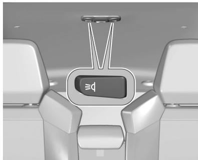
**Fonctions spéciales d'éclairage****ÉCLAIRAGE DE LA CONSOLE CENTRALE**
