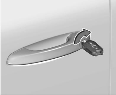
Verrouiller manuellement la porte avant gauche en introduisant et en tournant la clé dans le barillet de la serrure. Si le système de verrouillage centralisé est opérationnel, le véhicule sera verrouillé.
