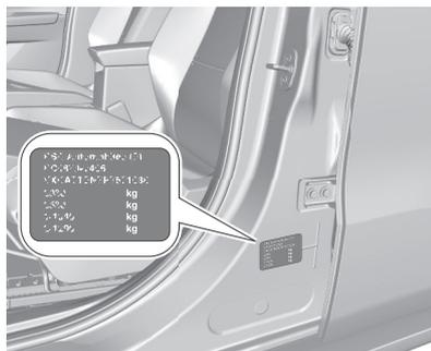
L'étiquette d'information sur la pression des pneus présente dans le cadre de porte gauche ou droit indique l'équipement pneumatique d'origine du véhicule et les pressions de gonflage correspondantes.
