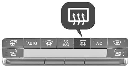
Appuyer sur le bouton pour activer le chauffage des rétroviseurs chauffants.
