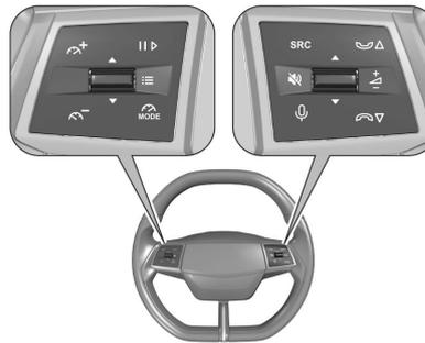
Certains systèmes d'assistance au conducteur, le système d'infodivertissement et un téléphone mobile connecté peuvent être actionnés via les commandes au volant.
