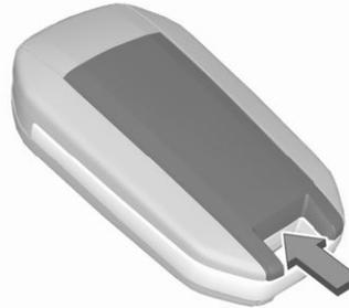
1. Pour déclipper le cache, insérer un petit tournevis entre le cache arrière et la télécommande.
