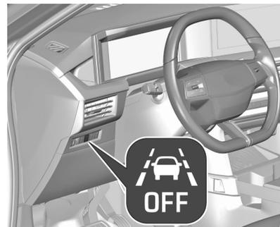
Si le système est activé, la LED du bouton ne s'allume pas. Pour activer le système lorsqu'il est désactivé, appuyer sur le bouton.
