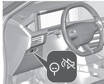
Conformément aux exigences légales, le signal sonore ne peut être désactivé qu'en cliquant sur le bouton-poussoir jusqu'à la prochaine mise du contact.
