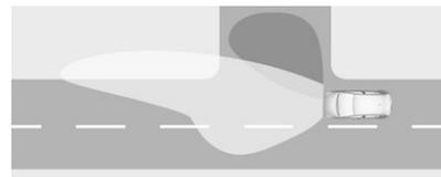
Des LED particulières, basées sur l'angle de braquage et la vitesse, sont en plus déclenchées pour améliorer l'éclairage dans les virages. Elles sont activées jusqu'à une vitesse de 40 km/h.
