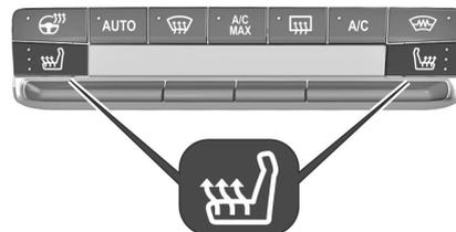
Selon le chauffage voulu, appuyer une ou plusieurs fois sur le bouton de siège correspondant. Le témoin dans le bouton indique le réglage sélectionné.
