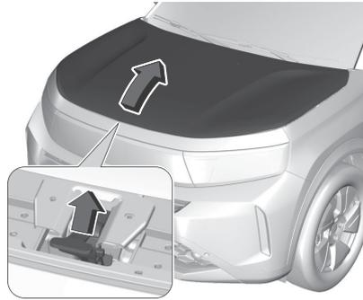
Lever le crochet de sécurité extérieur et soulever le capot.
