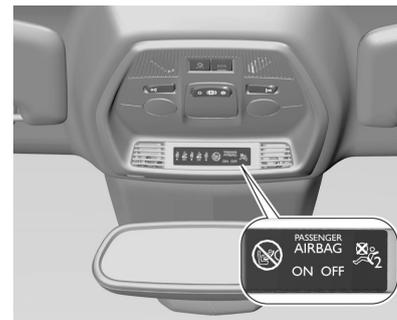
Si le témoin ON s'allume pendant environ 60 secondes après avoir mis le contact, le système d'airbag passager avant se déploiera en cas de collision.
