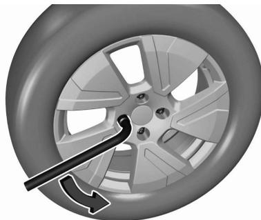
2. Placer la clé de roue et desserrer chaque boulon de roue d'un demi-tour.
