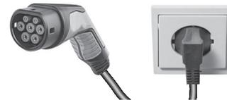
La batterie haute tension du véhicule peut être chargée sur une prise électrique domestique. Brancher le câble de recharge au port de recharge du véhicule et à la prise électrique domestique.
