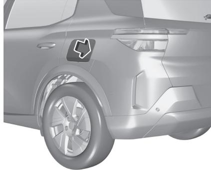
La trappe de réservoir ne peut être ouverte que si le véhicule est déverrouillé. Ouvrir la trappe à carburant en la poussant. Pour ouvrir, tourner lentement le capuchon dans le sens anti-horaire.
