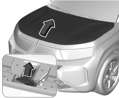
Lever le crochet de sécurité extérieur et soulever le capot. Déclipper le support de capot afin de son logement et le fixer dans le cran pour maintenir le capot ouvert.
