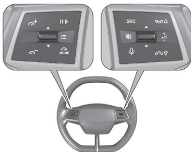
Le menu du combiné, certains systèmes d'assistance au conducteur, le système d'infodivertissement et un téléphone mobile connecté peuvent être actionnés via les commandes au volant.
