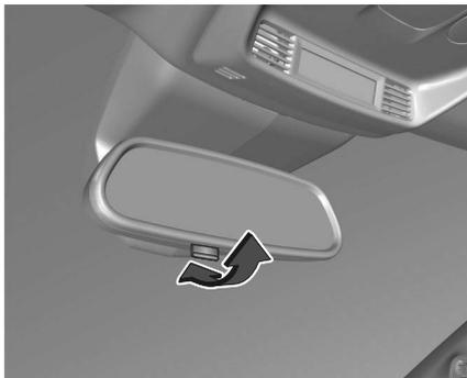
Pour réduire l'éblouissement, tirer le levier sous le boîtier du rétroviseur.
