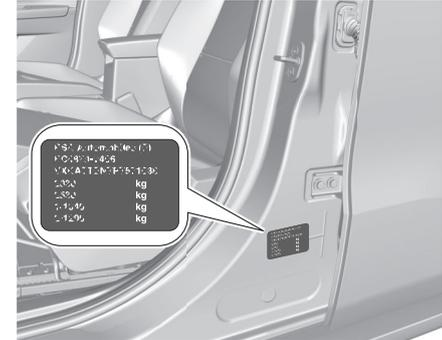
L'étiquette d'information sur la pression des pneus présente dans le cadre de porte gauche ou droit indique l'équipement pneumatique d'origine du véhicule et les pressions de gonflage correspondantes.
