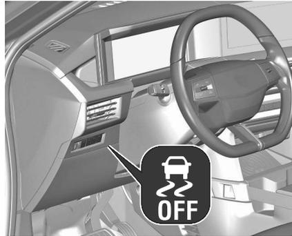
L'ESC et le système antipatinage (ASR) peuvent au besoin être désactivés :
