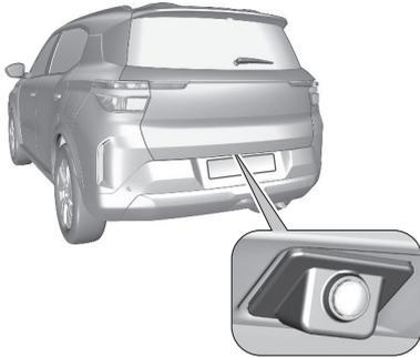
La caméra arrière aide le conducteur à reculer en affichant une vue de la zone derrière le véhicule. Elle permet d'afficher les alentours du véhicule dans une image à quasi 135° à l'écran d'information.
