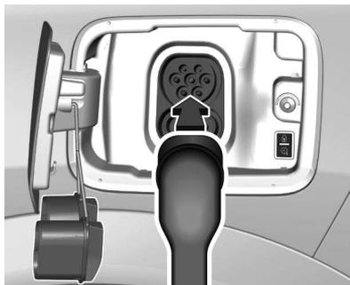
5. Brancher la fiche côté véhicule du câble de recharge Mode 3 dans le port de recharge du véhicule.
