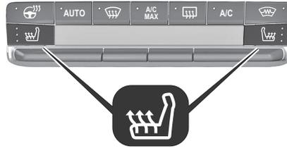
Selon le chauffage voulu, appuyer une ou plusieurs fois sur le bouton de siège correspondant. Le témoin dans le bouton indique le réglage sélectionné. Le chauffage fonctionne uniquement lorsque la température extérieure est inférieure à 20°C. Une utilisation prolongée au réglage maximum n'est pas recommandée pour les personnes à peau sensible. Le chauffage des sièges fonctionne uniquement moteur tournant. Le chauffage des sièges ne fonctionne pas pendant un Autostop.
