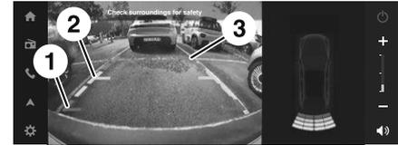
La zone derrière le véhicule est affichée à l'écran. Les lignes verticales représentent la largeur du véhicule avec les rétroviseurs dépliés.
