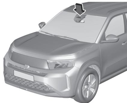
Ne pas fixer d'autocollants sur le pare-brise comme des autocollants de péage ou tout autre élément identique dans la zone du rétroviseur intérieur du pare-brise. Le champ du capteur de pluie doit rester propre, c'est-à-dire sans poussière, saletés, ni givre. Sinon, la zone de détection du capteur de pluie / capteur de luminosité et la zone de
