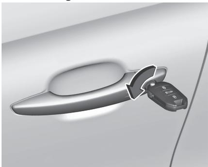
Déverrouiller manuellement la porte gauche en introduisant et en tournant la clé dans le sens anti-horaire dans le barillet de la serrure.
