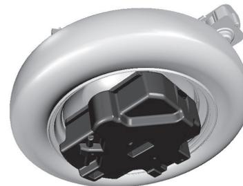
4. Retirer le cric avec son clip de montage pour déverrouiller l'ensemble roue/outil.
