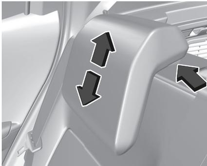
Tirer l'appuie-tête vers le haut ou appuyer sur le loquet pour le déverrouiller et abaisser l'appuie-tête.
