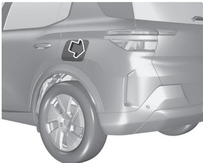
2. Appuyer sur le volet du port de recharge pour le dégager.
