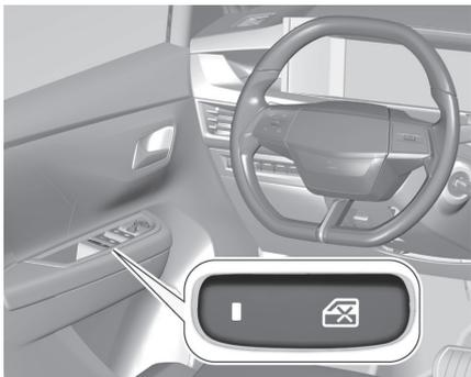
Appuyer sur le bouton pour désactiver les lève-vitres électriques des portes
