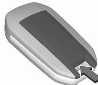
1. Pour déclipper le cache, insérer un petit tournevis entre le cache arrière et la télécommande.
