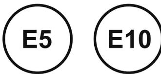
N'utiliser que des carburants conformes à la norme européenne EN 228 ou E DIN 51626-1 ou toute autre norme équivalente.
