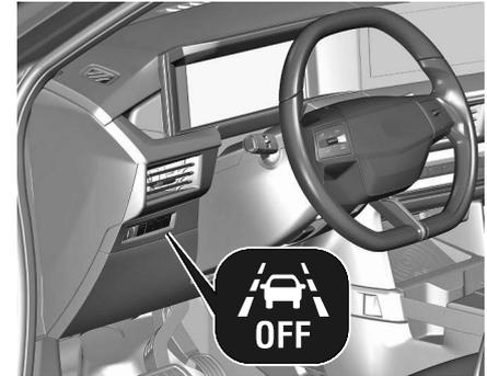
Si le système est activé, la LED du bouton ne s'allume pas. Pour activer le système lorsqu'il est désactivé, appuyer sur le bouton.
