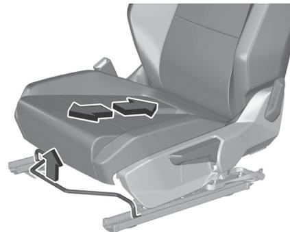
Tirer la poignée, déplacer le siège et relâcher la poignée. Essayer de déplacer le siège d'avant en arrière pour s'assurer qu'il est bien verrouillé en place.
