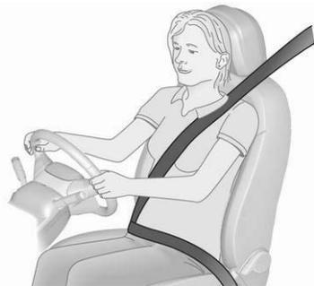
Les ceintures de sécurité sont bloquées lors d'accélération ou de décélération fortes du véhicule, ce qui assure le maintien des occupants en position assise. Le risque de blessure est ainsi sensiblement réduit.
