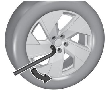
Placer la clé de roue et desserrer chaque boulon de roue d'un demi-tour.
