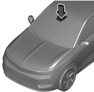
Ne pas fixer d'autocollants sur le pare-brise comme des autocollants de péage ou tout autre élément identique dans la zone du rétroviseur intérieur du pare-brise. Le champ du capteur de pluie doit rester propre, c'est-à-dire sans poussière, saletés, ni givre. Sinon, la zone de détection du capteur de pluie / capteur de luminosité et la zone de vision de la caméra dans le boîtier du rétroviseur peuvent être restreintes. ⇒ la page 44
