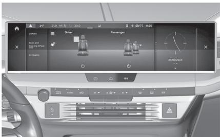
Régler la ventilation sur l'intensité voulue en appuyant une ou plusieurs fois sur
