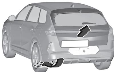
Pour ouvrir ou fermer le hayon, avancer et reculer le pied dans la zone illustrée. Ne pas laisser le pied trop longtemps ou le bouger trop lentement sous le pare-chocs. La clé électronique doit se trouver à l'extérieur du véhicule dans un rayon d'environ 1 m du hayon. Les feux de direction clignotent pour indiquer que le hayon motorisé est en mouvement. Le fonctionnement mains libres peut être réglé à l'écran d'informations.
