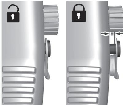
Vérifier que le mécanisme est déverrouillé (seule la marque rouge doit être visible).
