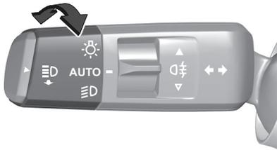
Quand la fonction de commande automatique des feux est activée, le système bascule automatiquement entre les feux de jour et les feux de croisement, en fonction des conditions d'éclairage extérieur et des informations communiquées par le système d'essuie-glaces.
