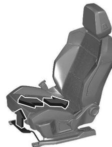
Tirer la poignée, déplacer le siège et relâcher la poignée. Essayer de déplacer le siège d'avant en arrière pour s'assurer qu'il est bien verrouillé en place.
