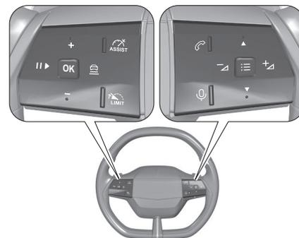
Certains systèmes d'assistance au conducteur, le système d'infodivertissement et un téléphone mobile connecté peuvent être actionnés via les commandes au volant.
