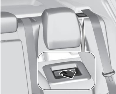
Tirer sur le levier de déverrouillage et rabattre les dossiers sur l'assise de siège.
