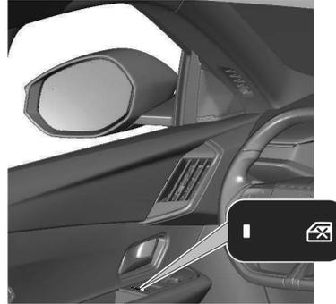
Appuyer sur le bouton pour désactiver les lève-vitres électriques des portes arrière. La LED s'allume. Pour l'activation, appuyer de nouveau sur le bouton.
