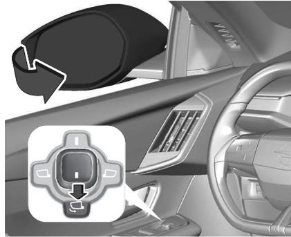
Pour rabattre ou déployer les deux rétroviseurs extérieurs, sélectionner la fonction de rabattement en tournant la commande sur
