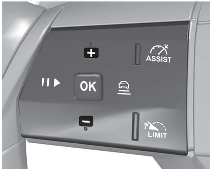
La vitesse présélectionnée peut être modifiée en appuyant sur + pour l'augmenter ou sur - pour la diminuer. Une pression courte modifie la vitesse de
