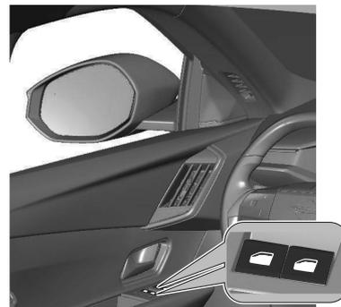
Manœuvrer le commutateur de la vitre concernée en l'appuyant pour l'ouvrir ou en le relevant pour la fermer.
