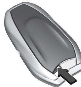
1. Pour déclipper le cache, insérer un petit tournevis entre le cache arrière et la télécommande.
