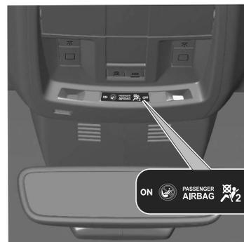
Si le témoin ON s'allume pendant environ 60 secondes après avoir mis le contact, le système d'airbag passager avant se déploiera en cas de collision.
