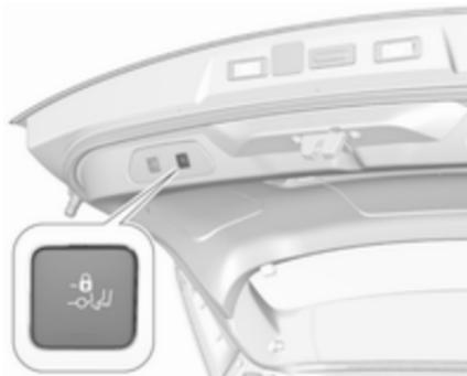
Appuyer sur le bouton
