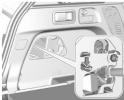
2. Desserrer l'écrou de fixation du bloc optique à l'aide d'une clé à douille ou d'une douille.
