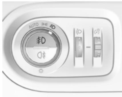
Pour les enclencher, appuyer sur
