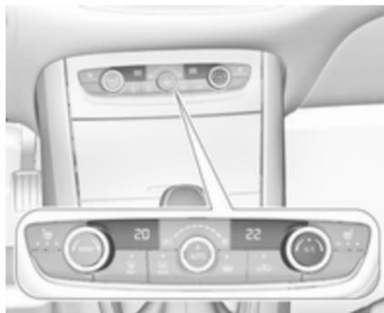
Appuyer sur **A/C** pour mettre le refroidissement en marche. L'activation est signalée par l'allumage de la diode du bouton. Le refroidissement ne fonctionne que lorsque le moteur est en
