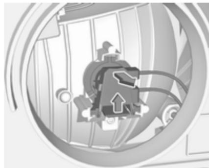
2. Pousser le clip de retenue vers le haut et tirer la douille d'ampoule vers l'arrière.
