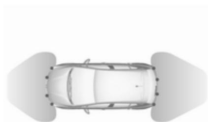
Le système possède des capteurs de stationnement à ultrasons dans les pare-chocs arrière et avant.
