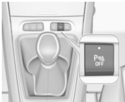
Le système est prêt à fonctionner lorsque la diode du bouton d'aide au stationnement
