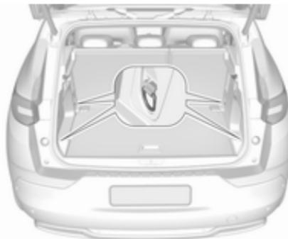
Les anneaux d'arrimage servent à sécuriser les objets pour éviter qu'ils ne glissent, par exemple avec des sangles de serrage ou le filet à bagages.
