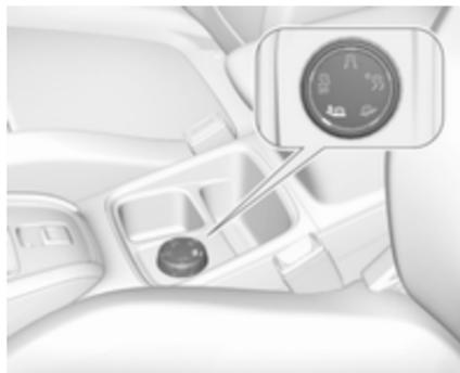
Ce mode laisse légèrement patiner les deux roues motrices simultanément, ce qui permet au véhicule d'avancer et réduit le risque d'enlèvement.
