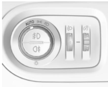
Les feux de route automatiques ne peuvent être activés que lorsque le commutateur d'éclairage est en position **AUTO**.
