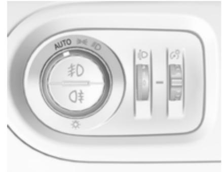
Quand la fonction de commande automatique des feux est activée et que le moteur tourne, le système bascule automatiquement entre les feux de jour et les phares, en fonction des conditions d'éclairage extérieur et des informations communiquées par le système de détecteur de pluie.
