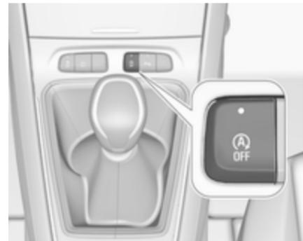
Pour désactiver le système Stop/Start manuellement, appuyer sur
