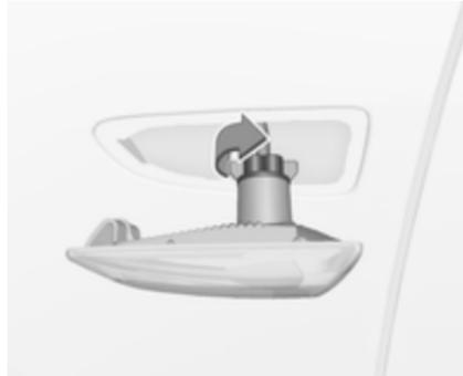
2. Faire tourner la douille d'ampoule dans le sens des aiguilles d'une montre et la déposer du logement.
