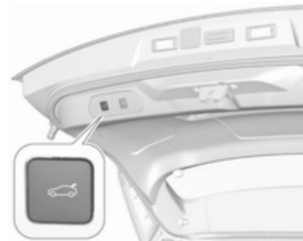
Pour fermer, appuyer sur
