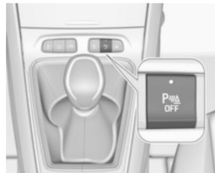
Le système est désactivé lorsque la marche arrière est désengagée. Appuyer sur
