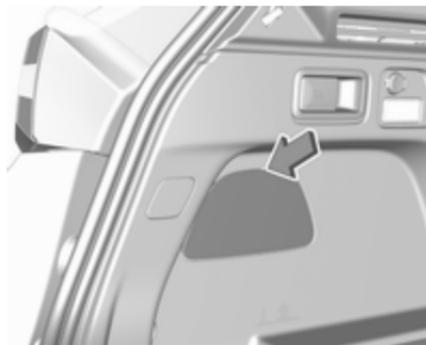
1. Ouvrir le hayon puis déclipser le couvercle d'accès du côté correspondant.
