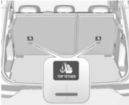
En plus des supports de montage ISOFIX, attacher la sangle Top-Tether aux ancrages Top-Tether.
