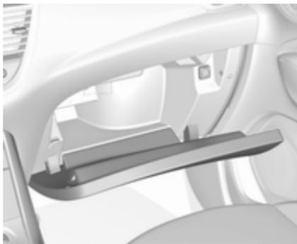
Sur certaines versions, la boîte à gants est ventilée. La ventilation et la température dépendent des réglages du système de commande de climatisation. La bouche d'air de la boîte à gants peut être fermée ⇨ 142.
