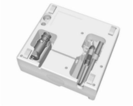
3. Enlever le câble de raccordement électrique et le flexible d'air de leur espace de rangement sur la face inférieure du compresseur.
