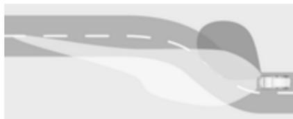
Des DEL particulières, basées sur l'angle de braquage et la vitesse, sont en plus déclenchées pour améliorer l'éclairage dans les virages. Cette fonction est activée à des vitesses comprises entre 40 km/h et 70 km/h et réagit à l'angle de braquage.
