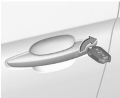
Verrouiller manuellement la porte du conducteur en introduisant et en tournant la clé dans le barillet de la serrure.
