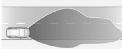
Activé automatiquement à une vitesse supérieure à 115 km/h. L'éclairage est adapté à la vitesse de conduite plus élevée sur autoroutes. Si aucun véhicule ne circule en sens inverse, la visibilité latérale du véhicule est augmentée. La plage de visibilité augmente de 70 m à 140 m, ce qui permet de reconnaître les objets éloignés sur toute la largeur de la route.
