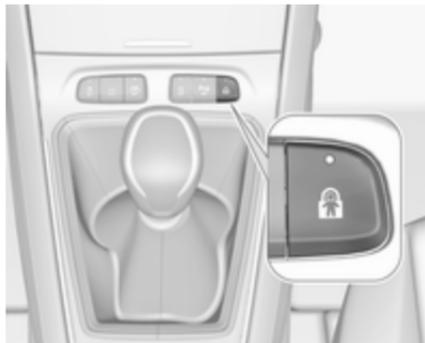
Système commandé à distance pour éviter l'ouverture des portes arrière au moyen des commandes intérieures et l'utilisation des lève-vitres électriques arrière. La commande se trouve sur la console centrale devant le levier sélecteur.
