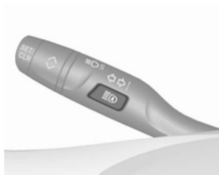
Activer les feux de route automatiques en appuyant sur  $\text{Ⓜ}$ , sur le levier de changement de direction et de voie. La diode du bouton s'allume si les feux de route automatiques sont activés. Les feux de route s'allument automatiquement à une vitesse supérieure à 25 km/h. Les feux de route s'éteignent à une vitesse inférieure à 15 km/h, mais les feux de route automatiques restent actifs.
