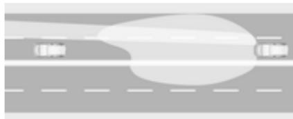
Les feux de route automatiques comprennent un mode pour autoroute spécial. En cas de circulation à plus de 115 km/h sur autoroute, le faisceau lumineux se raccourcit pour ne pas éblouir la circulation en sens inverse. Derrière des véhicules ou avec des véhicules de face, le reflet éblouissant des rétroviseurs de ces véhicules est réduit.
