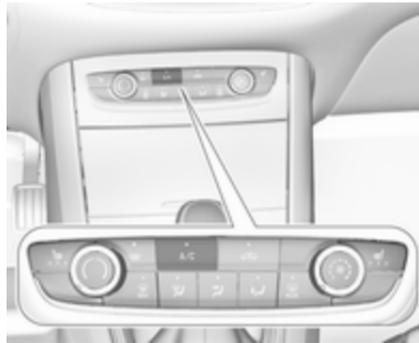
Appuyer sur **A/C** pour mettre le refroidissement en marche. L'activation est signalée par l'allumage de la diode du bouton. Le refroidissement ne fonctionne que lorsque le moteur est en marche et que le ventilateur de commande de climatisation est en fonction.
