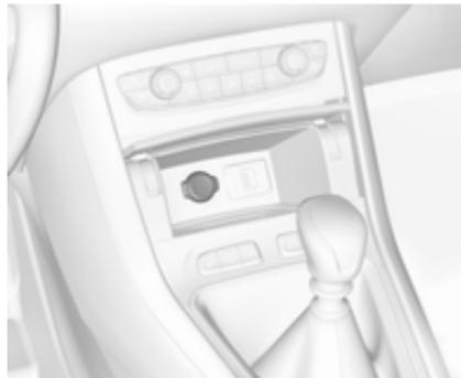
Une prise de courant 12 Volts est située derrière le couvercle de rangement sous les commandes de climatisation. Appuyer sur le couvercle pour l'ouvrir.
