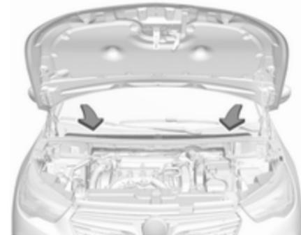
La prise d'air dans le compartiment moteur, à l'extérieur devant le pare-brise, ne doit pas être encombrée. Le cas échéant, enlever les feuilles, les saletés ou la neige.
