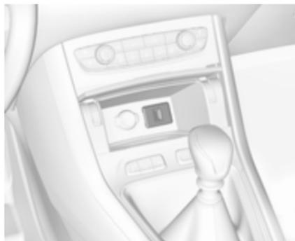
Un port USB est situé derrière le couvercle de rangement au-dessous des commandes de climatisation. Appuyer sur le couvercle pour l'ouvrir.
