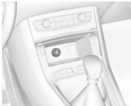
L'allume-cigares est situé derrière le couvercle du rangement au-dessous des commandes de climatisation. Appuyer sur le couvercle pour l'ouvrir. Appuyer sur l'allume-cigares. Il s'éteint automatiquement lorsque la résistance est incandescente. Retirer l'allume-cigares.
