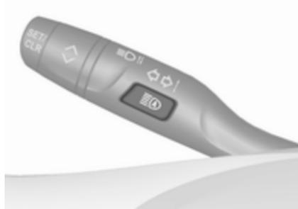
Activer les feux de route automatiques en appuyant sur
