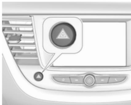
Pour les enclencher, appuyer sur
