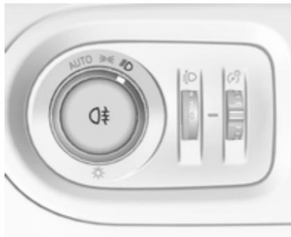
Pour les enclencher, appuyer sur
