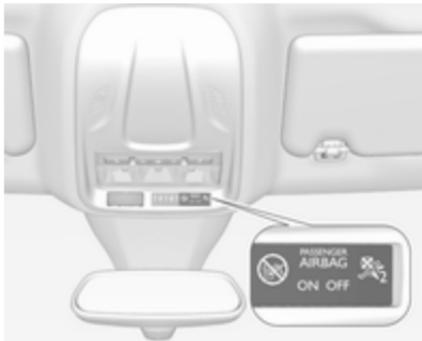
Si le témoin
