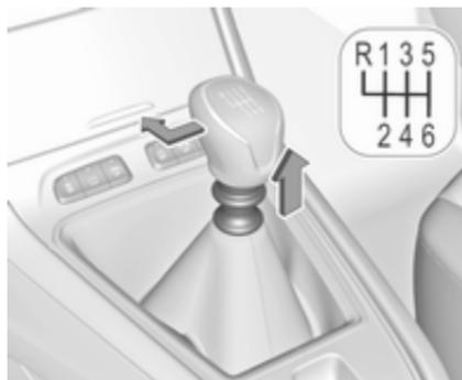
Pour engager la marche arrière d'une boîte de vitesses à 6 rapports, enfoncer la pédale d'embrayage, tirer sur l'anneau sous le levier sélecteur et déplacer le levier sélecteur complètement vers la gauche et l'avant.
