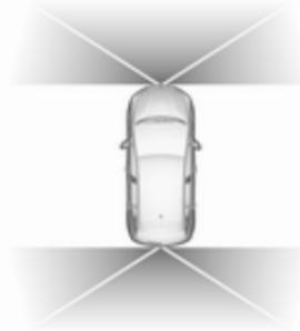
La vue à 180° facilite le recul hors d'un emplacement de stationnement, rendant possible d'observer l'approche des véhicules, des piétons et des cyclistes. Cette vue n'est pas recommandée pour une manœuvre complète. Ceci se compose de trois
