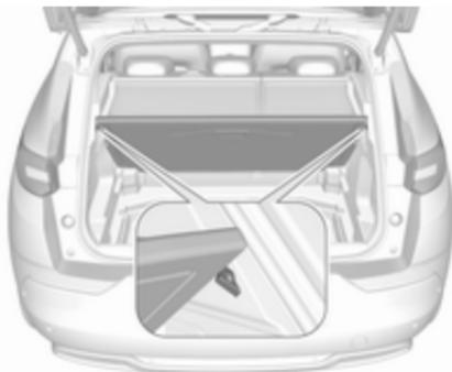
Pour maintenir le cache-bagages en position verticale, le soulever au-delà des butées rétractables.
