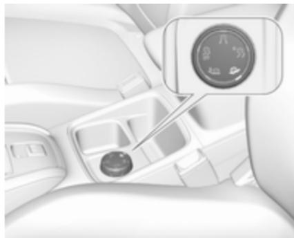
Ce mode permet de laisser considérablement patiner au démarrage la roue ayant la plus faible d'adhérence, ce qui permet à la force centrifuge d'éliminer la boue et ainsi de rétablir la traction.
