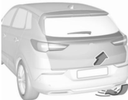
Pour ouvrir ou fermer le hayon, avancer et reculer le pied sous le pare-chocs arrière dans la zone au-dessous de la plaque d'immatriculation (voir l'illustration). La clé doit être dans une plage de distance d'un mètre. Si le véhicule est équipé de l'aide au stationnement, cette zone est reconnaissable sous le capteur indiqué. Ne pas laisser le pied trop longtemps ou le bouger trop lentement sous le pare-chocs. La clé élec-
