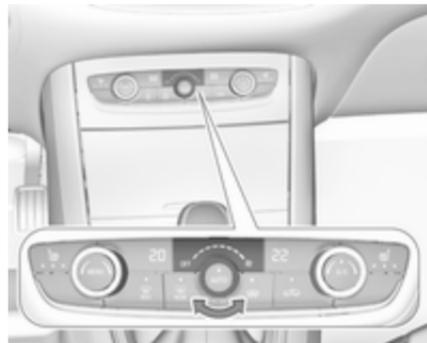
Régler le débit d'air en tournant le bouton rotatif sur la vitesse souhaitée. Faire tourner vers la gauche pour diminuer ou vers la droite pour augmenter. La vitesse de la soufflerie peut également être modifiée grâce aux boutons tactiles sur l'affichage des paramètres de la climatisation. Appuyer sur **MENU** pour accéder au menu.
