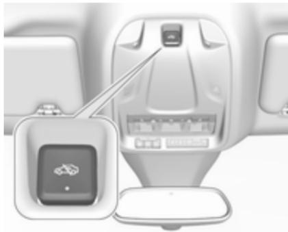
Arrêter la surveillance de l'habitacle et de l'inclinaison du véhicule quand des personnes ou des animaux restent dans le véhicule, en raison de la grande quantité de signaux ultrasoniques et de leurs mouvements déclenchant l'alarme. La désactiver également quand le véhicule est à bord d'un ferry ou d'un train.
