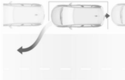
Se déplacer d'avant en arrière tout en observant les avertissements de l'aide au stationnement jusqu'à ce que la fin de la manœuvre soit indiquée. La manœuvre est terminée lorsque les roues avant du véhicule sont hors de l'emplacement de stationnement.
