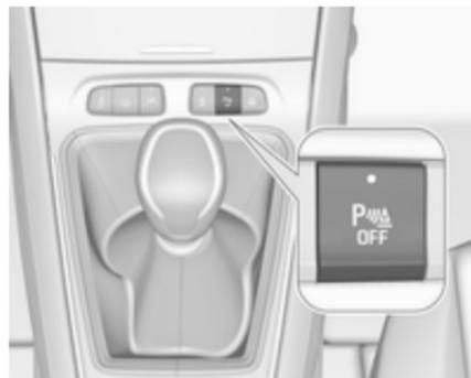
Le système est prêt à fonctionner lorsque la diode du bouton d'aide au stationnement <sup>P</sup> OFF est allumée.
