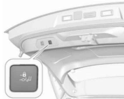
Appuyer sur le bouton
