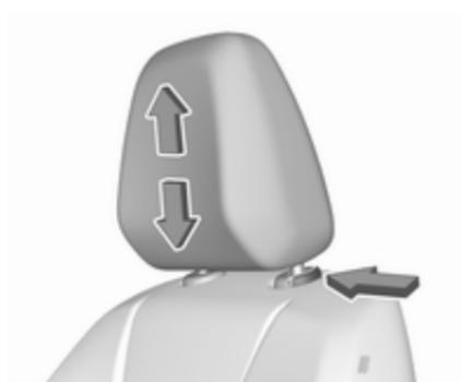
Appuyer sur le bouton de déverrouillage, régler la hauteur, verrouiller.
