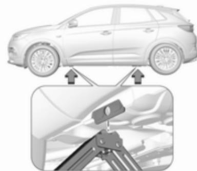
3. Vérifier que le cric est bien positionné sous le point de levage adéquat.
