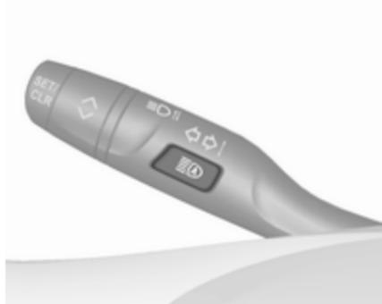
Activer les feux de route automatiques en pressant
