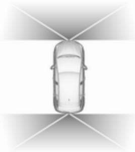
La vue à 180° facilite le recul hors d'un emplacement de stationnement, rendant possible d'observer l'approche des véhicules, des piétons et des cyclistes. Cette vue n'est pas recommandée pour une manœuvre complète. Ceci se compose de trois zones : gauche 1, centre 2 et droite 3. Cette vue est disponible uniquement depuis le menu de sélection de vue.
