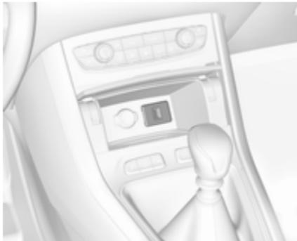
Un port USB se trouve derrière le couvercle de rangement. Appuyer sur le couvercle pour l'ouvrir.
