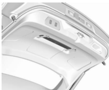
Ranger le triangle de présignalisation dans l'espace sur l'intérieur du hayon et le fixer au moyen de la bande Velcro®.
