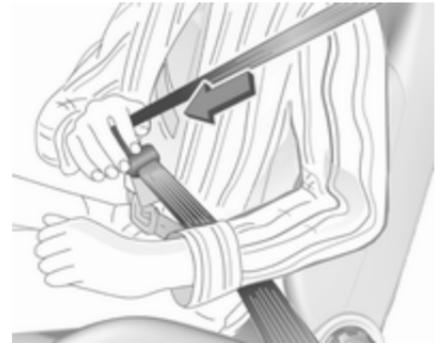
Tirer la ceinture hors de l'enrouleur, la guider sur le corps sans la vriller et insérer le verrou plat dans la serrure. En roulant, tendre régulièrement la sangle abdominale en tirant sur la sangle thoracique.
