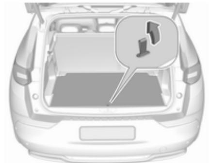
Le recouvrement de plancher arrière peut être soulevé et déposé. Soulever le couvercle au niveau de la boucle et l'enlever.
