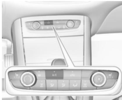
Appuyer sur **A/C** pour mettre le refroidissement en marche. L'activation est signalée par l'allumage de la diode du bouton. Le refroidissement ne fonctionne que lorsque le moteur est en marche et que la soufflerie est allumée.
