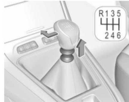
Pour engager la marche arrière d'une boîte de vitesses à 6 rapports, enfoncer la pédale d'embrayage, tirer sur l'anneau sous le levier sélecteur et déplacer le levier sélecteur complètement vers la gauche et l'avant.
