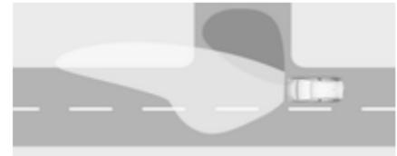
Activé à une vitesse jusqu'à 40 km/h lors de la mise hors tension. L'éclairage se compose de diodes particulières qui éclairent dans le sens du trajet. Ces diodes sont déclenchées en fonction de l'angle du volant ou de l'activation des feux de direction.
