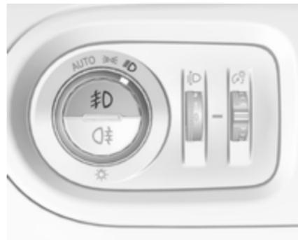
Pour les enclencher, appuyer sur
