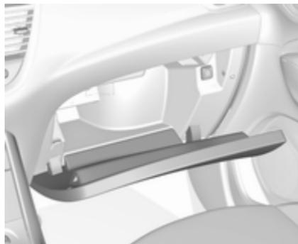
Sur certaines versions, la boîte à gants est ventilée. La ventilation et la température dépendent des réglages du système de commande de climatisation. La bouche d'air de la boîte à gants peut être fermée ⇨ 136.
