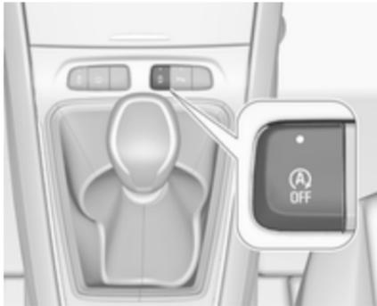
Pour désactiver le système Stop/Start manuellement, appuyer sur
