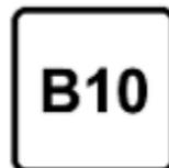
Carburant diesel conforme à la norme EN16734 mélangé à un biocarburant conforme à la norme EN14214 (pouvant contenir jusqu'à 10 % d'ester méthylique d'acide gras).
