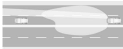
Les feux de route automatiques comprennent un mode pour autoroute spécial. En cas de circulation à plus de 115 km/h sur autoroute, le faisceau lumineux se raccourcit pour ne pas éblouir la circulation en sens inverse. Lorsque vous suivez des véhicules en avant ou de passage, l'éblouissement pour ces véhicules est réduit.
