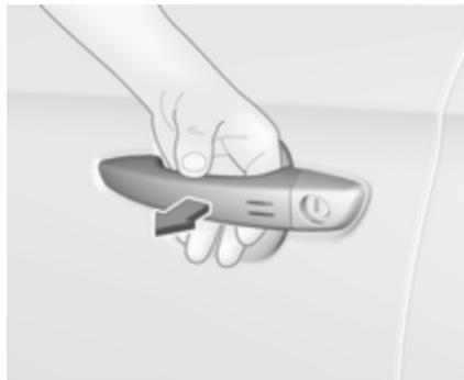
Passer la main derrière la poignée de porte d'une porte avant pour déverrouiller le véhicule ou appuyer sur le bouton du hayon.
