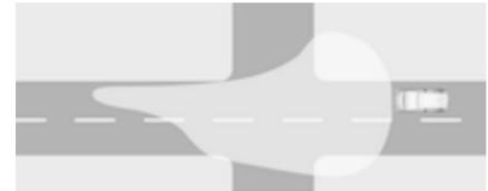
Activés automatiquement à une vitesse maximale d'environ 55 km/h et en cas de lumière ambiante extérieure. Le faisceau lumineux est large et symétrique. Si la vitesse est inférieure à 30 km/h, les phares pivotent légèrement vers l'extérieur pour permettre une reconnaissance plus précoce des piétons et des objets de chaque côté de la route. Un type spécial de faisceau lumineux permet d'éviter d'éblouir les autres usagers de la route.
