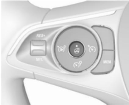
Activer le chauffage en appuyant sur
