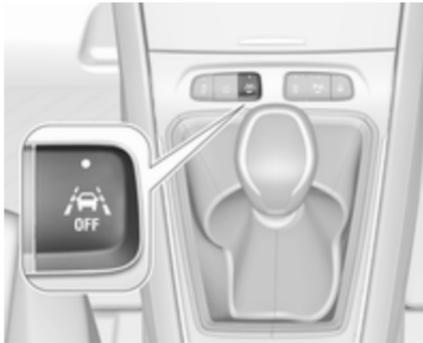
Si le système est activé, la LED intégrée au bouton
