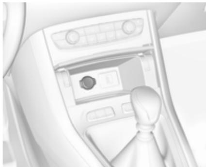
Une prise de courant 12 V se trouve derrière le couvercle de rangement. Appuyer sur le couvercle pour l'ouvrir.
