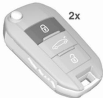
Appuyer deux fois sur le bouton 🔒 de la télécommande radio en 5 secondes.
