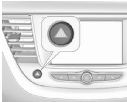
Pour les enclencher, appuyer sur
