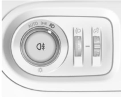
Pour les enclencher, appuyer sur
