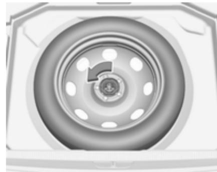
La roue de secours se trouve dans le coffre, sous le recouvrement de plancher.
