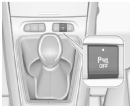
Le système est désactivé lorsque la marche arrière est désengagée. Appuyer sur  $\text{P OFF}$  pour désactiver manuellement le système. La diode du bouton s'allume lorsque le système est désactivé. Si le système a été désactivé manuellement, il n'est pas réactivé automatiquement lors de la suivante mise du contact du véhicule.
