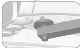
Position de centrage du bras porteur avant du pont élévateur sous le point de levage du véhicule.
