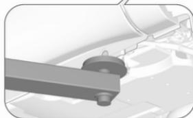
Position de centrage du bras porteur arrière du pont élévateur sous le point de levage du véhicule.
