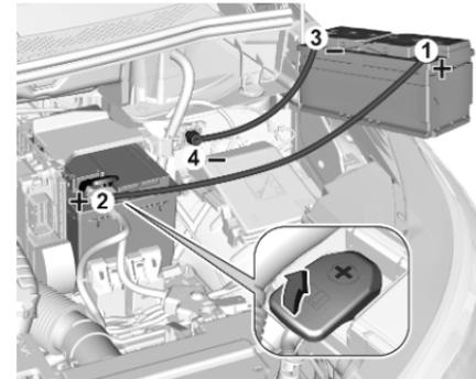
Ouvrir les capuchons de protection de borne positive des deux batteries de véhicule.
