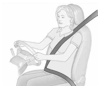
Tirer la ceinture de sécurité et l'attacher dans la boucle de la ceinture de sécurité. La ceinture de sécurité ne doit pas être vrillée et doit être placée près du corps. Le dossier ne doit pas être incliné trop en arrière (environ 25° maximum).
