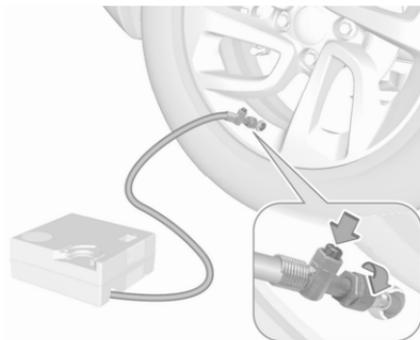
16. Reprendre la route sans délai afin que le produit d'étanchéité se répartisse uniformément dans le pneu. Après un trajet d'environ 5 km (mais pas plus de 10 minutes), s'arrêter et contrôler la pression du pneu. À cet effet, visser directement le flexible d'air sur la valve du pneu. Remplir le pneu comme décrit plus haut. Réduire l'excédent de pression de pneu au moyen du bouton du flexible pneumatique.
