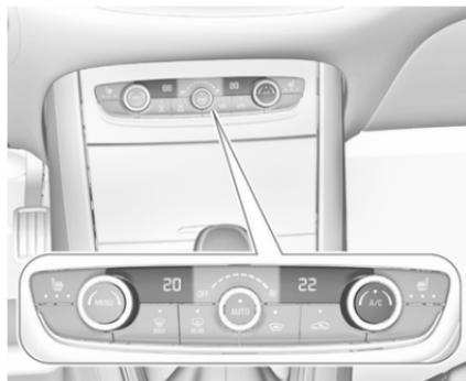
Appuyer sur **A/C** pour mettre le refroidissement en marche. L'activation est signalée par l'éclairage de la LED dans le bouton. Le refroidissement ne
