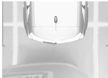
La caméra enregistre les environs du véhicule pendant la manœuvre pour reconstruire une vue depuis le haut de l'arrière ou de l'avant du véhicule dans son environnement proche. Le véhicule peut alors être manœuvré autour des obstacles proches. Cette
