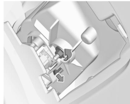
2. Desserrer l'écrou de fixation du feu à l'aide d'une clé à douille ou d'une douille.
