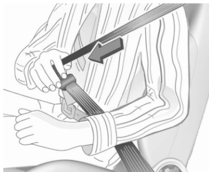
Tirer la ceinture de sécurité hors de l'enrouleur, la guider sur le corps sans la vriller et insérer la languette de verrouillage dans la boucle. En roulant, tendre régulièrement la sangle abdominale en tirant sur la sangle thoracique.
