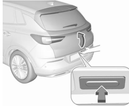
Pour ouvrir le hayon, presser le bouton du hayon jusqu'à ce que le hayon commence à se déplacer. Si le véhicule est verrouillé, la clé électronique doit se trouver à l'extérieur du véhicule dans un rayon d'environ 1 m du hayon.
