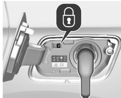
En cours de chargement, la prise du véhicule est verrouillée sur la prise de charge et ne peut être débranchée pendant le chargement. L'indicateur
