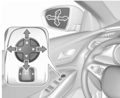
Sélectionner le rétroviseur extérieur concerné en appuyant sur le bouton de rétroviseur vers la gauche ou la droite. Régler le rétroviseur correspondant avec la commande à quatre voies.
