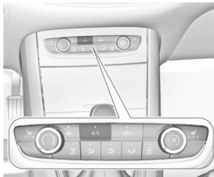
Appuyer sur **A/C** pour mettre le refroidissement en marche. L'activation est signalée par l'éclairage de la LED dans le bouton. Le refroidissement ne fonctionne que lorsque le moteur est en marche et que la soufflerie est allumée.
