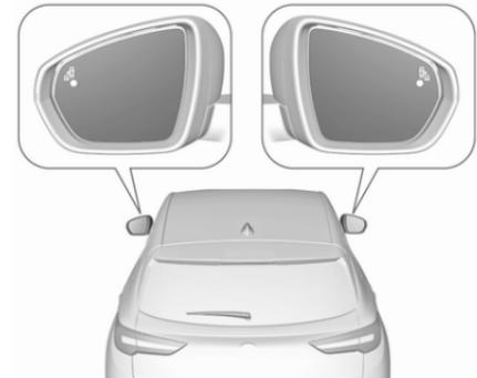
Lorsque le système détecte un véhicule dans la zone aveugle en roulant en avant, une diode s'allume dans le rétroviseur concerné.
