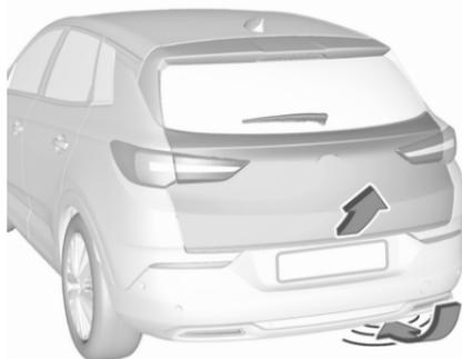
Pour ouvrir ou fermer le hayon, avancer et reculer le pied sous le pare-chocs arrière dans la zone au-dessous de la plaque d'immatriculation. Ne pas laisser le pied trop longtemps ou le bouger trop lentement sous le pare-chocs. La clé électronique doit se trouver à l'extérieur du véhicule dans un rayon d'environ 1 m du hayon.
