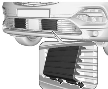
2. Appuyer sur la partie inférieure de la housse de protection contre la lamelle de la grille. S'assurer que la housse de protection est solidement fixée.
