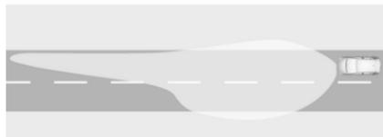
Activés automatiquement à une vitesse comprise entre 55 km/h et 115 km/h en conduisant dans des zones rurales. L'éclairage de la voie et du bas-côté est amélioré. Les véhicules qui arrivent et qui précèdent ne sont pas éblouis.
