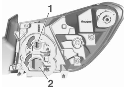
7. Séparer l'ampoule de la douille d'ampoule et remplacer l'ampoule.
