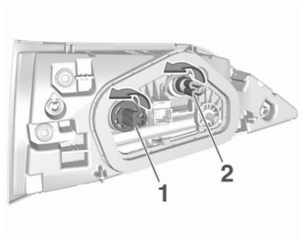
6. Tourner la douille d'ampoule dans le sens antihoraire et l'enlever du bloc optique.
