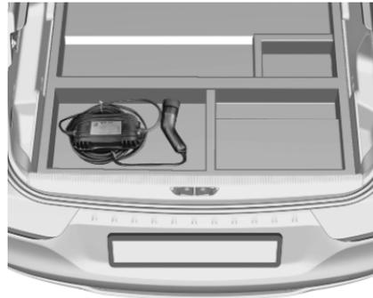
Un cordon de chargement portatif destiné à charger la batterie haute tension du véhicule est rangé sous le recouvrement des rangements dans le plancher arrière dans le coffre ⇨ 213. Le cordon de chargement est compatible avec les prises électriques domestiques du pays corres-
