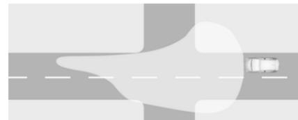
Activés automatiquement à une vitesse maximale d'environ 55 km/h et en cas de lumière ambiante extérieure. Le faisceau lumineux est large et symétrique. Si la vitesse est inférieure à 30 km/h, les phares pivotent légèrement vers l'extérieur pour permettre une reconnaissance plus précoce des piétons et des objets de chaque côté de la route. Un type
