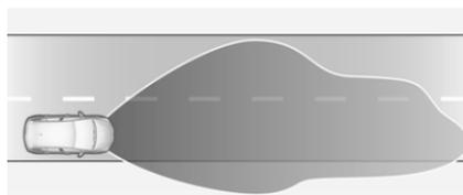
Activés automatiquement à une vitesse supérieure à 115 km/h. L'éclairage est adapté à la vitesse de conduite plus élevée sur autoroutes. Si aucun véhicule ne circule en sens inverse, la visibilité latérale du véhicule est augmentée. La plage de visibilité augmente de 70 m à 140 m, ce qui permet de reconnaître les objets éloignés sur toute la largeur de la route.
