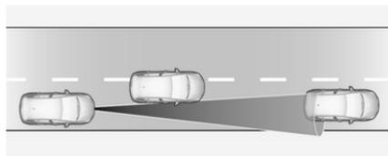
Si un autre véhicule entre dans la même voie de circulation, le régulateur de vitesse adaptatif considérera le véhicule lorsqu'il est complètement sur votre voie. Être prêt à agir et enfoncer la pédale de frein, si un freinage plus rapide est nécessaire.
