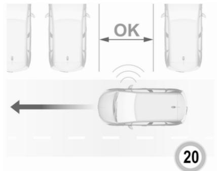
Lorsqu'un emplacement libre est détecté, une information visuelle en retour apparaît sur l'affichage d'informations et un signal sonore est émis. Arrêter le véhicule, sélectionner la marche arrière, lâcher le volant de direction et commencer à se déplacer sans dépasser 7 km/h.
