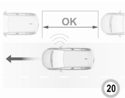
Lorsqu'un emplacement libre est détecté, une information visuelle en retour apparaît sur l'affichage d'informations et un premier signal sonore est émis. Rouler lentement en avant. Lorsque le second signal sonore retentit, arrêter le véhicule, sélectionner la marche arrière, lâcher le volant de direction et commencer à se déplacer doucement. Une rétroaction visuelle est transmise dans l'affichage d'informations.
