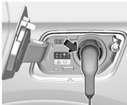
Le début du chargement est indiqué par le clignotement en vert de l'indicateur d'état sur la prise de charge et sur le boîtier de commande du cordon de chargement.
