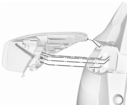
5. De l'extérieur, déloger soigneusement le bloc optique de l'évidement et l'extraire. Veiller à ce que la goulotte de câbles reste en place.
