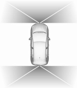
La vue à 180° facilite le recul hors d'un emplacement de stationnement, rendant possible d'observer l'approche des véhicules, des piétons et des cyclistes. Cette vue n'est pas recommandée pour une manœuvre complète. Ceci se compose de trois zones : gauche 1, centre 2 et droite 3. Cette vue est disponible uniquement depuis le menu de sélection de vue.
