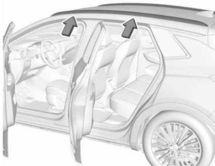
Fixer la galerie de toit dans les rails de toit au-dessus des points de montage situés dans chaque encadrement de porte de la carrosserie du véhicule.
