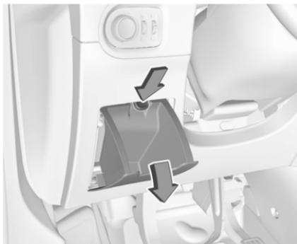
Dans les véhicules avec direction à gauche, la boîte à fusibles se trouve derrière un cache du tableau de bord du côté gauche. Ouvrir le couvercle et le déposer en pressant le verrou.
