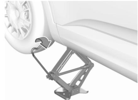
Quand le cric est bien aligné, tourner la clé à écrou de roue jusqu'à ce que la roue ne touche plus le sol.
