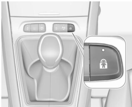
Système commandé à distance pour éviter l'ouverture des portes arrière au moyen des manettes intérieures de porte et l'utilisation des lève-vitres électriques arrière.
