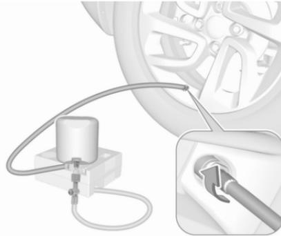
7. Visser le flexible de remplissage sur la valve de pneu.
