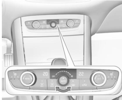
Régler le débit d'air en faisant tourner la bague rotative sur la vitesse souhaitée. Tourner dans le sens antihoraire pour diminuer et dans le sens horaire pour augmenter. Le régime du ventilateur peut également être modifié au menu des réglages de climatisation. Appuyer sur **MENU** pour accéder au menu.
