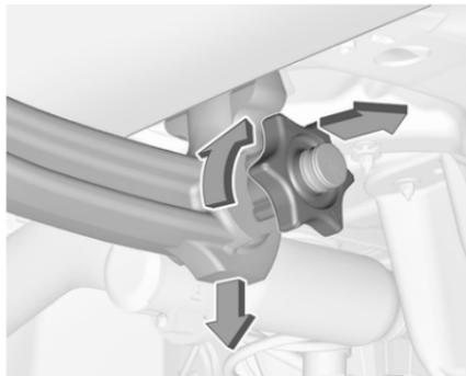
Ouvrir le volet de protection et tourner la clé en position
