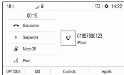
Pour réduire au silence le microphone de l'Infotainment System, effleurer **Micro Off**.
