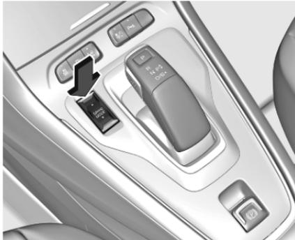
Le mode de transmission intégrale peut être activé à l'aide du commutateur de mode de conduite. L'activa-
