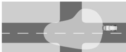
Activés automatiquement à une vitesse allant jusqu'à environ 50 km/h. Le faisceau a une forme large pour éviter d'éblouir la circulation venant en sens inverse.
