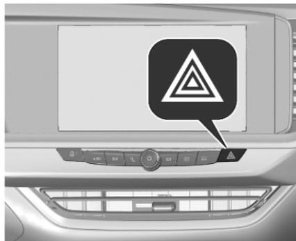
Pour les enclencher, appuyer sur
