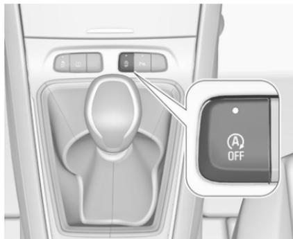
Pour désactiver le système Stop/Start manuellement, appuyer sur
