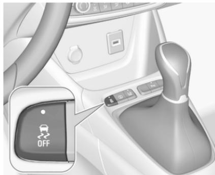
L'ESC et le système antipatinage peuvent être désactivés, si nécessaire : appuyer sur
