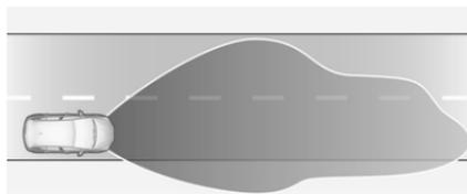
Activé automatiquement à une vitesse supérieure à 50 km/h en conduisant dans des zones rurales. L'éclairage de la voie et du bas-côté est adapté. Les véhicules qui arrivent et qui précèdent ne sont pas éblouis.
