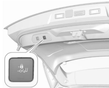
Appuyer sur le bouton
