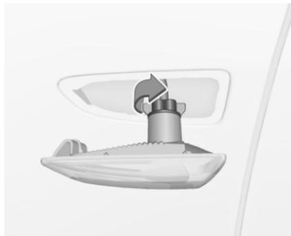
2. Tourner la douille d'ampoule dans le sens horaire et la retirer de l'ensemble de feu.
