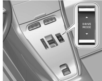
Pour sélectionner le mode d'entraînement correspondant, utiliser le sélecteur de mode d'entraînement. Le mode d'entraînement sélectionné est indiqué dans le centre d'informations du conducteur et dans l'affichage d'informations.
