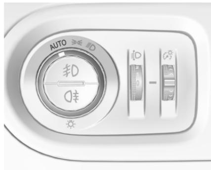
Si la fonction de commande automatique des feux est activée et que le moteur tourne, le système bascule automatiquement entre les feux de jour et les phares en fonction des
