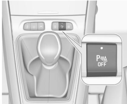
Selon la version, le système est prêt à fonctionner lorsque la LED du bouton d'aide au stationnement  $P_{OFF}$  n'est pas allumée. L'état du système est mémorisé lorsque le contact est coupé.
