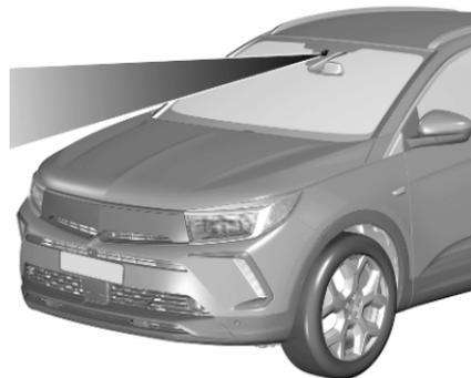
Le système activé repère les marquages de la voie à l'aide de la caméra placée en haut du pare-brise. Il dirige le véhicule à l'intérieur de la voie détectée. Le conducteur remarque un mouvement de rotation du volant.
