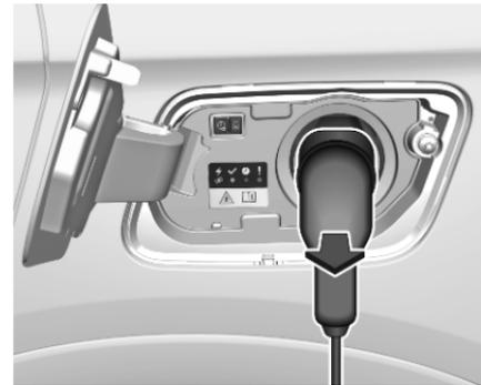
2. Débrancher du port de chargement la fiche côté véhicule du câble de chargement dans les 30 secondes suivant le déverrouillage.
