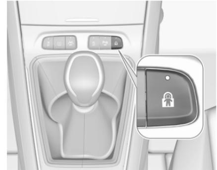
Système commandé à distance pour éviter l'ouverture des portes arrière au moyen des manettes intérieures de porte et l'utilisation des lève-vitres électriques arrière.
