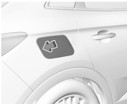
La trappe de réservoir ne peut être ouverte que si le véhicule est déverrouillé. Ouvrir la trappe à carburant en poussant sur la trappe.
