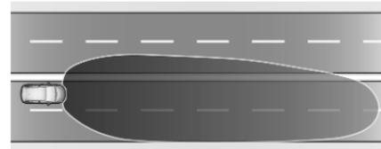
Activé automatiquement à une vitesse supérieure à 105 km/h. L'éclairage est adapté à la vitesse de conduite plus élevée sur autoroutes. Si aucun véhicule ne circule en sens inverse, la visibilité latérale du véhicule est augmentée. Lorsque vous suivez des véhicules en avant ou de passage, l'éblouissement pour ces véhicules est réduit.
