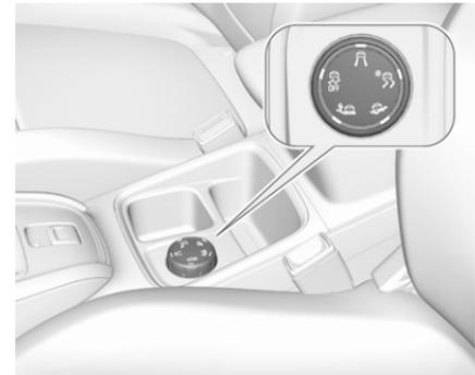
La commande de suspension sélective permet de choisir entre cinq modes de conduite en tournant la commande :
