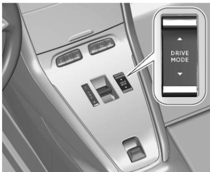
Pour sélectionner le mode d'entraînement correspondant, utiliser le sélecteur de mode d'entraînement. Le mode d'entraînement sélectionné est indiqué dans le centre d'informations du conducteur et dans l'affichage d'informations. La sélection d'un mode de conduite n'est possible que si **READY** est affiché dans le centre d'informations du conducteur.
