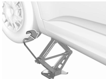
Quand le cric est correctement aligné, soulever le véhicule jusqu'à ce que la roue ne touche plus le sol.
