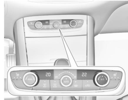
Appuyer sur **A/C** pour mettre le refroidissement en marche. L'activation est signalée par l'éclairage de la LED dans le bouton. Le refroidissement ne fonctionne que lorsque le moteur est en marche et que la soufflerie de la climatisation est allumée.
