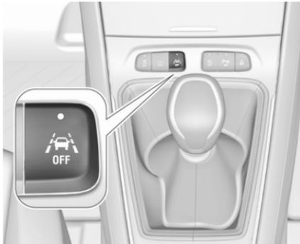
Selon la version, le système est automatiquement activé lorsque le contact est mis. Si le système est activé, la LED du bouton
