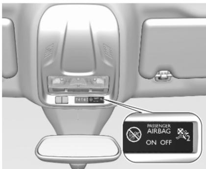
Si le témoin
