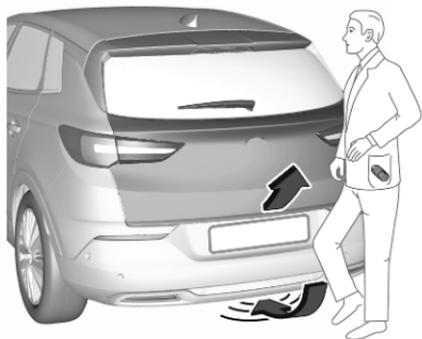
Pour ouvrir ou fermer le hayon, bouger le pied dans la zone centrale sous le pare-chocs arrière rapidement, d'avant en arrière. Ne pas laisser le pied sous le pare-chocs. La clé électronique doit se trouver à l'extérieur du véhicule dans un rayon d'environ 1 m du hayon. Lorsque le capteur détecte un mouvement du pied, le système actionne le hayon après un court instant.
