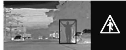
Si une collision est imminente, l'objet détecté est affiché dans un cadre rouge et un symbole d'alerte est déclenché.
