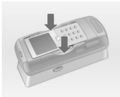
Avec les consoles de l'adaptateur ouvertes, insérez le téléphone mobile verticalement dans l'adaptateur comme indiqué sur l'illustration ci-dessus jusqu'à ce que les consoles latérales s'engagent.
