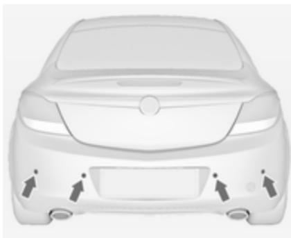
L'aide au stationnement facilite les manœuvres en mesurant la distance entre le véhicule et les obstacles et en émettant des signaux sonores. C'est toutefois le conducteur qui reste pleinement responsable de la manœuvre de stationnement.
