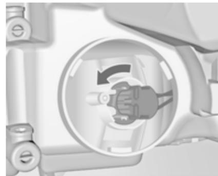
2. Faire tourner le support d'ampoule dans le sens antihoraire pour le désencliquer. Retirer le support d'ampoule du réflecteur.
