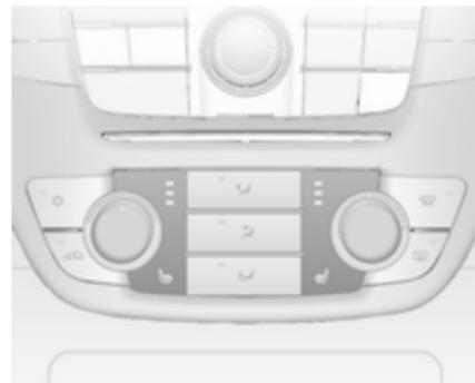
En fonction du niveau de chauffage voulu, appuyer une ou plusieurs fois sur le bouton
