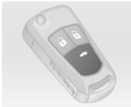
Le contact étant coupé, appuyer sur le bouton
