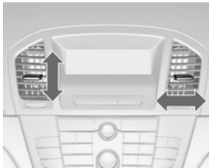
Régler la direction du flux d'air en faisant basculer et pivoter les lamelles. Pour fermer une bouche d'aération, tourner la molette sur O.
