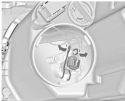
3. Dégager vers l'avant l'étrier en fil ressort en le sortant de l'attache et le basculer vers le bas.
