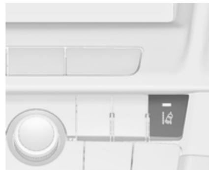
Quand le système détecte un changement de file inattendu, le témoin
