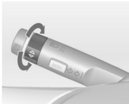
Les panneaux routiers sont affichés sur la page **Détection des panneaux routiers** dans le **Menu informations trajet/carbur.**, en sélectionnant avec la roue moletée de la manette des clignotants ↻ 96.
