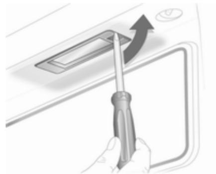
1. Introduire le tournevis dans le boîtier de l'ampoule ; appuyer sur le côté et déverrouiller le ressort.
