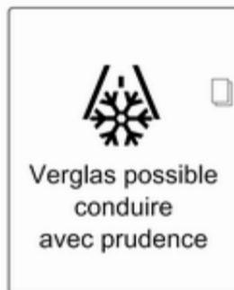
Si la température extérieure chute de 3 °C, un message d'avertissement est affiché sur le centre d'informations du conducteur avec affichage de niveau supérieur.
