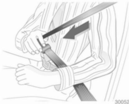
Tirer la ceinture hors de l'enrouleur, la guider sur le corps sans la vriller et insérer le verrou plat dans la serrure. En roulant, tendre régulièrement la sangle abdominale en tirant sur la sangle thoracique. Rappel de ceinture de sécurité ⇨ 89.
