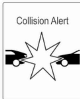
Si vous vous approchez trop rapidement d'un autre véhicule, le symbole d'alerte de collision clignotera dans le centre d'informations du conducteur. En même temps, un signal sonore retentira. Se tenir prêt à actionner les freins si les conditions de roulage l'exigent.
