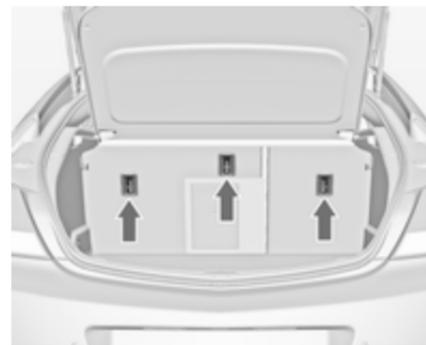
En plus de la fixation ISOFIX, attacher la sangle Top-Tether aux systèmes de sécurité pour enfant Top-Tether. La sangle doit alors passer entre les deux tiges de guidage de l'appuie-tête.
