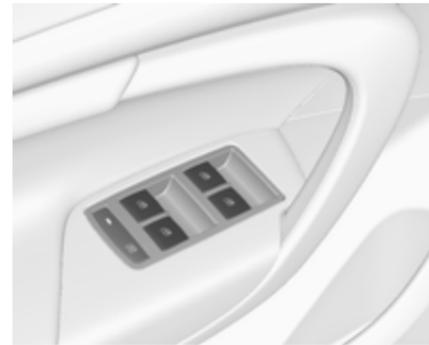
Appuyer sur le commutateur
