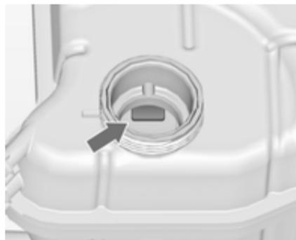
Sur d'autres modèles, le repère du niveau de remplissage se situe à l'intérieur de l'ouverture de remplissage. Pour vérifier, ouvrir le bouchon.
