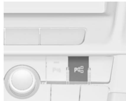
Lors de la recherche d'un emplacement de parking, le système doit être activé en appuyant sur le bouton **P**.
