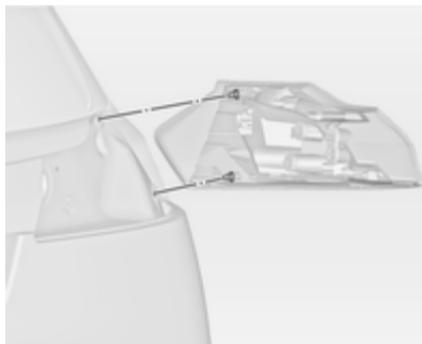
3. Enlever l'ensemble de feu arrière. Veiller à ce que la goulotte de câbles reste en place. Débrancher la fiche de la douille d'ampoule.
