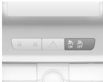
Tant que le témoin
