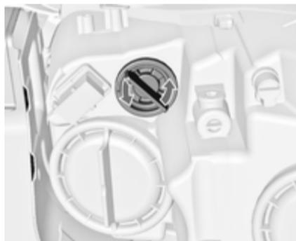
1. Faire tourner le support d'ampoule dans le sens antihoraire et le désencliqueter.
