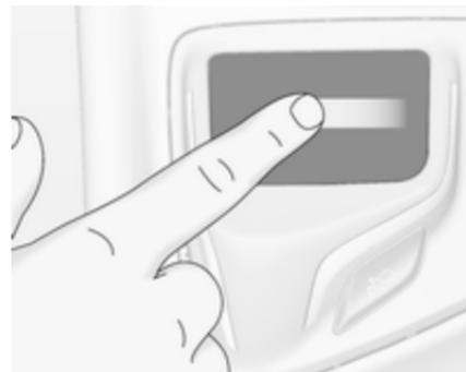
Déplacer votre doigt en direction de l'élément à sélectionner. Le curseur en forme de main se déplace d'un élément d'écran sélectionnable à un autre.
