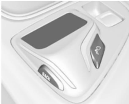
Le pavé tactile est doté d'une surface tactile proposant des fonctions supplémentaires de contrôle des menus sur l'écran central. Il se trouve derrière le levier de vitesses.
