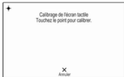
Suivre les instructions à l'écran et taper sur les points indiqués. L'écran tactile est étalonné.
