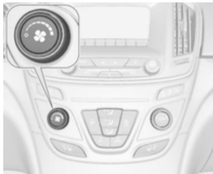
Régler le débit d'air en faisant tourner le contrôleur 🌀 à la position de vitesse désirée. O signifie que le ventilateur est arrêté.
