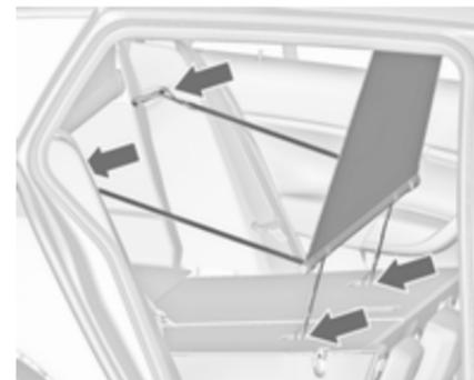
Monter les crochets des petites sangles dans les boucles de fixation Top-Tether sur la face arrière des dossiers rabattus de siège arrière.
