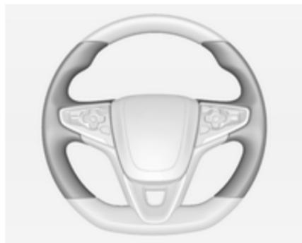
Les zones recommandées pour tenir le volant sont chauffées plus rapidement et à une température plus élevée que le reste du volant.
