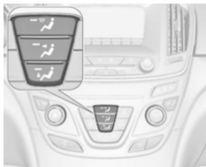
Appuyer sur le bouton correspondant au réglage souhaité. L'activation est signalée par la LED dans le bouton.
