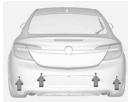
L'aide au stationnement avant-arrière mesure la distance entre le véhicule et les obstacles présents devant et derrière le véhicule. Le système émet des signaux sonores et affiche des messages.
