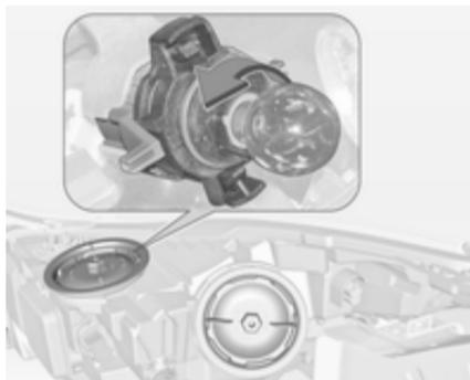
2. Pousser légèrement l'ampoule dans la douille, la tourner dans le sens antihoraire et l'enlever.
