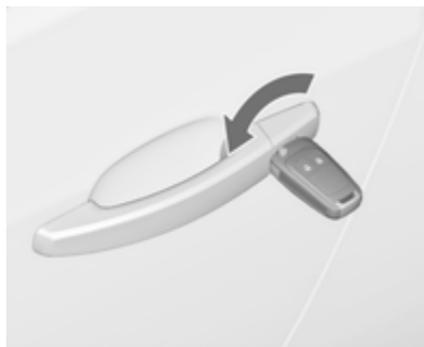
Déverrouiller manuellement la porte du conducteur en tournant la clé dans la serrure. Mettre le contact et appuyer sur le bouton de verrouillage central
