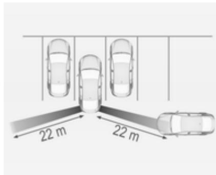
Les capteurs du système couvrent une zone d'environ 20 mètres vers la gauche ou la droite, derrière le véhicule.
