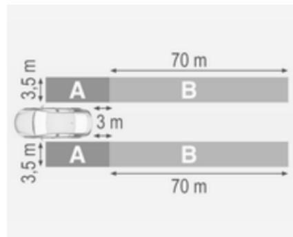
Les capteurs du système couvrent une zone d'environ 3,5 mètres parallèlement sur les côtés du véhicule et environ 3 mètres en arrière par rapport à l'alerte d'angle mort latéral (A) et à environ 70 mètres à l'arrière de la position d'alerte de changement de voie (B) sur les voies parallèles. Les zones commencent à chaque rétroviseur extérieur. La hauteur de la zone est environ entre 0,5 mètre et 2 mètres du sol.
