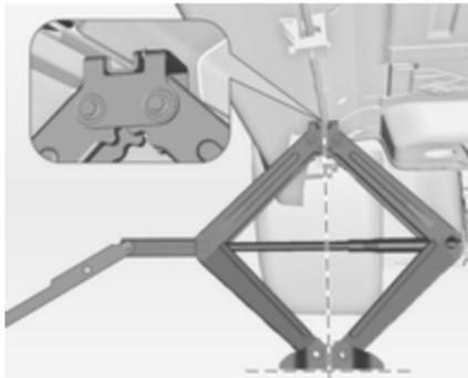
5. Régler le cric à la hauteur nécessaire. Le positionner juste au-dessous du point de levage de manière telle qu'il ne puisse pas glisser.
