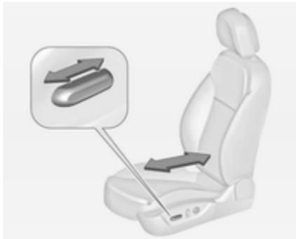
Déplacer l'avant du commutateur vers l'avant / vers l'arrière.
