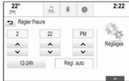
Sélectionner le bouton d'écran Auto Set (réglage automatique) du bas de l'écran. Sélectionner soit le mode On - RDS (RDS actif) ou Off - Manual (inactif - manuel).
