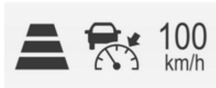
Le symbole de régulateur de vitesse adaptatif, le réglage de la distance vers l'avant et la vitesse réglée sont affichés dans le centre d'informations du conducteur.
