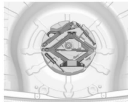
Le cric avec la clé à roue, les outils, le boulon avec une tige plus longue pour fixer une roue endommagée et l'oeillet de remorquage sont rangés dans la boîte à outils sous la roue de secours dans le coffre. Roue de secours ⇨ 274.
