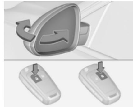
Appuyer à nouveau sur le bouton
