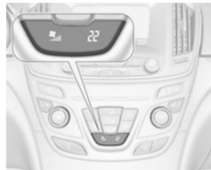
Les réglages de température et de régime de ventilateur sont signalés à l'affichage de climatisation.
