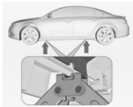
4. Vérifier que le cric est bien positionné sous le point de levage adéquat.
