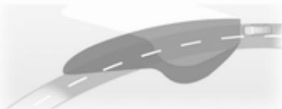
Le faisceau lumineux pivote en fonction de l'angle de braquage du volant et la vitesse, ce qui améliore l'éclairage des virages.
