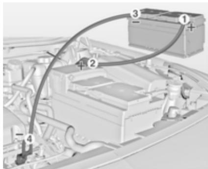
Séquence de raccordement des câbles :
