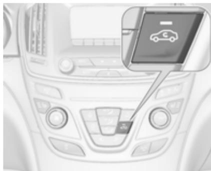
Appuyer sur le bouton
