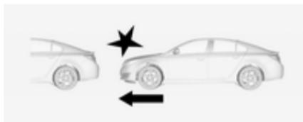
Si un véhicule directement devant est approché trop rapidement, un carillon d'avertissement retentit et une alarme est affichée sur le centre d'informations du conducteur.
