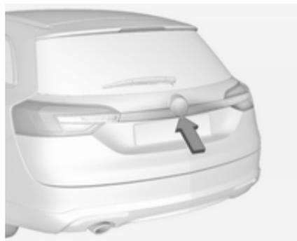
Pour ouvrir le hayon, pousser et maintenir le commutateur tactile sous la moulure de hayon jusqu'à ce que le hayon commence à se déplacer.
