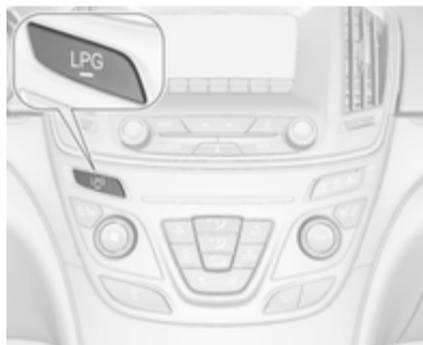
Le bouton **LPG** permet de choisir entre mode essence et mode gaz liquéfié. La diode d'état
