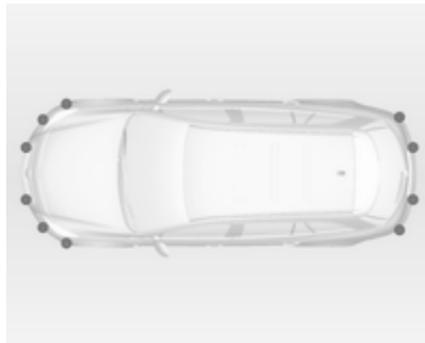
Le système avancé d'assistance au stationnement guide le conducteur dans un emplacement de parking en lui donnant des instructions dans le
