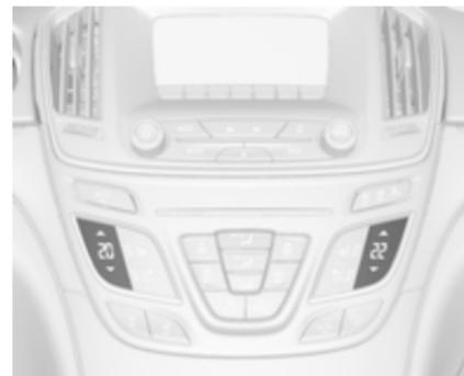
Les réglages de température sont indiqués séparément sur les panneaux pour le conducteur et le passager.
