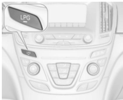
Appuyer sur le bouton **LPG** pour basculer entre les modes de fonctionnement à l'essence et au gaz de pétrole liquéfié dès que les paramètres requis (température de liquide de refroidissement et régime moteur minimal) ont été atteints. Les exigences sont généralement satisfaites environ après 60 secondes (en fonction de la température extérieure) et le premier enfoncement net de la pédale d'accélérateur. La LED indique le mode de fonctionnement en cours.
