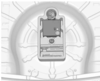
Le kit de réparation des pneus se trouve dans un espace de rangement sous le recouvrement de plancher du coffre.
