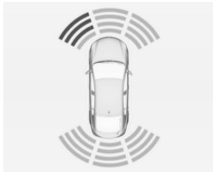
La distance vers l'obstacle avant et arrière est indiquée par des lignes de distance qui se modifient autour du véhicule.
