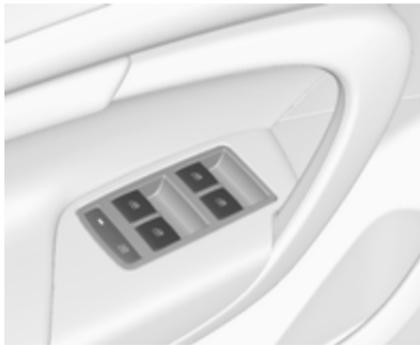
Appuyer sur le commutateur
