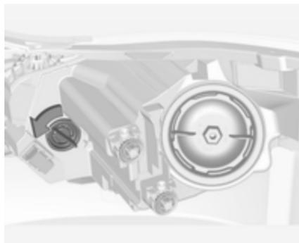
1. Faire tourner la douille de l'ampoule dans le sens antihoraire pour la désengager. Retirer la douille de l'ampoule du boîtier de phare.
