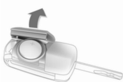
Sortir la clé et ouvrir l'unité. Remplacer la pile (type CR 2032) en faisant attention à la position de montage. Fermer l'unité et la programmer.
