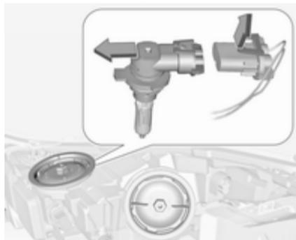
3. Désengager l'ampoule du connecteur en tirant.
