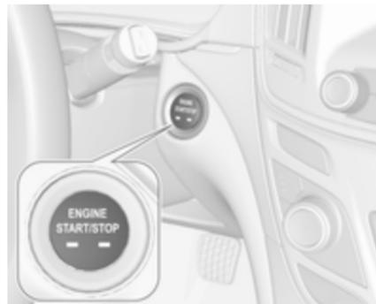
Bouton d'alimentation : appuyer sur le bouton **Engine Start/Stop** et le relâcher.
