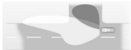
Dans les virages serrés ou lors des changements de direction, en fonction de l'angle de braquage du volant ou des clignotants, un réflecteur sup-
