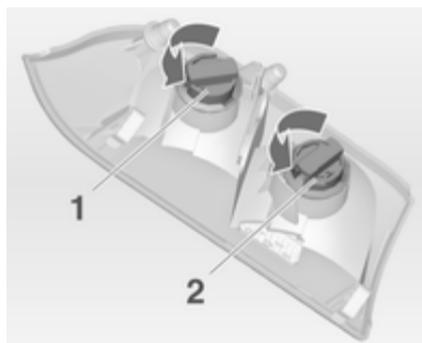
4. Tourner l'écrou en plastique dans le sens antihoraire et l'enlever de la douille de l'ampoule.
