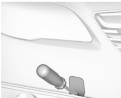
**Country Tourer** : insérer un tournevis dans la fente sur le bord inférieur du capuchon. Dégager le capuchon en enfonçant avec précaution le tournevis vers le bas. Pour éviter tout dégât, il est recommandé de placer un chiffon entre le tournevis et le cadre.
