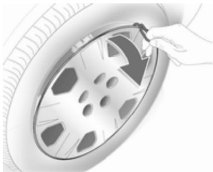
1. Dégager et retirer les capuchons des écrous de roue à l'aide d'un tournevis. Enlever l'enjoliveur à l'aide du crochet. Outillage de bord ↗ 261.
