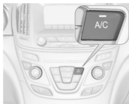
Appuyer sur le bouton **A/C** pour mettre le refroidissement en marche. L'activation est signalée par la LED dans le bouton. Le refroidissement ne fonctionne que lorsque le moteur est en marche et que le ventilateur de commande de climatisation est en fonction.
