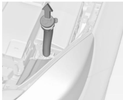
Sur le côté gauche du véhicule, tirer sur le tuyau de remplissage pour l'extraire du réservoir de liquide de lavage avant.
