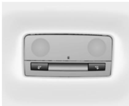
Sur les véhicules avec toit panoramique, les lampes arrière intérieures se trouvent près des poignées arrière.
