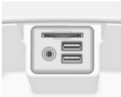
Un logement AUX, USB et carte SD pour la connexion des appareils externes se trouve sous l'accoudoir de la console centrale. Vous trouverez une description détaillée de la marche à suivre pour relever l'accoudoir dans le Manuel du propriétaire.
