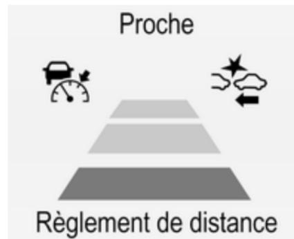
La distance de suivi sélectionnée est indiquée par les barres de distance remplies sur la page du régulateur de vitesse adaptatif.
