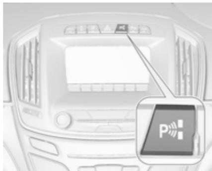
Lors d'une recherche d'un emplacement de stationnement, le système est prêt à fonctionner après un appui sur le bouton
