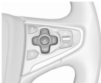
Sur les écrans de niveau médian et supérieur, sélectionner le menu **Info** à l'aide des boutons au volant sur la droite, puis appuyer sur ∨ pour sélectionner **Détection des panneaux routiers** ⇨ 116.
