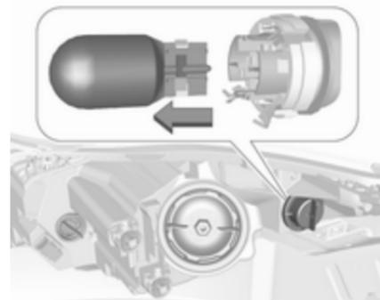
3. Retirer l'ampoule de la douille en tirant.
