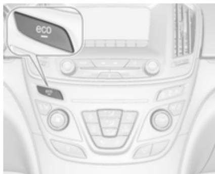
Pour désactiver le système Stop/Start manuellement, appuyer sur **eco**. La désactivation est indiquée par l'extinction de la diode du bouton.
