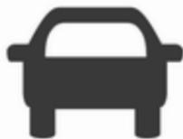
Le témoin de véhicule à l'avant allumé en vert
