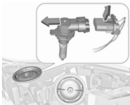
3. Désengager l'ampoule du connecteur en tirant.
