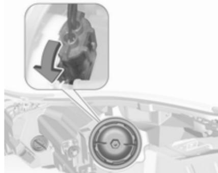
2. Faire tourner la douille de l'ampoule dans le sens antihoraire pour la désencliqueter. Retirer la douille de l'ampoule du réflecteur.
