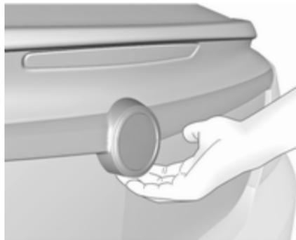
Après le déverrouillage, tirer le bouton sous la moulure du hayon et ouvrir le hayon manuellement.
