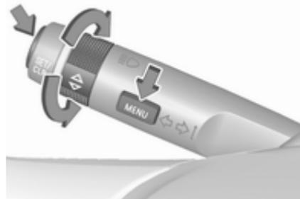
Sur l'écran de base, sélectionner le menu **Réglages** en appuyant sur **MENU** sur le levier des clignotants. Tourner la molette pour sélectionner la page **Durée de vie restante, huile**.
