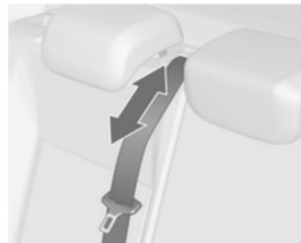
La ceinture de sécurité du siège central peut être bloquée quand le dossier est relevé trop rapidement. Pour débloquer l'enrouleur, rentrer la ceinture de sécurité ou la sortir d'environ 20 mm et relâcher.
