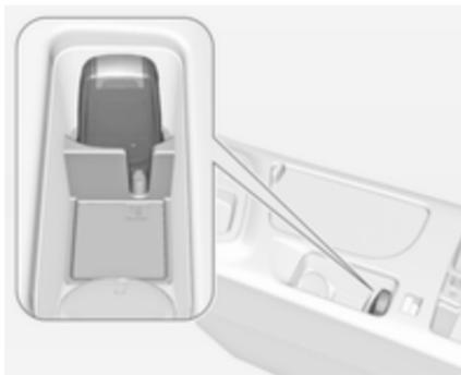
Ouvrir la zone de rangement de la console centrale en levant l'accoudoir. Placer la clé électronique dans la poche d'émetteur. Enfoncer la pédale d'embrayage (boîte manuelle)
