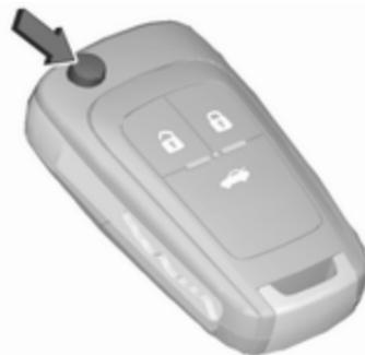
Appuyer sur le bouton pour l'ouvrir. Pour replier la clé, appuyer d'abord sur le bouton.
