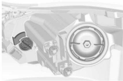
1. Faire tourner la douille de l'ampoule dans le sens antihoraire pour la désencliqueter. Retirer la douille de l'ampoule du boîtier de phare.
