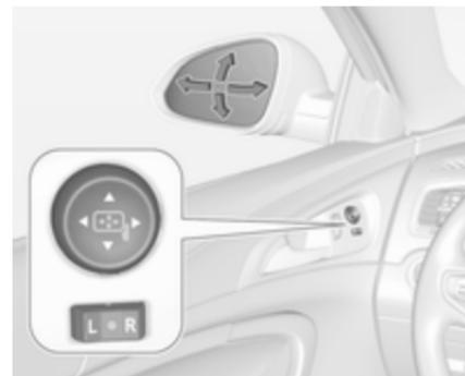
Sélectionner le rétroviseur extérieur souhaité en tournant la commande à gauche (**L**) ou à droite (**R**). Ensuite, régler.
