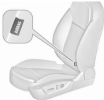
Le système d'airbag latéral se compose d'un airbag dans chacun des dossiers de siège avant et dans les dossiers des sièges arrière extérieurs. Ils sont reconnaissables à l'inscription **AIRBAG**.
