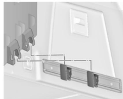
En variante, installer deux crochets dans le rail inférieur. Enficher les consoles inférieures de la boîte dans les crochets inférieurs, depuis le haut.
