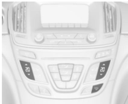
Régler la température désirée en effleurant ▲ pour des températures plus élevées ou ▼ pour des températures plus basses.
