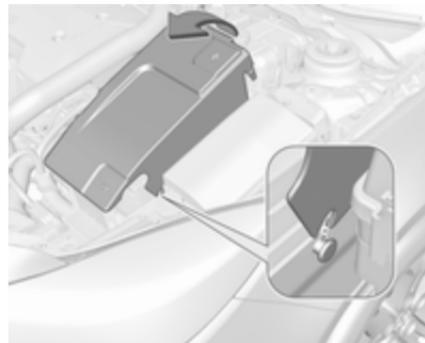
La batterie du véhicule est déchargée. Retirer le couvercle pour remplacer la batterie. Lever le couvercle à l'arrière et le détacher à l'avant.
