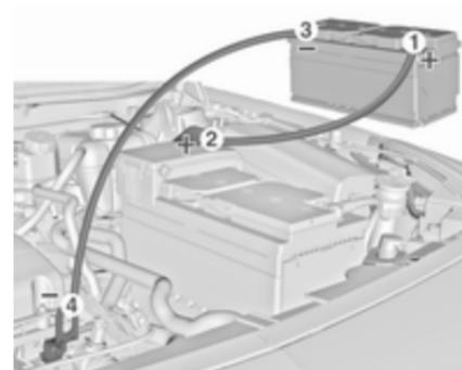
Séquence de raccordement des câbles :
