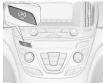
Appuyer sur **LPG** pour basculer entre les modes de fonctionnement à l'essence et au gaz de pétrole liquéfié dès que les paramètres requis (température du liquide de refroidissement, température du gaz et régime moteur minimal) ont été atteints. Les exigences sont généralement satisfaites environ après 60 secondes (en fonction de la température extérieure) et le premier enfoncement net de la pédale d'accélérateur. L'état de la diode indique le mode de fonctionnement en cours.
