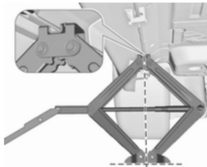
5. Régler le cric à la hauteur requise. Le positionner directement sous le point de levage de manière telle qu'il ne glisse pas.
