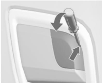
**OPC** : introduire le tournevis dans la fente de l'arrondi supérieur du capuchon. Dégager le capuchon en enfonçant avec précaution le tournevis vers le bas. Pour éviter tout dégât, il est recommandé de placer un chiffon entre le tournevis et le cadre.
