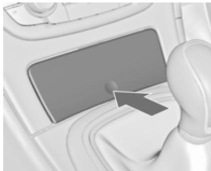
Une boîte de rangement se trouve derrière un couvercle sous la climatisation. Appuyer sur le couvercle pour l'ouvrir.
