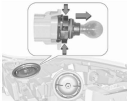
3. Désengager la douille d'ampoule du connecteur en tirant.
