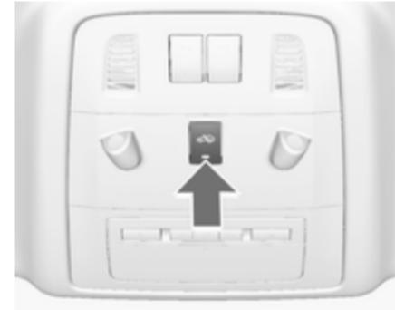
Désactiver la surveillance de l'habitacle et de l'inclinaison du véhicule quand des animaux sont laissés dans le véhicule en raison de la grande quantité de signaux ultrasoniques ou de leurs mouvements déclenchant l'alarme. La désactiver également quand le véhicule est à bord d'un ferry ou d'un train.
