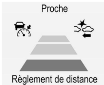
Il est à noter que le réglage de sensibilité de temporisation d'alerte est partagé avec le réglage de la distance de suivi du régulateur de vitesse adaptatif ↪ 193. Donc modifier la sensibilité de la temporisation d'alerte change le réglage de distance de suivi du régulateur de vitesse adaptatif.
