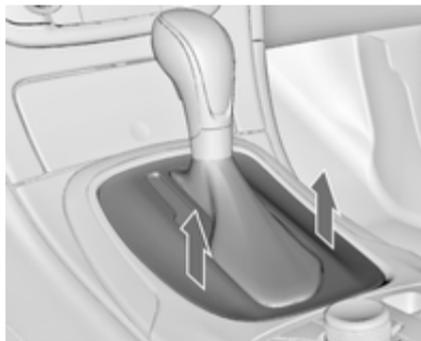
2. Détacher la garniture du levier sélecteur à l'arrière de la console centrale, la replier vers le haut et la faire tourner vers la gauche.
