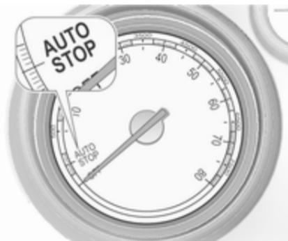
Une fonction Autostop est indiquée par l'aiguille à la position **AUTOSTOP** dans le compte-tours. Sur certaines versions, un témoin du combiné d'instruments s'éclaire lorsque le moteur est en mode d'arrêt automatique.
