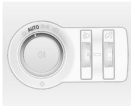
Quand la fonction de commande automatique des feux est activée et que le moteur tourne, le système bascule automatiquement entre les feux de jour et les feux de route/feux de croisement en fonction des conditions d'éclairage et de l'information communiquée par le système de détecteur de pluie.
