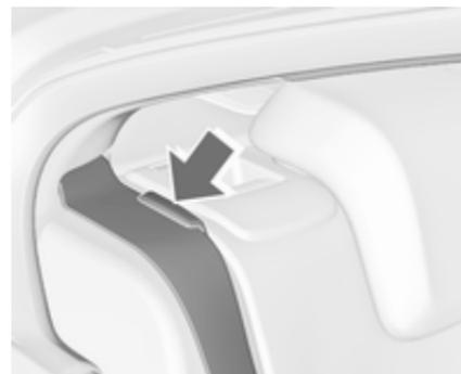
Placer les ceintures de sécurité des sièges extérieurs dans les guides de ceinture.
