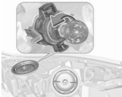
2. Pousser légèrement l'ampoule dans la douille, la tourner dans le sens antihoraire et l'enlever.
