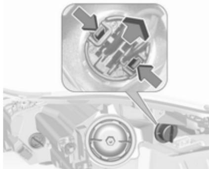
2. Emboîter les languettes ensemble et déplacer la douille hors du logement.
