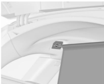
Tirer le filet hors de la cassette et verrouiller la barre du filet d'un côté, dans l'ouverture de montage arrière du cadre de toit. Comprimer la barre et la verrouiller de l'autre côté.
