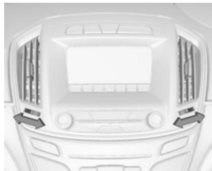
Pour ouvrir une bouche d'aération, tourner la molette sur I. Régler la quantité d'air sortant de la bouche d'aération en tournant la molette.
