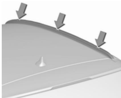
Pour fixer la galerie de toit, insérer les boulons de montage dans les orifices indiqués sur l'illustration.
