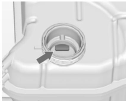
Sur d'autres modèles, le repère du niveau de remplissage se trouve à l'intérieur de l'ouverture de remplissage. Ouvrir le bouchon pour vérifier.
