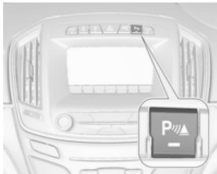
Une diode allumée dans le bouton de l'aide au stationnement **P**▲ indique que le système est prêt à fonctionner.
