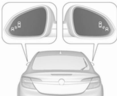
Lorsque le véhicule est démarré, les deux rétroviseurs extérieurs s'allument brièvement pour indiquer que le système est en fonctionnement.
