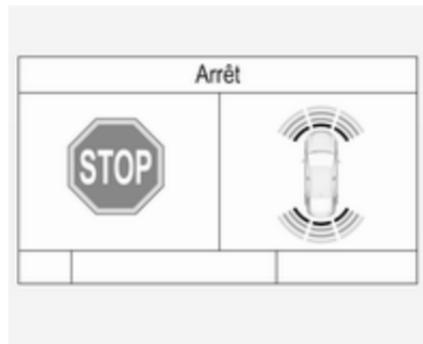
La suggestion de place de stationnement du système est acceptée quand le véhicule est arrêté par le conducteur dans les 10 mètres après l'émission du message « Stop ». Le système calcule le trajet optimal pour stationner dans l'emplacement de parking. Ensuite, il guide le conducteur dans l'emplacement en lui donnant des instructions détaillées.
