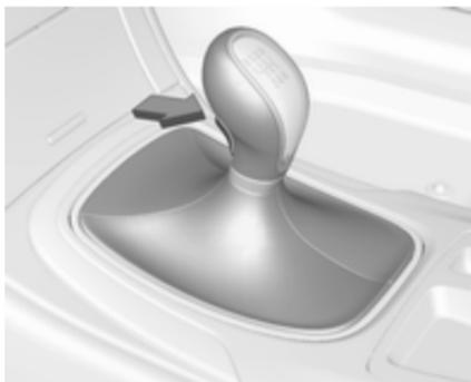
Pour engager la marche arrière, enfoncer le bouton de déverrouillage se trouvant sur le levier avec le véhicule à l'arrêt et engager le rapport.
