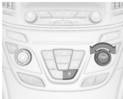
Régler la température par rotation du contrôleur **TEMP** à la valeur désirée.
