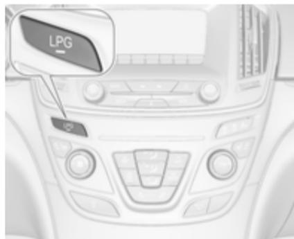
Une pression sur **LPG** permet de choisir entre mode essence et mode gaz de pétrole liquéfié. La diode d'état
