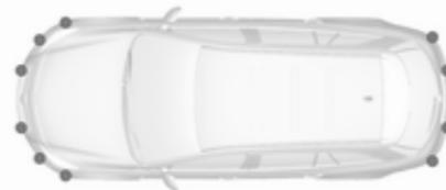
Le système avancé d'assistance au stationnement guide le conducteur dans un emplacement de parking en lui donnant des instructions sur le centre d'informations du conducteur et en émettant des signaux acoustiques. Le conducteur doit contrôler l'accélération, le freinage, la direction et les changements de vitesses.
