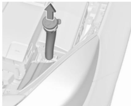
Sur le côté gauche du véhicule, extraire le tuyau de remplissage du réservoir de liquide de lave-glace avant.
