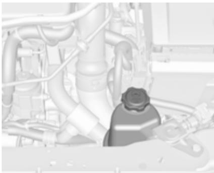
Le niveau du liquide de direction assistée ne doit normalement pas être vérifié. Si un bruit inhabituel est audible pendant l'utilisation du volant ou si la direction réagit de manière singulière, demander l'aide d'un atelier.
