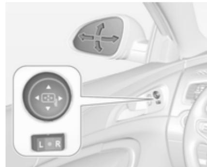
Sélectionner le rétroviseur extérieur souhaité en tournant la commande à gauche (**L**) ou à droite (**R**). Puis pivoter le bouton de commande pour régler le rétroviseur.
