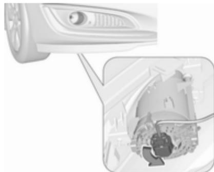
1. Tourner la douille d'ampoule dans le sens antihoraire et l'enlever du réflecteur.
