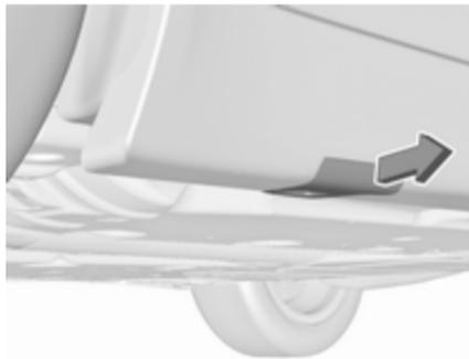
3. Certaines variantes peuvent avoir le point de levage par cric du véhicule recouvert. Éloigner le couvercle sur le côté.
