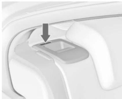
Les dossiers arrière ne sont verrouillés que si les deux repères rouges situés sur le côté près de la poignée de déverrouillage ne sont pas visibles.
