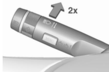
Les feux de route automatiques sont allumés en poussant deux fois le levier de clignotant lorsque le véhicule roule à une vitesse supérieure à 40 km/h.
