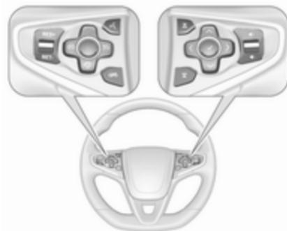
L'Infotainment System, certains systèmes d'assistance au conducteur et un téléphone mobile connecté peuvent être commandés à partir du volant.
