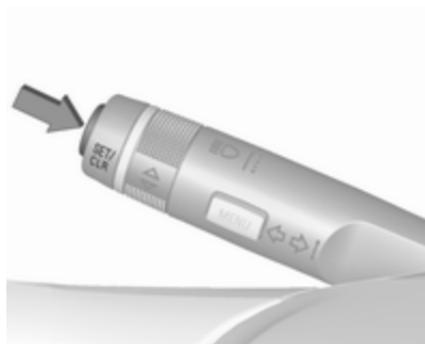
La fonction d'alerte peut être activée ou désactivée dans le menu réglages de la page d'assistant de détection des panneaux routiers en appuyant sur le bouton **SET/CLR** du levier des clignotants ou sur **✓** sur le volant.
