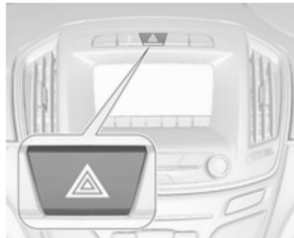
Pour les enclencher, appuyer sur
