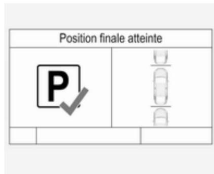
Une manœuvre de stationnement réussie est signalée par le message de position de fin.
