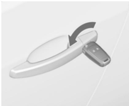
Déverrouiller manuellement la porte du conducteur en tournant la clé dans la serrure. Mettre le contact et appuyer sur le bouton de verrouillage central
