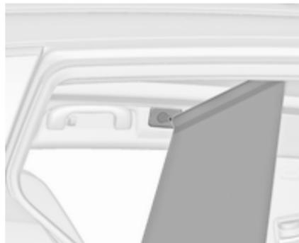
Ouvertures de montage avant dans le cadre de toit : verrouiller la barre du filet d'un côté, compresser la barre et la verrouiller de l'autre côté.
