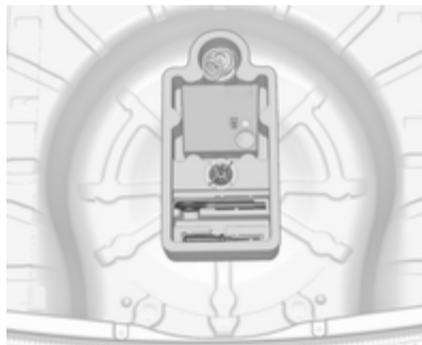
Les outils et l'oeillet de remorquage sont situés ensemble avec le kit de réparation des pneus dans une boîte à outils sous le recouvrement de plancher dans le coffre.
