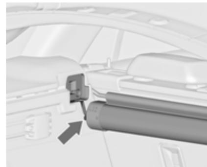
Introduire la cassette dans les logements à gauche et à droite. Utiliser les repères **L** (côté gauche) et **R** (côté droit) de la cassette pour la pose.
