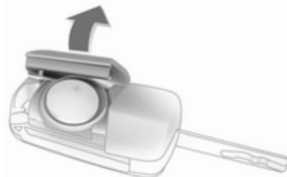
Sortir la clé et ouvrir l'unité. Remplacer la pile (type CR 2032) en faisant attention à la position de montage. Fermer l'unité et la programmer.
