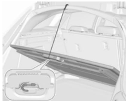
Pour avoir accès à la roue de secours ou au kit de réparation des pneus, soulever le recouvrement de plancher et fixer la sangle de retenue au bord supérieur du renforcement de hayon. Soulever et fixer le recouvrement uniquement lorsqu'il n'est pas chargé.
