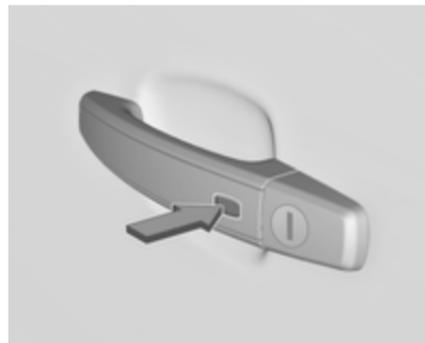
Système à clé électronique : Un déverrouillage du véhicule en enfonçant le bouton ou un actionnement de la poignée de porte désactive l'alarme antivol.
