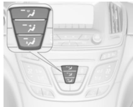
Appuyer sur le bouton correspondant au réglage souhaité. L'activation est indiquée par la diode du bouton.
