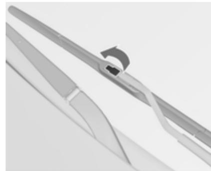
Soulever le bras d'essuie-glace, ouvrir l'attache de fixation.
