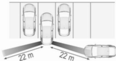
Les capteurs du système couvrent une zone d'environ 20 mètres vers la gauche ou la droite, derrière le véhicule.
