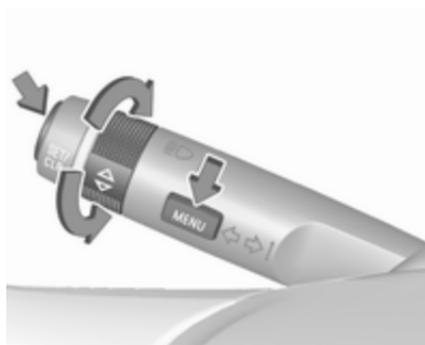
Sur l'écran de base, sélectionner **Réglages**
