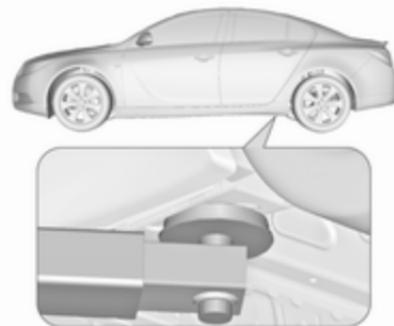
Positionner le bras arrière du pont élévateur au niveau du soubassement.
