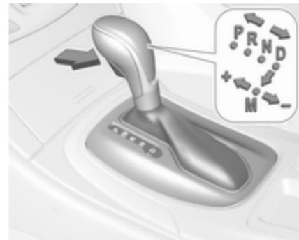
**P** = position de stationnement, presser le bouton de déverrouillage, les roues sont bloquées, à n'engager que si le véhicule est à l'arrêt et que le frein de stationnement est serré
