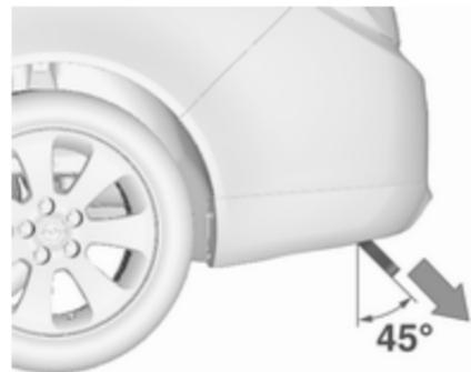
Un signal sonore retentit pour avertir que la poignée de déverrouillage est tirée et que le col de la boule est déverrouillé.
