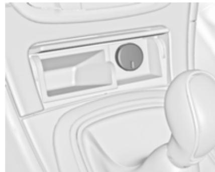
Une prise de courant 12 volts se trouve derrière le couvercle de rangement sous la climatisation. Appuyer sur le couvercle pour l'ouvrir.
