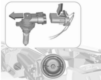
3. Dégager la douille d'ampoule du connecteur en écartant légèrement la patte de retenue.
