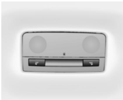
Sur les véhicules avec toit panoramique, les lampes d'éclairage intérieur arrière se trouvent près des poignées arrière.
