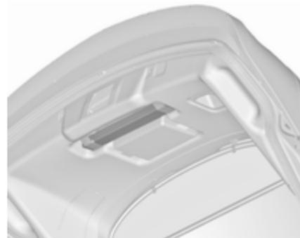
Ranger le triangle de présignalisation dans l'espace situé derrière les sangles sur face intérieure du hayon.
