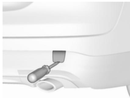
**Country Tourer** : insérer un tournevis dans la fente sur le bord inférieur du capuchon. Dégager le capuchon en enfonçant avec précaution le tournevis vers le bas. Pour éviter tout dégât, il est recommandé de placer un chiffon entre le tournevis et le cadre.
