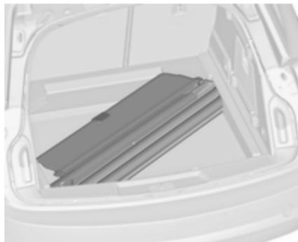
Placer le cache-bagages dans le creux avec la face supérieure vers le bas et avec le levier de déblocage sur le bord avant droit.
