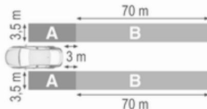
Les capteurs du système couvrent une zone d'environ 3,5 mètres parallèlement aux deux côtés du véhicule, d'environ 3 mètres en arrière de la position d'alerte d'angle mort latéral (A) et d'environ 70 mètres à l'arrière de la position d'alerte de changement de voie (B) sur les voies parallèles. Les zones commencent à chaque rétroviseur extérieur. La hauteur de la zone est environ entre 0,5 mètre et 2 mètres du sol.
