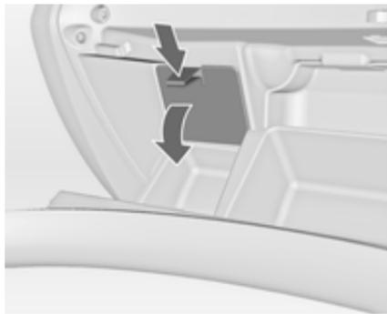
Dans les véhicules avec direction à droite, la boîte à fusibles se trouve derrière un cache dans la boîte à gants. Ouvrir la boîte à gants et retirer le couvercle.
