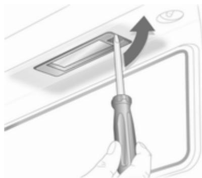
1. Introduire le tournevis dans le boîtier de l'ampoule ; appuyer sur le côté et déverrouiller le ressort.
