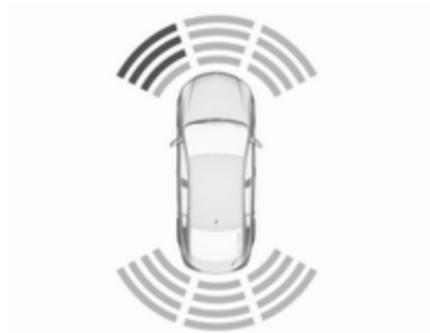
La distance vers l'obstacle avant et arrière est indiquée par des lignes de distance qui se modifient autour du véhicule.
