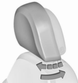
Tirer lentement le rembourrage de l'appui-tête vers l'avant. Il s'enclenche dans plusieurs positions.
