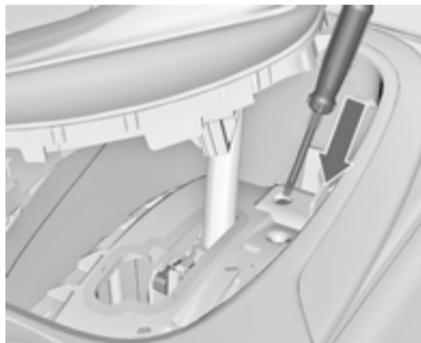
3. Introduire un tournevis aussi loin que possible dans l'ouverture et déplacer le levier sélecteur de la position **P** ou **N**. Si le levier sélecteur est à nouveau ramené en position **P** ou **N**, il sera à nouveau bloqué dans cette position. Faire corriger la cause de la coupure de courant par un atelier.
