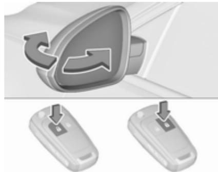
Appuyer à nouveau sur
