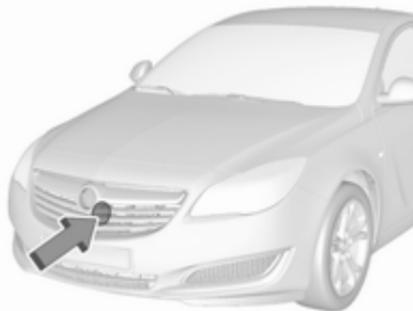
Le radar est monté derrière la calandre du radiateur sous l'emblème de la marque.
