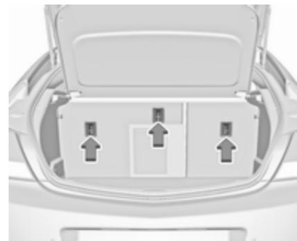
En plus de la fixation ISOFIX, attacher la sangle Top-Tether aux systèmes de sécurité pour enfant Top-Tether. La sangle doit alors passer entre les deux tiges de guidage de l'appui-tête.
