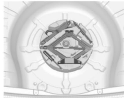
Le cric avec la clé à roue, les outils, le boulon avec une tige plus longue pour fixer une roue endommagée et l'oeillet de remorquage sont rangés dans la boîte à outils sous la roue de secours dans le coffre. Roue de secours ⇨ 280.
