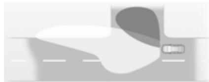
Dans les virages serrés ou lors des changements de direction, en fonction de l'angle de braquage du volant ou des clignotants, un réflecteur supplémentaire, à gauche ou à droite, est activé pour éclairer la route sous un angle correct par rapport à la direction du déplacement. Il est activé jusqu'à une vitesse de 40 km/h.
