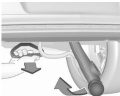
Tirer la poignée se trouvant à gauche de la plaque d'immatriculation sous le pare-chocs arrière jusqu'à former un angle de 45° environ par rapport au sol.
