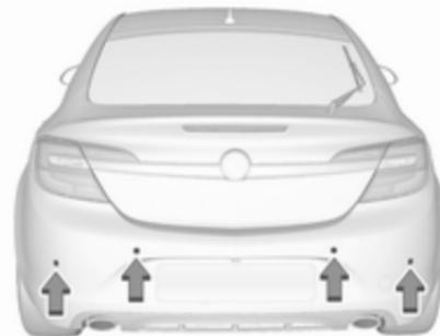
L'aide au stationnement avant-arrière mesure la distance entre le véhicule et les obstacles présents devant et derrière le véhicule. Le système émet des signaux sonores et affiche des messages.
