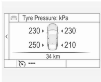
L'état du système et des avertissements de pression sont signalés par un message avec un clignotement du pneu correspondant dans le DIC.
