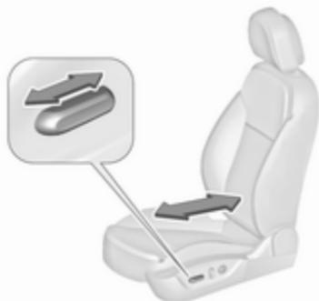
Déplacer l'avant du commutateur vers l'avant / vers l'arrière.
