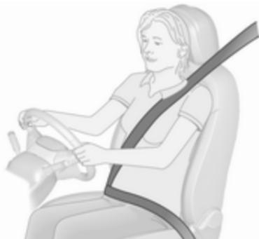
Tirer la ceinture de sécurité et l'enclencher dans la serrure de ceinture. La ceinture de sécurité ne doit pas être vrillée et doit être placée près du corps. Le dossier ne doit pas être incliné trop en arrière (environ 25° maximum).
