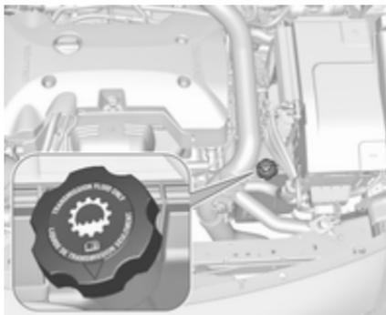
Le niveau du liquide de boîte de vitesses automatique ne doit normalement pas être vérifié. Pour vérifier le niveau du liquide, demander l'aide d'un atelier.
