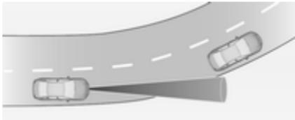
Le régulateur de vitesse adaptatif calcule une voie estimée, basée sur la force centrifuge. Cette voie estimée considère la caractéristique de virage réelle, mais ne peut pas considérer un changement de virage futur. Le système peut perdre le véhicule à l'avant ou considérer un véhicule qui n'est pas dans la voie actuelle. Ceci peut se réduire lors de l'entrée ou la sortie d'un virage ou si le virage devient plus prononcé ou moins pro-
