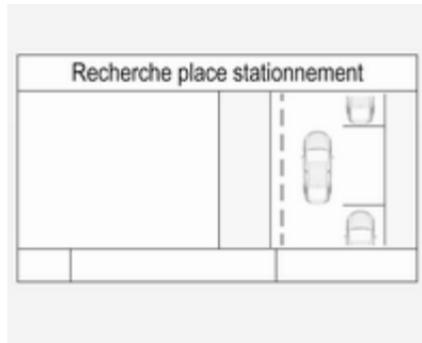
Quand le véhicule passe le long d'une rangée de voitures et que le système est activé, le système avancé d'assistance au stationnement commence à rechercher une place de parking adéquate. Quand un emplacement approprié est détecté, des signaux acoustiques et visuels sont donnés sur le centre d'informations du conducteur.
