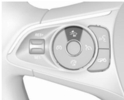
La première pression sur le bouton affiche le réglage en cours sur le centre d'informations du conducteur. Une pression supplémentaire sur le bouton permet de changer ce réglage. Le réglage choisi reste
