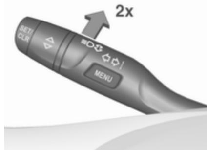
Activer les feux de route automatiques en poussant deux fois le levier des clignotants. Les feux de route s'allument automatiquement à une vitesse supérieure à 50 km/h. Les feux de route s'éteignent à une vitesse inférieure à 35 km/h, mais les feux de route automatiques restent actifs.
