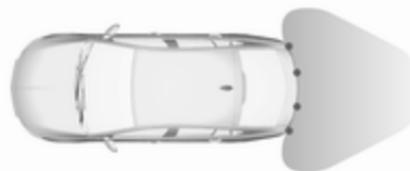
Le système possède quatre capteurs de stationnement à ultrasons disposés dans le pare-chocs arrière.
