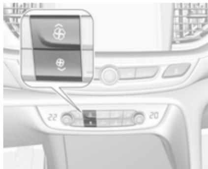
Appuyer sur le bouton supérieur ☼ pour augmenter ou sur le bouton inférieur ☾ pour diminuer la vitesse de la soufflerie. La vitesse de soufflerie est indiquée grâce à une notification dans l'affichage d'informations. La vitesse de la soufflerie peut également être modifiée grâce aux boutons tactiles sur l'affichage des paramètres de la climatisation. Appuyer sur **Climate** pour accéder au menu.
