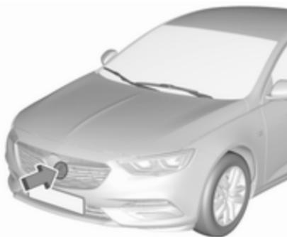
Le radar est monté derrière la calandre du radiateur derrière ou sous l'emblème de la marque.
