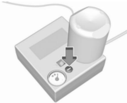
Si la pression des pneus est atteinte dans les 10 minutes, régler à la pression de pneus prescrite en utilisant le compresseur pour augmenter ou réduire grâce au bouton au-dessus de l'indicateur de pression.
