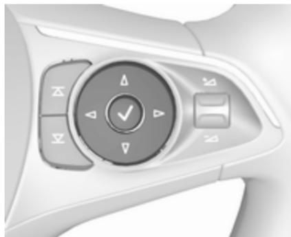
Sur l'écran de niveau médian ou supérieur, choisir le menu **Info** à l'aide des boutons à droite du volant et appuyer sur  $\nabla$  ou  $\Delta$  pour sélectionner la page d'assistant de détection des panneaux routiers
