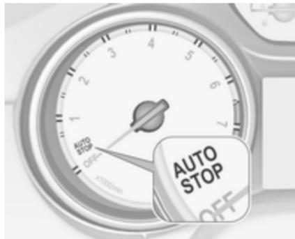
Lorsque le véhicule roule à faible vitesse ou est à l'arrêt et que certaines conditions sont réunies, un arrêt automatique est activé.
