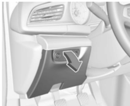
Dans les véhicules avec direction à gauche, la boîte à fusibles se trouve derrière un cache du tableau de bord. Dégager le cache sur le côté, puis l'enlever.
