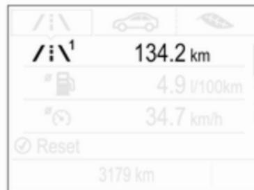
Sélectionner  $/i\backslash$  en appuyant sur **Menu** du levier des clignotants. Tourner la molette de réglage sur la manette des clignotants et sélectionner  $/i\backslash 1$  ou  $/i\backslash 2$ . Chaque page du compteur kilométrique journalier peut être réinitialisée séparément en appuyant pendant quelques secondes sur **SET/CLR** du levier des clignotants sur le menu concerné.
