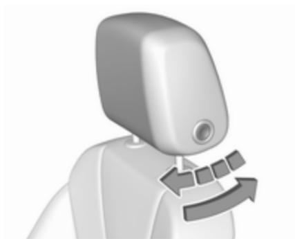
Tirer lentement le rembourrage de l'appui-tête vers l'avant. Il s'encliquette dans plusieurs positions.
