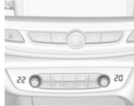
Régler séparément les températures pré-sélectionnées pour le conducteur et le passager avant à la valeur désirée, à l'aide des cadrans de commande gauche et droit. Le bouton du côté passager permet de modifier la température du côté passager. Le bouton du côté conducteur permet de modifier la température du côté conducteur ou des deux côtés selon l'activation de la synchronisation **SYNC**. La température recommandée est de 22 °C. La
