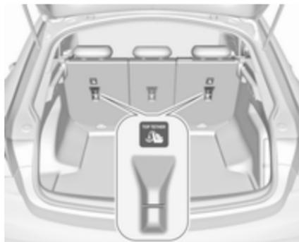
En plus des supports ISOFIX, attacher la sangle Top-Tether aux œillets de fixation Top-Tether.
