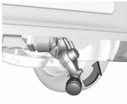
Avec le plat de la main, pivoter la barre d'attelage libérée vers la droite jusqu'à ce qu'elle s'engage sous le plancher. S'assurer que la poignée de déverrouillage est revenue dans sa position initiale cachée, sinon le signal sonore ne s'arrêtera pas.
