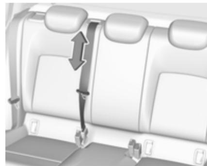
La ceinture de sécurité du siège central peut être bloquée quand le dossier peut être relevé trop rapidement. Pour débloquer l'enrouleur, rentrer la ceinture de sécurité ou la sortir d'environ 20 mm, puis relâcher.
