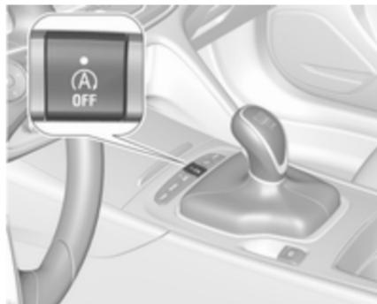
Pour désactiver le système Stop/Start manuellement, appuyer sur
