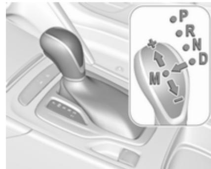
**P** : position de stationnement, roues bloquées, engager uniquement lorsque le véhicule n'est pas en mouvement
