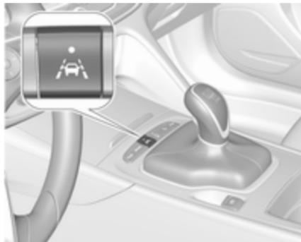
L'assistance au maintien de trajectoire est activée en appuyant sur
