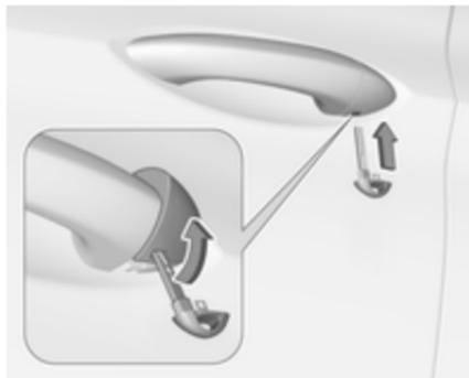
**Clé électronique :** pour retirer le capuchon, appuyer sur le bouton à l'arrière et retirer la lame de la clé du boîtier. Introduire la clé dans le renforcement au bas du capuchon et faire pivoter la clé vers le haut.
