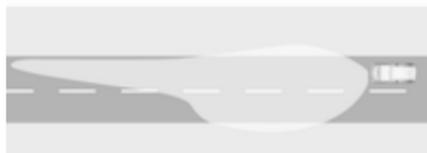
Activés automatiquement à une vitesse supérieure à environ 55 km/h en conduisant dans des zones rurales. L'éclairage de la voie
