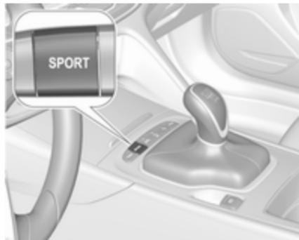
Sur les véhicules dotés des modes de conduite Flex Ride, le conducteur peut légèrement augmenter l'accélération du régulateur de vitesse adaptatif lorsque le Mode Sport est sélectionné.
