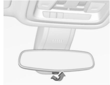
Pour réduire l'éblouissement, ajuster le levier sous le boîtier du rétroviseur.
