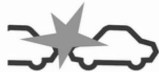
Lorsque le temps avant une collision possible avec le véhicule à l'avant est trop court et que la collision est imminente, le symbole d'alerte de collision s'affiche dans le centre d'informations du conducteur et le conducteur est avisé par une bande LED rouge clignotante ou par le symbole d'une notification sur l'affichage à tête haute, projeté sur le pare-brise dans le champ de vision du conducteur.
