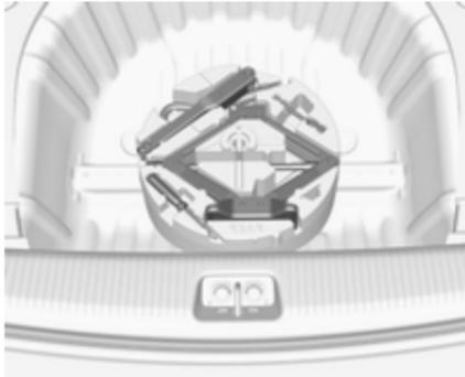
Le cric avec la clé à roue, les outils, le boulon avec une tige plus longue pour fixer une roue endommagée et l'oeillet de remorquage sont rangés dans la boîte à outils sous la roue de secours dans le coffre. Roue de secours ⇨ 283.
