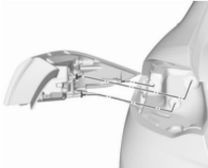
3. Retirer avec précaution l'ensemble de feu arrière du renforcement et le déposer. Veiller à ce que la goulotte de câbles reste en place.
