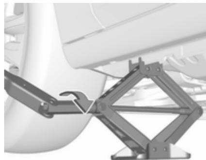
Attacher la clé de roue, aligner correctement le cric et tourner la clé de roue jusqu'à ce que la roue ait quitté le sol.
