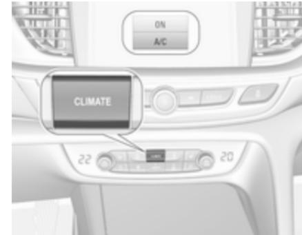
Appuyer sur **Climate** pour accéder au menu et suivre les boutons tactiles **A/C ON** ou **A/C OFF** pour allumer ou arrêter la climatisation.
