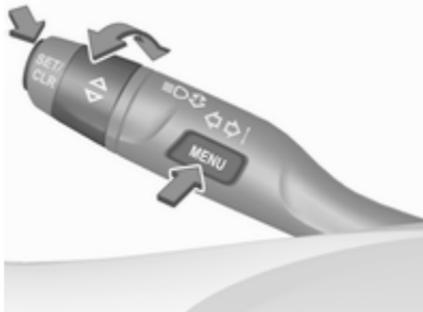
Sur l'écran de niveau de base, sélectionner
