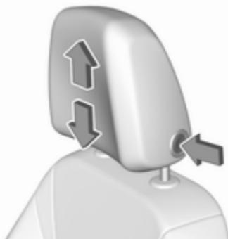
Appuyer sur le bouton de déverrouillage, régler la hauteur, verrouiller.
