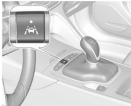
L'assistance au maintien de trajectoire est activée en appuyant sur
