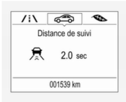
Sur les écrans de niveau médian et supérieur, sélectionner le menu **Info** avec les boutons du volant et appuyer sur  $\nabla$  pour sélectionner l'indication de distance de suivi  $\rightarrow$  117.
