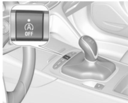
Pour désactiver le système Stop/Start manuellement, appuyer sur
