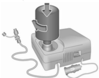
**Type 2** : retirer le bouchon à vis du compresseur et de la bouteille de produit d'étanchéité. Visser la bouteille sur le compresseur sans retirer le papier d'aluminium de la bouteille.
