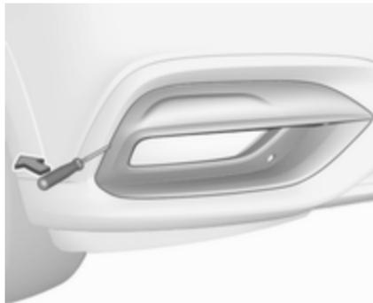
Envelopper d'un tissu l'extrémité du tournevis plat pour ne pas endommager la peinture. Faire lever sur la plaquette pour la soulever en insérant le tournevis dans le renforcement, puis la retirer.
