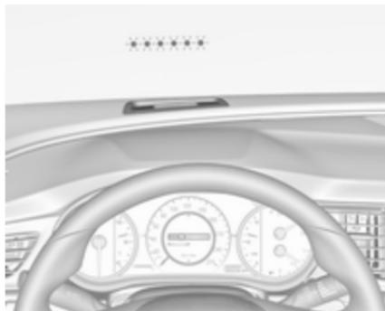
Si un piéton détecté est approché trop rapidement, une LED d'alerte clignote en rouge ou un symbole de notification  $\lambda$  s'affiche sur le pare-brise par l'affichage à tête haute dans le champ de vision du conducteur. Un signal sonore est activé. Le système de freinage peut se préparer à ce que le
