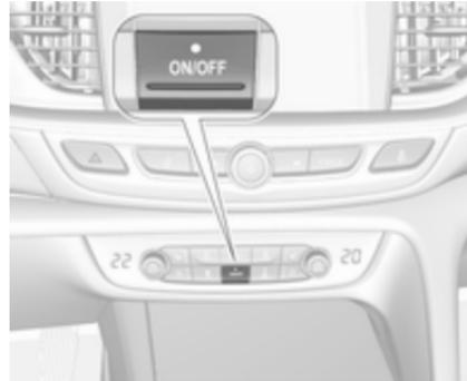
Le refroidissement, le ventilateur et le mode automatique peuvent être désactivés en appuyant sur **ON/OFF**. Lorsque le système est désactivé, la LED du bouton **ON/OFF** ne s'allume pas.
