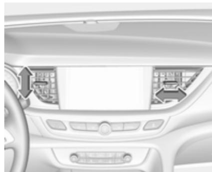
L'illustration montre les bouches d'aération centrales du tableau de bord.
