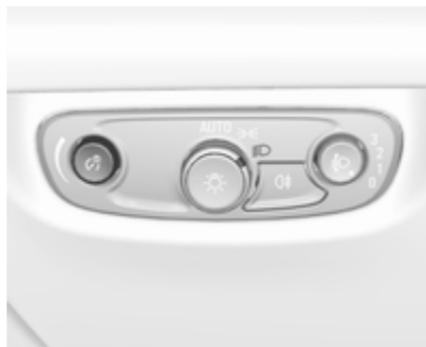
La luminosité des phares suivants peut être réglée en position **AUTO** lorsque le capteur de lumière détecte des conditions de nuit, ou en position **OFF** ou **ON/OFF**.
