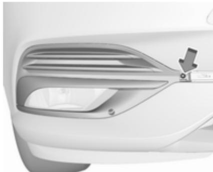
Enlever la vis avec le tournevis Torx et retirer la plaquette.
