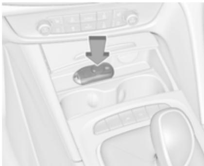
Ouvrir le couvercle de la console centrale en face du levier de changement de vitesses. Placer la clé électronique boutons vers le haut dans la poche de l'émetteur, à côté de la prise de courant, comme indiqué sur l'illustration.
