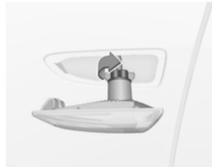
2. Faire tourner la douille d'ampoule dans le sens inverse des aiguilles d'une montre et la déposer du logement.
