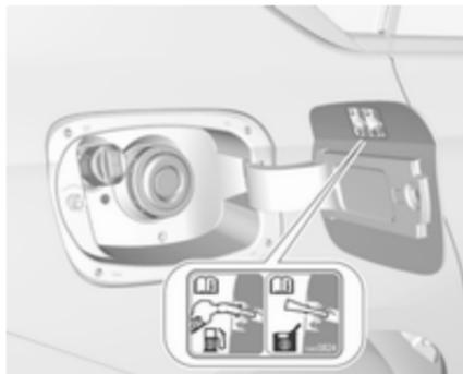
L'inhibiteur de détrompeur de carburant garantit que la trappe du goulot de remplissage de carburant ne peut être ouverte qu'au moyen d'une buse pour carburant appropriée ou d'un entonnoir pour appoint d'urgence.
