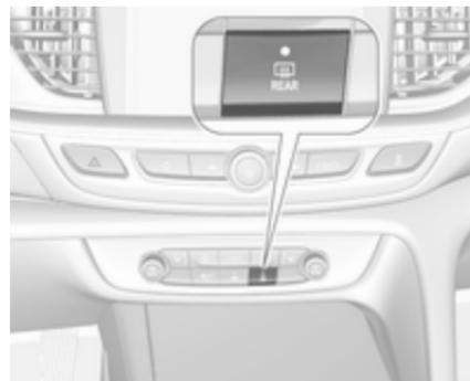
Enclenché en appuyant sur
