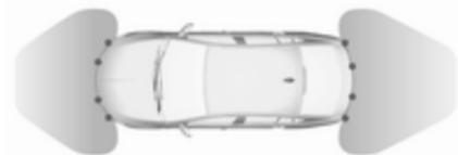
Quatre capteurs de stationnement à ultrasons sont présents dans chaque pare-chocs avant et arrière.
