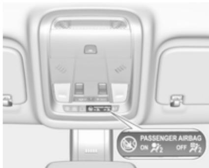
Si le témoin
