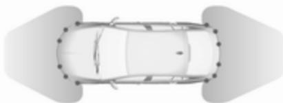
Le système avancé d'assistance au stationnement est toujours associé à l'aide au stationnement avant-arrière. Les deux systèmes utilisent les mêmes capteurs sur les pare-chocs avant et arrière.
