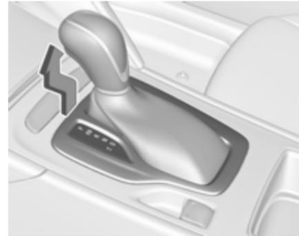
2. Dégager la garniture du levier sélecteur de la console centrale. Appuyer avec un doigt sur la poche en cuir à côté du levier sélecteur et tirer la garniture doucement vers le haut ; un câble y est fixé. Faire glisser la garniture légèrement vers l'avant car elle est montée sur charnière sur son côté arrière. Libérer la garniture en l'inclinant vers la gauche pour éviter de tendre le câble.
