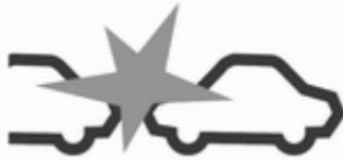
Lorsque le temps avant une collision possible avec le véhicule à l'avant est trop court et que la collision est imminente, le symbole d'alerte de collision s'affiche dans le centre d'informations du conducteur et le conducteur est avisé par une bande LED rouge clignotante ou par le symbole d'une notification sur l'affichage à tête haute, projeté sur le pare-brise dans le champ de vision du conducteur.
