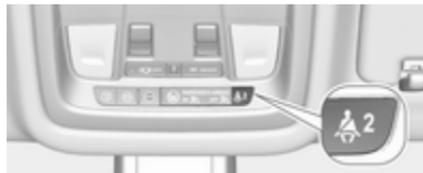
✚<sup>2</sup> du siège du passager avant s'allume ou clignote en rouge sur la console de toit, quand le siège est occupé.
