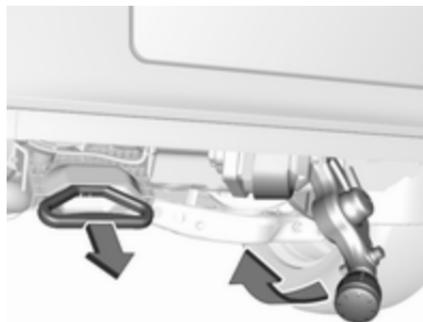
Tirer la poignée se trouvant à gauche de la plaque d'immatriculation sous le pare-chocs arrière jusqu'à former un angle de 45° environ par rapport au sol.
