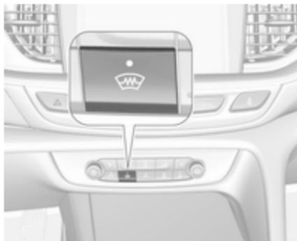
Si le véhicule est équipé d'un pare-brise chauffant, le bouton
