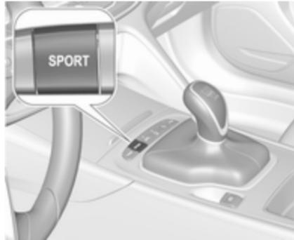
Sur les véhicules dotés des modes de conduite Flex Ride, le conducteur peut légèrement augmenter l'accélération du régulateur de vitesse adaptatif lorsque le Mode Sport est sélectionné. Cette fonction peut être désactivée dans le menu de visualisation Flex Ride ⇨ 196.
