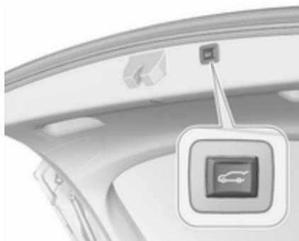
Pour fermer, appuyer sur
