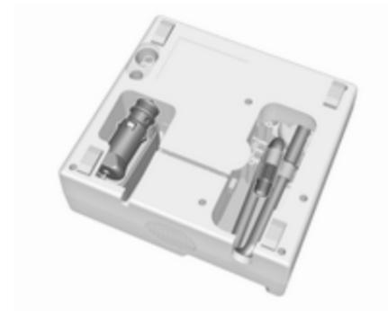
1. Enlever le câble de raccordement électrique et le flexible d'air de leur espace de rangement sur la face inférieure du compresseur.
