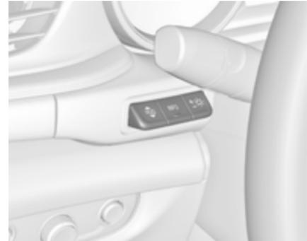
Trois commandes se trouvent au-dessus du commutateur d'éclairage pour actionner l'affichage à tête haute.
