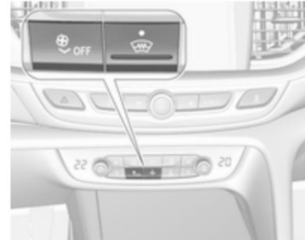
Si le véhicule est équipé d'un pare-brise chauffant, le bouton **ON/OFF** est remplacé par le bouton
