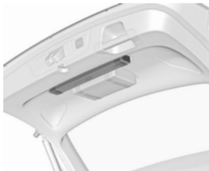
Ranger le triangle de présignalisation sur le panneau intérieur du hayon et le fixer avec les sangles.
