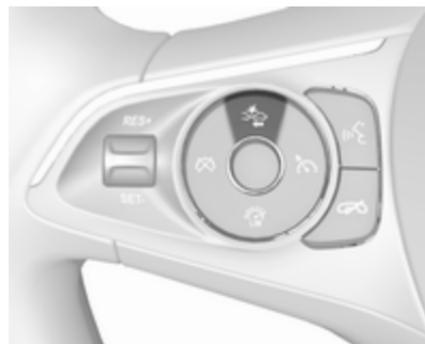
La première pression sur le bouton affiche le réglage en cours sur le centre d'informations du conducteur. Une pression supplémentaire sur le bouton permet de changer ce réglage. Le réglage choisi reste jusqu'à ce qu'il soit changé. Le déclenchement de l'alerte varie en fonction de la vitesse du véhicule. Plus la vitesse du véhicule est élevée, plus la vitesse de déclenchement de
