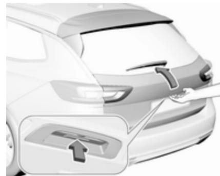
Pour ouvrir le hayon, appuyer sur le bouton sous la moulure de hayon et le maintenir enfoncé jusqu'à ce que le hayon commence à se déplacer. Si le véhicule est verrouillé, la clé électronique doit se trouver à l'extérieur du véhicule dans un rayon d'environ 1 m du hayon.
