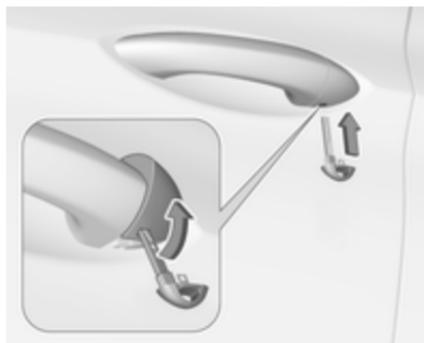
Introduire la lame de la clé dans le logement du bas du capuchon et faire pivoter la clé vers le haut.
