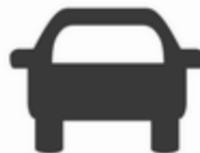
Le témoin de véhicule à l'avant allumé en vert
