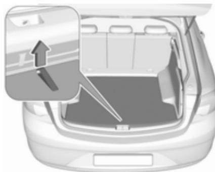
Le recouvrement du plancher arrière peut être retiré. Soulever le couvercle au niveau de la boucle et l'enlever.
