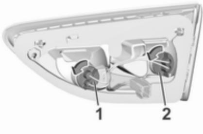
4. Tourner la douille d'ampoule dans le sens antihoraire et l'enlever du bloc optique.
