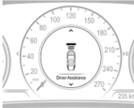
Si le système est actif et qu'un véhicule est détecté devant, les barres devant le symbole de véhicule apparaissent en vert et indiquent la position de l'écart configuré.
