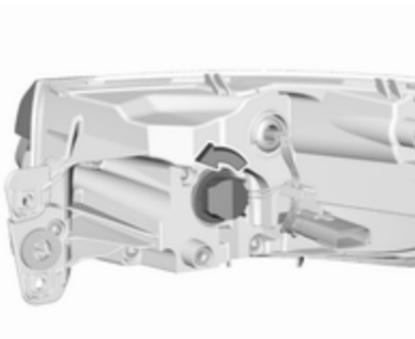
3. Tourner la douille d'ampoule du feu de direction dans le sens anti-horaire et la retirer du bloc optique.
