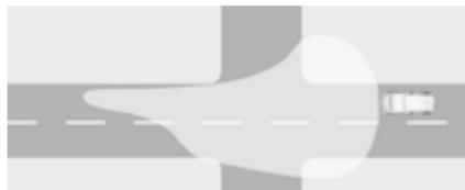
Activés automatiquement à une vitesse maximale d'environ 55 km/h et en cas de lumière ambiante extérieure. Le faisceau est large et conçu pour éviter d'éblouir les autres usagers de la route.
