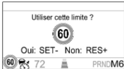
Même si le régulateur de vitesse adaptatif est inactif, la vitesse enregistrée est mise à jour automatiquement à chaque nouvelle limite de vitesse détectée, comme décrit dans la section suivante. Appuyer sur **RES+** pour réactiver le régulateur de vitesse adaptatif avec la vitesse définie enregistrée.
