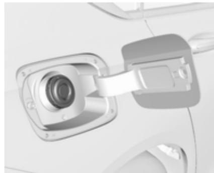
Placer bec de remplissage en position verticale sur le goulot de remplissage et presser légèrement pour l'insérer.
