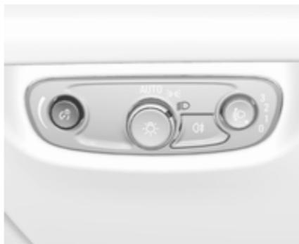
La luminosité des phares suivants peut être réglée en position **AUTO** lorsque le capteur de lumière détecte des conditions de nuit, ou en position **ON/OFF** ou **OFF**.
