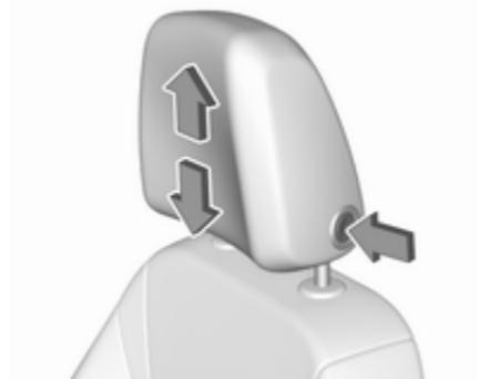
Appuyer sur le bouton de déverrouillage, régler la hauteur, verrouiller.
