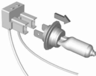
3. Séparer l'ampoule de la douille d'ampoule et remplacer l'ampoule.
