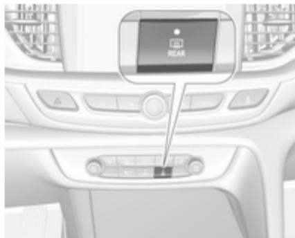
Le chauffage de la lunette arrière et des rétroviseurs extérieurs est déclenché par une pression sur
