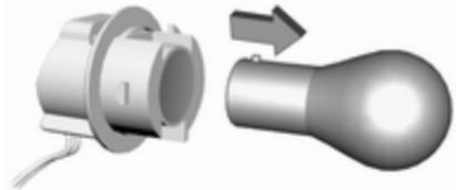
4. Séparer l'ampoule de la douille d'ampoule et remplacer l'ampoule du feu de direction.
