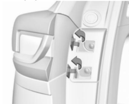
1. Ouvrir les couvercles avec un tournevis. Dévisser et déposer les deux vis.
