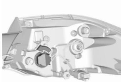
4. Tourner la douille d'ampoule du feu de direction dans le sens anti-horaire et la retirer du bloc optique.
