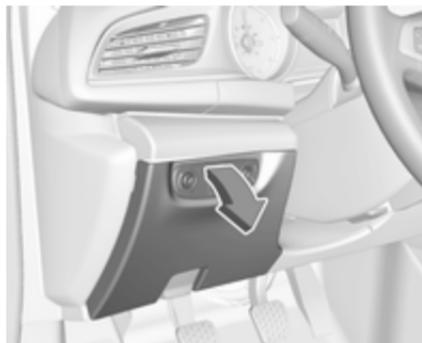
Dans les véhicules avec direction à gauche, la boîte à fusibles se trouve derrière un cache du tableau de bord.
