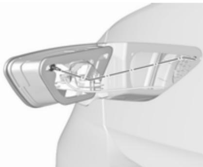
3. Retirer avec précaution l'ensemble de feu arrière du renforcement et le déposer. Veiller à ne pas tirer sur le câble.
