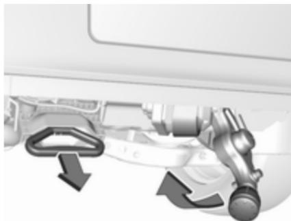
Tirer la poignée se trouvant à gauche de la plaque d'immatriculation sous le pare-chocs arrière jusqu'à former un angle de 45° environ par rapport au sol.
