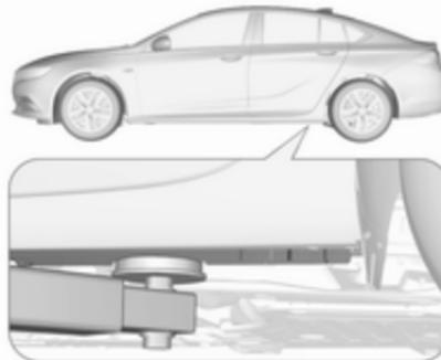
Position de centrage du bras porteur arrière du pont élévateur sous le point de levage du véhicule.
