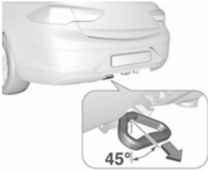
Un signal sonore retentit pour avertir que la poignée de déverrouillage est tirée et que le col de la boule est déverrouillé.
