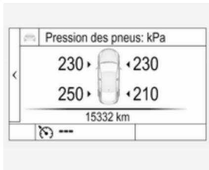
L'état du système et des avertissements de pression sont signalés par un message indiquant le pneu correspondant dans le centre d'informations du conducteur.
