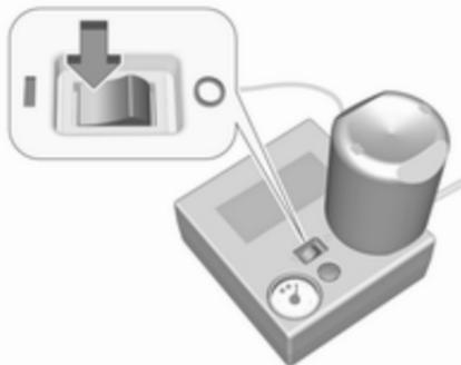
8. Placer le commutateur à bascule du compresseur sur **I**. Le pneu est rempli de produit d'étanchéité.
