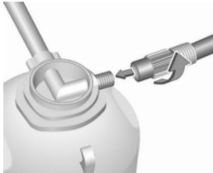
2. **Type 1** : visser le flexible d'air du compresseur au raccord de la bouteille de produit d'étanchéité et positionner cette dernière dans le dispositif de retenue du compresseur.
