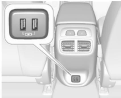
Deux ports USB réservés à la charge de périphériques sont situés à l'arrière de la console centrale.
