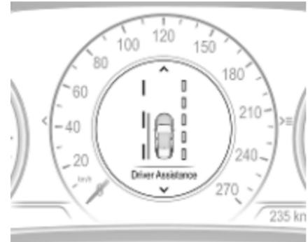
Si le système est actif mais que l'une des files ou les deux ne sont pas détectées, elles apparaissent sous la forme de lignes en pointillé, comme illustré sur le côté droit du véhicule dans l'image ci-avant.
