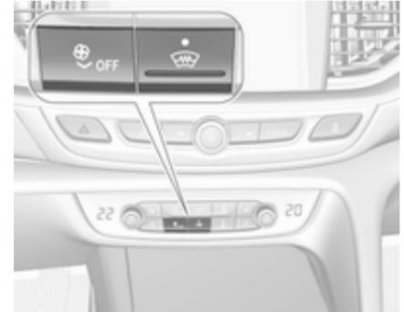
Si le véhicule est équipé d'un pare-brise chauffant, le bouton **ON/OFF** est remplacé par le bouton
