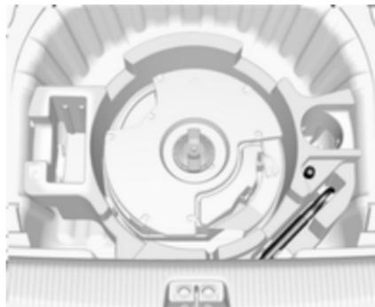
Le tournevis et l'œillet de remorquage sont placés sous le couvercle du plancher du coffre, à côté de l'élément rond du système de haut-parleurs.
