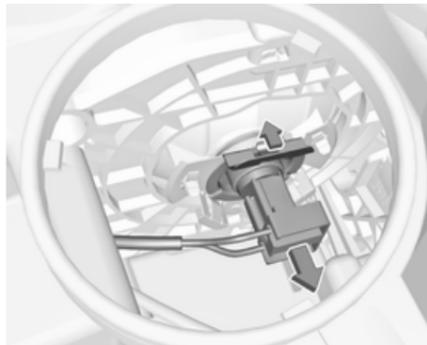
2. Dégager la douille d'ampoule en appuyant sur la fixation à l'avant. Retirer la douille de l'ampoule du boîtier du réflecteur.
