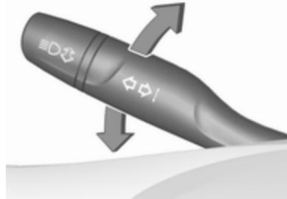
Quand le véhicule est stationné, les feux de stationnement peuvent être allumés d'un côté :
