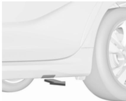
Certains modèles sont dotés de cache-seuils couvrant les points de levage du véhicule : tirer tout d'abord sur le cache du point de levage concerné.
