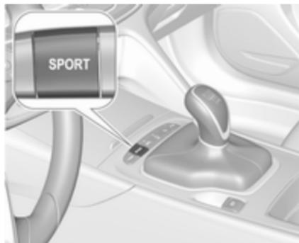
Sur les véhicules dotés des modes de conduite Flex Ride, le conducteur peut légèrement augmenter l'accélération du régulateur de vitesse adaptatif lorsque le Mode Sport est sélectionné. Cette fonction peut être désactivée dans le menu de visualisation Flex Ride ↗ 193.
