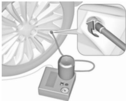
5. **Type 1** : visser le flexible de remplissage sur la valve de pneu.
