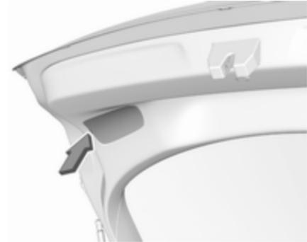
1. Détacher le couvercle dans le hayon et le déposer.
