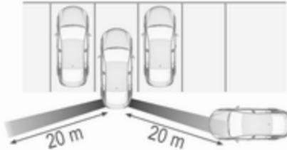
Les capteurs du système couvrent une zone d’environ 20 m à 90° vers la gauche ou la droite, derrière le
