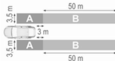
Les capteurs du système couvrent une zone d'environ 3,5 m parallèlement sur les côtés du véhicule et environ 3 m en arrière par rapport à l'alerte d'angle mort latéral (A) et à environ 50 m à l'arrière de la position d'alerte de changement de voie (B) sur les voies parallèles. Les zones commencent à chaque rétroviseur extérieur. La hauteur de la zone est comprise entre environ 0,5 m et 2 m du sol.
