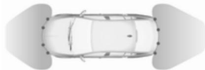
Quatre capteurs de stationnement à ultrasons sont présents dans chaque pare-chocs avant et arrière.
