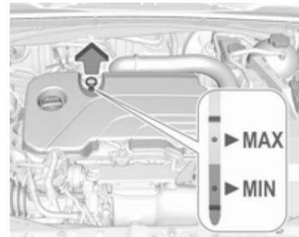
Tirer sur la jauge pour la sortir, la nettoyer, l'insérer à nouveau intégralement et la ressortir pour lire le niveau d'huile moteur.
