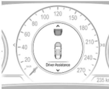
Un symbole de véhicule situé devant apparaît en gris lorsqu'un véhicule a été détecté.
