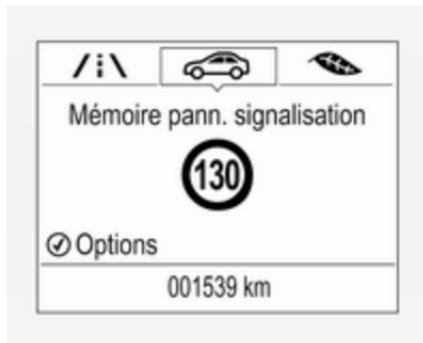
Sur l'affichage de niveau de base, lorsque la page d'assistant de détection des panneaux routiers est affichée, appuyer sur ✓ sur les commandes au volant.
