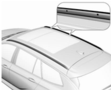
Les points de fixation se trouvent dans les deux rails de toit.
