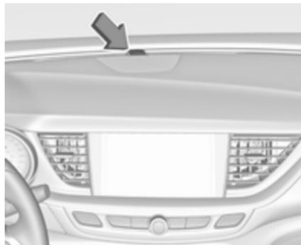
La diode d'état est intégrée au capteur sur le haut du tableau de commande.
