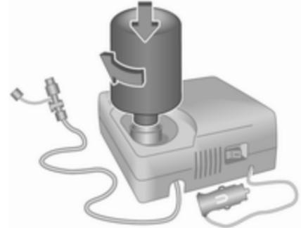
**Type 2** : retirer le bouchon à vis du compresseur et de la bouteille de produit d'étanchéité. Visser la bouteille sur le compresseur sans retirer le papier d'aluminium de la bouteille.
