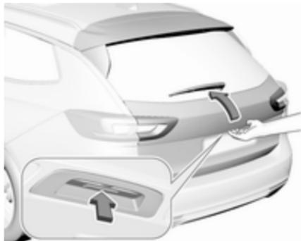
Après le déverrouillage, appuyer sur le bouton sous la moulure de hayon et ouvrir le hayon.
