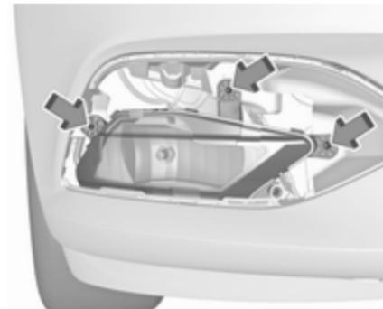
3. Enlever trois vis avec le tournevis Torx et retirer l'ensemble d'éclairage à l'avant.
