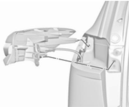
2. Retirer avec précaution l'ensemble de feu du renforcement et le déposer. Veiller à ne pas tirer sur le câble.
