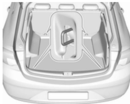
Les anneaux d'arrimage servent à sécuriser les objets pour éviter qu'ils ne glissent. Ils doivent être utilisés pour fixer les sangles de serrage ou le filet à bagages.
