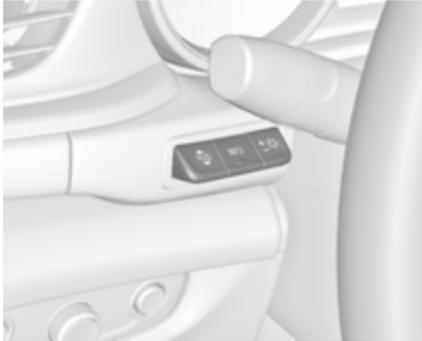
Trois commandes se trouvent au-dessus du commutateur d'éclairage pour actionner l'affichage à tête haute.
