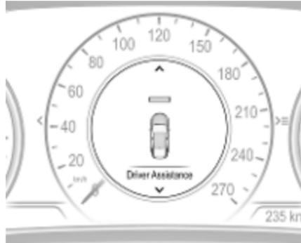
Si le système est mis en marche mais inactif, une barre blanche sur la position d'écart configuré apparaît devant le symbole du véhicule.
