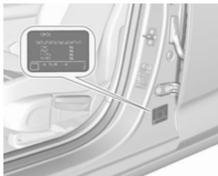
L'étiquette d'identification se trouve sur l'encadrement de la porte avant gauche ou droite.
