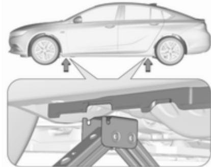
3. Vérifier que le cric est bien positionné sous le point de levage adéquat.
