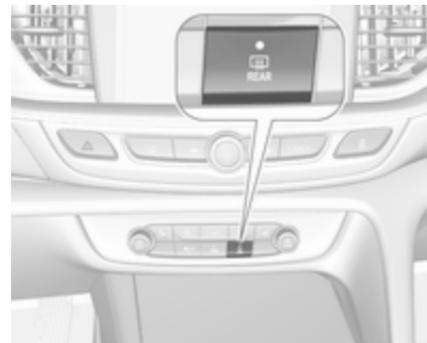
Le chauffage de la lunette arrière et des rétroviseurs extérieurs est déclenché par une pression sur
