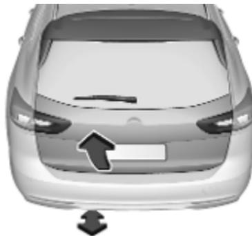
Pour ouvrir ou fermer le hayon, bouger le pied dans la zone centrale sous le pare-chocs arrière rapidement, d'avant en arrière. Ne pas laisser le pied sous le pare-chocs. La clé électronique doit se trouver à l'extérieur du véhicule dans un rayon d'en-
