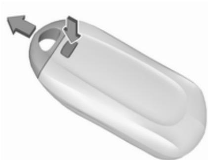
Appuyer sur le bouton de la clé électronique et retirer la lame de la clé. Le barillet de serrure de la porte du conducteur est recouvert d'un capuchon.
