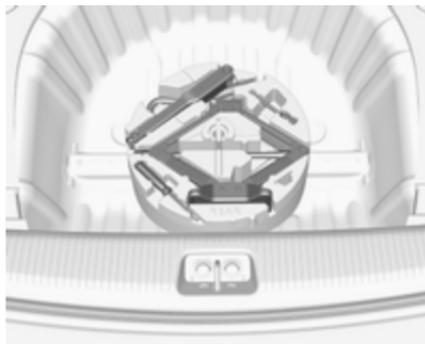
Le cric avec la clé à roue, les outils, le boulon avec une tige plus longue pour fixer une roue endommagée et l'œillet de remorquage sont rangés dans la boîte à outils sous la roue de secours dans le coffre.
