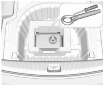
Le tournevis et l'œillet de remorquage sont placés dans une boîte sous le couvercle du plancher du coffre.
