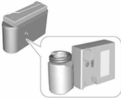
Sortir la bouteille de produit d'étanchéité et le compresseur de la boîte.
