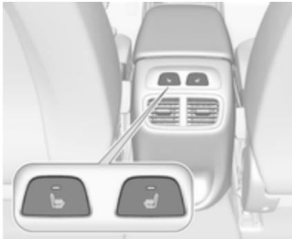
Activer le chauffage du siège en appuyant sur
