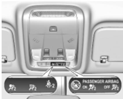
Si le témoin
