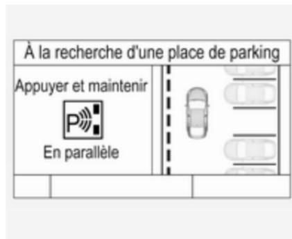
Sélectionner une place de stationnement parallèle ou perpendiculaire dans le centre d'informations du conducteur par une pression longue sur
