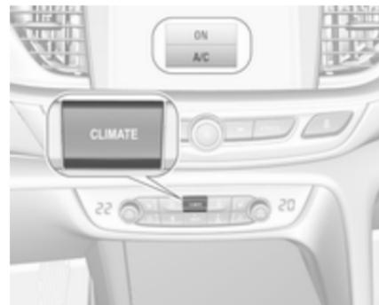
Appuyer sur **Climate** pour accéder au menu et sélectionner le bouton tactile **A/C** pour allumer ou arrêter la climatisation.
