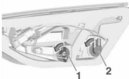
4. Tourner la douille d'ampoule dans le sens antihoraire et l'enlever du bloc optique.
