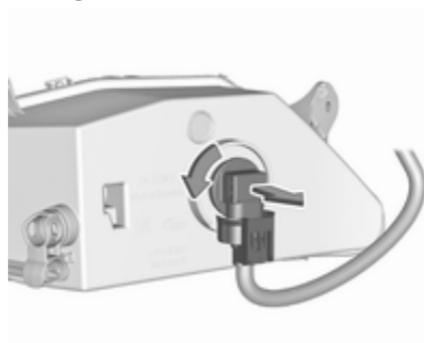
4. Tourner la douille d'ampoule dans le sens antihoraire et l'enlever du bloc optique.
