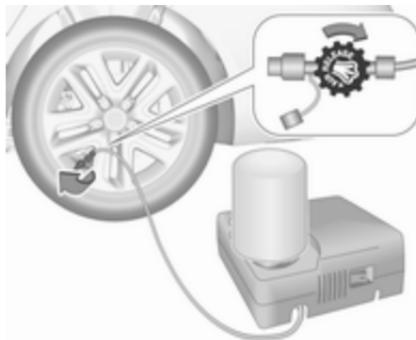
**Type 2** : enlever le capuchon de protection de la valve de pneu et visser le flexible de remplissage
