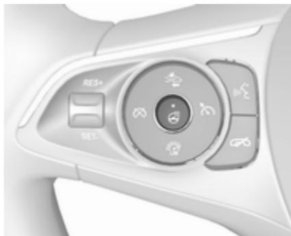
Activer le chauffage en appuyant sur
