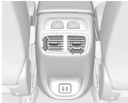
L'illustration montre les bouches d'aération pour le passager arrière.
