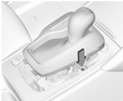
3. Introduire une petite tige (par exemple un stylo ou un tournevis) dans l'ouverture près du levier sélecteur. Pousser la tige verticalement vers le bas et sortir le levier sélecteur du **P**. Si cette position est à nouveau enclenchée, le levier sélecteur sera à nouveau
