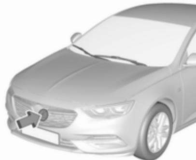
Le radar est monté derrière la calandre du radiateur ou sous l'emblème de la marque.
