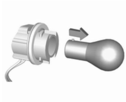
5. Retirer et remplacer l'ampoule du feu de direction.
