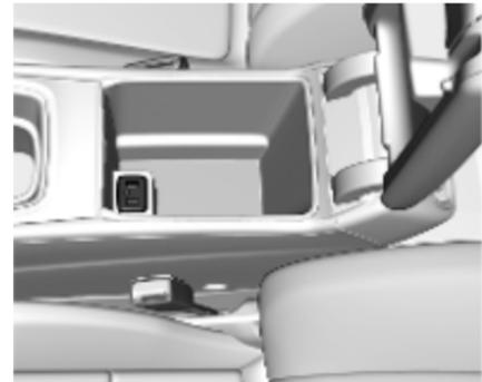
Deux ports de recharge USB se trouvent sous l'accoudoir pliable. Ces ports disposent également d'une connexion de données à l'Infotainment System.
