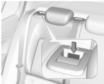
Les dossiers arrière ne sont verrouillés que si les repères rouges des poignées de déverrouillage des deux côtés ne sont plus visibles.
