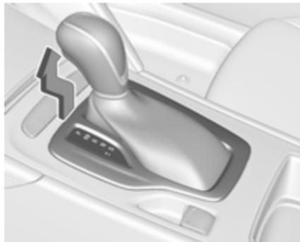
2. Dégager la garniture du levier sélecteur de la console centrale. Appuyer avec un doigt sur la poche en cuir à côté du levier sélecteur et tirer la garniture
