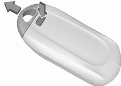
Appuyer sur le bouton de la clé électronique et retirer la lame de la clé.
