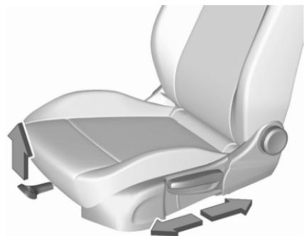
Tirer la poignée, déplacer le siège et relâcher la poignée. Essayer de déplacer le siège d'avant en arrière pour s'assurer qu'il est bien verrouillé en place.
