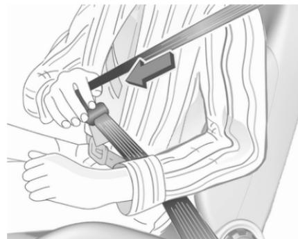
Tirer la ceinture hors de l'enrouleur, la guider sur le corps sans la vriller et insérer le verrou plat dans la serrure. S'assurer que la sangle soit bien serrée sur le corps pendant la conduite.
