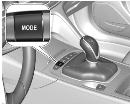
Sur les véhicules dotés des modes de conduite FlexRide, le conducteur peut légèrement augmenter l'accélération du régulateur de vitesse adaptatif lorsque le mode sport est sélectionné. Cette fonction peut être désactivée dans le menu de visualisation FlexRide  $\Rightarrow$  184.
