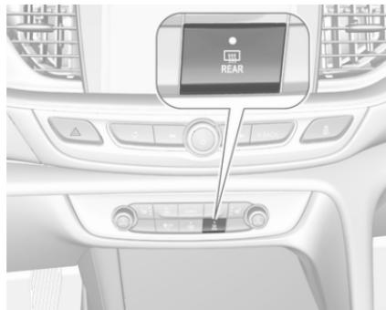
Le chauffage de la lunette arrière et des rétroviseurs extérieurs est déclenché par une pression sur
