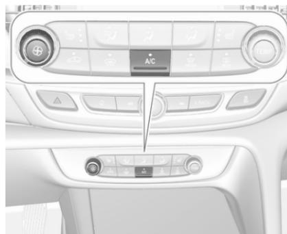
Appuyer sur **A/C** pour mettre le refroidissement en marche. L'activation est indiquée par la diode du bouton. Le refroidissement ne fonctionne que lorsque le moteur est en marche et que le ventilateur de commande de climatisation est en fonction.
