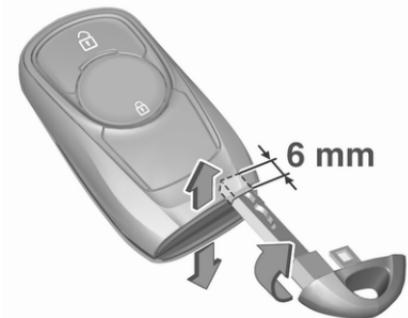
2. Insérer de nouveau la panne de la clé sur environ 6 mm et tourner la clé pour ouvrir le boîtier. Une insertion plus profonde de la clé peut endommager le boîtier.
