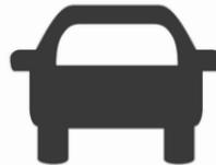
Le témoin de véhicule à l'avant allumé en vert
