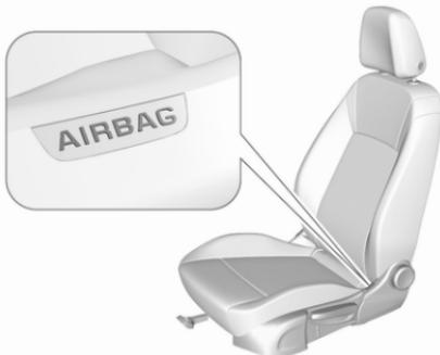
Le système d'airbag latéral se compose d'un airbag dans chacun des dossier de siège avant et dans les dossier des sièges arrière extérieurs. Ils sont reconnaissables à l'inscription **AIRBAG**.
