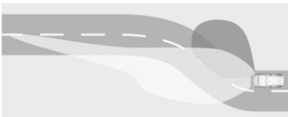
En fonction de la direction du virage et de la vitesse du véhicule et afin d'améliorer l'éclairage, des diodes spécifiques ainsi que l'intensité de celles-ci sont également adaptées dans les virages.
