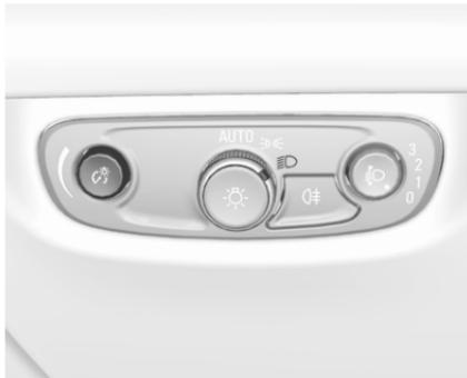
La luminosité des phares suivants peut être réglée en position **AUTO** lorsque le capteur de lumière détecte des conditions de nuit, ou en position **DE** ou **DO**.
