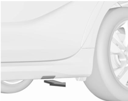
Certains modèles sont dotés de cache-seuils couvrant les points de levage du véhicule : tirer tout d'abord sur le cache du point de levage concerné.
