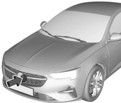
Le radar est monté derrière la calandre du radiateur ou sous l'emblème de la marque.
