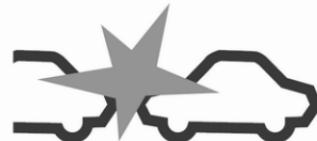
Lorsque le temps avant une collision possible avec le véhicule à l'avant est trop court et que la collision est imminente, le symbole d'alerte de collision s'affiche dans le centre d'informations du conducteur et le conducteur est avisé par une bande LED rouge clignotante ou par le symbole d'une
