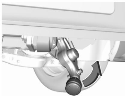
Avec le plat de la main, pivoter la barre d'attelage libérée vers la droite jusqu'à ce qu'elle s'engage sous le plancher. S'assurer que la poignée de déverrouillage est revenue dans sa position initiale cachée, sinon le signal sonore ne s'arrêtera pas.
