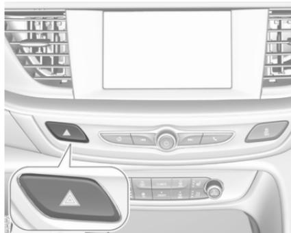
En cas d'accident avec déploiement d'airbag, les feux de détresse sont automatiquement activés.
