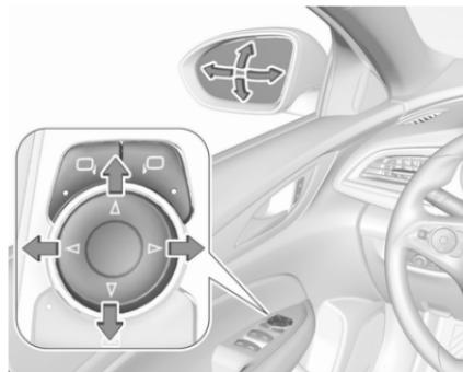
Selectionner le rétroviseur extérieur souhaité en appuyant sur le bouton du rétroviseur gauche ou droit. La diode du bouton indique le rétroviseur sélectionné.
