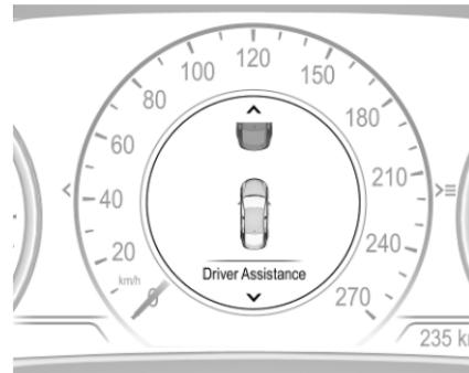
Un symbole de véhicule situé devant apparaît en gris lorsqu'un véhicule a été détecté.
