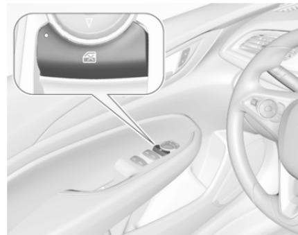
Appuyer sur **RKE** pour désactiver les lève-vitres électriques des portes arrière ; la diode s'allume. Pour l'activation, appuyer à nouveau sur **RKE**.
