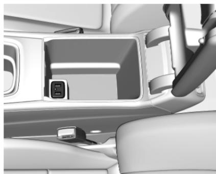
Deux ports de recharge USB se trouvent sous l'accoudoir pliable. Ces ports disposent également d'une connexion de données à l'Infotainment System.
