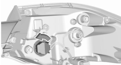
4. Tourner la douille d'ampoule du feu de direction dans le sens antihoraire et la retirer du bloc optique.
