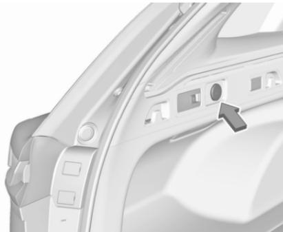
Une prise de courant de 12 V est située sur la cloison gauche du coffre. Quand le contact est coupé, cette prise de courant reste active.
