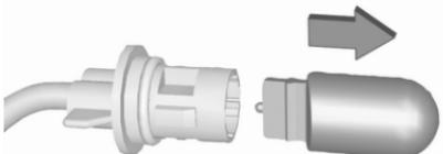
3. Tirer l'ampoule de la douille d'ampoule et la remplacer.
