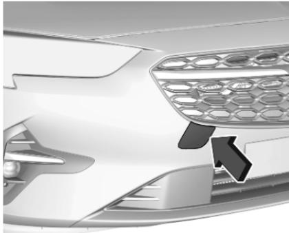
Envelopper d'un linge l'extrémité d'un tournevis plat pour ne pas endommager la peinture. Insérer le tournevis dans la fente sur le bord du capuchon. Libérer le capuchon en faisant doucement levier dessus.
