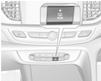
Le chauffage de la lunette arrière et des rétroviseurs extérieurs est déclenché par une pression sur
