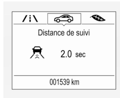
Sur les écrans de niveau médian et supérieur, sélectionner le menu **Info** avec les boutons du volant et appuyer sur **▼** pour sélectionner l'indication de distance de suivi  $\diamond 118$ .
