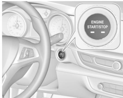
La clé électrique doit se trouver à l'intérieur du véhicule.
