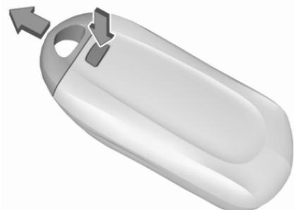
1. Appuyer sur le bouton au dos de la clé électronique et retirer la lame de la clé du boîtier.
