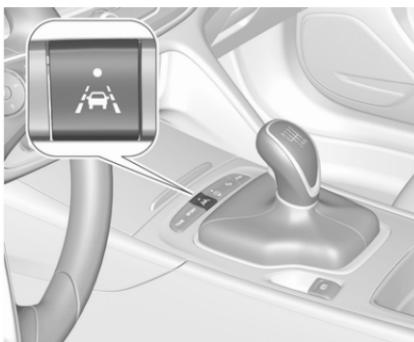
L'assistance au maintien de trajectoire est activée avec le démarrage du moteur ou en appuyant sur
