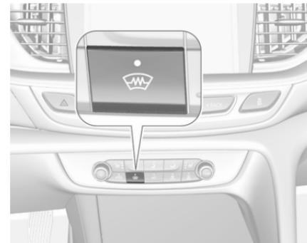
Si le véhicule est équipé d'un pare-brise chauffant, le bouton
