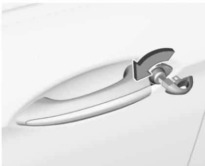
Déverrouiller manuellement la porte du conducteur en introduisant et en tournant la lame de la clé dans le barijet de la serrure.
