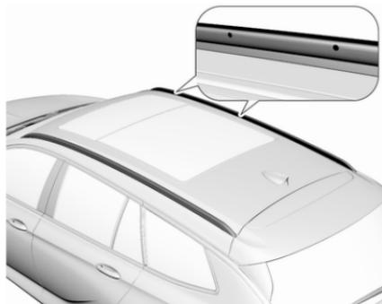
Les points de fixation se trouvent dans les deux rails de toit.
