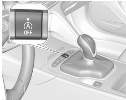
Pour désactiver le système Stop/Start manuellement, appuyer sur
