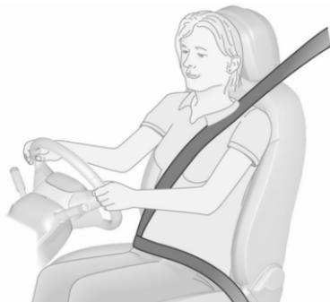
Les ceintures de sécurité sont bloquées lors d'accélérations ou de décélérations fortes du véhicule, ce qui assure le maintien des occupants en position assise. Le risque de blessure est ainsi sensiblement réduit.
