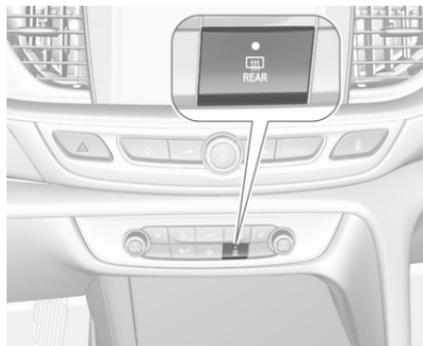
Le chauffage de la lunette arrière et des rétroviseurs extérieurs est déclenché par une pression sur
