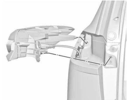
2. Retirer avec précaution l'ensemble de feu du renforcement et le déposer. Veiller à ne pas tirer sur le câble.
