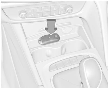
Ouvrir le couvercle de la console centrale en face du levier sélecteur. Placer la clé électronique boutons vers le haut dans la poche de l'émetteur, à côté de la prise de courant, comme indiqué sur l'illustration.
