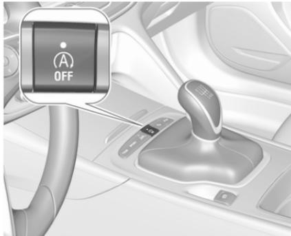
Pour désactiver le système Stop/Start manuellement, appuyer sur
