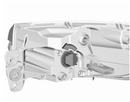
3. Tourner la douille d'ampoule du feu de direction dans le sens anti-horaire et la retirer du bloc optique.
