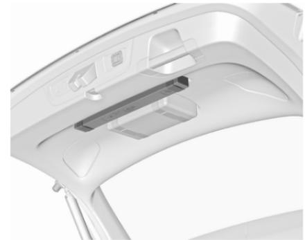
Ranger le triangle de présignalisation sur le panneau intérieur du hayon et le fixer avec les sangles.
