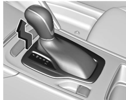
2. Dégager la garniture du levier sélecteur de la console centrale. Appuyer avec un doigt sur la poche en cuir à côté du levier sélecteur et tirer la garniture doucement vers le haut ; un câble y est fixé. Faire glisser la garniture légèrement vers l'avant car elle est montée sur charnière sur son côté arrière. Libérer la garniture en l'inclinant vers la gauche pour éviter de tendre le câble.
