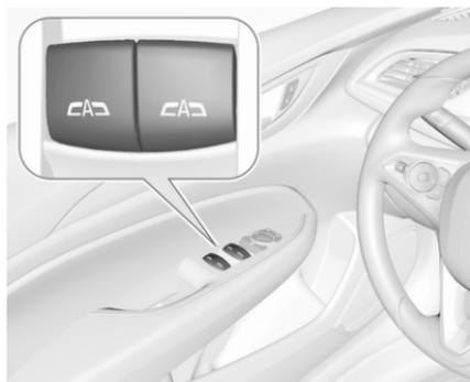
Actionner **CAD** pour la vitre concernée en enfonçant pour ouvrir et en relevant pour fermer.
