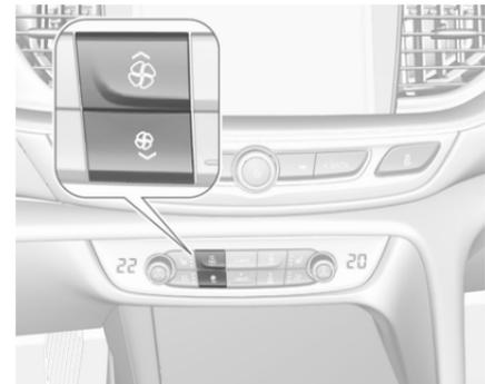
Appuyer sur le bouton supérieur ☼ pour augmenter ou sur le bouton inférieur ☾ pour diminuer la vitesse de la soufflerie. La vitesse de soufflerie est indiquée grâce à une notification dans l'affichage d'informations. La vitesse de la soufflerie peut également être modifiée grâce aux boutons tactiles sur l'affichage des paramètres de la climatisation. Appuyer sur **Climate** pour accéder au menu.
