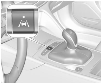
L'assistance au maintien de trajectoire est activée avec le démarrage du moteur ou en appuyant sur
