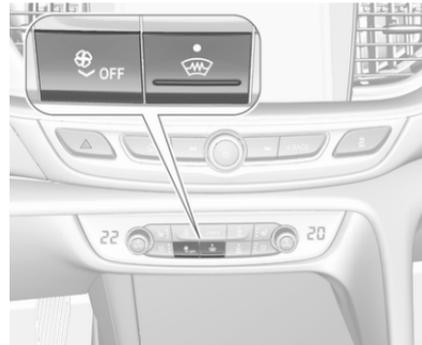
Si le véhicule est équipé d'un pare-brise chauffant, le bouton **ON/OFF** est remplacé par le bouton
