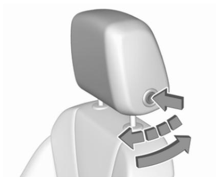
Appuyer sur le bouton de déverrouillage, tirer le coussin de l'appui-tête lentement vers l'avant. Il s'encliquette dans plusieurs positions.
