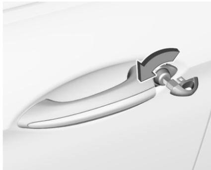
Déverrouiller manuellement la porte du conducteur en introduisant et en tournant la lame de la clé dans le barillet de la serrure.
