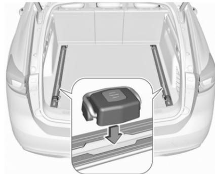
Introduire les chariots dans les rails du plancher du coffre. Utiliser pour cela le logement dans le rail et appuyer sur le bouton du chariot en l'introduisant.
