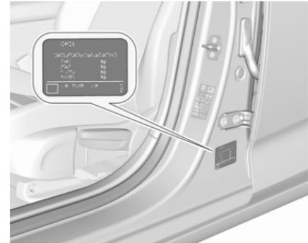
L'étiquette d'identification se trouve sur l'encadrement de la porte avant gauche ou droite.
