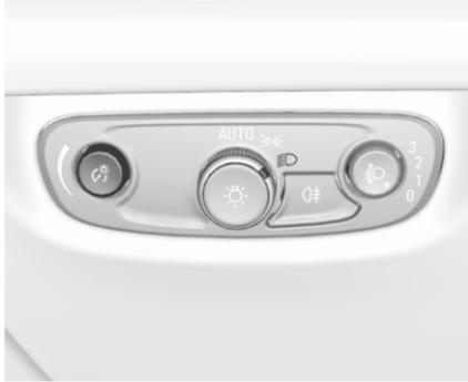
La luminosité des phares suivants peut être réglée en position **AUTO** lorsque le capteur de lumière détecte des conditions de nuit, ou en position  $\text{☀}$  ou  $\text{☾}$ .
