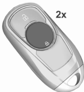
Appuyer deux fois sur
