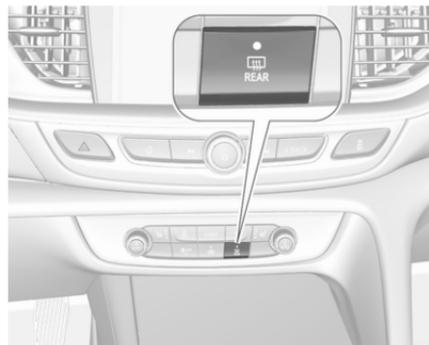
Le chauffage de la lunette arrière et des rétroviseurs extérieurs est déclenché par une pression sur
