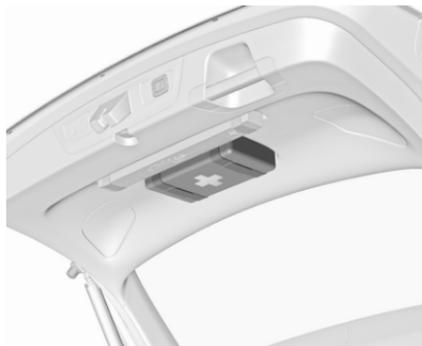
Ranger la trousse de secours sur le panneau intérieur du hayon et le fixer avec les sangles.
