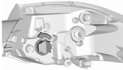
4. Tourner la douille d'ampoule du feu de direction dans le sens anti-horaire et la retirer du bloc optique.
