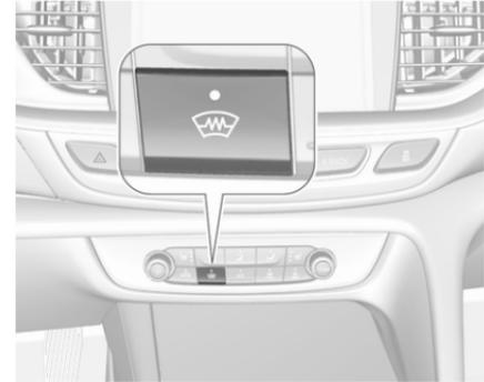
Si le véhicule est équipé d'un pare-brise chauffant, le bouton
