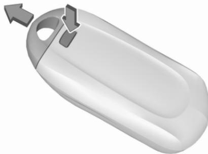
Utiliser la clé de contact ou la lame de clé située dans la clé électronique, pour choisir la position :
