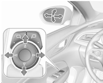
Sélectionner le rétroviseur extérieur souhaité en appuyant sur le bouton du rétroviseur gauche ou droit. La diode du bouton indique le rétroviseur sélectionné.
