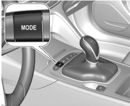
Sur les véhicules dotés des modes de conduite FlexRide, le conducteur peut légèrement augmenter l'accélération du régulateur de vitesse adaptatif lorsque le mode sport est sélectionné. Cette fonction peut être désactivée dans le menu de visualisation FlexRide ↻ 184.
