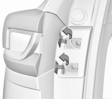
1. Ouvrir les couvercles avec un tournevis. Dévisser et déposer les deux vis.
