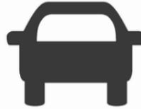
Le témoin de véhicule à l'avant allumé en vert
