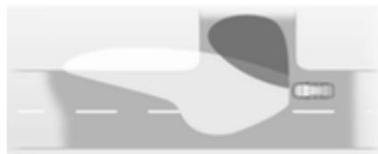
Dans les virages serrés ou lors des changements de direction, en fonction de l'angle de braquage du volant ou des clignotants, un réflecteur
