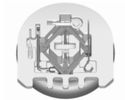
L'équipement de levage et l'outillage du véhicule se trouvent dans le coffre.
