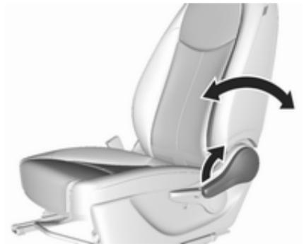
Tirer le levier, régler l'inclinaison et relâcher le levier. Laisser le dossier s'encliqueter de manière audible.
