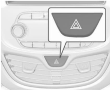
Pour les enclencher, appuyer sur
