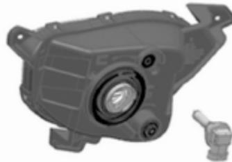
2. Débrancher le connecteur électrique du support d'ampoule.
