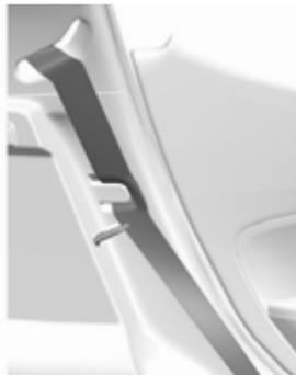
6. Placer les ceintures de sécurité des sièges extérieurs dans les guides de ceinture.
