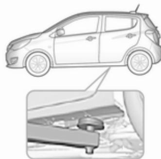
Position du bras arrière du pont élévateur, positionné centralement sous le creux du seuil.
