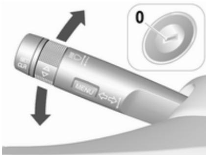
Quand le véhicule est stationné, les feux de stationnement peuvent être allumés d'un côté :
