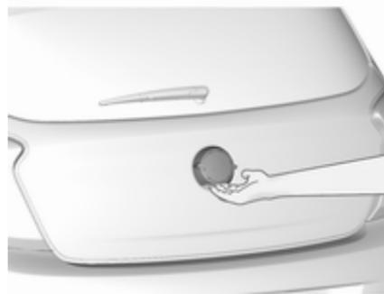
Pour ouvrir le hayon, appuyer sur le commutateur sur le dessous de l'emblème.
