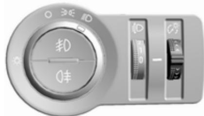
La luminosité des lampes suivantes peut être réglée quand les feux extérieurs sont allumés :
