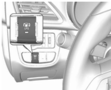
L'actionnement de **LPG** permet le basculement entre les modes de fonctionnement à l'essence et au gaz de pétrole liquéfié dès que les paramètres requis (température de liquide de refroidissement et régime moteur minimal) ont été atteints. Les exigences sont généralement satisfaites après environ 60 secondes (en fonction de la température extérieure) et la première pression ferme sur la pédale d'accélérateur. La LED indique le mode de fonctionnement en cours.
