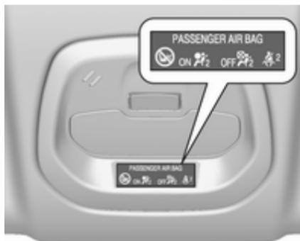
☘<sup>2</sup> pour le siège passager avant s'allume ou clignote en rouge sur la console de pavillon quand le siège est occupé.
