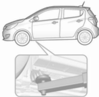
Position du bras avant du pont élévateur au niveau du soubassement.
