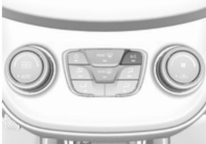
Appuyer sur **A/C** pour mettre le refroidissement en marche. L'activation est signalée par l'éclairage de la LED dans le bouton. Le refroidissement ne fonctionne que lorsque le moteur est
