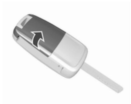
Sortir la clé et ouvrir l'unité latéralement. Remplacer la pile (type CR 2032) en faisant attention à la position de montage. Fermer l'unité et la programmer.
