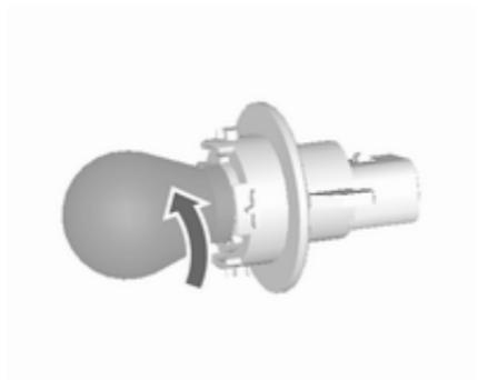
2. Tourner l'ampoule dans le sens antihoraire et l'enlever de la douille.
