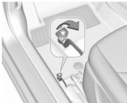
2. Relever le levier de déverrouillage de la trappe à carburant qui se trouve au plancher, côté avant gauche du siège conducteur.
