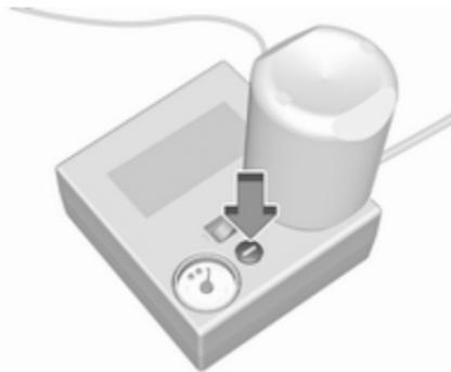
Si la pression des pneus prescrite n'est pas atteinte dans les dix minutes, démonter le kit de réparation de pneus. Avancer ou reculer le véhicule d'un tour de roue. Brancher à nouveau le kit de réparation des pneus et poursuivre la procédure de remplissage pendant dix minutes. Si la pression de gonflage prescrite n'est toujours pas atteinte, c'est que le pneu est trop fortement endommagé. Prendre contact avec un atelier.
