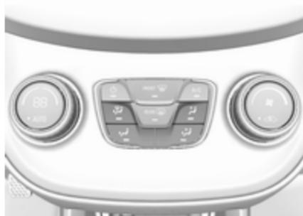
Appuyer sur le bouton correspondant au réglage souhaité. L'activation est signalée par la LED dans le bouton.
