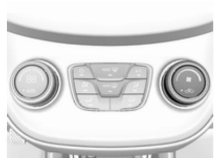
Régler le débit d'air en sélectionnant la vitesse de soufflerie souhaitée. La vitesse de soufflerie sélectionnée est indiquée par un certain nombre de segments sur l'affichage. Si la soufflerie est arrêtée, la climatisation l'est également.
