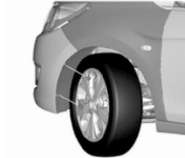
1. Basculer la roulette et déposer les deux écrous poussoirs sur l'extérieur de la garniture.
