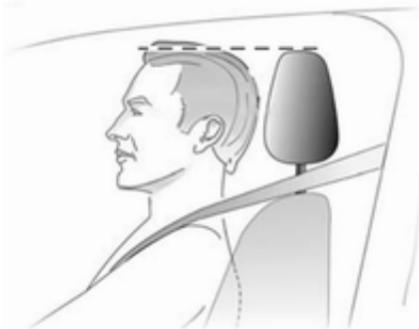
Le bord supérieur de l'appui-tête doit toujours être au niveau du haut de la tête. Si cela s'avérait impossible pour des personnes de très grande taille, l'appui-tête doit être réglé sur la posi-
