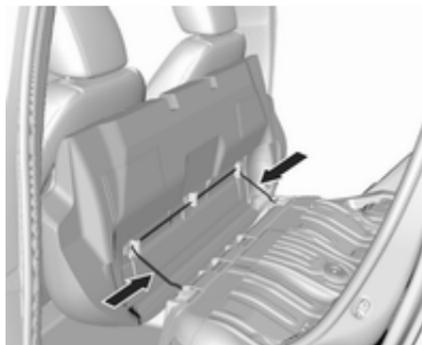
Pour déposer l'assise de siège arrière, pousser les onglets dans le sens de la flèche.
