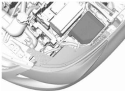
2. Déposer le cache de boîte à fusibles (côté gauche du véhicule uniquement).
