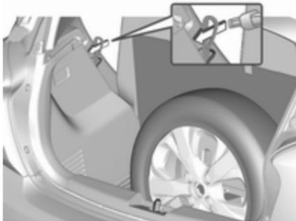
3. Placer la boucle de la sangle de la boîte à outils à travers le loquet du dossier de siège.
