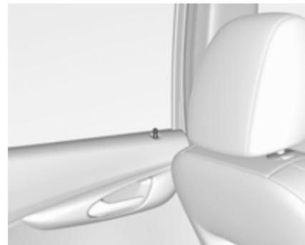
Pour déverrouiller une porte arrière, tirer le bouton de verrouillage intérieur de la porte respective. Ouvrir la porte en tirant la poignée.
