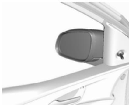
Régler les rétroviseurs en faisant pivoter le levier dans la direction souhaitée.
