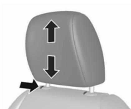
Appuyer sur le bouton de déverrouillage, régler la hauteur et enclencher. Appui-tête ↪ 32.
