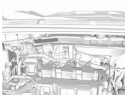
Le numéro d'identification du véhicule se trouve dans le compartiment moteur.
