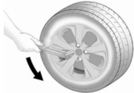
2. Placer la clé de roue en s'assurant qu'elle soit bien positionnée et desserrer chaque vis de roue d'un demi-tour.
