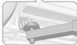
Position du bras avant du pont élévateur au niveau du soubassement.
