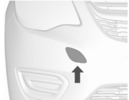
1. Envelopper d'un linge l'extrémité d'un tournevis plat pour ne pas endommager la peinture. Libérer le capuchon en utilisant un tournevis et enlever le capuchon.
