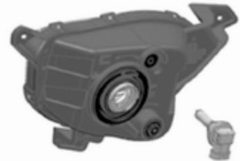
2. Débrancher le connecteur électrique du support d'ampoule.
