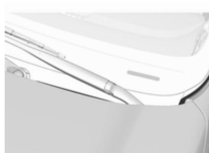
Le numéro d'identification du véhicule peut être estampé sur le tableau de bord, il est alors visible à travers le pare-brise.
