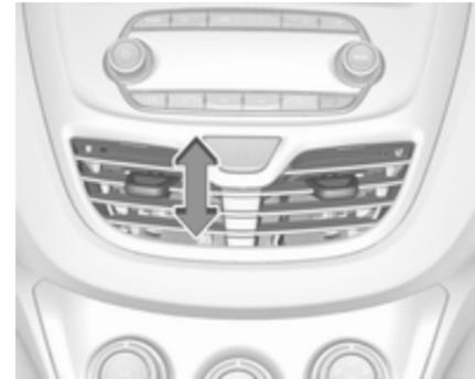
Régler la direction du flux d'air en faisant basculer les lamelles.
