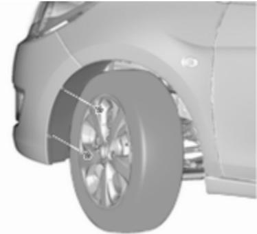
1. Basculer la roulette et déposer les deux écrous poussoirs sur l'extérieur de la garniture.
