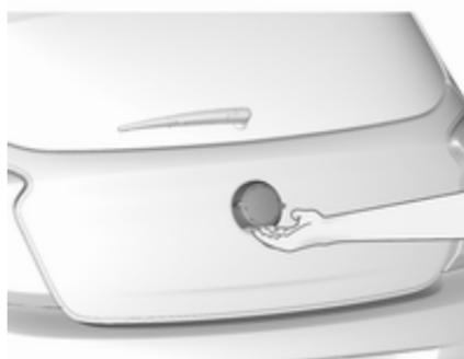
Pour ouvrir le hayon, appuyer sur le commutateur sur le dessous de l'emblème et le soulever légèrement.
