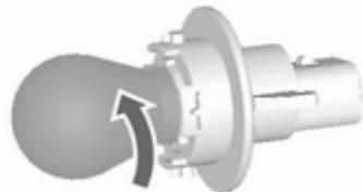
2. Tourner l'ampoule dans le sens antihoraire et l'enlever de la douille.
