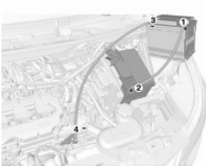
Séquence de raccordement des câbles :
