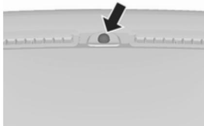
La LED d'état est intégrée dans le capteur sur le haut du tableau de commande.
