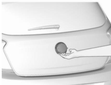
Pour ouvrir le hayon lorsque toutes les portes sont déverrouillées, appuyer sur le commutateur de pavé de la face inférieure de la poignée du hayon et soulever celui-ci.
