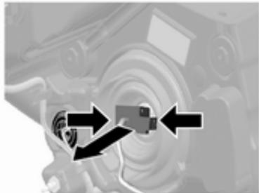
3. Appuyer sur les deux clips en même temps pour débrancher le connecteur enfichable de l'ampoule.
