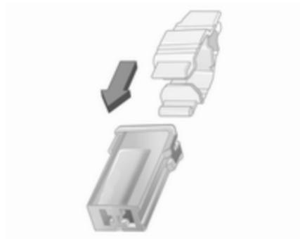
Placer la pince à fusibles par le haut sur les différents types de fusibles et retirer le fusible.
