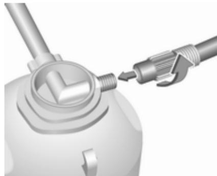
4. Visser le flexible d'air du compresseur sur le raccord de la pompe de produit d'étanchéité.
