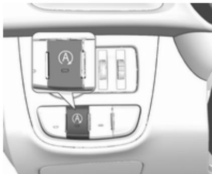
Pour désactiver le système Stop/Start manuellement, appuyer sur  $\text{\textcircled{A}}$ . La désactivation est signalée par l'extinction de la LED dans le bouton.
