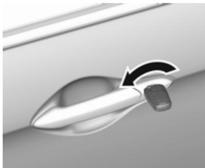
Déverrouiller une porte avant en tournant la clé dans la serrure dans le sens antihoraire. Tirer la poignée pour ouvrir la porte.
