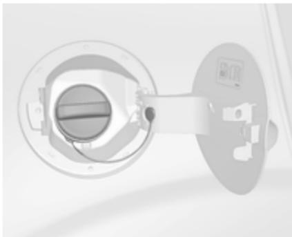
3. Tourner lentement le bouchon à carburant dans le sens antihoraire. Si un sifflement se fait entendre, attendre qu'il s'arrête avant de dévisser totalement le bouchon.
