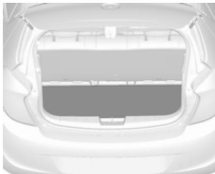
Soulever le tapis de sol arrière pour accéder au kit de réparation des pneus, à l'outillage du véhicule et au triangle de présignalisation.
