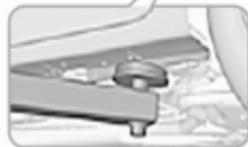
Position du bras arrière du pont élévateur, positionné centralement sous le creux du seuil.
