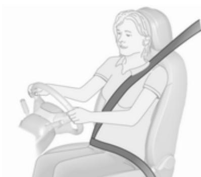
Tirer la ceinture de sécurité et l'attacher dans la boucle de ceinture. La ceinture de sécurité ne doit pas être vrillée et doit être placée près du corps. Le dossier ne doit pas être incliné trop en arrière (environ 25° maximum).
