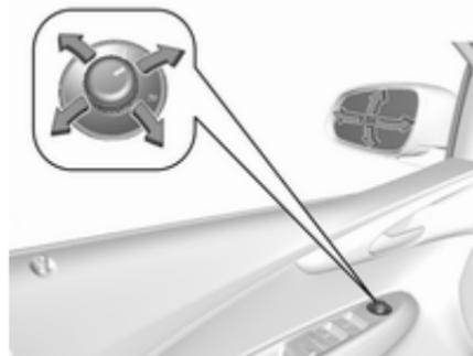
Sélectionner le rétroviseur extérieur souhaité en tournant la commande vers la gauche (L) ou la droite (R). Puis pivoter le bouton de commande pour régler le rétroviseur.
