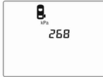
Tourner la molette pour sélectionner le système de surveillance de la pression des pneus.
