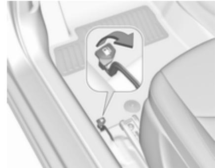
2. Relever le levier de déverrouillage de la trappe à carburant qui se trouve au plancher, côté avant gauche du siège conducteur.
