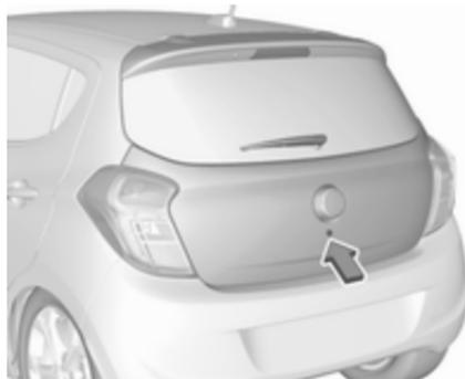
Pour déverrouiller le hayon, introduire la clé dans la serrure et la tourner dans le sens antihoraire à une position horizontale. Soulever le hayon pour l'ouvrir.
