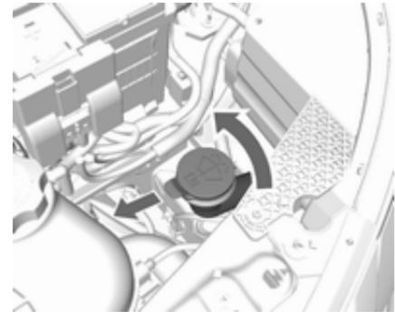
1. Sur le côté gauche du véhicule: faire tourner et tirer le tuyau de remplissage hors du réservoir de liquide de nettoyage du pare-brise.
