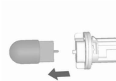
3. Détacher l'ampoule de la douille d'ampoule et la remplacer.
