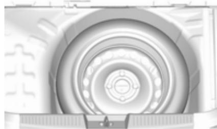
La roue de secours se trouve dans le coffre, sous le recouvrement de plancher. Elle est fixée dans une niche par un boulon papillon.
