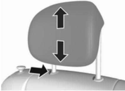
Tirer l'appui-tête vers le haut jusqu'à ce qu'il soit enclenché. Pour le déplacer vers le bas, appuyer sur le loquet pour débloquer et pousser l'appui-tête vers le bas.
