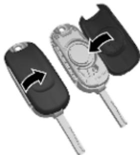
Ouvrir l'unité. Remplacer la pile (type CR 2032) en faisant attention à la position de montage. Fermer l'unité et la programmer.
