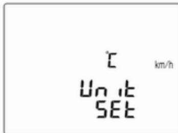
Appuyer sur le bouton **SET/CLR** lorsque la page s'affiche. Sélectionner les mesures métriques (unité 1) ou impériales (unité 2) en tournant la molette de réglage. Appuyer sur **SET/CLR** pour régler l'unité de mesure.
