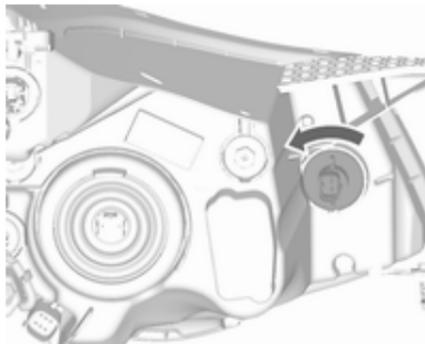
1. Tourner la douille d'ampoule dans le sens antihoraire et l'enlever.
