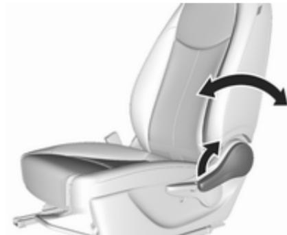
Tirer le levier, régler l'inclinaison et relâcher le levier. Laisser le siège s'encliquer de manière audible.
