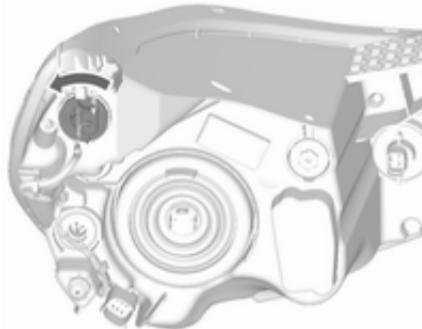
2. Tourner la douille d'ampoule dans le sens antihoraire et l'enlever.
