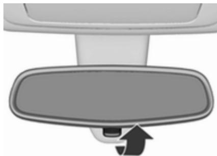
Pour réduire l'éblouissement, régler le levier sous le rétroviseur.
