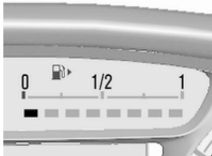
Le nombre de DEL allumées indique le niveau de carburant dans le réservoir à carburant.
