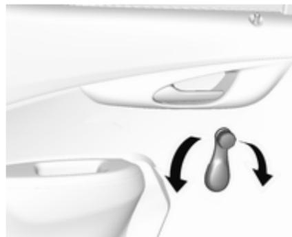
Les vitres de portes peuvent être ouvertes ou fermées manuellement au moyen des manivelles de vitre.
