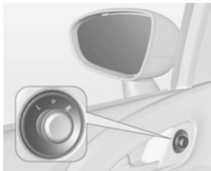
Sélectionner le rétroviseur extérieur correspondant et le régler.
