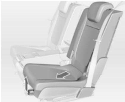
Tirer la poignée et coulisser le siège transversalement vers l'avant en position 2. Le siège est automatiquement guidé vers l'extérieur. Relâcher la poignée et laisser le siège s'encliqueter en position.
