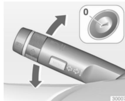
Quand le véhicule est stationné, les feux de stationnement peuvent être allumés d'un côté :
