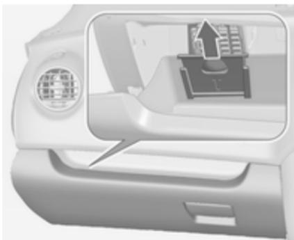
Dans les véhicules avec direction à droite, la boîte à fusibles se trouve derrière un cache dans la boîte à gants. Ouvrir la boîte à gants, tirer le couvercle vers le haut et l'enlever.
