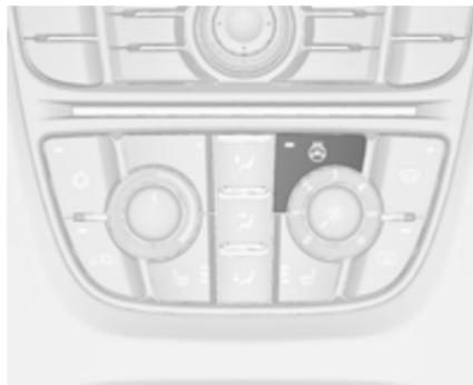
Activer le chauffage en appuyant sur le bouton
