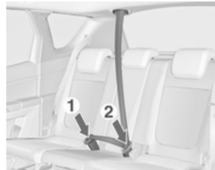
Encliquer le verrou plat inférieur dans la serrure droite (1) du siège central. Enlever le verrou plat supérieur de sa fixation, guider la ceinture (sans la vriller) au-dessus de l'épaule et de la zone abdominale et l'encliquer dans la serrure gauche (2) du siège central.
