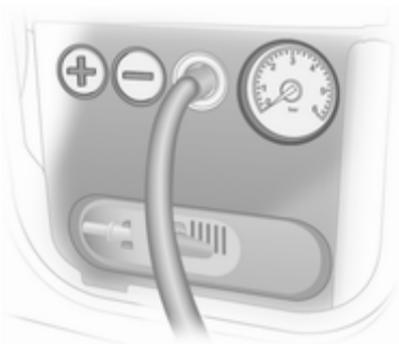
8. Appuyer sur le bouton **+** du compresseur. Le pneu est rempli de produit d'étanchéité.
