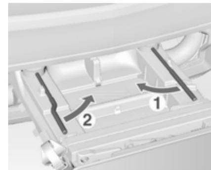
Pivoter d'abord la poignée de verrouillage droite (1), puis celle de gauche (2), jusqu'à ce qu'une résistance soit ressentie.
