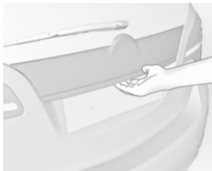
Après le déverrouillage, toucher le commutateur tactile sous la moulure du hayon et ouvrir le hayon.
