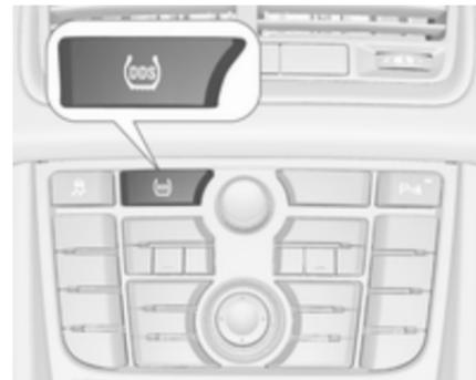
Après un ajustement de la pression de gonflage ou un remplacement de roue, le système doit être initialisé. Mettre le contact, enfoncer et maintenir le bouton **DDS** pendant environ 4 secondes.
