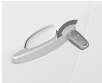
Déverrouiller manuellement la porte du conducteur en tournant la clé dans la serrure. Mettre le contact et appuyer sur le bouton de verrouillage central pour déverrouiller toutes les portes, le coffre et la trappe à carburant. En mettant le contact, le dispositif antivol est désactivé ⇨ 27.
