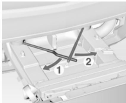
Pivoter tout d'abord à fond d'abord la poignée de verrouillage gauche (1), puis celle de droite (2) jusqu'à ce qu'elles se bloquent en butée.
