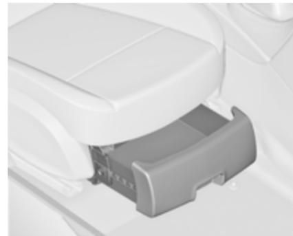
Lever le tiroir sur le bord et tirer pour l'ouvrir. Charge maximale : 3 kg. Pour fermer, repousser le tiroir et l'encliqueter.
