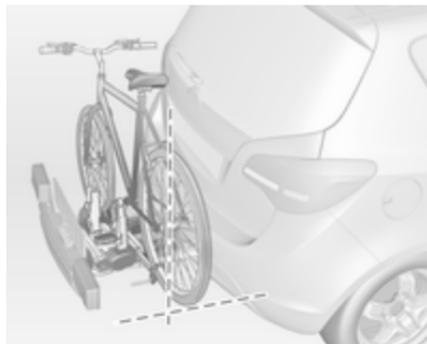
Aligner le vélo dans le sens longitudinal du véhicule : desserrer légèrement la fixation de pédale.
