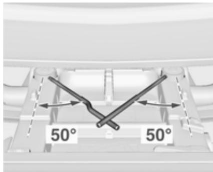
Le système de transport arrière est verrouillé lorsque les poignées de verrouillage sont tournées d'environ 50°. Sinon la fonction de sécurité n'est pas garantie.
