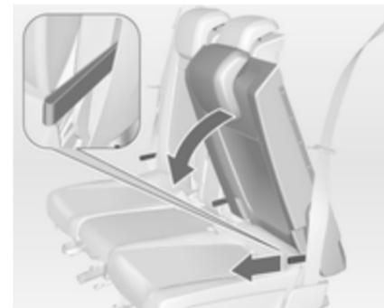
Tirer la poignée sur la face avant du dossier et rabattre le dossier sur l'assise du siège. Le siège s'abaisse automatiquement.
