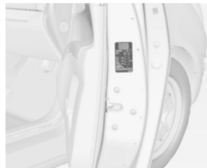
Pression de gonflage ⇨ 210 et sur l'étiquette apposée sur la porte avant côté passager.
