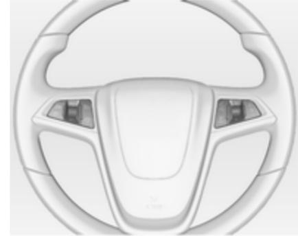
L'Infotainment System, le régulateur de vitesse et un téléphone mobile connecté peuvent être commandés à partir du volant.
