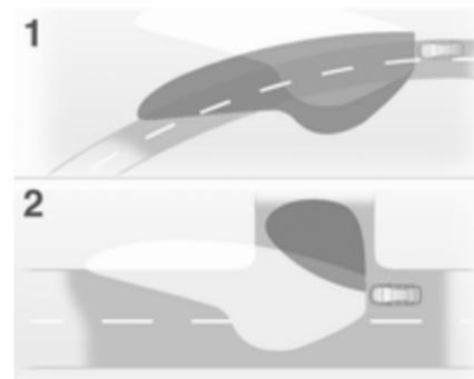
Le faisceau lumineux pivote en fonction de l'angle de braquage et de la vitesse.
