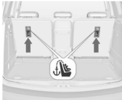
En plus de la fixation ISOFIX, attacher la sangle Top-Tether aux anneaux de fixation Top-Tether. La sangle doit alors passer entre les deux tiges de guidage de l'appui-tête.
