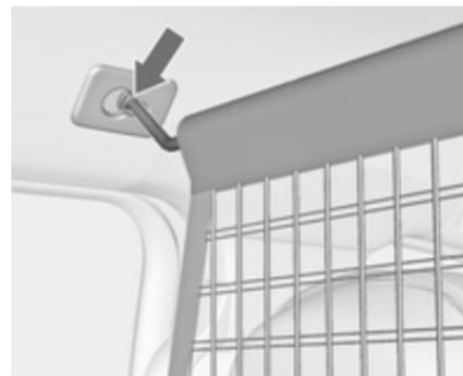
Le cadre de toit est doté de deux ouvertures de montage : suspendre la barre du filet d'un côté, pousser vers l'avant et encliqueter. Étendre la barre, suspendre l'autre côté, pousser vers l'avant et encliqueter.
