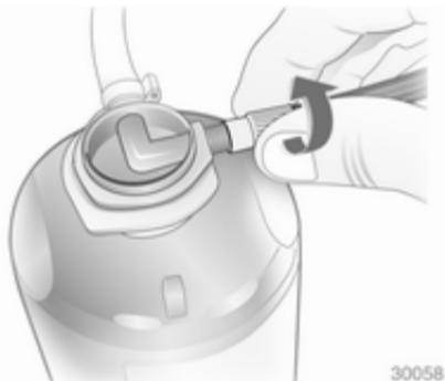
2. Détacher le flexible d'air du support et le visser sur le raccord de la bouteille de produit d'étanchéité.
