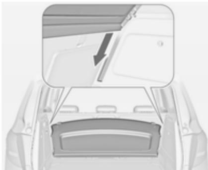
Ranger le cache derrière les sièges arrière.
