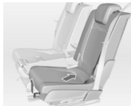
Tirer la poignée et coulisser le siège transversalement vers l'arrière en position 1. Le siège est automatiquement guidé vers l'intérieur. Relâcher la poignée et laisser le siège s'encliqueter en position.
