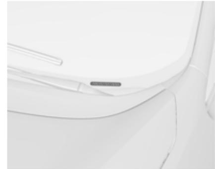
Le numéro d'identification du véhicule peut être estampé sur le tableau de bord et il est alors visible à travers le pare-brise.
