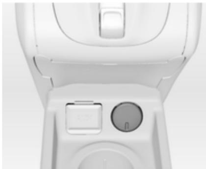
Une prise de courant 12 volt est placée dans la console avant.
