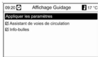
A l'aide de l'option **Info-bulles**, il est possible de déterminer le type d'illustration à montrer lors de l'approche d'une intersection autoroutière.
