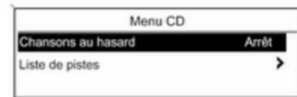
Tournez le bouton multifonction pour marquer la fonction à activer ou à désactiver. Appuyez sur le bouton multifonction pour activer **Mar** ou désactiver **Arrêt** le paramètre.
