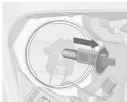
4. Enlever et remplacer l'ampoule.
