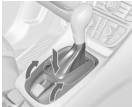
2. Saisir le garnissage du levier sélecteur à l'endroit indiqué et le tirer pour le dégager à l'arrière.
