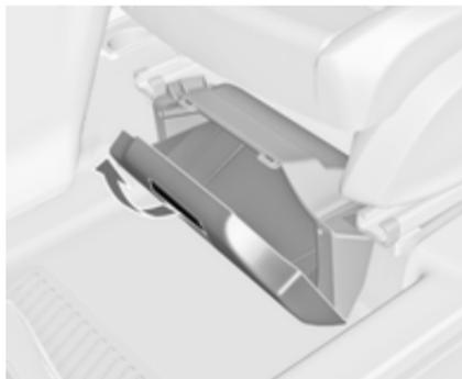
Selon le véhicule, une boîte peut être présente sous le siège du conducteur. Tirer la poignée et rabattre le couvercle. Charge maximum : 1,5 kg.
