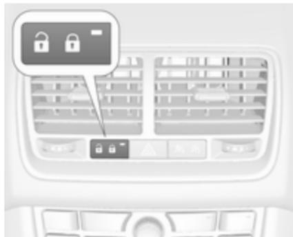
La LED d'état est intégrée dans le bouton du verrouillage central.
