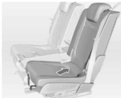
Tirer la poignée et coulisser le siège transversalement vers l'arrière en position 1. Le siège est automatiquement guidé vers l'intérieur. Relâcher la poignée et laisser le siège s'encliquer en position.
