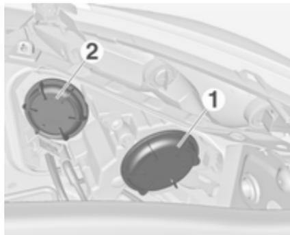
Phares avec systèmes séparés pour les feux de croisement et les feux de routes **1** (ampoules extérieures) et les feux de route additionnels **2** (ampoules intérieures). Le feu de change-
