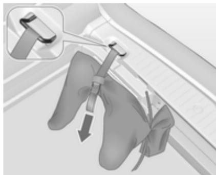
Le sac avec la barre d'attelage est rangé dans le compartiment de rangement arrière sur le plancher. Introduire la sangle à travers l'anneau d'arrimage et serrer la sangle pour fixe le sac.
