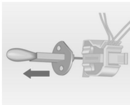
3. Enlever et remplacer l'ampoule.
