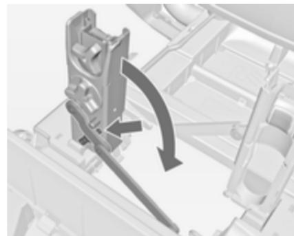
Désencliqueter le levier de verrouillage du support diagonal et rabattre les deux logements de manivelle de pédale.
