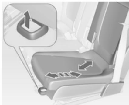
Il est possible d'avancer ou reculer individuellement les sièges arrière extérieurs. Les sièges peuvent être déplacés dans le sens longitudinal et transversal.
