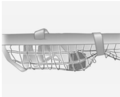
Attacher la bande Velcro en la serrant autour du filet au niveau des dispositifs de réglage de longueur. Les dispositifs de réglage de longueur et les barres du filet doivent être posés à plat l'un à côté de l'autre.
