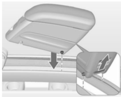
Appuyer sur le bouton arrière et introduire les broches de guidage arrière dans les rails de guidage supérieurs. Relâcher le bouton.
