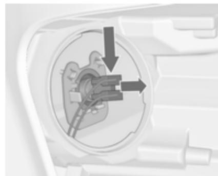
2. Pousser la douille d'ampoule vers le bas et extraire la douille d'ampoule du réflecteur.
