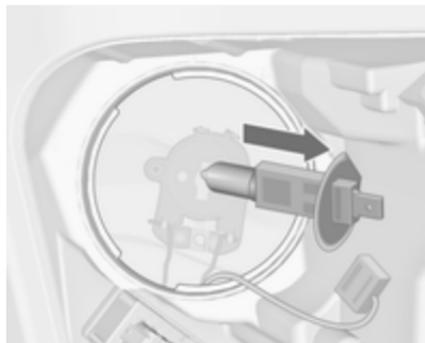
4. Enlever et remplacer l'ampoule.
