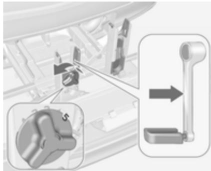
Grâce au levier rotatif du logement de manivelle de pédale, adapter grossièrement l'ensemble réglable pour manivelle au débordement de la manivelle de pédale.
