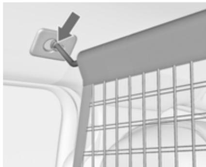
Le cadre de toit est doté de deux ouvertures de montage : suspendre la barre du filet d'un côté, pousser vers l'avant et encliquer. Étendre la barre, suspendre l'autre côté, pousser vers l'avant et encliquer.
