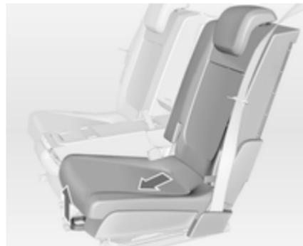
Tirer la poignée et coulisser le siège transversalement vers l'avant en position 2. Le siège est automatiquement guidé vers l'extérieur. Relâcher la poignée et laisser le siège s'encliquer en position.
