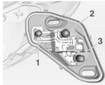
6. Enlever et remplacer l'ampoule.
