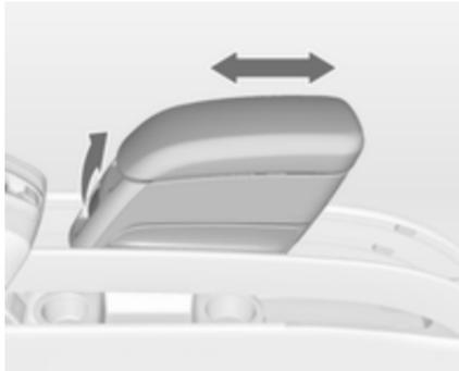
Tirer légèrement sur la poignée avant et déplacer l'accoudoir dans la position souhaitée. Relâcher la poignée. Déplacer l'accoudoir jusqu'à ce qu'il s'engage de manière audible.
