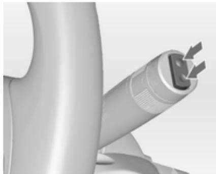
Appuyer sur le commutateur à bascule pour actionner l'essuie-glace de lunette arrière :
