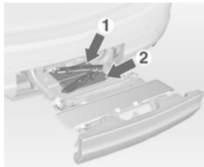
Replier les supports d'ampoules au dos des feux arrière.
