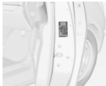
Pression de gonflage ⇨ 212 et sur l'étiquette apposée sur la porte avant côté passager.
