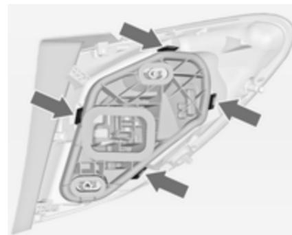
5. Déverrouiller les quatre pattes de fixation et enlever le support d'ampoule.
