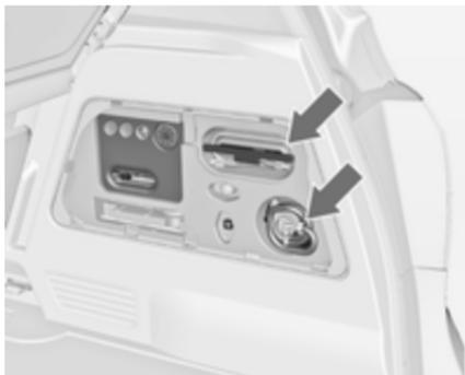
1. Sortir la bouteille de produit d'étanchéité et le support avec le flexible d'air de leur logement.
