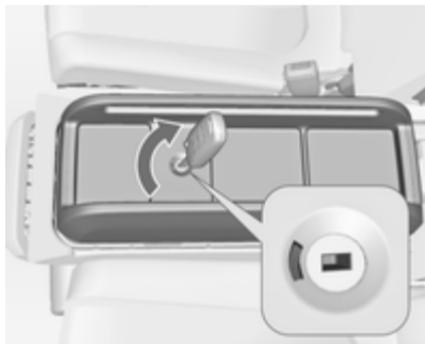
Verrouiller l'adaptateur en tournant la clé de contact dans la serrure dans le sens horaire. L'adaptateur est correctement verrouillé quand le repère vert est visible.
