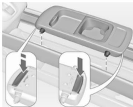
Enfoncer les boutons à l'avant et à l'arrière et introduire les broches de guidage dans les rails de guidage supérieurs ou inférieurs. Le bouton avant doit être enfoncé fermement. Relâcher les boutons et déplacer le porte-gobelets jusqu'à ce qu'il s'engage de manière audible.
