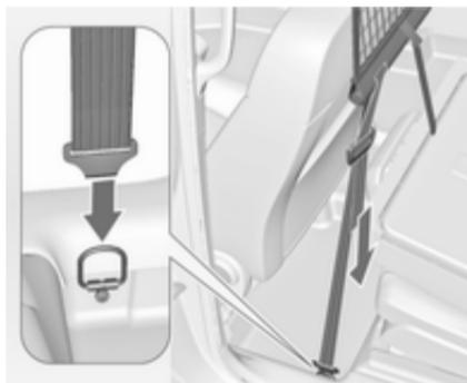
Accrocher les crochets des sangles de tension du filet dans les anneaux d'arrimage du plancher, derrière les sièges avant. Tendre le filet en tirant l'extrémité libre de la sangle.
