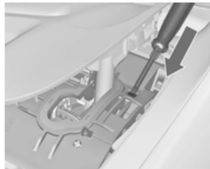
5. Introduire un tournevis aussi loin que possible dans l'ouverture et déplacer le levier sélecteur hors de la position **P** ou **N**. Si la position **P** ou **N** est à nouveau engagée, le levier sélecteur se verrouillera à nouveau dans cette position. Faire corriger la cause de la coupure de courant par un atelier.
