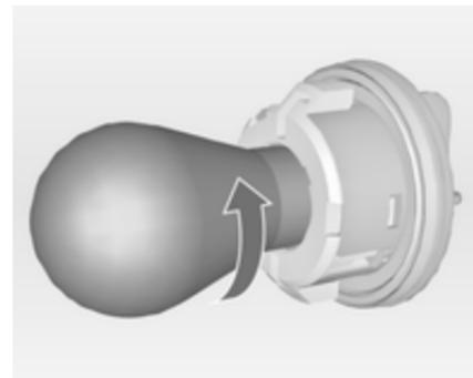
2. Tourner l'ampoule dans le sens antihoraire et l'enlever de la douille.
