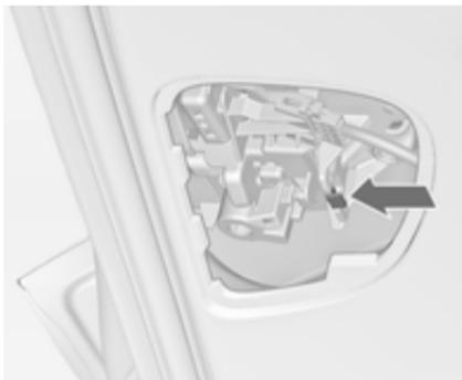
2. Enfoncer la patte de fixation et enlever le support d'ampoule par le bas.
