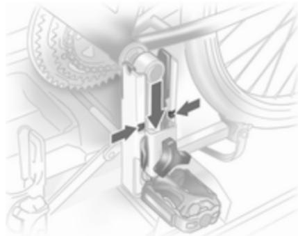
Introduire la fixation de manivelle dans le rail de chaque logement de manivelle depuis le haut et la coulisser vers le bas au moins jusqu'aux encoches.
