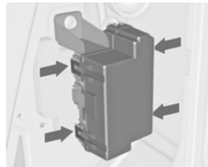
Déverrouiller les quatre pattes de fixation et enlever le couvercle.
