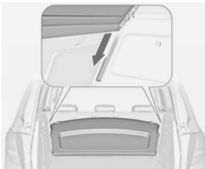
Ranger le cache derrière les sièges arrière.
