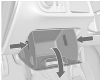
Dans les véhicules avec direction à gauche, la boîte à fusibles se trouve derrière le compartiment de rangement du tableau de bord.
