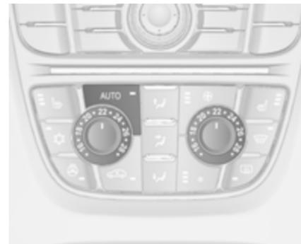
Si la température minimale est réglée, la climatisation fonctionne avec sa capacité maximale de refroidissement.
