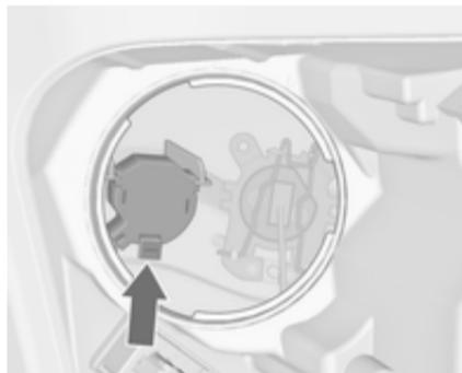
2. Comprimer le loquet et retirer la douille d'ampoule du réflecteur.
