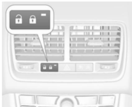
Appuyer sur le bouton de verrouillage central : les portes sont verrouillées ou déverrouillées. Si les portes sont verrouillées, la LED du bouton est allumée.
