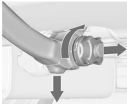
Ouvrir le volet de protection et tourner la clé dans le sens horaire pour déverrouiller la barre d'attelage.
