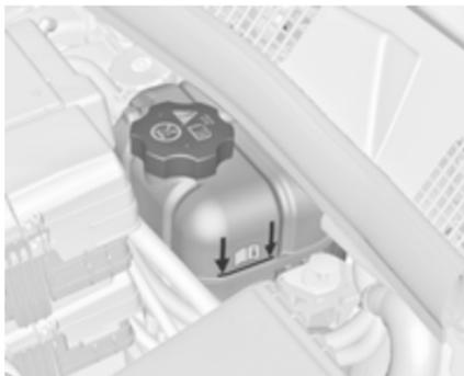
Si le système de refroidissement est froid, le niveau de liquide de refroidissement doit se trouver au-dessus du repère de niveau de remplissage. Faire l'appoint si le niveau est bas.
