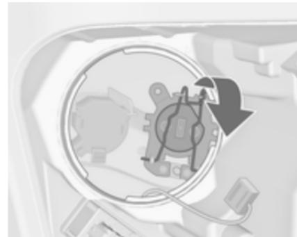
3. Désencliqueter l'attache ressort, puis la pivoter vers l'arrière.
