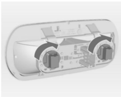
3. Tourner la douille d'ampoule dans le sens horaire et l'enlever.
