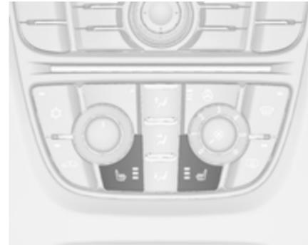
En fonction du niveau de chauffage voulu, appuyer une ou plusieurs fois sur le bouton
