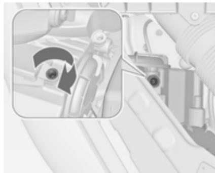
À l'aide du tournevis, tourner les vis de réglage d'un demi-tour dans le sens horaire.
