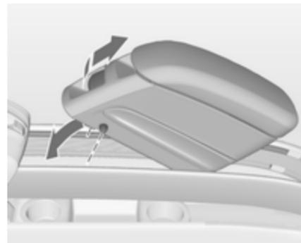
Abaisser l'avant de l'accoudoir. Tirer fermement la poignée avant et introduire les broches de guidage avant dans les rails de guidage supérieurs. Relâcher la poignée. Déplacer l'accoudoir jusqu'à ce qu'il s'engage de manière audible.
