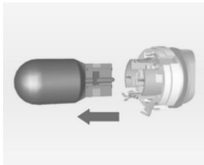
2. Détacher l'ampoule de la douille d'ampoule et la remplacer.
