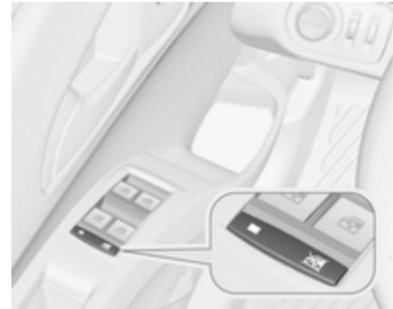
Appuyer sur le commutateur
