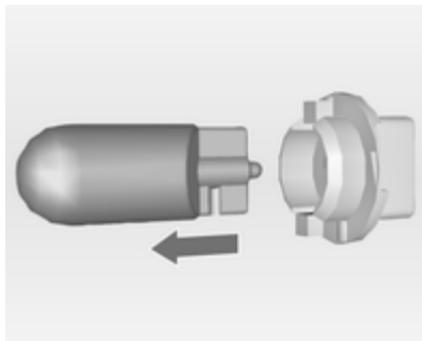
4. Sortir l'ampoule de la douille et la remplacer.
