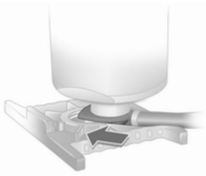
3. Positionner la bouteille de produit d'étanchéité sur le support. S'assurer que la bouteille ne tombe pas.
