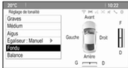
Pour régler la répartition du volume entre les haut-parleurs avant et arrière du véhicule, sélectionnez le point de menu **Fondu**. Effectuez le réglage désiré.
