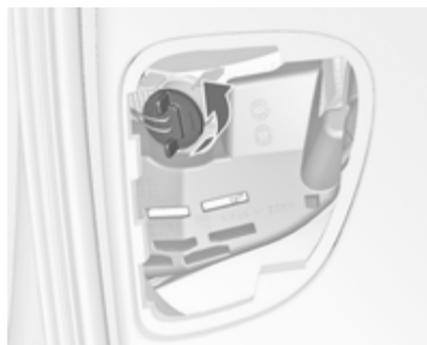
2. Faire tourner la douille de l'ampoule dans le sens antihoraire pour la désencliqueter. Retirer la douille de l'ampoule.
