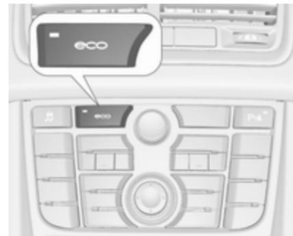
Pour désactiver le système Stop/Start manuellement, appuyer sur **eco**. La désactivation est signalée par l'extinction de la LED du bouton.
