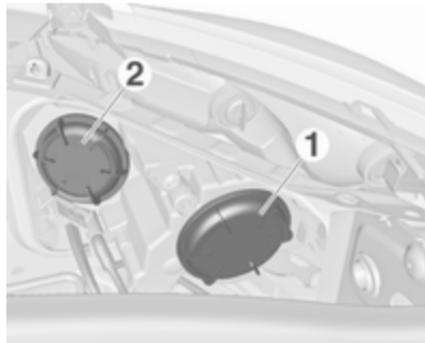
Phares avec systèmes séparés pour les feux de croisement et les feux de routes **1** (ampoules extérieures) et les feux de changement de direction **2** (ampoules intérieures).
