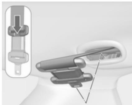
Pousser le verrou plat supérieur dans la fixation. Replier les verrous plats assemblés contre la sangle de ceinture.
