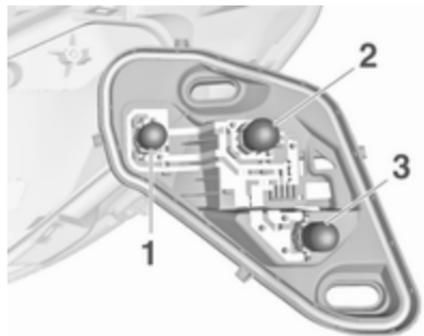
6. Enlever et remplacer l'ampoule.
