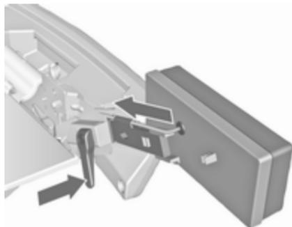
Enfoncer la poignée de verrouillage et pousser le support d'ampoule dans le dispositif de retenue jusqu'à ce qu'il s'enclique.
