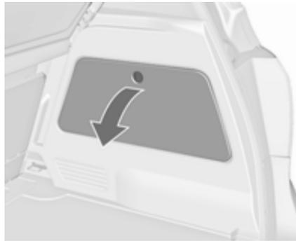
Pour ouvrir le compartiment, désencliqueter le couvercle et l'ouvrir ou, selon la version, lever le couvercle du plancher.
