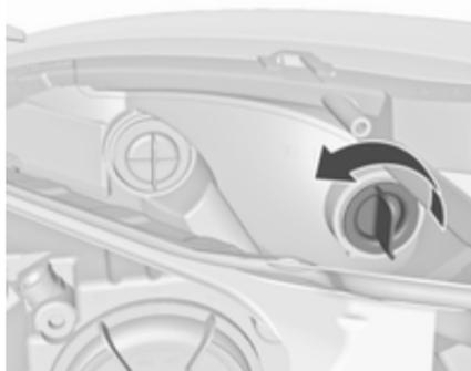
1. Tourner la douille d'ampoule dans le sens antihoraire et l'enlever.
