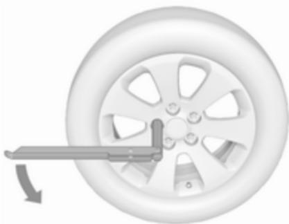
Sortir la clé de roue et la poser en s'assurant qu'elle est bien positionnée, puis desserrer chaque vis de roue d'un demi-tour.
