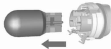
2. Détacher l'ampoule de la douille d'ampoule et la remplacer.
