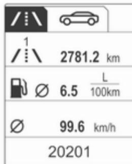
Sur l'affichage de niveau supérieur-combi, les pages de menu peuvent être sélectionnées en pressant **MENU** sur le levier de clignotants ; les symboles de menu sont indiqués sur la ligne supérieure de l'affichage :
