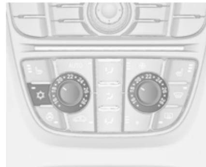
Appuyer sur ☼ pour mettre le refroidissement en marche. L'activation est signalée par la LED dans le bouton. Le refroidissement ne fonctionne que
