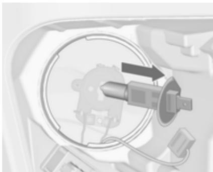
4. Enlever et remplacer l'ampoule.
