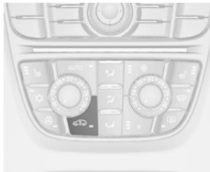
Appuyer sur 🚗 pour activer le mode de recyclage de l'air. L'activation est signalée par la LED dans le bouton.
