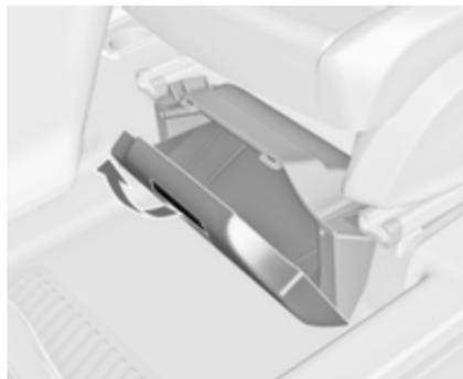
Selon le véhicule, une boîte peut être présente sous le siège du conducteur. Tirer la poignée et rabattre le couvercle. Charge maximale : 1,5 kg.
