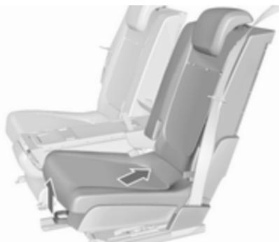
Tirer la poignée et coulisser le siège transversalement vers l'arrière en position 1. Le siège est automatiquement guidé vers l'intérieur. Relâcher la poignée et laisser le siège s'encliquer en position.
