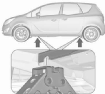
3. Vérifier que le cric est positionné correctement sur un point de levage du véhicule.
