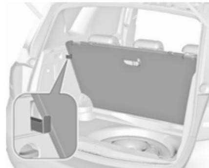
Le couvercle de plancher arrière peut être relevé.
