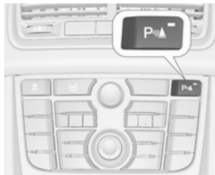
Lorsque la marche arrière est enclenchée, l'aide au stationnement avant et arrière est prête à fonctionner.
