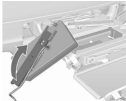
Ouvrir complètement le support d'ampoule au dos du feu arrière.
