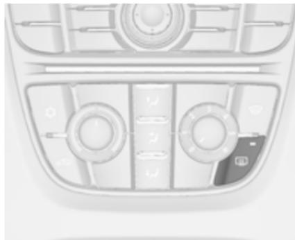
Pour les enclencher, appuyer sur
