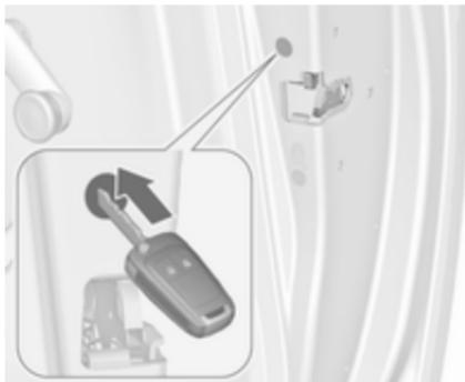
Introduire la clé dans l'ouverture au-dessus de la serrure sur l'intérieur de la porte et opérer la serrure en appuyant jusqu'au déclic. Puis, fermer la porte. La procédure doit être effectuée pour chaque porte. La porte du conducteur peut aussi être verrouillée depuis l'extérieur à l'aide de la clé. La trappe à carburant et le hayon ne peuvent pas être verrouillés.
