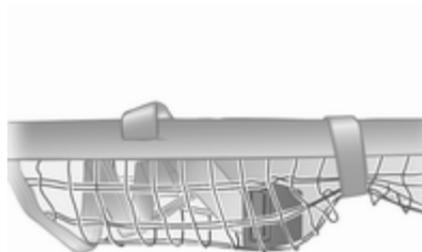
Attacher la bande Velcro en la serrant autour du filet au niveau des dispositifs de réglage de longueur. Les dispositifs de réglage de longueur et les barres du filet doivent être posés à plat l'un à côté de l'autre.
