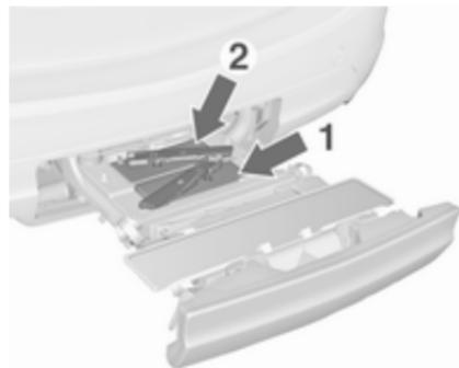
Déposer d'abord le feu arrière (1) puis le feu arrière avant (2) des logements.
