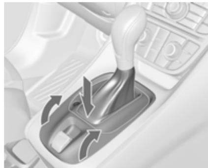
2. Tenir le garnissage du levier sélecteur à l'endroit indiqué et le tirer pour le dégager à l'arrière.
