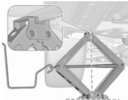
Régler le cric à la hauteur nécessaire. Le positionner juste au-dessous du point de levage de manière telle qu'il ne puisse pas glisser.
