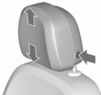
Appuyer sur le bouton de déverrouillage, régler la hauteur et enclencher. Pour procéder au réglage horizontal, tirer l'appui-tête vers l'avant. Il s'enclenche dans plusieurs positions. Pour revenir dans sa position la plus arrière, le tirer totalement vers l'avant et le relâcher.
