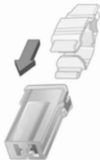
Placer la pince à fusibles par le haut ou le côté sur les différents types de fusibles et retirer le fusible.
