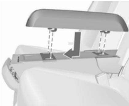
Introduire les crochets de l'adaptateur dans les logements au dos du siège et pousser l'adaptateur vers l'avant.
