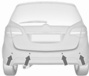
Le système se compose de quatre capteurs de stationnement à ultrasons disposés dans le pare-chocs arrière. Si le véhicule est équipé d'une aide au stationnement avant, le système comporte en plus quatre autres capteurs de stationnement à ultrasons dans le pare-chocs avant.
