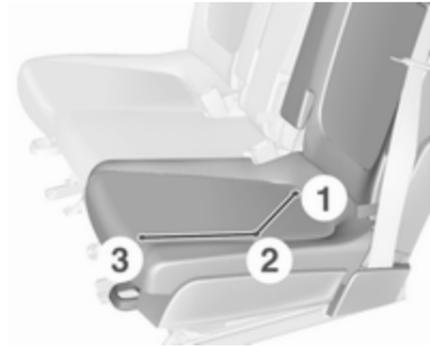
La rangée de sièges arrière peut être configurée en deux sièges procurant un espace d'assise maximum en position 1 ou en trois sièges en position 2. En position 1, le siège central est abaissé.
