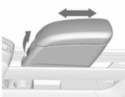
Tirer légèrement sur la poignée avant et déplacer l'accoudoir dans la position souhaitée. Relâcher la poignée. Déplacer l'accoudoir jusqu'à ce qu'il s'engage de manière audible.
