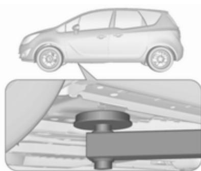
Positionner le bras avant du pont élévateur au niveau du soubassement.
