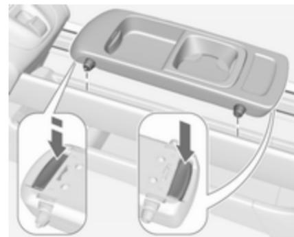
Enfoncer les boutons à l'avant et à l'arrière et introduire les broches de guidage dans les rails de guidage supérieurs ou inférieurs. Le bouton avant doit être enfoncé fermement.
