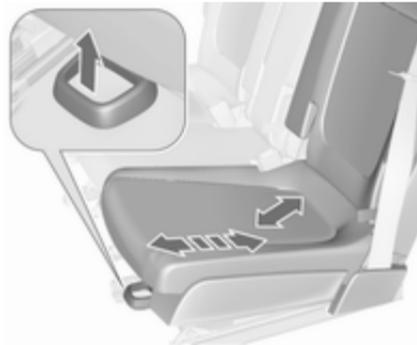
Il est possible d'avancer ou reculer individuellement les sièges arrière extérieurs. Les sièges peuvent être déplacés dans le sens longitudinal et dans le sens transversal.
