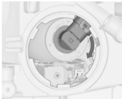
2. Faire tourner la douille de l'ampoule dans le sens horaire pour la désencliqueter. Retirer la douille de l'ampoule du réflecteur.
