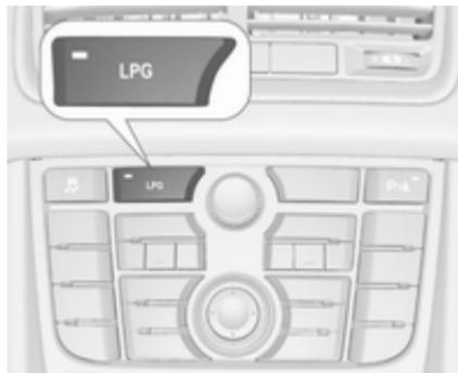
Une pression sur **LPG** permet de choisir entre mode essence et mode gaz de pétrole liquéfié. La LED ● indique le mode de fonctionnement en cours.
