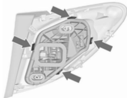
5. Déverrouiller les quatre pattes de fixation et enlever le support d'ampoule.
