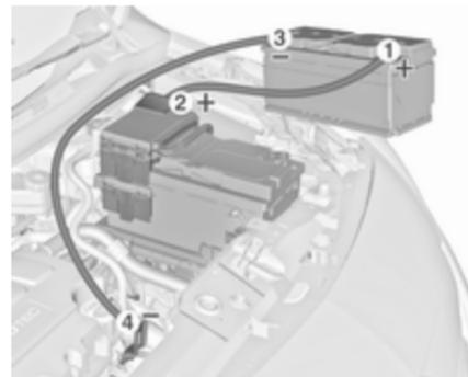
Séquence de raccordement des câbles :
