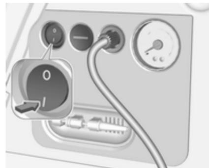
8. Appuyer sur le commutateur marche/arrêt pour mettre le compresseur en marche. Le pneu se gonfle en aspirant le produit d'étanchéité.
