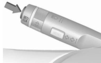
Remettre le compteur kilométrique journalier à zéro en appuyant sur le bouton **SET/CLR** du levier des clignotants pendant quelques secondes ou, sur les véhicules dotés d'un bouton molette de réinitialisation, en appuyant sur le bouton de remise à zéro situé à côté du compteur de vitesse pour la page 1 ou 2 sélectionnée.
