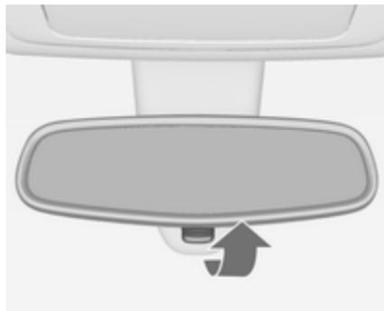
Pour réduire l'éblouissement, ajuster le levier sous le boîtier du rétroviseur. Rétroviseur intérieur ↗ 31, rétroviseur intérieur à position nuit automatique ↗ 31.
