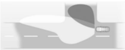
Dans les virages serrés ou lors des changements de direction, en fonction de l'angle de braquage du volant ou des clignotants, un réflecteur supplémentaire, à gauche ou à droite, est
