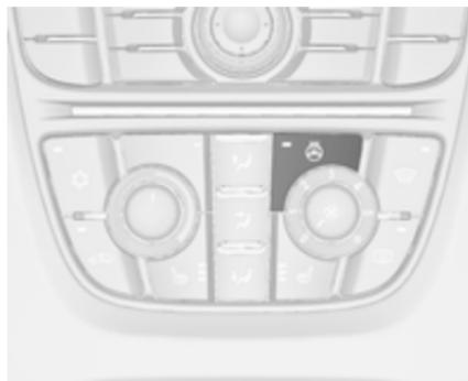
Activer le chauffage en appuyant sur
