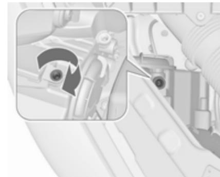
À l'aide du tournevis, tourner les vis de réglage d'un demi-tour dans le sens des aiguilles d'une montre.
