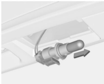
3. Déposer la douille d'ampoule du logement de feu en tournant dans le sens inverse des aiguilles d'une montre.
