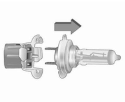
3. Séparer l'ampoule de la douille d'ampoule et remplacer l'ampoule.
