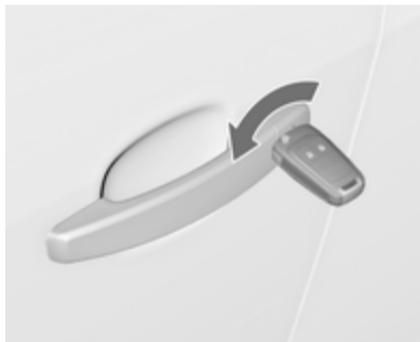
Déverrouiller manuellement la porte du conducteur en tournant la clé dans la serrure. Mettre le contact et appuyer sur le bouton de verrouillage central pour déverrouiller toutes les portes, le coffre et la trappe à carburant.
