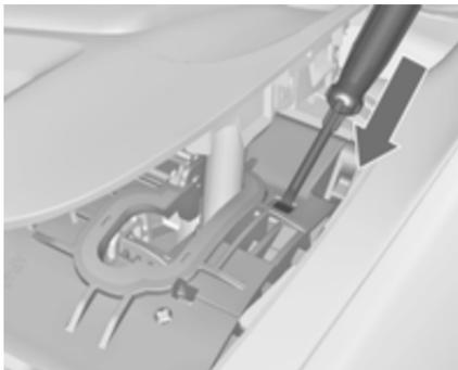
5. Introduire un tournevis aussi loin que possible dans l'ouverture et déplacer le levier sélecteur hors de la position **P** ou **N**. Si la position **P** ou **N** est à nouveau engagée, le levier sélecteur se verrouillera à
