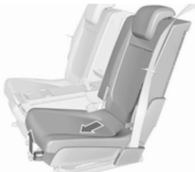
Tirer la poignée et coulisser le siège transversalement vers l'avant en position 2. Le siège est automatiquement guidé vers l'extérieur. Relâcher la poignée et laisser le siège s'encliquer en position.
