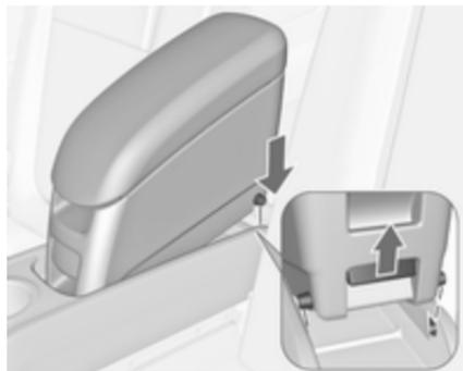
Abaisser l'arrière de l'accoudoir. Tirer fermement la poignée arrière et introduire les broches de guidage arrière dans les rails de guidage. Relâcher la poignée.
