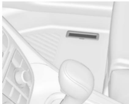
Le numéro d'identification du véhicule est frappé sur la plaquette d'identification et sur le plancher, sous le recouvrement, à l'abri d'un cache.
