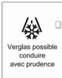
Si la température extérieure chute à 3 °C, un message d'avertissement s'affiche sur le centre d'informations du conducteur doté d'un affichage de niveau supérieur ou d'un affichage de niveau supérieur-combi.
