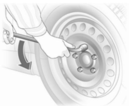
Placer la clé de roue en s'assurant qu'elle est bien positionnée et desserrer chaque vis de roue d'un demi-tour.
