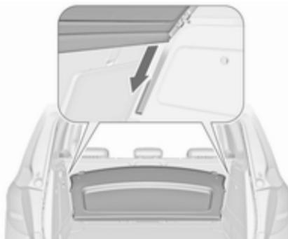
Ranger le cache derrière les sièges arrière.
