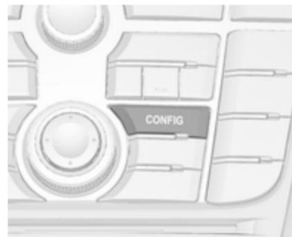
Appuyer sur **CONFIG** de la façade de l'Infotainment System pour entrer dans le menu **Paramètres**.
