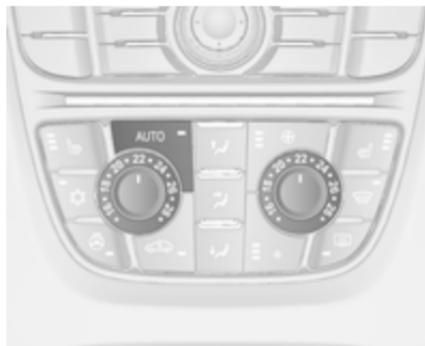
Si la température minimale **Lo** est réglée, le système de commande de climatisation fonctionne avec sa capacité maximale de refroidissement, si le refroidissement
