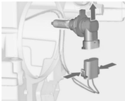
3. Dégager la douille d'ampoule du connecteur en enfonçant les pattes de retenue.
