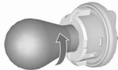
2. Tourner l'ampoule dans le sens antihoraire et l'enlever de la douille.
