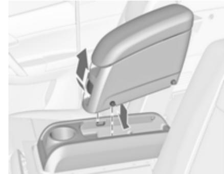
Appuyer sur le bouton avant et introduire les broches de guidage avant dans les rails de guidage. Déplacer l'accoudoir jusqu'à ce qu'il s'engage de manière audible. Relâcher le bouton.
