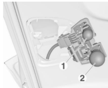
3. Pour remplacer l'ampoule du feu de recul (1), enlever et remplacer l'ampoule.
