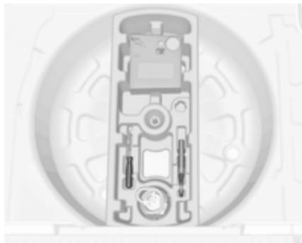
Variante 2 : les outils du véhicule se trouvent dans le compartiment sous le couvercle de plancher dans le coffre, avec le kit de réparation des pneus.
