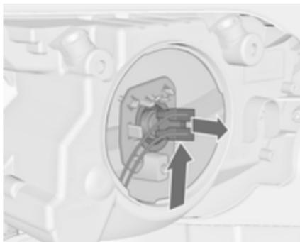
2. Pousser la douille d'ampoule vers le haut et extraire la douille d'ampoule du réflecteur.
