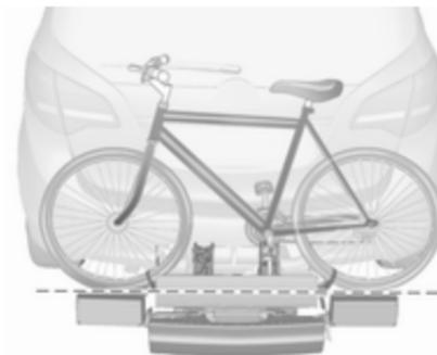
Placer les logements de roue de telle manière que la bicyclette soit à peu près horizontale. La distance entre les pédales et le hayon doit alors être d'au moins 5 cm.
