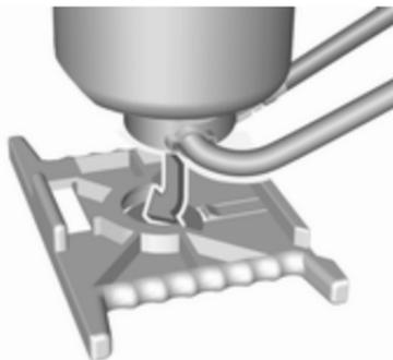
3. Mettre la bouteille de produit d'étanchéité sur le support. S'assurer que la bouteille ne se retourne pas.
