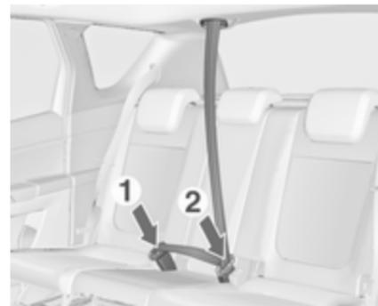
Encliquer le verrou plat inférieur dans la serrure droite (1) du siège central. Enlever le verrou plat supérieur de sa fixation, guider la ceinture (sans la vriller) au-dessus de l'épaule et de la zone abdominale et l'encliquer dans la serrure gauche (2) du siège central.
