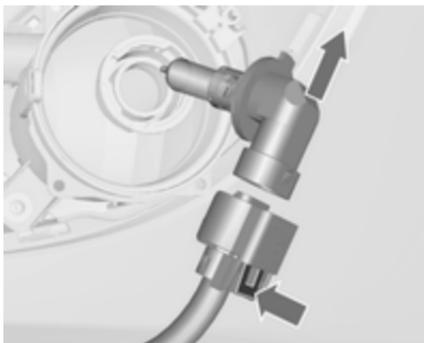
2. Dégager la douille d'ampoule du connecteur en enfouissant la patte de retenue.
