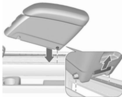
Appuyer sur le bouton arrière et introduire les broches de guidage arrière dans les rails de guidage supérieurs. Relâcher le bouton.
