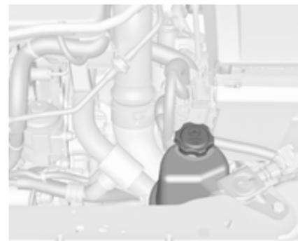
Le niveau du liquide de direction assistée n'a généralement pas besoin d'être vérifié. Si un bruit inhabituel est audible pendant l'utilisation du volant ou si la direction réagit de manière singulière, demander l'aide d'un atelier.
