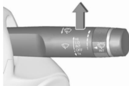
**INT** = balayage automatique avec capteur de pluie
