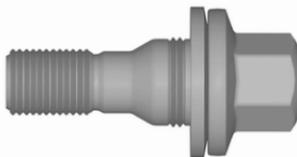
Le couple de serrage des roues en alliage est 115 Nm.
