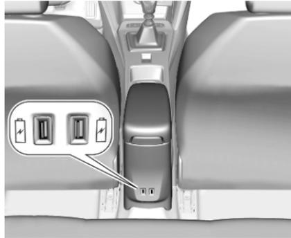
L'emplacement sous les ports USB à l'arrière de la boîte de rangement est destiné à la fixation d'un accessoire porte-gobelets.
