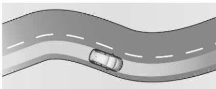
La position actuelle du véhicule dans la voie est ainsi maintenue. Cette position n'est pas nécessairement au centre de la voie.
