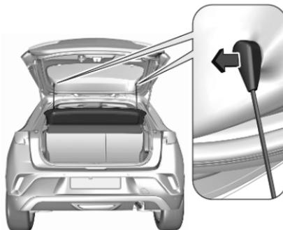
Décrocher les sangles de fixation du hayon.
