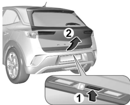
1. Appuyer sur le bouton du hayon ou appuyer longuement sur
