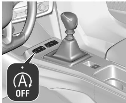
Le système est prêt à fonctionner lorsque la LED du bouton
