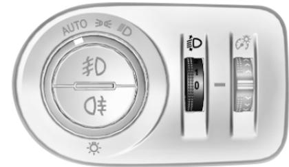
La portée des phares peut être ajustée manuellement si le véhicule n'est pas équipé de phares matriciels à DEL. Les phares matriciels à DEL se règlent automatiquement.
