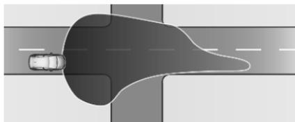
Activé automatiquement à une vitesse maximale d'environ 50 km/h. Le faisceau lumineux est large et symétrique.
