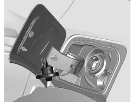
Le bouchon de remplissage de carburant peut être fixé au crochet sur la trappe à carburant.
