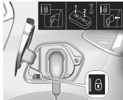
Pendant le chargement, la fiche du véhicule est verrouillée sur le port de chargement et ne peut être débranchée en cours de chargement. L'indicateur
