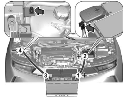
Séquence de raccordement des câbles :
