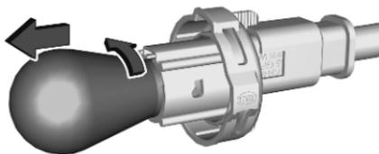
2. Enfoncer légèrement l'ampoule, la faire tourner dans le sens antihoraire et la retirer de la douille.
