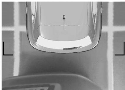
La caméra arrière enregistre les environs du véhicule pendant la manœuvre pour reconstruire une vue depuis le haut de l'arrière ou de l'avant du
