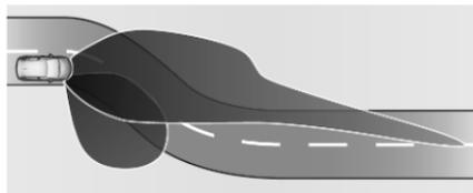
Des LED particulières, basées sur l'angle de braquage et la vitesse, sont en plus déclenchées pour améliorer l'éclairage dans les virages. Cette fonction est activée à des vitesses comprises entre 40 km/h et 70 km/h.
