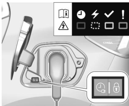
Le début du chargement est indiqué par le clignotement en vert de l'indicateur d'état sur le port de chargement et sur son boîtier de commande.
