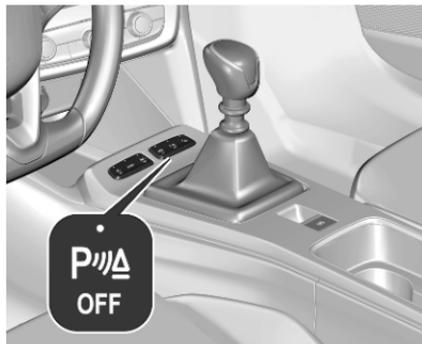
Le système est prêt à fonctionner lorsque la LED du bouton d'aide au stationnement  $P_{\triangle OFF}$  est éteinte. L'état du système est mémorisé lorsque le contact est coupé.
