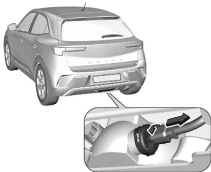
1. Tourner le support d'ampoule dans le sens antihoraire et l'enlever du boîtier du réflecteur.
