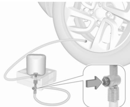
Réduire l'excédent de pression de pneu au moyen du bouton du flexible pneumatique.
