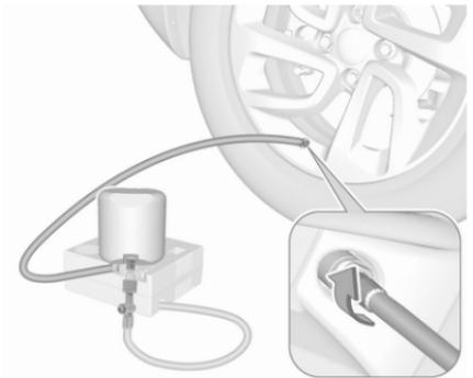
7. Visser le flexible de remplissage sur la valve de pneu.
