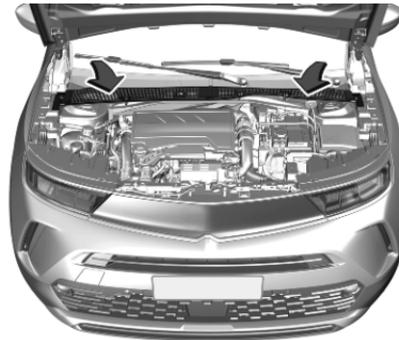
La prise d'air dans le compartiment moteur, à l'extérieur devant le pare-brise, ne doit pas être encombrée. Le cas échéant, enlever les feuilles, les saletés ou la neige.
