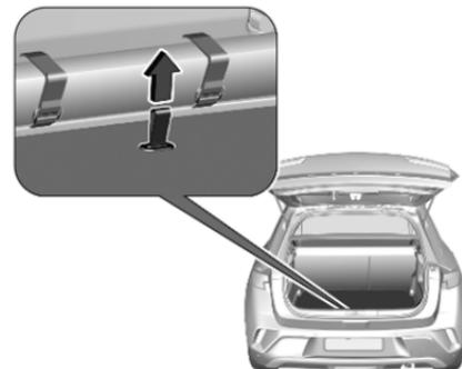
Le recouvrement de plancher arrière peut être soulevé et déposé. Utiliser l'ouverture pour soulever le recouvrement de plancher arrière, puis l'enlever.
