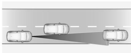
Si un autre véhicule entre dans la même voie de circulation, le régulateur de vitesse adaptatif considérera le véhicule lorsqu'il est complètement sur cette voie. Il faut être prêt à agir et à enfoncer la pédale de frein si un freinage plus rapide est nécessaire.
