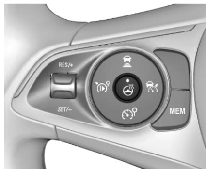
Activer le chauffage en appuyant sur
