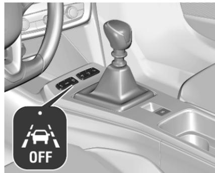
Si le système est activé, la LED du bouton
