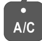
Appuyer sur **A/C** pour mettre le refroidissement en marche. L'activation est signalée par l'éclairage de la LED dans le bouton. Le refroidissement ne fonctionne que lorsque le moteur est en marche et que le ventilateur de commande de climatisation est en fonction.
