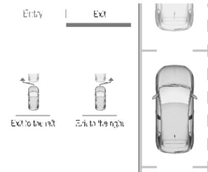
Sélectionner le côté de sortie dans le menu. La P s'allume au combiné d'instruments pour confirmer l'activation du système.
