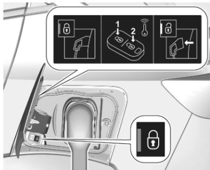
Pendant le chargement, la fiche du véhicule est verrouillée sur le port de chargement et ne peut être débranchée en cours de chargement. L'indicateur
