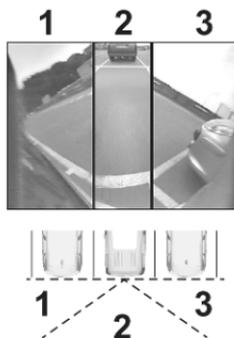
La vue à 180° facilite le recul hors d'un emplacement de stationnement, rendant possible d'observer l'approche des véhicules, des piétons et des cyclistes. Cette vue n'est pas recommandée pour une manœuvre complète. Ceci se compose de trois
