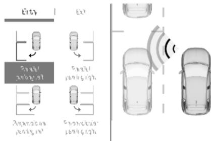
Sélectionner le menu place de stationnement en parallèle. La **P** s'allume au combiné d'instruments pour confirmer l'activation du système.
