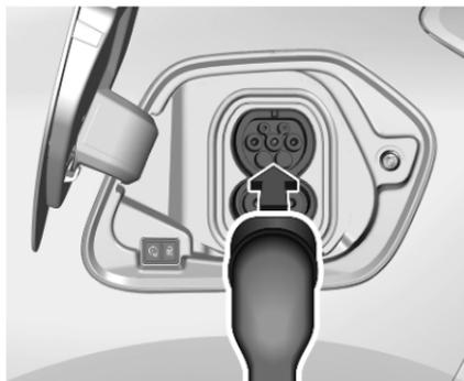
5. Brancher la fiche côté véhicule du câble de chargement dans le port de chargement du véhicule.
