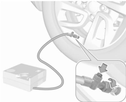
16. Reprendre la route sans délai afin que le produit d'étanchéité se répartisse uniformément dans le pneu. Conduire entre 20 km/h et 60 km/h. Après un trajet d'environ 5 km mais pas plus de 10 minutes, s'arrêter et contrôler la pression du pneu. À cet effet, visser directement le flexible d'air sur la valve du pneu. Remplir le pneu comme décrit plus haut. Réduire l'excédent de pression de pneu au moyen du bouton du flexible pneumatique.
