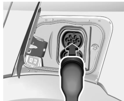
5. Brancher la fiche côté véhicule du câble de chargement en mode 3 dans le port de chargement du véhicule.
