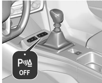
Le système est désactivé lorsque la marche arrière est désengagée. Appuyer sur  $P_{\triangle}$  pour désactiver manuellement le système. La diode du bouton s'allume lorsque le système est désactivé. Si le système a été désactivé manuellement, il n'est pas réactivé automatiquement lors de la suivante mise du contact du véhicule.
