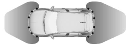
Le système possède des capteurs de stationnement à ultrasons dans les pare-chocs arrière et avant.
