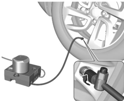
9. Visser le flexible de remplissage sur la valve de pneu.
