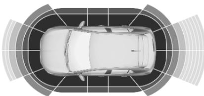
Cette fonction avertit le conducteur par une indication en cas d'obstacles à côté du véhicule. Si l'obstacle se trouve le long du véhicule et dans la trajectoire de conduite et qu'il risque d'entraîner une collision, un signal sonore est émis. Les obstacles à côté du véhicule sont pris en compte uniquement s'ils ont été reconnus précédemment par les capteurs de stationnement et mémorisés par le système.
