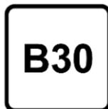
L'utilisation d'un carburant B20 ou B30 conforme à la norme EB16709 est possible dans nos moteurs diesel. Toutefois, cette utilisation, même occasionnelle, exige une application
