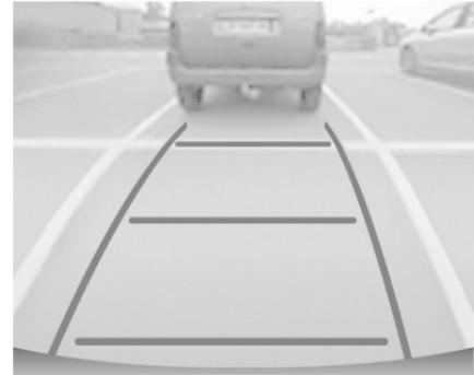
La zone derrière le véhicule est affichée à l'écran. Les lignes verticales représentent la largeur du véhicule avec les rétroviseurs dépliés. La direction des lignes change avec la position du volant de direction.
