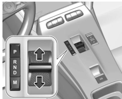
Le véhicule utilise l'unité d'entraînement électrique avec une transmission à 1 vitesse. Le sélecteur se trouve sur la console centrale, entre les sièges.
