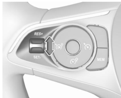
La vitesse maximale présélectionnée peut être réglée en appuyant sur la molette vers **RES/+** pour l'augmenter ou vers **SET/-** pour la diminuer. Déplacer la molette à plusieurs reprises pour modifier la vitesse par petits incréments ; déplacer et maintenir pour modifier la vitesse par grands incréments.
