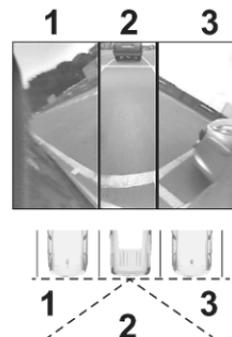
La vue à 180° facilite le recul hors d'un emplacement de stationnement, rendant possible d'observer l'approche des véhicules, des piétons et des cyclistes. Cette vue n'est pas recommandée pour une manœuvre complète. Ceci se compose de trois zones : gauche 1, centre 2 et droite 3. Cette vue est disponible uniquement depuis le menu de sélection de vue.
