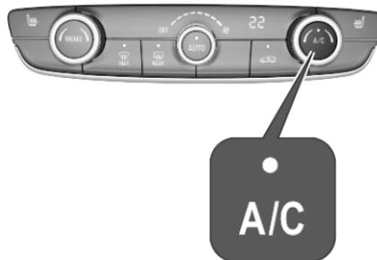
Appuyer sur **A/C** pour mettre le refroidissement en marche. L'activation est signalée par l'éclairage de la LED dans le bouton. Le refroidissement ne fonctionne que lorsque le moteur est en marche et que le ventilateur de commande de climatisation est en fonction.
