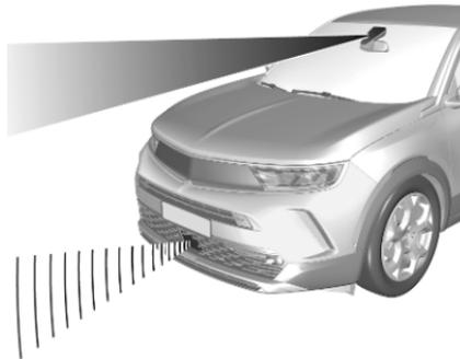
L'alerte de collision avant utilise la caméra avant du pare-brise et, selon la configuration du véhicule, un radar placé derrière le pare-chocs avant pour détecter un véhicule directement à l'avant, sur la trajectoire.
