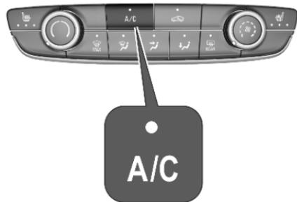
Appuyer sur **A/C** pour mettre le refroidissement en marche. L'activation est signalée par l'éclairage de la LED dans le bouton. Le refroidissement ne fonctionne que lorsque le moteur est en marche et le ventilateur aussi.
