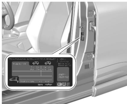
L'étiquette d'information sur la pression des pneus située sur le montant B gauche indique les pneus d'origine et les pressions correspondantes.
