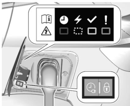
Le début de la charge est indiqué par le clignotement vert de l'indicateur d'état au niveau du port de charge et du boîtier de commande du câble de charge, si disponible.
