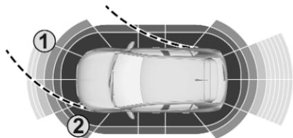
Si l'obstacle (1) se trouve dans la trajectoire de conduite et qu'il risque d'entraîner une collision, un signal sonore est émis.
