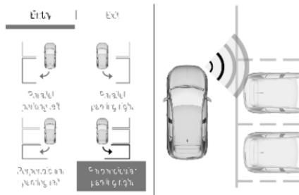
Sélectionner le menu de place de stationnement perpendiculaire. P s'allume au centre d'informations du conducteur pour confirmer l'activation du système.
