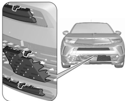
2. Appuyer sur l'extérieur de la partie supérieure des caches de protection contre le froid contre la latte de la calandre.
