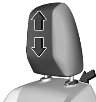
Tirer l'appui-tête vers le haut ou appuyer sur le loquet pour le déverrouiller et abaisser l'appui-tête.
