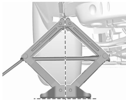
4. Régler le cric à la hauteur nécessaire. Le positionner juste au-
