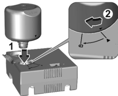
5. Type A : en premier lieu, insérer la bouteille de produit d'étanchéité dans le compresseur et aligner les symboles triangulaires. Ensuite, abaisser la bouteille de produit d'étanchéité et la tourner dans la position de verrouillage.
