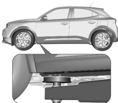
La position de bras avant de la plateforme de levage est centrale sous le point concerné de levage du véhicule.
