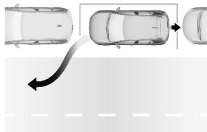
Se déplacer d'avant en arrière tout en observant les avertissements de l'aide au stationnement jusqu'à ce que la fin de la manœuvre soit indiquée.
