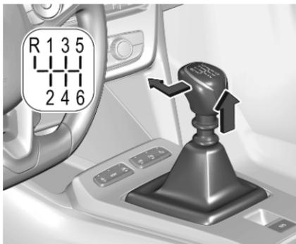
Pour engager la marche arrière, enfoncer la pédale d'embrayage, tirer sur l'anneau sous le levier sélecteur et déplacer le levier sélecteur complètement vers la gauche et l'avant.
