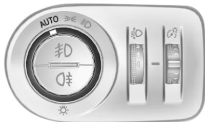
Quand la fonction de commande automatique des feux est activée, le système bascule automatiquement entre les feux de jour et les phares, en fonction des conditions d'éclairage extérieur et des informations communiquées par le système d'essuie-glaces.
