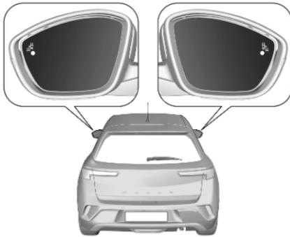
Lorsque le système détecte un véhicule dans la zone aveugle en roulant en avant, une diode s'allume dans le rétroviseur concerné. Si les feux de direction du côté approprié sont activés, la LED clignote.
