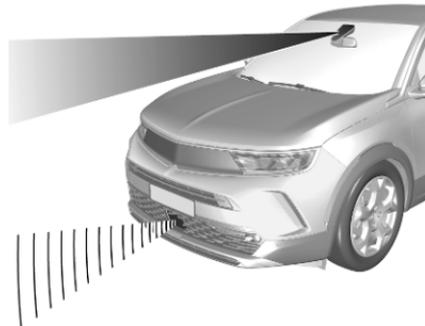
Le système fait appel à la caméra avant du pare-brise et, selon la configuration du véhicule, à un radar monté dans le pare-chocs avant du véhicule pour détecter un piéton se trouvant directement à l'avant, sur la trajectoire.
