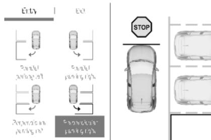
Lorsqu'un emplacement libre est détecté, une information visuelle en retour apparaît sur l'affichage d'informations et un signal sonore est émis. Arrêter le véhicule, sélectionner la marche arrière, lâcher le volant de direction et commencer à se déplacer sans dépasser 7 km/h.
