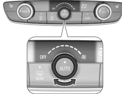
Régler le débit d'air en tournant le bouton rotatif sur la vitesse souhaitée. Le régime du ventilateur peut également être modifié au menu des réglages de climatisation. Appuyer sur **MENU** pour accéder au menu.
