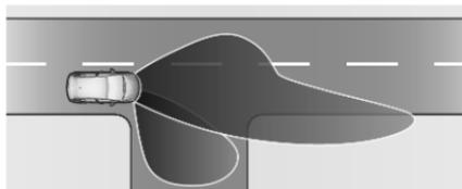
Activé à une vitesse jusqu'à 40 km/h lors de la mise hors tension. L'éclairage se compose de diodes particulières qui éclairent dans le sens du trajet. Ces diodes sont déclenchées en fonction de l'angle du volant ou de l'activation des feux de direction.
