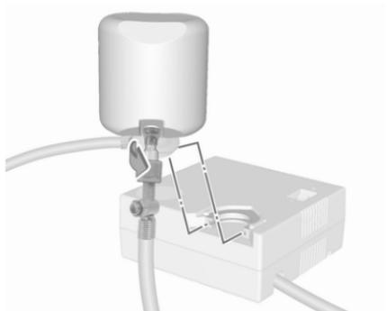
Type B : visser le flexible d'air du compresseur sur le raccord sur la bouteille de produit d'étanchéité.
