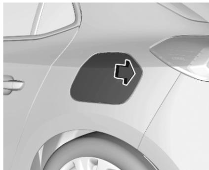
2. Appuyer sur le volet du port de chargement pour le dégager.
