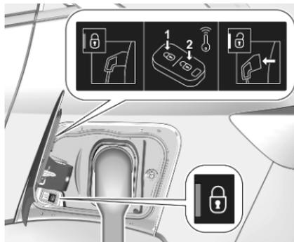
Pendant le chargement, la fiche du véhicule est verrouillée sur le port de chargement et ne peut être débranchée en cours de chargement. L'indicateur
