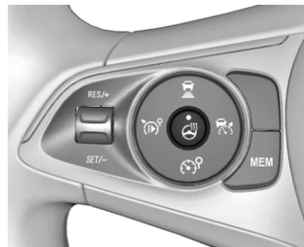
Activer le chauffage en appuyant sur
