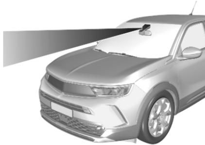
Le système d'avertissement de franchissement de ligne aide le conducteur à éviter une sortie de voie accidentelle. La caméra avant observe les bords de la chaussée, ainsi que les marquages de voie entre lesquels le véhicule circule. Si le véhicule s'approche d'un bord de route ou d'un marquage de voie, le système avertit le conducteur.
