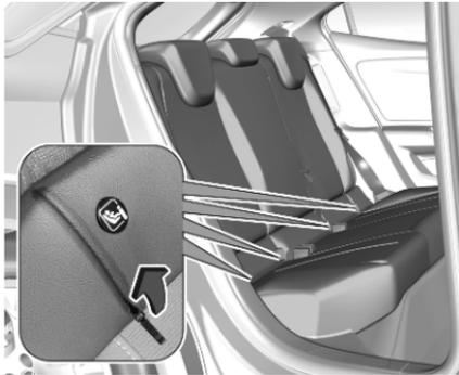
Les supports ISOFIX sont signalés par une étiquette sur le dossier. Pour accéder aux supports ISOFIX, ouvrir d'abord la fermeture éclair.
