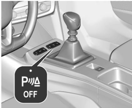
Le système est prêt à fonctionner lorsque la LED du bouton d'aide au stationnement **P OFF** est éteinte. L'état du système est mémorisé lorsque le contact est coupé.
