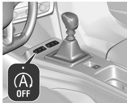
Le système est prêt à fonctionner lorsque la LED du bouton **A OFF** n'est pas allumée. Pour activer le système lorsqu'il est désactivé, appuyer sur **A OFF**.
