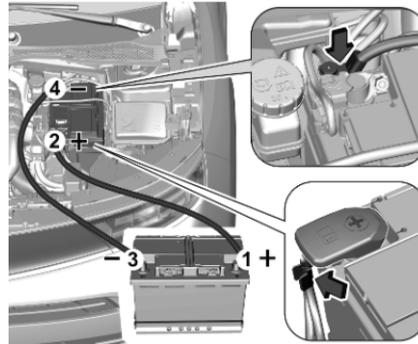
Séquence de raccordement des câbles :
