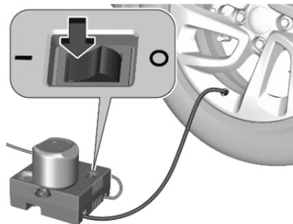
12. Placer le commutateur à bascule du compresseur sur **I**. Le pneu est rempli de produit d'étanchéité.
