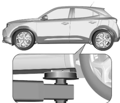
La position de bras arrière de la plateforme de levage est centrale sous le point concerné de levage du véhicule.
