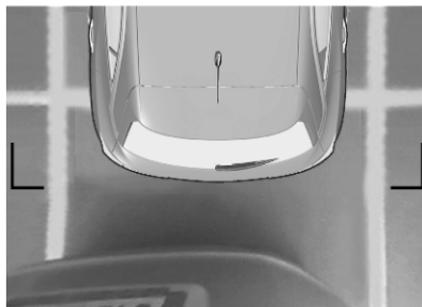
La caméra arrière enregistre les environs du véhicule pendant la manœuvre pour reconstruire une vue depuis le haut du véhicule dans son environnement proche. Le véhicule peut alors être manœuvré autour des obstacles proches. Cette vue est disponible avec le mode automatique ou dans le menu de sélection de vue.
