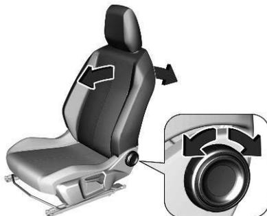
Effectuer le réglage avec le levier. Ne pas s'appuyer sur le dossier pendant le réglage.
