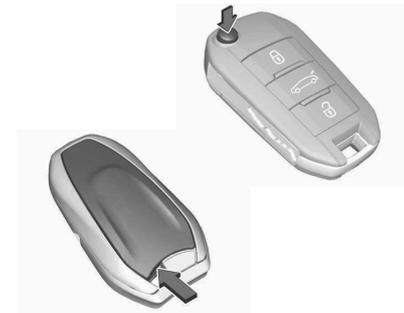
Clé électronique avec accès et démarrage sans clé : pousser le loquet pour extraire la clé intégrée.
