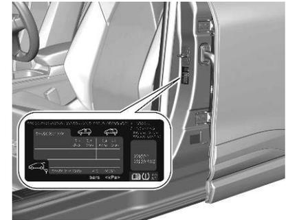
L'étiquette d'information sur la pression des pneus située sur le montant B gauche indique les pneus d'origine et les pressions correspondantes.
