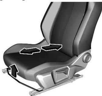
Conduire uniquement le véhicule si les sièges et les dossiers sont correctement encliquetés. Tirer la poignée, déplacer le siège et relâcher la poignée. Essayer de déplacer le siège d'avant en arrière pour s'assurer qu'il est bien verrouillé en place.
