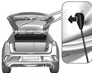
Décrocher les sangles de fixation du hayon.
