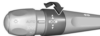
Il doit être actionné à l'aide du levier à gauche du volant, en tournant la section avec le symbole
