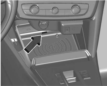
Dès que l'appareil est détecté, le voyant du chargeur s'allume en vert. Il reste allumé pendant toute la durée du chargement de la batterie.
