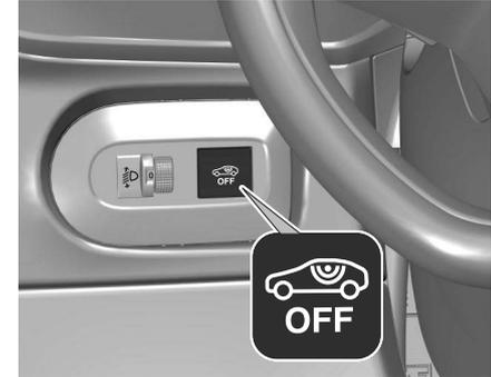
Arrêter la surveillance de l'habitacle et de l'inclinaison du véhicule quand des personnes ou des animaux restent dans le véhicule, en raison de la grande quantité de signaux ultrasoniques et de leurs mouvements déclenchant l'alarme.
