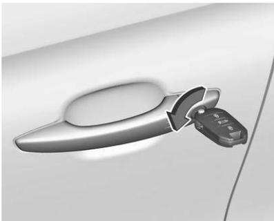
Déverrouiller manuellement la porte avant gauche en introduisant et en tournant la clé dans le barillet de la serrure.
