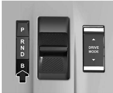
B peut être activé uniquement si D est sélectionné. Appuyer sur le bouton B.
