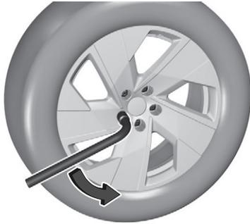
2. Placer la clé de roue et desserrer chaque boulon de roue d'un demi-tour.
