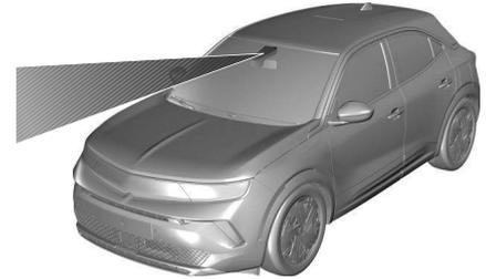
Le système d'avertissement de franchissement de ligne aide le conducteur à éviter une sortie de voie involontaire. La caméra frontale observe les bords de la route, ainsi que les marquages des voies entre lesquelles circule le véhicule. Si le véhicule franchit un bord de route ou un marquage de voie, le système avertit le conducteur.
