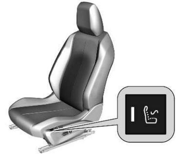
Activer la fonction de massage du dos en appuyant sur
