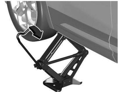
Quand le cric est correctement aligné, soulever le véhicule jusqu'à ce que la roue ne touche plus le sol.
