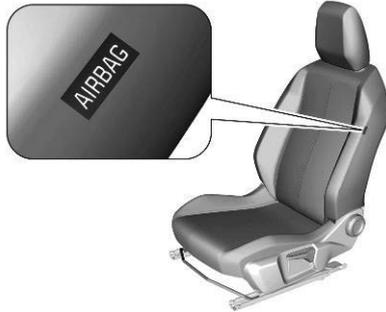
Le système d'airbags latéraux se compose d'un airbag dans chacun des dossiers de siège avant.
