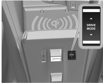
Pour sélectionner le mode de conduite correspondant, utiliser le commutateur à bascule indiqué.
