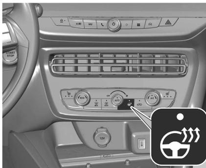
Par temps froid, cette fonction chauffe la partie circulaire du volant.
