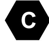
Fiche ou prise de type 2 utilisée pour la recharge en courant alternatif
