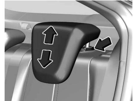
Tirer l'appuie-tête vers le haut ou appuyer sur le loquet pour le déverrouiller et abaisser l'appuie-tête.
