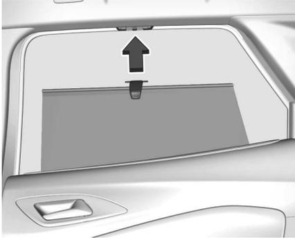
Pour réduire l'exposition au soleil des sièges arrière, relever le store en utilisant la poignée et l'encliqueter sur le haut du cadre de porte.
