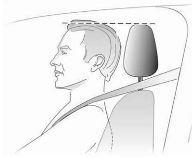
Le bord supérieur de l'appuie-tête doit toujours être au niveau du haut de la tête. Si cela s'avérait impossible pour des personnes de très grande taille, l'appuie-tête doit être réglé sur la position la plus haute. Pour des personnes de très petite taille, régler l'appuie-tête sur la position la plus basse.
