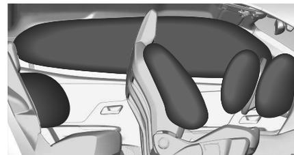
Le système d'airbags comporte une série de systèmes individuels en fonction de l'étendue de l'équipement. Une fois déclenchés, les airbags se déploient en quelques millisecondes. Il se dégonfle si rapidement que cela passe souvent inaperçu pendant la collision.
