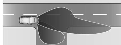
Activé à une vitesse jusqu'à 40 km/h lors de la mise hors tension. L'éclairage se compose de diodes particulières qui éclairent dans le sens du trajet. Ces diodes sont déclenchées en fonction de l'angle du volant ou de l'activation des feux de direction.
