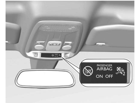
Si le voyant ON s'allume pendant environ 60 secondes après avoir mis le contact, le système d'airbag passager avant se déploiera en cas de collision.
