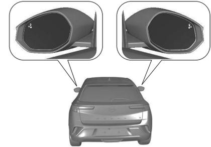
Lorsque le système détecte un véhicule dans la zone aveugle en roulant en avant, une diode s'allume dans le rétroviseur concerné. Si les feux de direction du côté approprié sont activés, la LED clignote.
