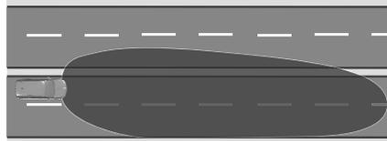
Activé automatiquement à une vitesse supérieure à 105 km/h. L'éclairage est adapté à la vitesse de conduite plus élevée sur autoroutes. Si aucun véhicule ne circule en sens inverse, la visibilité latérale du véhicule est augmentée. En suivant les véhicules à l'avant ou croisés, l'éblouissement pour ces véhicules est réduit.
