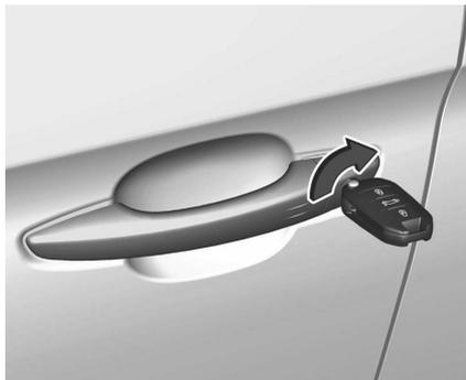
Verrouiller manuellement la porte avant en introduisant et en tournant la clé dans le barillet de la serrure.
