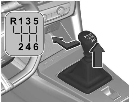
Pour engager la marche arrière, enfoncer la pédale d'embrayage, tirer sur l'anneau sous le levier sélecteur et déplacer le
