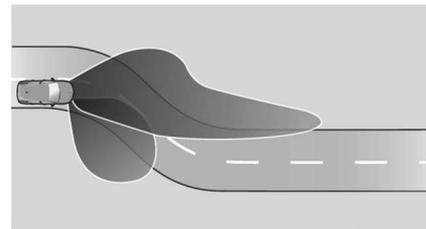
Des LED particulières, basées sur l'angle de braquage et la vitesse, sont en plus déclenchées pour améliorer l'éclairage dans les virages. Cette fonction est activée à des vitesses comprises entre 40 km/h et 70 km/h.
