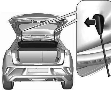
Décrocher les sangles de fixation du hayon.
