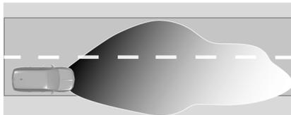
Activé automatiquement à une vitesse supérieure à 50 km/h en conduisant dans des zones rurales. L'éclairage de la voie et du bas-côté est adapté. Les véhicules qui arrivent et qui précèdent ne sont pas éblouis.
