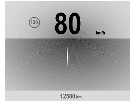
Affiche la vitesse du véhicule. Véhicule hybride 48 V : La vitesse est indiquée en bleu lorsque le véhicule roule en mode électrique. Types de propulsion ⇒ page 4
