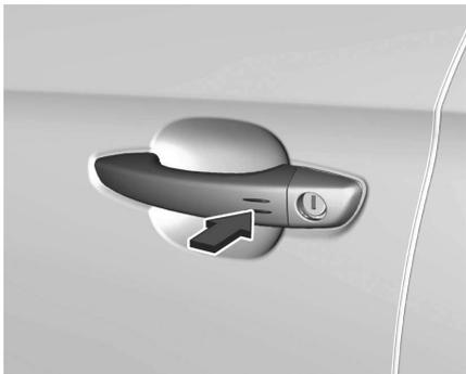
Toucher le capteur de la poignée de porte conducteur pour déverrouiller ou pour verrouiller.
