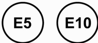
N'utiliser que des carburants conformes à la norme européenne EN 228 ou
