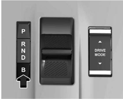
**B** peut être activé uniquement si **D** est sélectionné. Appuyer sur le bouton **B**. Pour désactiver le mode **B**, appuyer sur le bouton **B**.
