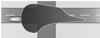
Activé automatiquement jusqu'à une vitesse de 50 km/h environ. Le faisceau lumineux est large et symétrique.
