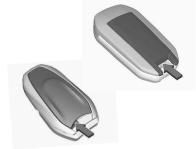
1. Pour déclipper le cache, insérer un petit tournevis entre le cache arrière et la télécommande.
