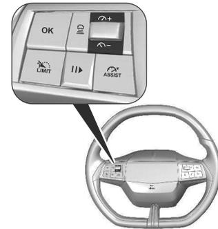
Si le système est actif, la vitesse présélectionnée peut être modifiée en appuyant sur **+** pour l'augmenter ou sur **-** pour la diminuer. Une pression courte modifie la vitesse de 1 km/h. Une pression longue modifie la vitesse de 5 km/h.
