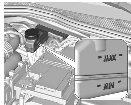
Le niveau de liquide de frein doit se situer entre les repères **MIN** et **MAX**. Si le niveau de liquide est en dessous du niveau **MIN**, contacter un atelier. Liquide de frein/ d'embrayage ⇒ page 178
