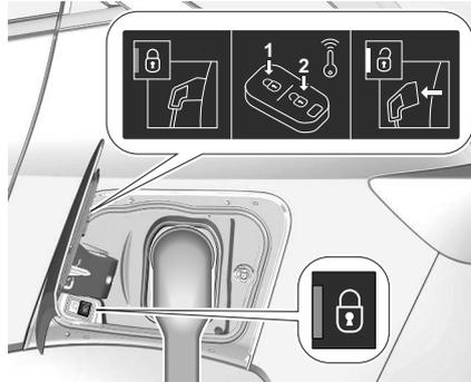
Pendant la recharge, la fiche du véhicule est verrouillée sur le port de charge et ne peut être débranchée en cours de recharge. Le voyant
