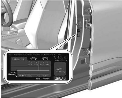
L'étiquette d'information sur la pression des pneus située sur le montant B gauche indique les pneus d'origine et les pressions correspondantes. Les données de pression de gonflage se rapportent aux pneus froids. Elles s'appliquent tant aux pneus d'été qu'aux pneus hiver. Toujours gonfler la roue de secours à la pression de pneus pour pleine charge.
