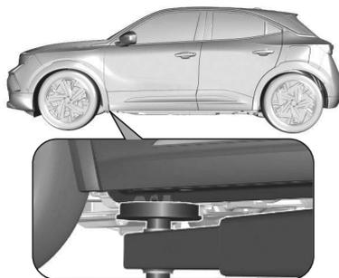
La position de bras avant de la plateforme de levage est centrale sous le point concerné de levage du véhicule.
