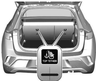
En plus des supports ISOFIX, attacher la sangle du Top-Tether aux ancrages du Top-Tether.
