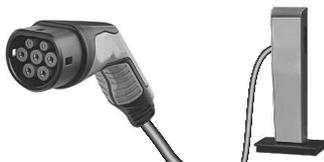
**BEV** : BEV : la charge dure environ cinq heures avec le chargeur embarqué 11 kW.
