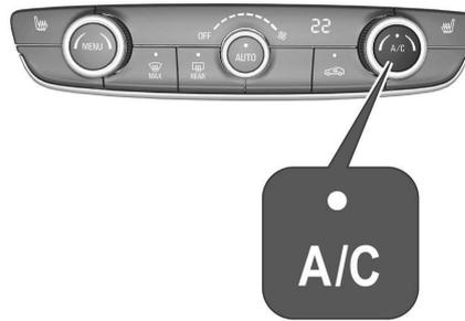
Appuyer sur **A/C** pour mettre le refroidissement en marche. L'activation est signalée par l'éclairage de la LED dans le bouton. Le refroidissement ne fonctionne que lorsque le moteur est en marche et le ventilateur aussi.
