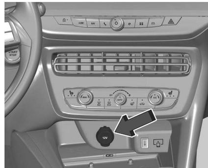
La puissance maximale absorbée ne doit pas dépasser 120 W.
