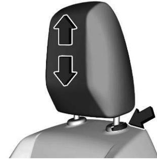
Tirer l'appuie-tête vers le haut ou appuyer sur le loquet pour le déverrouiller et abaisser l'appuie-tête.
