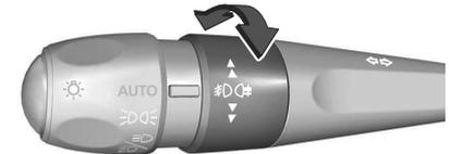
Tourner la molette de réglage vers l'avant/l'arrière pour allumer/éteindre. Il doit être actionné à l'aide du levier à gauche du volant, en tournant la section avec le symbole
