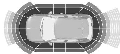
Cette fonction avertit le conducteur par une indication en cas d'obstacles à côté du véhicule. Si l'obstacle se trouve à côté du véhicule et dans la trajectoire de conduite et qu'il pourrait entraîner une collision, un **signal sonore** est émis. Les obstacles à côté du véhicule sont pris en compte uniquement s'ils ont été reconnus précédemment par les capteurs de stationnement et mémorisés par le système.
