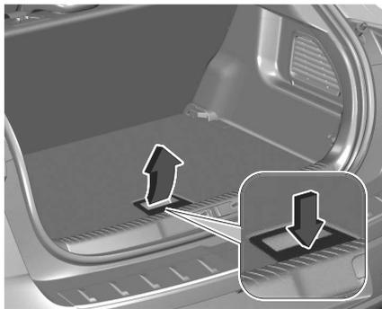
Pour l'enlever, appuyer sur la poignée pour déverrouiller le plancher de charge et le soulever avec la poignée.
