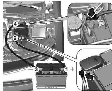
Séquence de raccordement des câbles :
