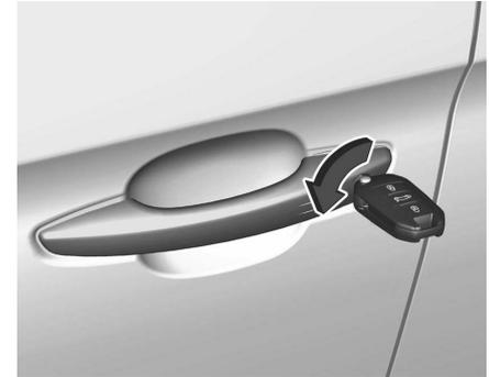
Déverrouiller manuellement la porte avant gauche en introduisant et en tournant la clé dans le barillet de la serrure.
