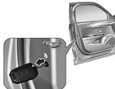
Pour verrouiller les autres portes, ouvrir les portes arrière. S'assurer que la sécurité enfants est désactivée. Insérer la clé délicatement et la tourner vers le côté intérieur des portes. Ensuite, retirer la clé.
