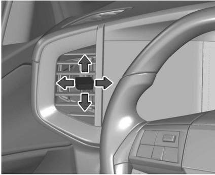
Régler la direction du flux d'air en faisant basculer et pivoter les lamelles. Pour fermer la bouche d'aération, faire pivoter les lamelles vers l'extérieur. Au moins deux bouches d'aération doivent être ouvertes pendant que le refroidissement fonctionne.
