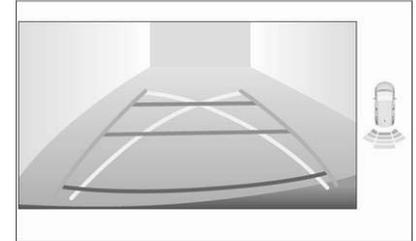
La zone derrière le véhicule est affichée à l'écran. Les lignes verticales représentent la largeur du véhicule avec les rétroviseurs dépliés.
