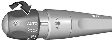
Quand la fonction de commande automatique des feux est activée, le système bascule automatiquement entre les feux de jour et les phares, en fonction des conditions d'éclairage extérieur et des informations communiquées par le système d'essuie-glaces. Feux de jour ⇒ page 44
