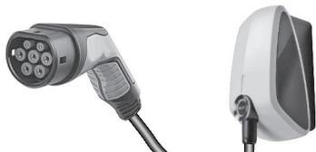
Une Wallbox/une borne de recharge CA peut disposer ou non d'un câble de recharge qui doit être connecté au port de charge du véhicule.
