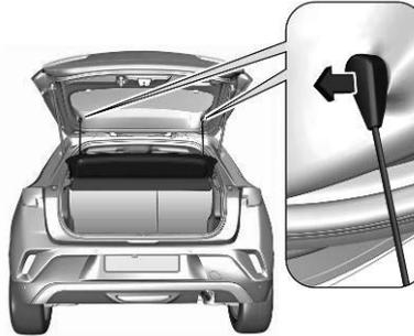
Décrocher les sangles de fixation du hayon.
