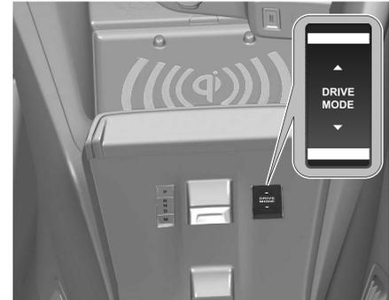
Pour sélectionner le mode de conduite correspondant, utiliser le commutateur à bascule indiqué.
