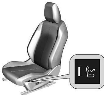
Activer la fonction de massage du dos en appuyant sur
