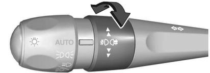
Tourner la molette de réglage vers l'avant/l'arrière pour allumer/éteindre. Il doit être actionné à l'aide du levier à gauche du volant, en tournant la section avec le symbole
