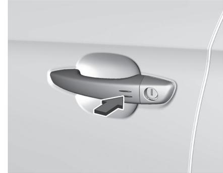
Toucher le capteur de la poignée de porte conducteur pour déverrouiller ou pour verrouiller.
