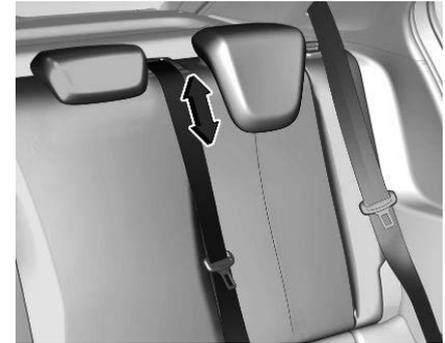
La ceinture de sécurité du siège central pourrait être coincée lorsque le dossier est soulevé trop rapidement. Pour débloquer l'enrouleur, rentrer la ceinture de sécurité ou la sortir d'environ 20 mm, puis relâcher.
