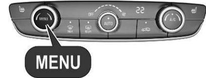
Appuyer sur **MENU** sur le panneau de commande de climatisation ou toucher
