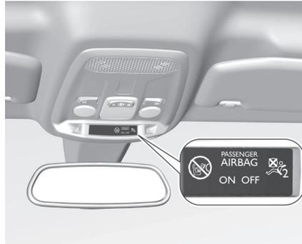
Si le voyant ON s'allume pendant environ 60 secondes après avoir mis le contact, le système d'airbag passager avant se déploiera en cas de collision.
