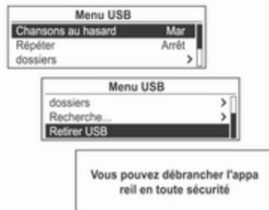
Appuyer sur le bouton multifonction en mode de lecture pour afficher le **Menu USB**. Faire tourner le bouton multifonction pour sélectionner **Retirer USB**, puis appuyer sur ce bouton pour afficher le message indiquant que le périphérique USB peut être retiré en toute sécurité.
