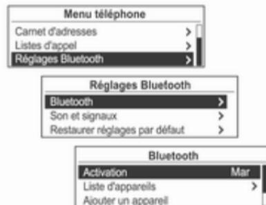
À l'aide du bouton multifonction, sélectionner **Menu téléphone** → **Réglages Bluetooth**, puis appuyer sur ce bouton.
