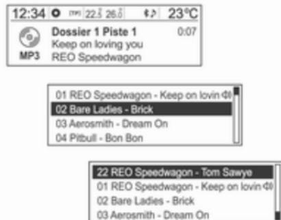
Pour les morceaux MP3 (WMA), tourner le bouton multifonction pour passer à la liste des morceaux et appuyer sur ce bouton pour passer instantanément à un autre morceau.
