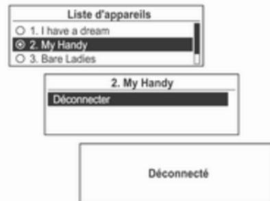
Déconnexion du périphérique Bluetooth connecté : Dans l'écran Liste des appareils, sélectionner le périphérique connecté. L'option **Déconnecter** s'affiche. Appuyer sur le bouton multifonction.
