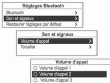
Pour réinitialiser **Réglages Bluetooth** aux valeurs par défaut, utiliser le bouton multifonction pour sélectionner l'élément de restauration initiale, puis sélectionner **Oui** avec le bouton multifonction.
