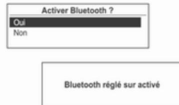
Pour activer la fonction Bluetooth, enregistrer/connecter/supprimer le périphérique Bluetooth ou modifier le code Bluetooth, sélectionner **Bluetooth** à l'aide du bouton multifonction puis utiliser ce bouton pour configurer l'élément voulu.
