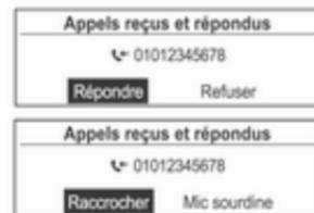
Pour répondre, appuyer sur la touche
