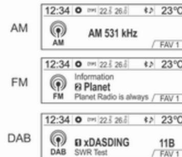
Appuyer sur la touche **RADIO/BAND** pour sélectionner la radio FM, AM ou DAB.
