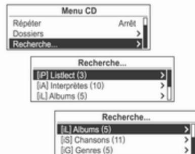
Appuyer à nouveau sur le bouton multifonction et tourner ce bouton à partir du résultat de la recherche affiché pour sélectionner le mode de lecture désiré.
