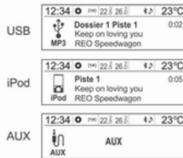
Brancher l'USB/iPod avec les fichiers de musique à lire sur la borne de connexion USB ou brancher la sortie audio de l'équipement audio externe à écouter sur la borne d'entrée AUX.
