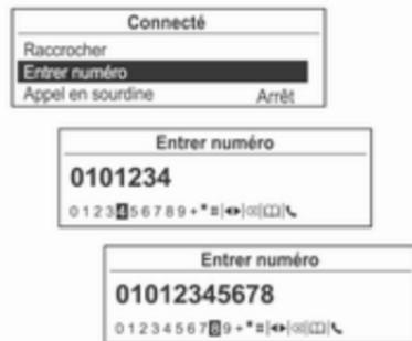
Pour passer un appel en introduisant le numéro de téléphone, appuyer sur le bouton multifonction et le faire tourner pour sélectionner **Entrer numéro**, puis appuyer sur ce bouton.
