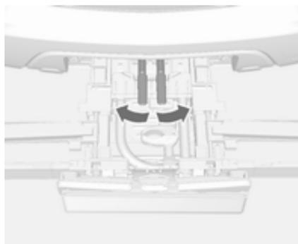
Déposer la sangle et faire pivoter les deux leviers de serrage latéralement, aussi loin que possible.
