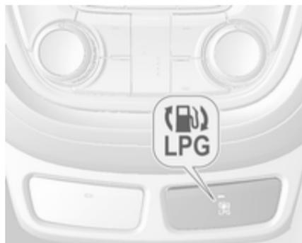
L'actionnement du bouton **LPG** permet le basculement entre les modes de fonctionnement à l'essence et au gaz de pétrole liquéfié dès que les paramètres requis (température de liquide de refroidissement et régime moteur minimal) ont été atteints. Les exigences sont généralement satisfaites après environ 60 secondes (en fonction de la température extérieure) et la première pression ferme sur la pédale d'accélérateur. La LED indique le mode de fonctionnement en cours.
