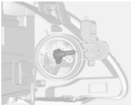
3. Déposer l'ampoule de son soquet et la remplacer.
