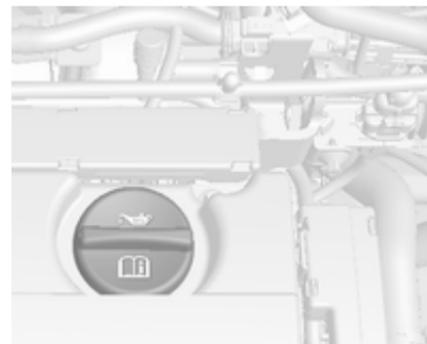
Le bouchon de remplissage d'huile moteur est situé sur le couvercle d'arbre à cames.
