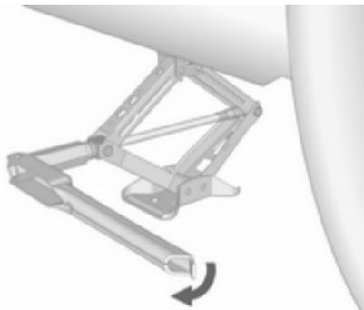
Attacher la clé de roue, aligner correctement le cric et tourner la clé de roue jusqu'à ce que la roue ait quitté le sol.
