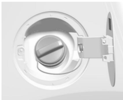
Tourner doucement le bouchon de remplissage dans le sens anti-horaire pour ouvrir.
