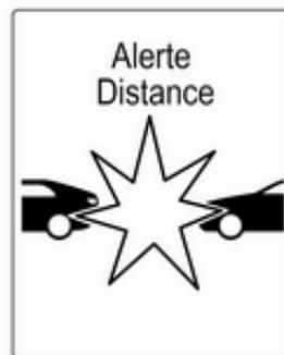
Lors de l'approche trop rapide d'un autre véhicule, la page d'alerte de collision sera affichée sur le centre d'informations du conducteur. En même temps, un signal sonore retentira. Enfoncer la pédale de frein, si cela est exigé par la situation.
