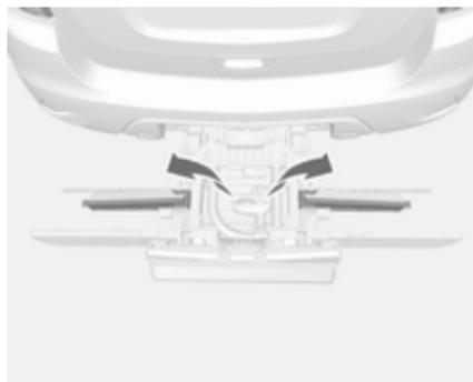
Déposer la sangle et déployer le logement de roue.
