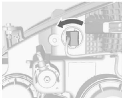
1. Faire tourner le support d'ampoule dans le sens inverse des aiguilles d'une montre et le désengager.
