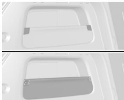
1. Déposer les deux couvercles et dévisser les vis. Déposer le panneau.
