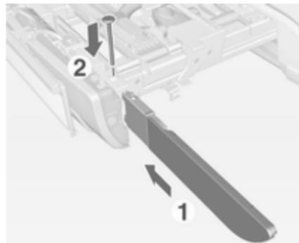
Pousser les feux arrière dans la fixation (1) et reposer les vis (2) pour fixer les feux.
