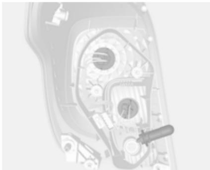
4. Enlever le support d'ampoule. Déposer l'ampoule et la remplacer.
