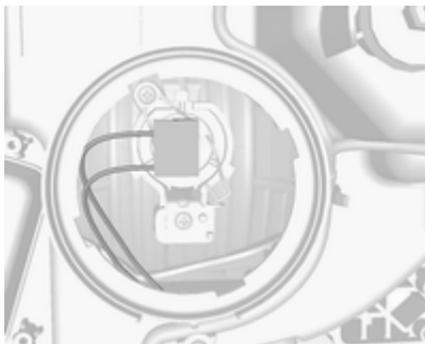
1. Débrancher le connecteur de socket d'ampoule de phare.
