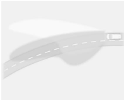
Le faisceau lumineux pivote en fonction de l'angle de braquage du volant et la vitesse, ce qui améliore l'éclairage des virages.
