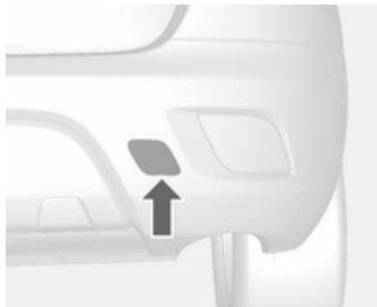
Désengager le capuchon à l'aide d'un tournevis et le déposer.
