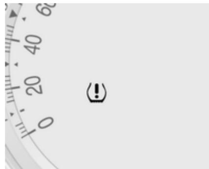
En cas de détection d'une basse pression de pneu, le témoin (⚠) s'allume. S'arrêter dès que possible et gonfler les pneus à la pression recommandée ↪ 189.
