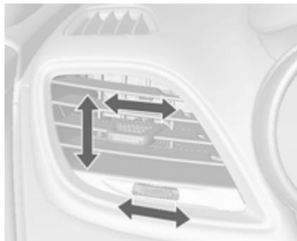
Régler la direction du flux d'air en faisant basculer et pivoter les lamelles. Pour fermer la bouche d'aération, tourner la molette de réglage vers la gauche.
