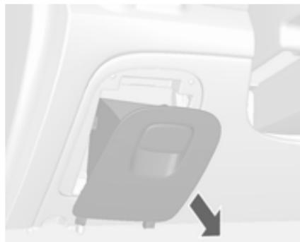
Le bloc de fusibles intérieur se trouve sous la face inférieure du tableau de bord, côté conducteur.
