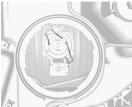
2. Appuyer sur l'attache ressort, la désencliqueter.
