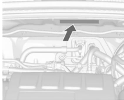
Le numéro d'identification du véhicule se trouve dans le compartiment moteur.
