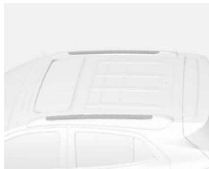
La galerie de toit comporte des rails latéraux fixés au toit.
