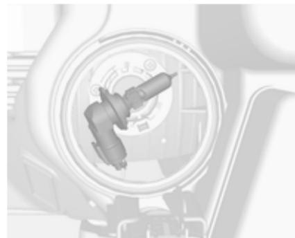
1. Déposer le socket d'ampoule en tirant.
