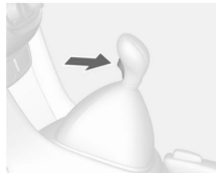
Pour engager la marche arrière : lorsque le véhicule est à l'arrêt, appuyer sur le bouton de déverrouillage du levier sélecteur 3 secondes après avoir enfoncé la pédale d'embrayage et engager la marche arrière.
