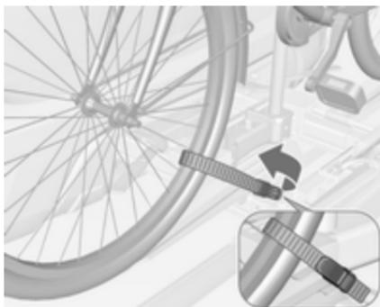
3. Attacher les deux roues du vélo aux logements de roue en utilisant les dispositifs de retenue par sangle.
