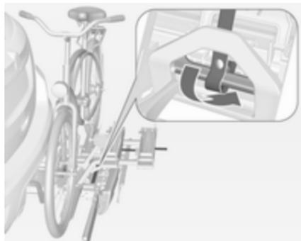
4. Passer la sangle attachée à l'adaptateur sous le levier lors du rabattement du système de transport arrière. Attacher la sangle.
