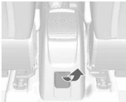
Une prise de courant de 230 V est placée dans la console arrière.
