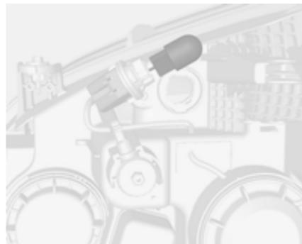
2. Pousser légèrement l'ampoule dans le soquet, la faire tourner dans le sens inverse des aiguilles d'une montre, la déposer et la remplacer.
