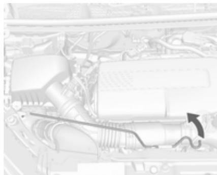
Sortir délicatement la béquille de son support. La fixer ensuite dans le crochet du côté gauche, sur le capot.
