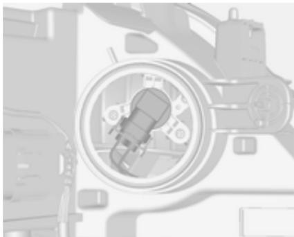
2. Déposer le soquet d'ampoule en tirant.
