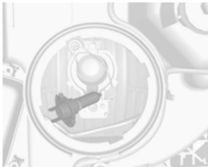
3. Déposer l'ampoule de son socket et la remplacer.
