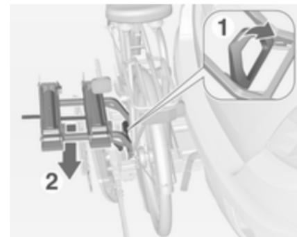
2. Tourner le levier (1) vers l'avant et le maintenir, abaisser alors l'adaptateur (2) sur l'arrière.
