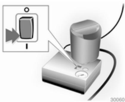
10. Placer le commutateur à bascule du compresseur sur I. Le pneu est rempli de produit d'étanchéité.
