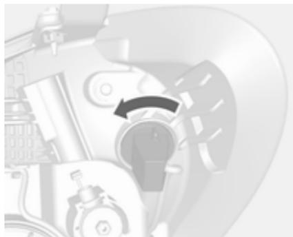
1. Déposer le soquet de l'ensemble en le faisant tourner dans le sens inverse des aiguilles d'une montre.
