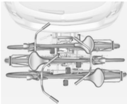
3. Positionner les vélos sur le système de transport arrière en les alignant en alternance vers la gauche ou la droite.
