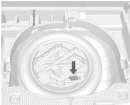
Une roue de plein format endommagée doit être rangée dans le coffre et attachée avec une sangle. Outillage de bord ↻ 187. Pour fixer la roue :
