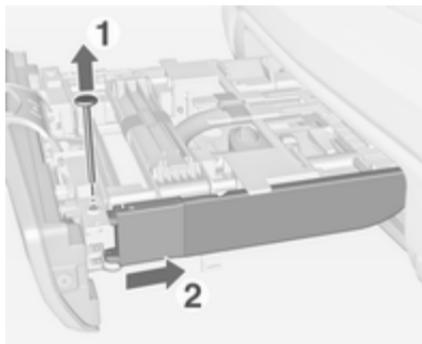
Pour poser les feux arrière, déposer les deux vis (1). Extraire les feux arrière de la fixation, vers l'avant (2) et vers le bas, et les faire pivoter vers le côté.
