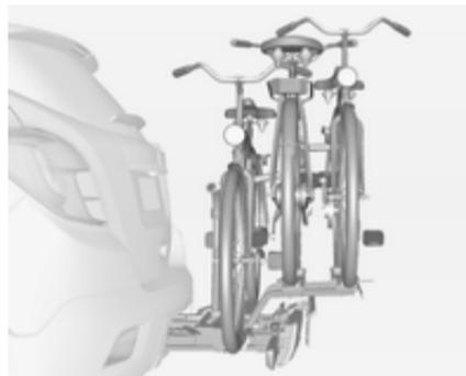
Le système de transport arrière (système Flex-Fix) permet de fixer une bicyclette au support de transport extensible intégré dans le plancher du véhicule. Il est possible de fixer deux vélos supplémentaires sur un adaptateur. Le transport d'autres objets n'est pas autorisé.
