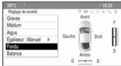
Pour régler la répartition du volume entre les haut-parleurs avant et arrière du véhicule, sélectionnez **Fondu**. Effectuez le réglage désiré.
