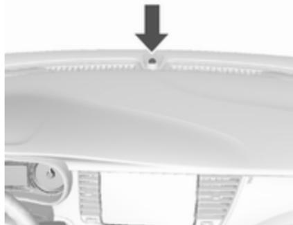
La LED d'état est intégrée dans le capteur sur le haut du tableau de commande.
