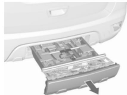
Sortir complètement le système de transport arrière jusqu'à ce qu'il se verrouille de manière audible.
