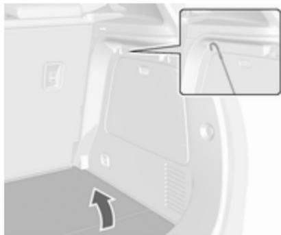
Monter le couvercle sur le crochet au niveau de la paroi latérale.
