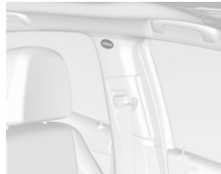
Le système d'airbag rideau se déclenche en cas de collision latérale d'une certaine gravité. Le contact doit être mis.
