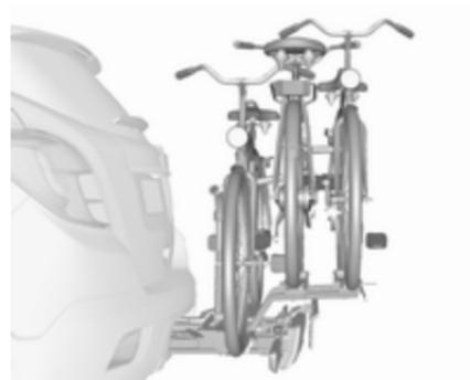
Le système de transport arrière (système Flex-Fix) permet de fixer un vélo au support de transport extensible intégré dans le plancher du véhicule. Il est possible de fixer deux vélos supplémentaires sur un adaptateur. Le transport d'autres objets n'est pas autorisé.
