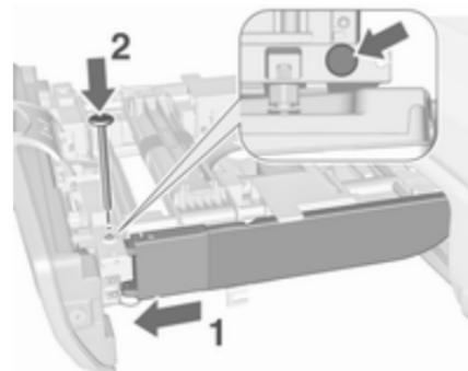
Pousser les feux arrière dans la fixation (1). Insérer les goupilles dans les trous indiqués de la fixation et des feux arrière (2).
