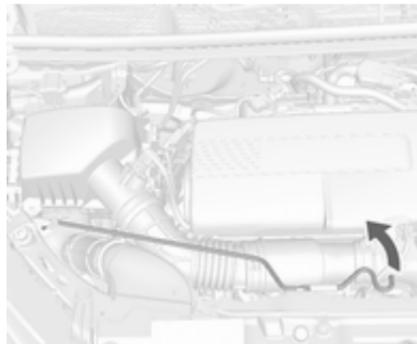
Sortir délicatement la béquille de son support. La fixer ensuite dans le crochet du côté gauche, sur le capot. Si le capot est ouvert lors d'un Auto-stop, le moteur sera automatiquement redémarré pour des raisons de sécurité.
