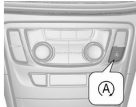
Pour désactiver le système Stop/Start manuellement, appuyer sur **A**. La désactivation est signalée par l'extinction de la LED dans le bouton.
