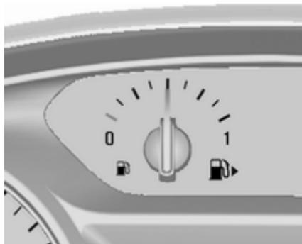
Affiche le niveau du réservoir à carburant ou à gaz en fonction du mode de fonctionnement.
