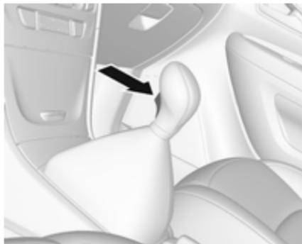
Pour engager la marche arrière, avec le véhicule à l'arrêt, enfoncer la pédale d'embrayage, enfoncer le bouton de déverrouillage du levier sélecteur et engager le rapport.
