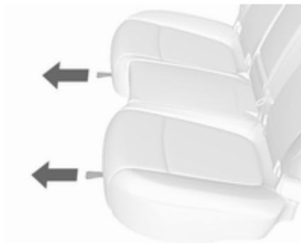
2. Tirer la boucle sous l'assise de siège et replier l'assise de siège.
