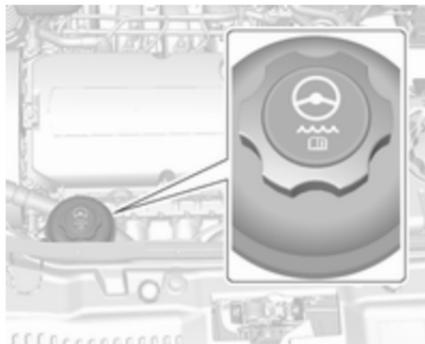
Le niveau du liquide de direction assistée n'a pas nécessairement besoin d'être vérifié. Si un bruit inhabituel est audible pendant l'utilisation du volant ou si la direction réagit de manière singulière, demander l'aide d'un atelier.
