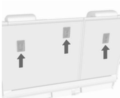
Pour les systèmes de sécurité pour enfant non ISOFIX, fixer la sangle Top-Tether sur les anneaux de fixation Top-Tether. La sangle doit alors passer entre les deux tiges de guidage de l'appui-tête.
