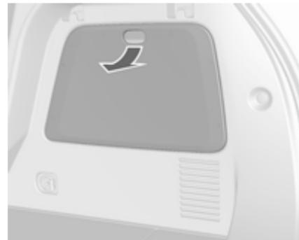
1. Retirer la porte du compartiment de rangement et le kit de réparation des pneus.
