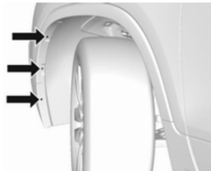
1. Tourner la roue correspondante vers l'intérieur de manière à faciliter l'accès et déposer les trois vis torx sur l'extérieur du passage de roue. Outils de bord ↻ 211.
