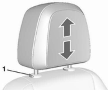
Tirer l'appui-tête vers le haut. Appuyer sur le loquet (1) pour débloquer et pousser l'appui-tête vers le bas.
