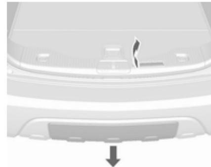
Tirer la manette de déblocage vers le haut. Le système de transport arrière se déverrouille et est éjecté hors du pare-chocs arrière.
