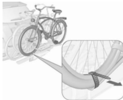
6. De plus, attacher les deux roues du troisième vélo aux logements de roue en utilisant les sangles de serrage.
