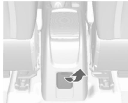
La puissance maximale absorbée ne doit pas dépasser 150 watts.
