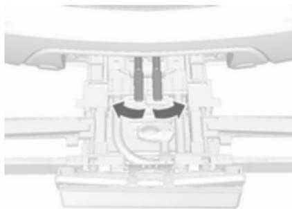
Déposer la sangle et faire pivoter les deux leviers de serrage latéralement, aussi loin que possible.
