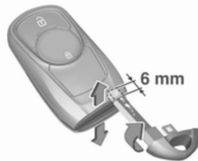
2. Insérer la lame de la clé d'environ 6 mm dans le boîtier et tourner la clé pour ouvrir le boîtier. Une insertion plus profonde de la clé peut endommager le boîtier.
