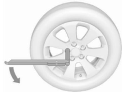
2. Déplier la clé de roue et la placer de sorte qu'elle soit bien positionnée et dévisser chaque écrou de roue d'un demi-tour.
