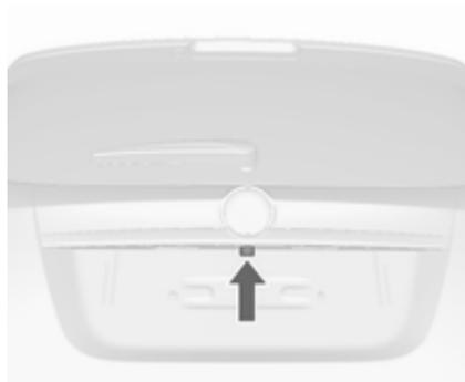
La caméra est montée sur la poignée du hayon et a un angle de vision de 130°.
