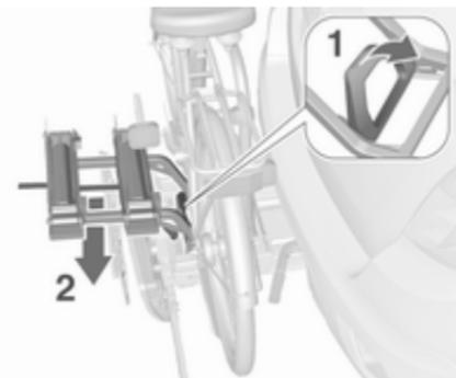
2. Tourner le levier (1) vers l'avant et le maintenir, puis abaisser l'adaptateur (2) sur l'arrière.
