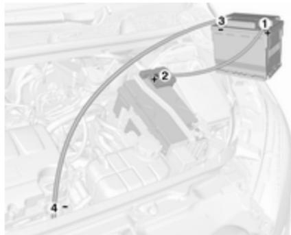
Séquence de raccordement des câbles :
