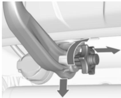
Ouvrir le volet de protection et tourner la clé en position
