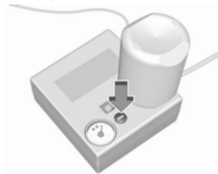
Si la pression des pneus prescrite n'est pas atteinte dans les dix minutes, démonter le kit de réparation de pneus. Avancer ou reculer le véhicule d'un tour de roue. Brancher à nouveau le kit de réparation de pneus et poursuivre la procédure de remplissage pendant 10 minutes. Si la pression de gonflage prescrite n'est toujours pas atteinte, c'est que le pneu est trop fortement endommagé. Prendre contact avec un atelier.
