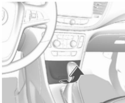
Une prise de courant 12 Volt est placée dans la console avant derrière le couvercle. Pour ouvrir, pousser sur le bouton.
