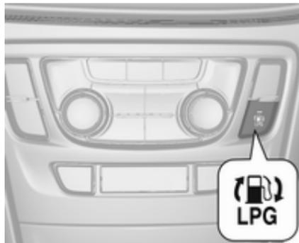
L'actionnement de **LPG** permet le basculement entre les modes de fonctionnement à l'essence et au gaz de pétrole liquéfié dès que les paramètres requis (température de liquide de refroidissement et régime moteur minimal) ont été atteints. Les exigences sont généralement satisfaites après environ 60 secondes (en fonction de la température extérieure) et la première pression ferme sur la pédale d'accélérateur. La LED d'état indique le mode de fonctionnement en cours.
