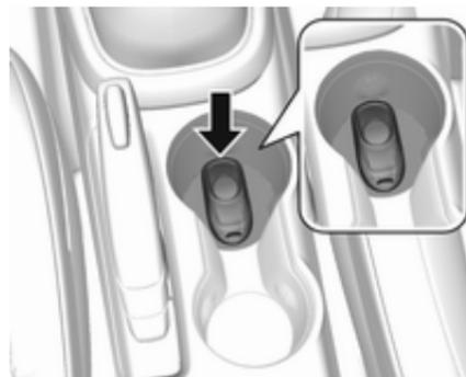
1. Placer la clé électronique dans le porte-gobelets avant de la console centrale. Placer la clé électronique uniquement centrée dans la zone de l'émetteur à plat
