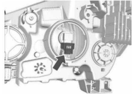
4. Débrancher le connecteur du faisceau de câbles de l'ampoule.
