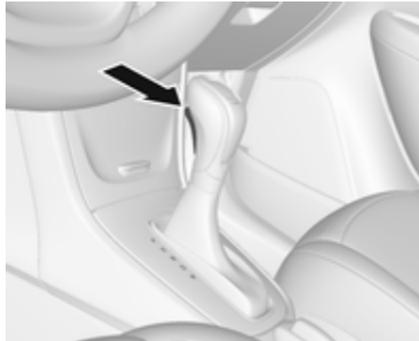
Pour engager le levier sur **P** ou **R**, appuyer sur le bouton de verrouillage.
