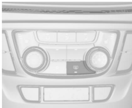
Pour les enclencher, appuyer sur
