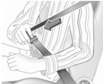
Tirer la ceinture hors de l'enrouleur, la guider sur le corps sans la vriller et insérer le verrou plat dans la serrure.
