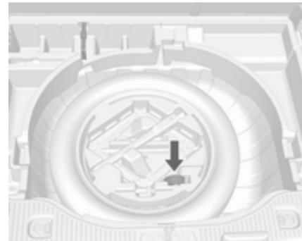
Une roue de taille normale endommagée doit être rangée dans le coffre et attachée grâce à une sangle. Outillage de bord ↗ 211.
