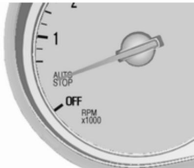
Une fonction Autostop est indiquée par l'aiguille à la position **AUTOSTOP** dans le compte-tours. Pendant un Autostop, le rendement du chauffage, la direction assistée et la puissance de freinage sont maintenus.
