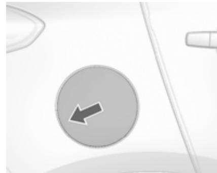
La trappe de réservoir ne peut être ouverte que si le véhicule est déverrouillé. Pousser le volet et ouvrir.
