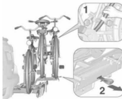
Maintenir le cadre (1) du vélo le plus en arrière avec une main et tirer sur la boucle (2) pour la désengager.
