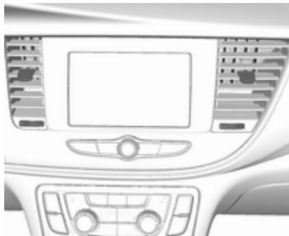
Pour ouvrir la bouche d'aération, tourner la molette de réglage vers la droite. Régler le débit d'air venant de la bouche d'aération en tournant la molette.
