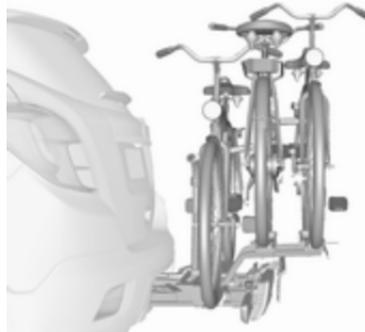
Le système de transport arrière (système Flex-Fix) permet de fixer un vélo au support de transport extensible intégré dans le plancher du véhicule. Il est possible de fixer deux vélos supplémentaires sur un adaptateur. Le transport d'autres objets n'est pas autorisé.
