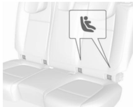
Le véhicule peut être équipé de guides à l'avant des supports de montage afin de faciliter l'installation du système de sécurité pour enfant.
