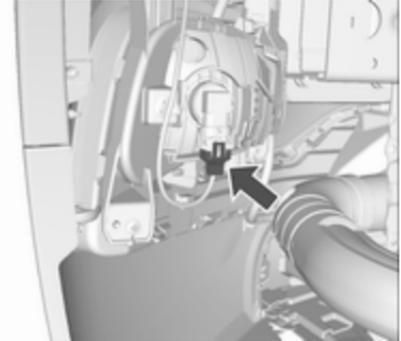
3. Tirer la nervure de retenue vers l'extérieur et déposer le connecteur de fiche de la douille d'ampoule.
