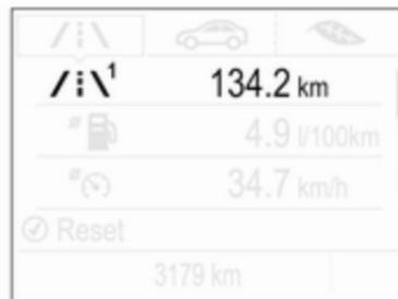
Sélectionner **/i\1** en appuyant sur **Menu** du levier des clignotants. Tourner la molette de réglage et sélectionner **/i\1** ou **/i\2**. Chaque page du compteur kilométrique journalier peut être réinitialisée séparément en appuyant pendant quelques secondes sur **SET/CLR** du levier des clignotants sur le menu concerné.
