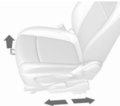
Tirer la poignée, déplacer le siège et relâcher la poignée. Essayer de déplacer le siège d'avant en arrière pour s'assurer qu'il est bien verrouillé en place.
