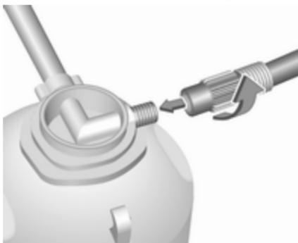
4. Visser le flexible d'air du compresseur sur le raccord sur la bouteille de produit d'étanchéité.
