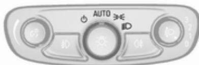
Quand la fonction de commande automatique des feux est activée et que le moteur tourne, le système bascule automatiquement entre les feux de jour et les phares, en fonction des conditions d'éclairage extérieur et des informations communiquées par le système de détecteur de pluie.
