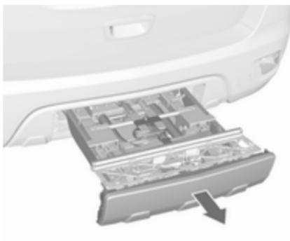
Sortir complètement le système de transport arrière jusqu'à ce qu'il se verrouille de manière audible.
