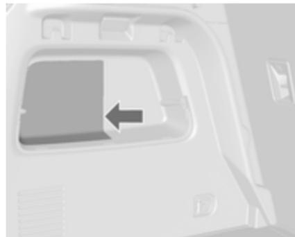
2. Dégager tout d'abord le couvercle en insérant un tournevis dans le renforcement. Puis dégager le couvercle sur le côté avant et supérieur. Retirer le couvercle.
