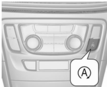
Pour désactiver le système Stop/Start manuellement, appuyer sur **(A)**. La désactivation est signalée par l'extinction de la LED dans le bouton.
