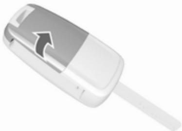
Sortir la clé et ouvrir l'unité. Remplacer la pile (type CR 2032) en faisant attention à la position de montage. Fermer l'unité et la programmer.
