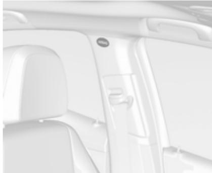
Le système d'airbag rideau se déclenche en cas de collision latérale d'une certaine gravité. Le contact doit être mis.
