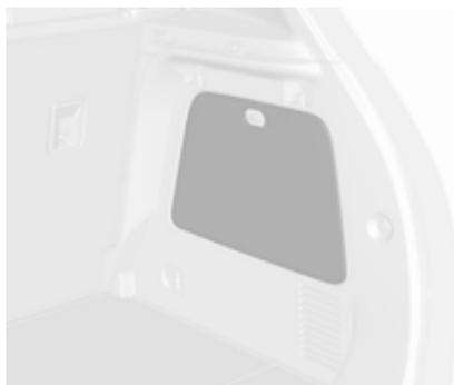
Les outils et le kit de réparation des pneus se trouvent du côté droit du coffre ↪ 219.
