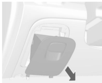
Le bloc de fusibles intérieur se trouve sous la face inférieure du tableau de bord, côté conducteur. Pour accéder aux fusibles, déposer le compartiment de rangement. Pour déposer le compartiment de rangement, l'ouvrir et le tirer.
