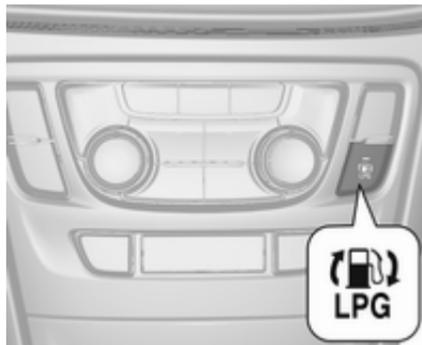
Appuyer sur **LPG** pour permuter entre mode essence et mode gaz de pétrole liquéfié. La LED du bouton indique le mode de fonctionnement actuel.
