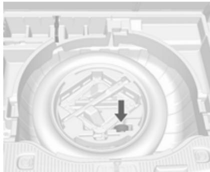
Une roue de plein format endommagée doit être rangée dans le coffre et attachée avec une sangle.
