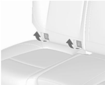
Les caches des guides pivotent automatiquement vers l'arrière en fixant le système de sécurité pour enfant.
