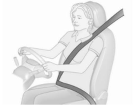
Les ceintures de sécurité sont bloquées lors d'accélération ou de décélération fortes du véhicule, ce qui assure le maintien des occupants en position assise. Le risque de blessure est ainsi sensiblement réduit.
