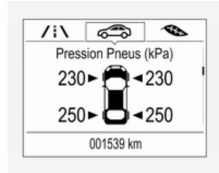
Sélectionner la page **Pression des pneus** sous la rubrique **Menu informations véhicule** dans le centre d'informations du conducteur 102.
