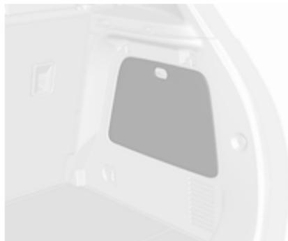
Les outils et le kit de réparation des pneus se trouvent du côté droit du coffre.
