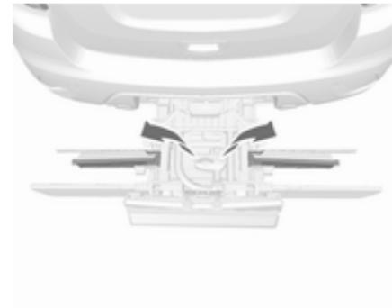
Déposer la sangle et déployer le logement de roue.
