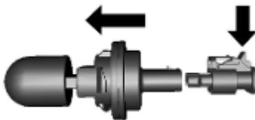
2. Dégager la douille d'ampoule du connecteur en enfonçant la patte de retenue.
