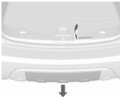
Tirer la manette de déblocage vers le haut. Le système de transport arrière se déverrouille et est éjecté hors du pare-chocs arrière.
