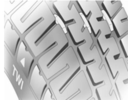
La profondeur minimale de sculpture légalement autorisée (1,6 mm) est atteinte lorsque le profil est usé jusqu'au repère d'usure (TWI = Tread Wear Indicator). La position des repères d'usure est indiquée par des marques sur les flancs du pneu.
