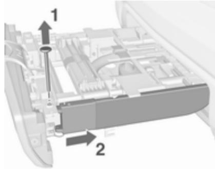
Pour poser les feux arrière, déposer les deux goupilles (1). Extraire les feux arrière de la fixation, vers l'avant (2) et vers le bas, et les faire pivoter vers le côté.
