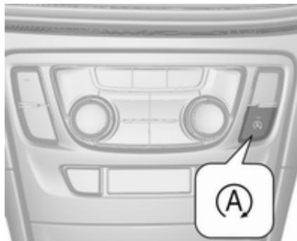
Pour désactiver le système Stop/Start manuellement, appuyer sur
