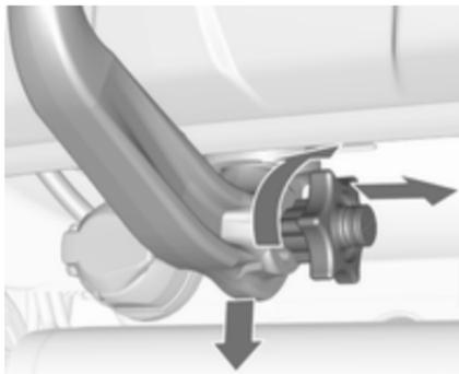
Ouvrir le volet de protection et tourner la clé en position
