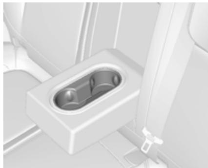
Pour utiliser le porte-gobelets de siège arrière, rabattre l'accoudoir du siège arrière.
