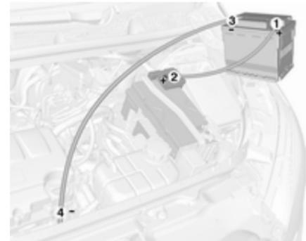
Séquence de raccordement des câbles :
