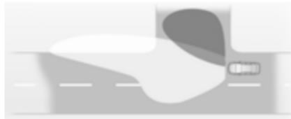
Dans les virages serrés ou lors des changements de direction, en fonction de l'angle de braquage du volant ou des clignotants, un réflecteur supplémentaire, à gauche ou à droite, est activé pour éclairer la route dans la direction du déplacement. Il est activé jusqu'à une vitesse de 70 km/h.
