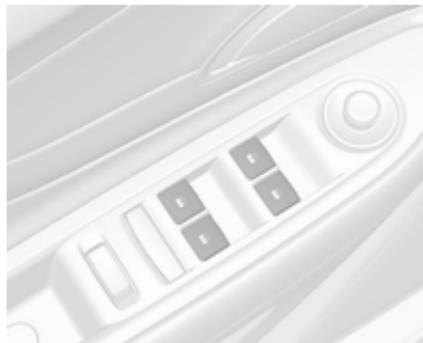
Manœuvrer le commutateur de la vitre concernée en l'enfonçant pour l'ouvrir ou en le relevant pour la fermer.
