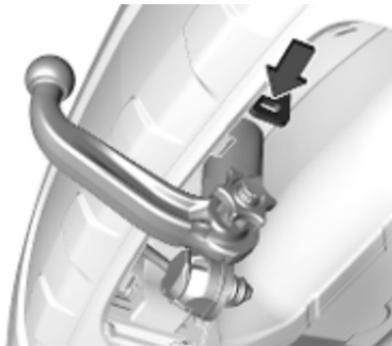
Attacher le câble de rupture d'attelage à l'œillet.
