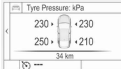
6. Appuyer sur **SET/CLR** pour lancer le processus d'appariement de capteur. Un message demandant d'accepter le processus doit s'afficher.
