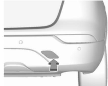
Envelopper d'un linge l'extrémité d'un tournevis plat pour ne pas endommager la peinture. Insérer le tournevis dans la fente de la courbure basse du capuchon. Dégager le capuchon en enfonçant avec précaution le tournevis vers le bas.
