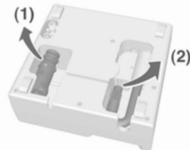
3. Enlever le câble de raccordement électrique (1) et le flexible d'air (2) de leur espace de rangement sur la face inférieure du compresseur.
