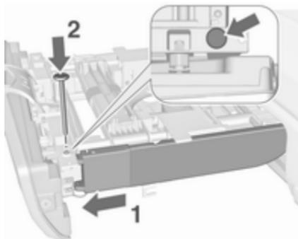
Pousser les feux arrière dans la fixation (1). Insérer les goupilles dans les trous indiqués de la fixation et des feux arrière (2).
