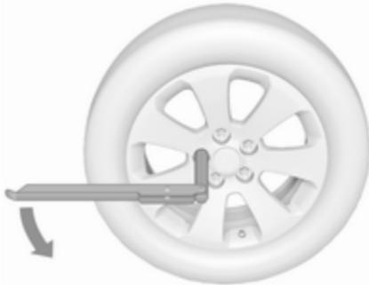
2. Déplier la clé de roue et la placer de sorte qu'elle soit bien positionnée et dévisser chaque écrou de roue d'un demi-tour.
