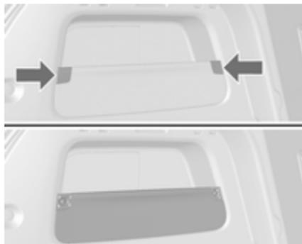
1. Dégager les deux couvercles du côté extérieur respectif en insérant un tournevis. Déposer les deux couvercles et dévisser les vis. Déposer le panneau.
