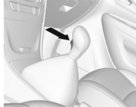
Pour engager la marche arrière, avec le véhicule à l'arrêt, enfoncer la pédale d'embrayage, enfoncer le bouton de déverrouillage du levier sélecteur et engager le rapport.
