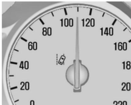
Quand le témoin
