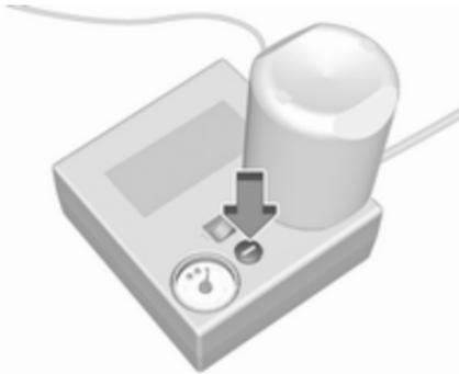
Si la pression de pneu prescrite n'est pas atteinte dans les 10 min, démonter le kit de réparation de pneus. Avancer ou reculer le véhicule d'un tour de roue. Brancher à nouveau le kit de réparation des pneus et poursuivre la procédure de remplissage pendant 10 min. Si la pression de gonflage prescrite n'est toujours pas atteinte, cela signifie que le pneu est trop fortement endommagé. Prendre contact avec un atelier.
