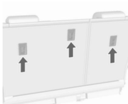
Pour les systèmes de sécurité pour enfant non ISOFIX, fixer la sangle de l'attache supérieure sur les ancrages de fixation de l'attache supérieure.
