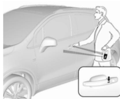
La clé électronique doit se trouver à l'extérieur du véhicule dans un rayon d'environ 1 m du côté de la porte concernée.
