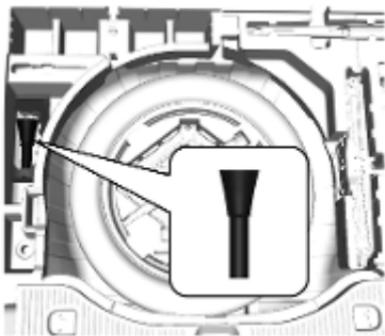
L'entonnoir est rangé dans le coffre. Placer l'entonnoir dans la boîte de stockage et ranger dans un sac plastique.
