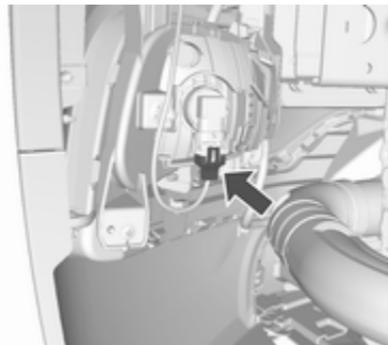
3. Tirer la nervure de retenue vers l'extérieur et déposer le connecteur de fiche de la douille d'ampoule.
