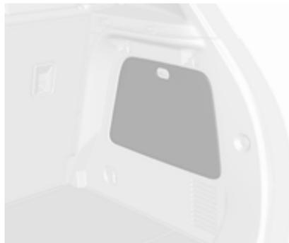
Le kit de réparation des pneus se trouve du côté droit du compartiment arrière.
