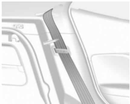
5. Placer les ceintures de sécurité des sièges extérieurs dans les guides de ceinture.
