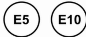
Utiliser uniquement du carburant sans plomb conforme à la norme européenne EN 228 ou équivalent.
