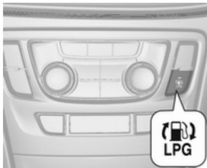
L'actionnement de **LPG** permet le basculement entre les modes de fonctionnement à l'essence et au gaz
