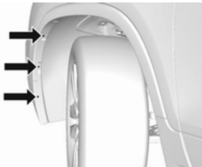
1. Tourner la roue correspondante vers l'intérieur de manière à faciliter l'accès et déposer les trois vis torx sur l'extérieur du passage de roue.
