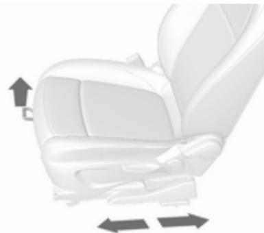
Tirer la poignée, déplacer le siège et relâcher la poignée. Essayer de déplacer le siège d'avant en arrière pour s'assurer qu'il est bien verrouillé en place.
