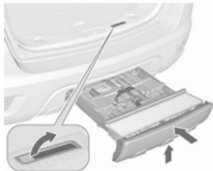
Pousser le levier de déverrouillage vers le haut et le maintenir. Soulever légèrement le système et le pousser dans le pare-chocs jusqu'à ce qu'il s'enclique.
