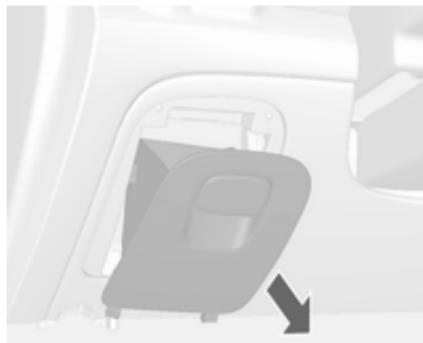
Dans les véhicules avec direction à gauche, la boîte à fusibles intérieure se trouve sous la face inférieure du tableau de bord, côté conducteur. Pour accéder aux fusibles, déposer le compartiment de rangement. Pour déposer le compartiment de rangement, l'ouvrir et le tirer.
