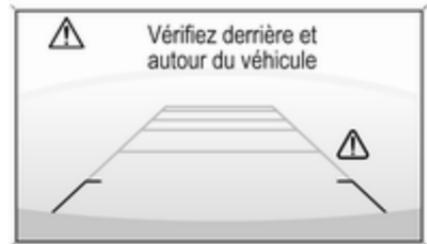
En raison de la position haute de la caméra, le pare-chocs peut être vu sur l'écran afin de mieux vous guider. La zone affichée par la caméra est limitée. La distance de l'image qui s'affiche sur l'écran est différente de la distance réelle.
