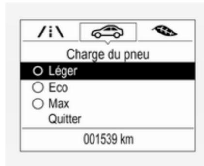
Sélectionner la page **Charge des pneus** sous la rubrique **Menu informations véhicule** ↪ dans le centre d'informations du conducteur ↪ 102.
