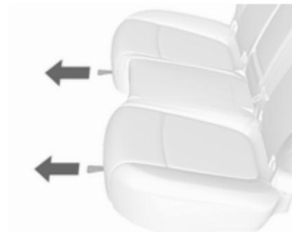
2. Tirer la boucle sous l'assise de siège et replier l'assise de siège.
