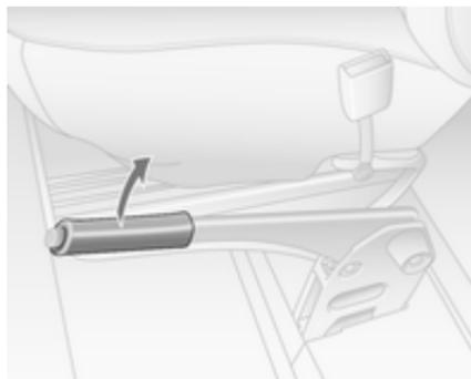
Serrer toujours le frein de stationnement sans actionner le bouton de déverrouillage. Dans une pente ou dans une côte, le serrer aussi fort que possible.
