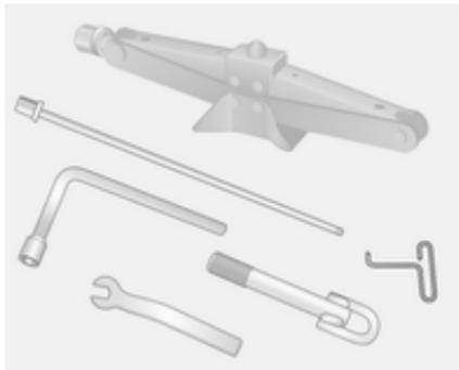
Le cric, la clé de roue, l'adaptateur, le crochet d'enjoliveur, la clé et l'œillet de remorquage sont contenus dans un ensemble rangé sous le siège du conducteur.
