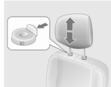
Enfoncer le loquet, régler la hauteur et l'encliqueter.
