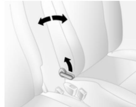
Tirer le levier, régler l'inclinaison et relâcher le levier. Laisser le siège s'encliquer.
