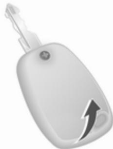
Enlever la vis et ouvrir le logement de pile en introduisant une pièce de monnaie dans la rainure et en la pivotant.
