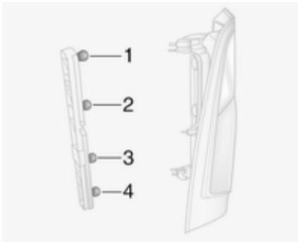
7. Pousser légèrement l'ampoule dans la douille, la tourner dans le sens antihoraire, l'enlever puis la remplacer par une neuve.
