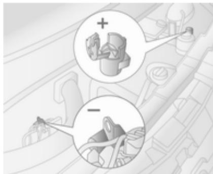
8. Brancher le câble rouge d'alimentation + du compresseur sur la borne de démarrage par câbles auxiliaires ↗ 123.
