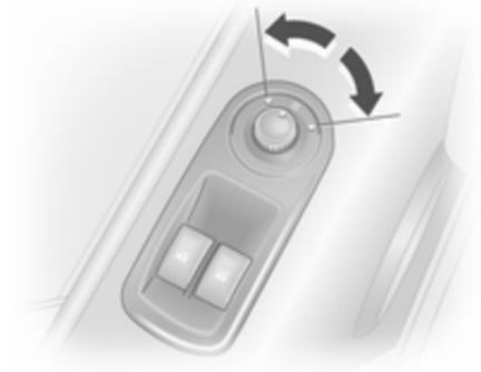
Sélectionner le rétroviseur extérieur concerné en tournant la commande vers la gauche ou la droite. Pivoter ensuite la commande pour régler le rétroviseur.
