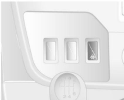
Quand le patinage des roues motrices est nécessaire, il est possible de désactiver l'antipatinage :
