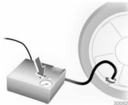
17. Reprendre la route sans délai afin que le produit d'étanchéité se répartisse uniformément dans le pneu. Après un trajet d'environ 10 km, mais pas plus de 10 minutes, s'arrêter et contrôler la pression du pneu à l'aide du compresseur. À cet effet, visser directement le flexible d'air sur la valve du pneu et le compresseur.
