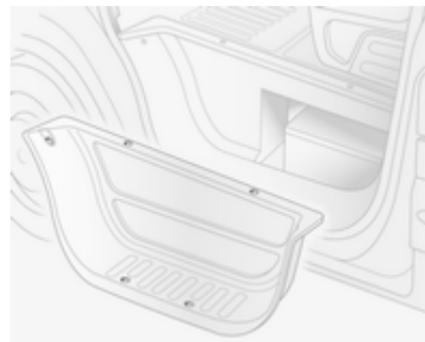
La batterie est située dans le bas du véhicule, derrière un panneau dans la marche de la porte avant gauche. Enlever le panneau pour accéder à la batterie.
