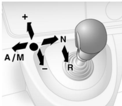
Toujours déplacer le levier sélecteur aussi loin que possible dans la direction adéquate. Quand il est relâché, il revient automatiquement en position centrale.
