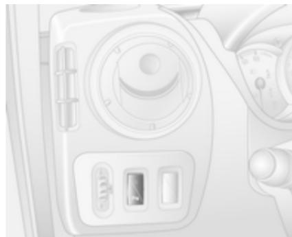
Désactiver le système en enfonçant et en maintenant le bouton **P** avec un triangle de danger du tableau de bord pendant environ 3 secondes, avec le contact mis et la marche arrière engagée. Le témoin dans le bouton s'allume en permanence.
