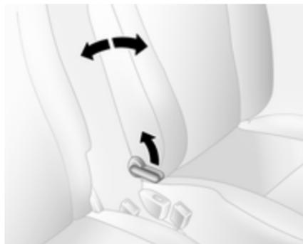
Tirer le levier, régler l'inclinaison et relâcher le levier. Laisser le siège s'encliqueter de manière audible.
