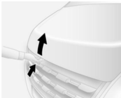
Tirer le verrou de sécurité et ouvrir le capot moteur.
