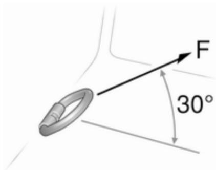
Les anneaux d'arrimage sont disposés dans le coffre pour maintenir le chargement en place en utilisant des sangles de serrage ou un filet à bagages.
