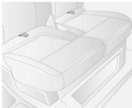
En utilisant les deux boucles de l'assise de siège du passager, tirer l'assise vers l'avant pour accéder au rangement situé sous le siège.
