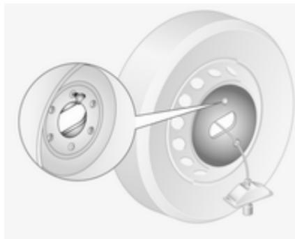
Lors de la remise en place d'une roue de secours, attacher la plaque de fixation et la bloquer avec l'écrou.
