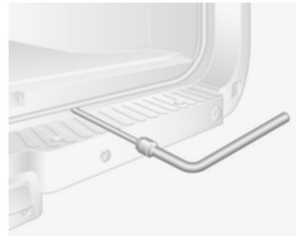
Pour libérer la roue de secours, desserrer le câble à l'aide de la clé de roue et de l'adaptateur et abaisser totalement la roue.
