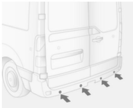
Le système se compose de quatre capteurs de stationnement logés dans le pare-chocs arrière.
