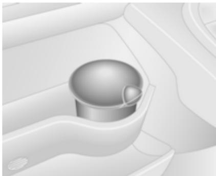
Boîtier de cendrier pour une utilisation portable dans le véhicule. Pour l'employer, ouvrir le couvercle.
