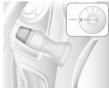
Commutateur d'éclairage placé sur **AUTO** : Lorsque le moteur tourne, les feux de croisement s'allument en fonction des conditions de luminosité extérieures.
