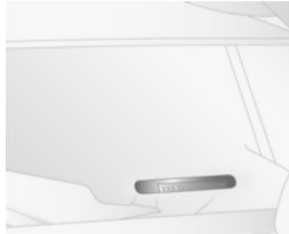
Le numéro d'identification du véhicule (NIV) est visible à travers le pare-brise.
