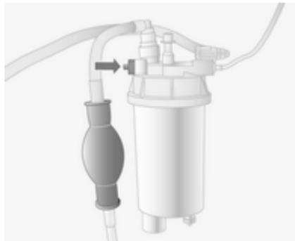
En cas de panne sèche, il sera nécessaire de purger l'air du circuit d'alimentation en gazole (diesel).
