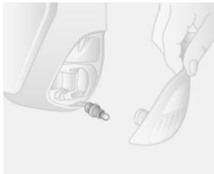
3. Enlever la douille d'ampoule depuis l'arrière de l'ensemble inférieur de rétroviseur.
