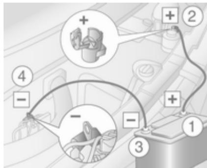
Séquence de raccordement des câbles :
