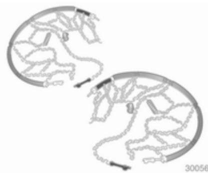
Les chaînes à neige ne sont autorisées que sur les roues motrices. Sur les véhicules avec roues arrière jumelées, des chaînes à neige sont uniquement autorisées sur les roues extérieures.
