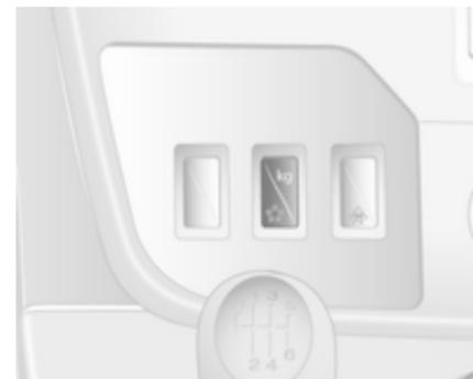
Il est possible d'utiliser le mode Chargé à la fois dans le mode manuel et dans le mode automatique. Dans les deux cas, les schémas de changement de rapport sont automatiquement adaptés pour le transport d'une charge utile accrue.
