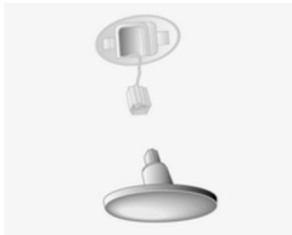
2. Débrancher le connecteur de l'ensemble de lampes.
