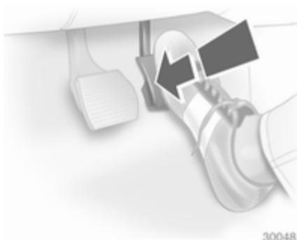
En enfonçant la pédale d'accélérateur au-delà du point de résistance, un rapport inférieur est sélectionné en fonction du régime moteur. La pleine puissance du moteur est disponible pour accélérer.
