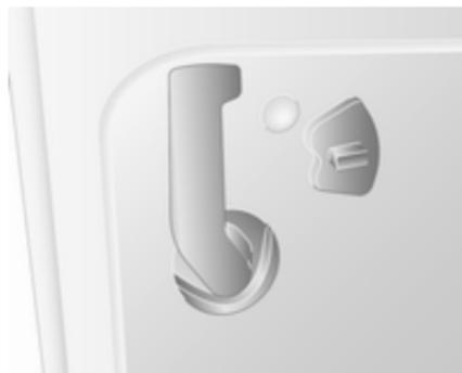
La porte peut être verrouillée depuis l'intérieur à l'aide du commutateur de verrouillage intérieur.
