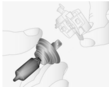
5. Séparer l'ampoule de sa douille et mettre une ampoule neuve.
