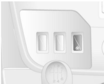
Quand le patinage des roues motrices est nécessaire, il est possible de désactiver l'ESP@Plus :
