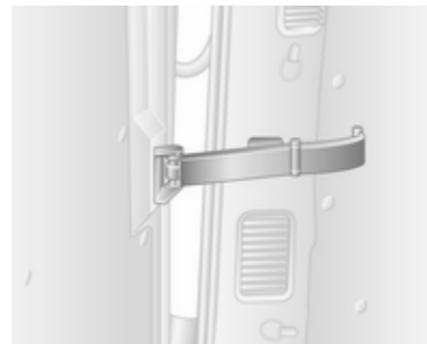
Pour ouvrir les portes à 180°, libérer les limiteurs d'ouverture des loquets dans les cadres de porte.
