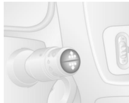
Les fonctions peuvent être sélectionnées en appuyant une ou plusieurs fois sur l'un des boutons à l'extrémité de la manette d'essuie-glace.
