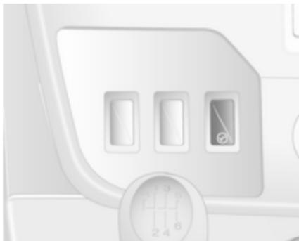
Pour augmenter le régime de ralenti, appuyer sur le commutateur. La fonction est activée après quelques secondes.
