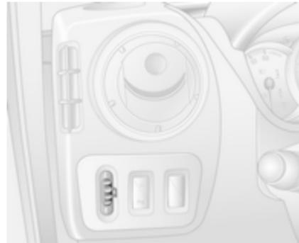
Pour adapter la portée des phares en fonction du chargement du véhicule : tourner le bouton rotatif dans la position désirée afin d'éviter l'éblouissement.
