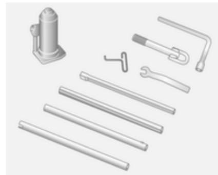
Véhicules avec transmission aux roues arrière : un cric hydraulique et un jeu de pièces d'extension à utiliser avec le cric sont également inclus.
