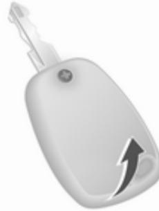
Enlever la vis et ouvrir le logement de pile en introduisant une pièce de monnaie dans la rainure et en la pivotant.
