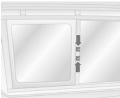
Appuyer sur le verrou et faire coulisser la vitre pour l'ouvrir. Vérifier que le verrou s'engage à la fermeture.
