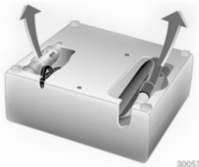
1. Sortir le compresseur du kit de réparation des pneus.
