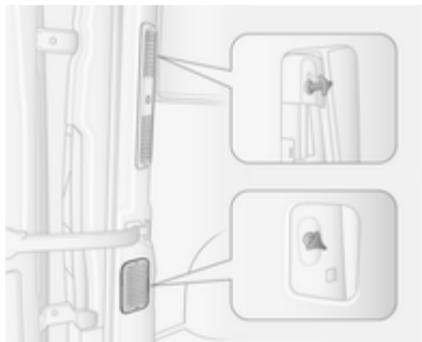
1. Enlever les panneaux de garnissage supérieur et inférieur du montant arrière.
