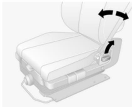
Tirer le levier, régler l'inclinaison et relâcher le levier. Laisser le siège s'encliquer.
