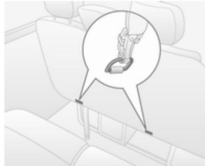
En plus de la fixation ISOFIX, attacher la sangle Top-Tether aux systèmes de sécurité Top-Tether. La sangle doit alors passer entre les deux tiges de guidage de l'appui-tête.
