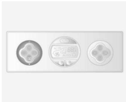
Le chauffage fonctionne quand le moteur tourne et est automatiquement arrêté au bout d'un certain temps.
