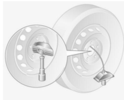
Placer la roue verticalement, enlever la broche du dispositif de retenue et libérer la roue du câble.
