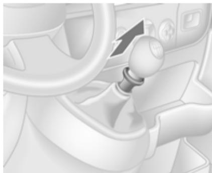
Marche arrière : lorsque le véhicule est à l'arrêt, enfoncer la pédale d'embrayage, puis soulever la bague du levier sélecteur et engager la marche arrière.
