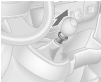
Pour passer la marche arrière, avec le véhicule à l'arrêt, enfoncer la pédale d'embrayage, soulever la bague du levier sélecteur puis engager le rapport.
