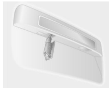
1. Déclipser la lentille à l'aide d'un tournevis à lame plate.
