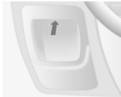
Située derrière le panneau de garnissage du tableau de bord, côté conducteur. Tirer sur la partie supérieure du panneau de garnissage pour l'enlever.
