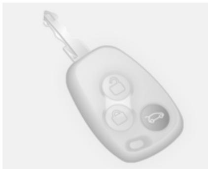
Grâce au verrouillage sélectif, l'habitacle et le coffre peuvent être verrouillés et déverrouillés indépendamment. Les portes avant restent verrouillées.
