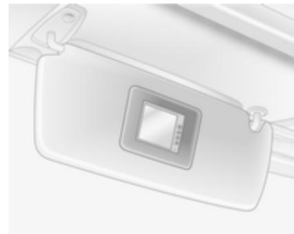
En principe, la caméra est installée sous la baguette de plaque d'immatriculation avec un écran monté sur le pare-soleil du conducteur.
