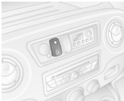
Serrer le frein de stationnement et appuyer sur le bouton du tableau de bord pour ouvrir automatiquement. Le témoin du tableau de bord s'allume.
