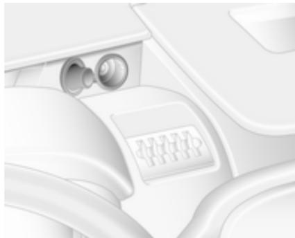
Des prises pour accessoires 12 V se trouvent sur le tableau de bord et à l'arrière du véhicule.
