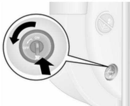
Le système d'airbag de passager avant peut être désactivé via un commutateur placé sur le côté du tableau de bord.
