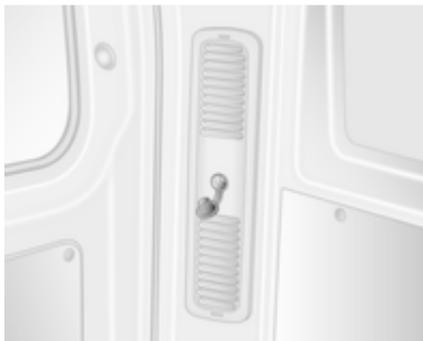
Si des accessoires électriques sont raccordés et que le moteur ne tourne pas, la batterie se décharge. La puissance maximale absorbée ne doit pas dépasser 120 watts. Ne pas y raccorder d'accessoires fournissant du courant, tels que chargeurs ou batteries.
