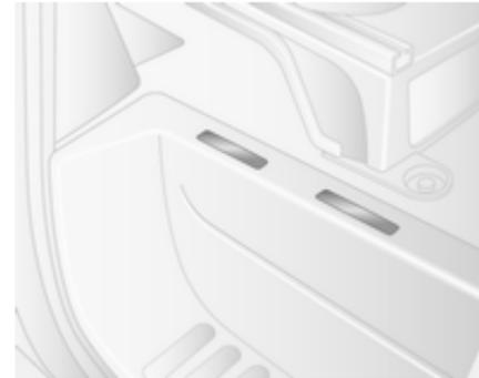
Le NIV peut également être lu derrière un cache en plastique amovible sur le seuil de porte droit. Déclipser les couvercles à l'aide d'un tournevis à lame plate pou y accéder.
