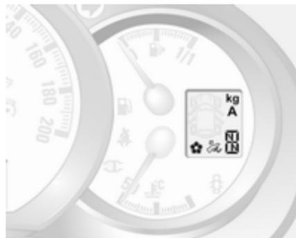
Le mode ou le rapport sélectionné de la boîte manuelle automatisée est indiqué sur l'affichage de la transmission.
