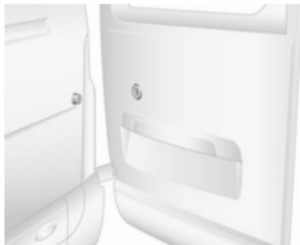
Lors de l'ouverture des portes à 270°, les portes sont maintenues en position totalement ouvertes grâce à des aimants situés sur le flanc de la carrosserie.
