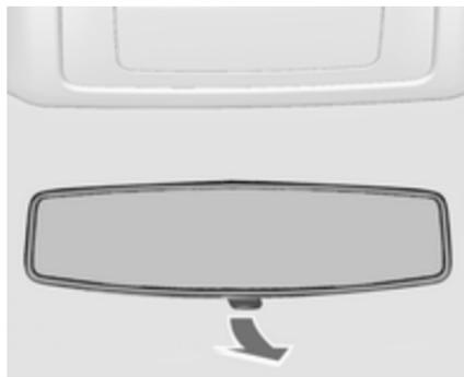
Pour réduire l'éblouissement, régler le levier sous le rétroviseur.
