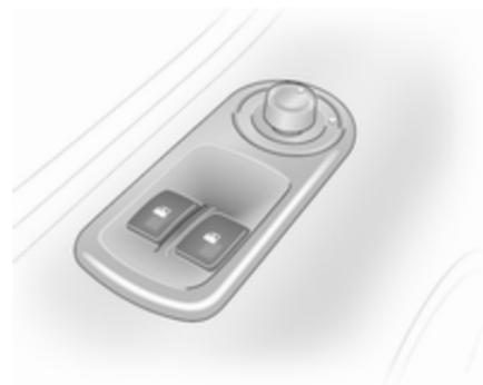
Manipuler le commutateur de la vitre respective en l'enfonçant pour ouvrir ou en le relevant pour fermer.
