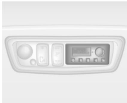
Si le moteur est coupé, l'arrière de l'habitacle peut être chauffé à l'aide du chauffage supplémentaire par l'intermédiaire des bouches d'aération inférieures. L'utilisateur peut programmer les valeur d'heure, de jour et de température à l'aide du tableau de commande.
