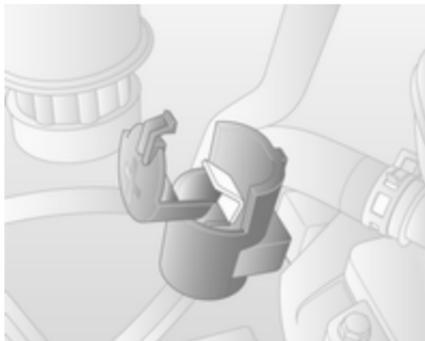
Si la batterie est déchargée, la borne de démarrage par câbles auxiliaires permet le démarrage du véhicule sans devoir accéder à la batterie à l'intérieur du véhicule.
