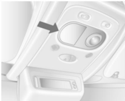
1. Enlever la lentille à l'aide d'un tournevis à lame plate.
