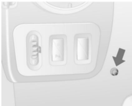
Outre la télécommande, le chauffage peut également s'activer pour une durée de 30 minutes, ou se désactiver, à l'aide de la touche du tableau de bord.
