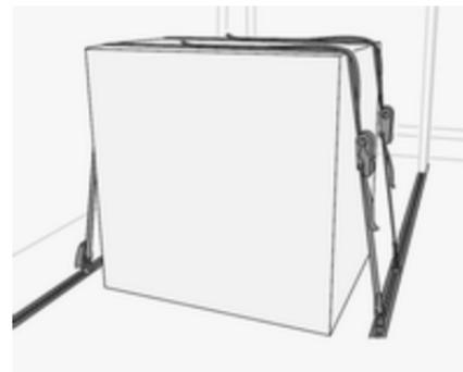
Utiliser les sangles à cliquet pour fixer l'objet aux anneaux d'arrimage amovibles dans le plancher du véhicule.
