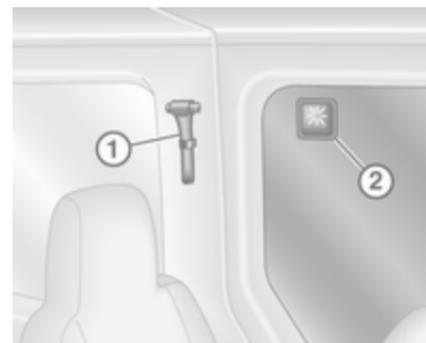
Pour sortir du véhicule en cas d'urgence, utiliser le marteau 1 pour briser la vitre 2.
