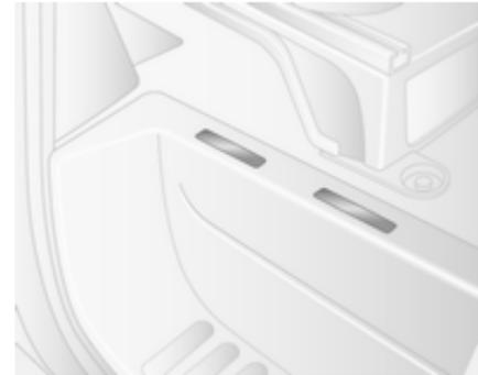
Le NIV peut également être lu derrière un cache en plastique amovible sur le seuil de porte avant droit. Déclipser les couvercles à l'aide d'un tournevis à lame plate pou y accéder.
