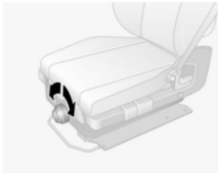
Pour ajuster le niveau de sensibilité du siège à suspension.
