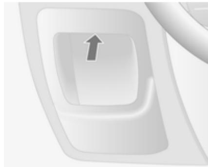
Située derrière le panneau de garnissage du tableau de bord, côté gauche. Tirer sur la partie supérieure du panneau de garnissage pour l'enlever.
