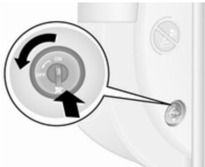
Avec la porte avant ouverte, enfoncer le commutateur et le tourner dans le sens antihoraire jusqu'en position **OFF**.
