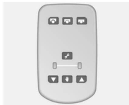
La télécommande permet de relever ou d'abaisser la suspension afin d'augmenter la garde au sol ou de faciliter l'accès dans le véhicule.
