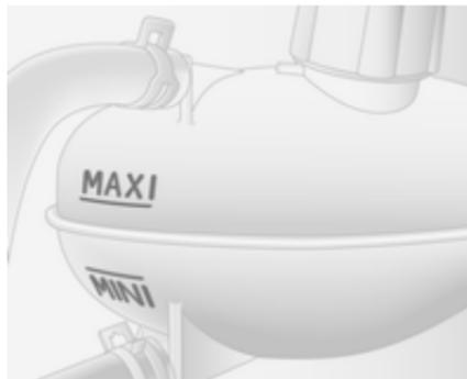
Si le système de refroidissement est froid, le niveau de liquide de refroidissement doit se trouver juste au-dessus du repère **MINI**. Faire l'appoint si le niveau est bas.
