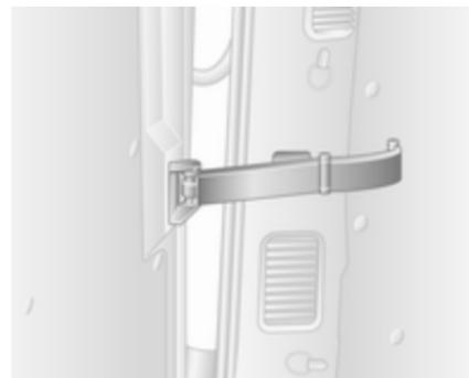
Pour ouvrir les portes à 180° ou plus, libérer les limiteurs d'ouverture des loquets dans les cadres de porte et ouvrir les portes à la position souhaitée.
