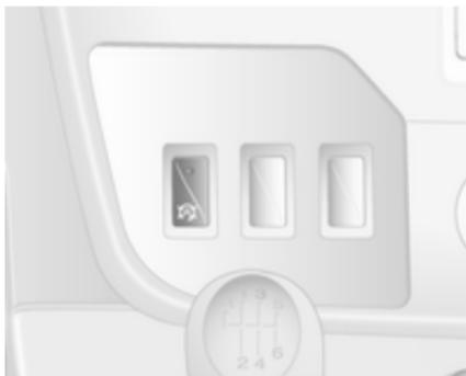
Désactiver le système d'arrêt-démarrage manuellement en appuyant sur le bouton
