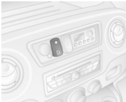
Avec le frein de stationnement serré, appuyer sur le commutateur du tableau de bord pour ouvrir automatiquement la porte latérale coulissante. Le témoin dans le commutateur clignote pendant la manoeuvre.
