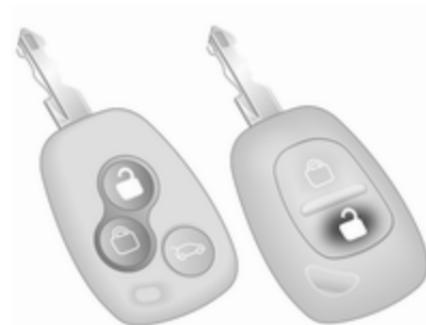
Appuyer sur le bouton
