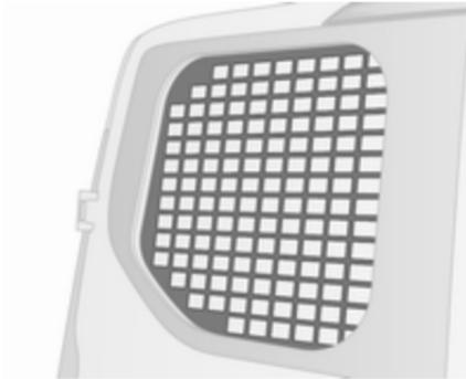
En fonction de la version, les vitres de la porte arrière et de la(des) porte(s) latérale(s) coulissante(s) contiennent également des protections de vitre pour renforcer la protection et la sécurité.
