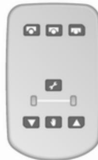
La télécommande permet de relever ou d'abaisser la suspension afin d'augmenter la garde au sol ou de faciliter l'accès dans le véhicule.
