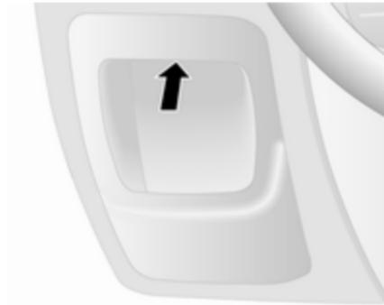
Située derrière le panneau de garnissage du tableau de bord, côté gauche. Tirer sur la partie supérieure du panneau de garnissage pour l'enlever.
