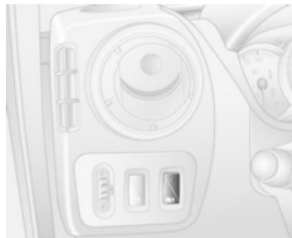
Si nécessaire, en cas de routes couvertes de boue ou de neige ou sur sol meuble, l'ESP®<sup>Plus</sup> peut être désactivé pour améliorer la traction : Appuyer sur
