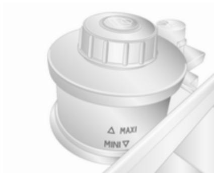
Si le niveau de liquide dans le réservoir descend sous le repère **MINI**, prendre contact avec un atelier.
