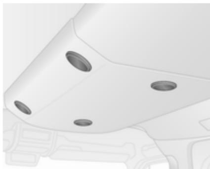
Les bouches d'aération réglables sont situées sur le cadre de toit. Pour ouvrir, appuyer sur la bouche d'aération. Maintenir la bouche d'aération et la tourner à la position souhaitée pour diriger l'air.
