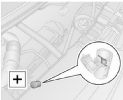
9. Brancher le câble rouge d'alimentation **+** du compresseur sur la borne de démarrage par câbles auxiliaires ↻ 227.
