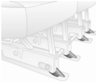
Positionner les guides de siège immédiatement derrière les points d'ancrage de plancher avant et faire coulisser vers l'avant pour l'engager.
