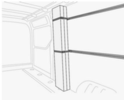
Le chargement maximal des longérons de charge latéraux est de 100 daN/700 mm.
