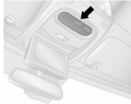
1. Enlever l'ensemble de lampes à l'aide d'un tournevis à lame plate.
