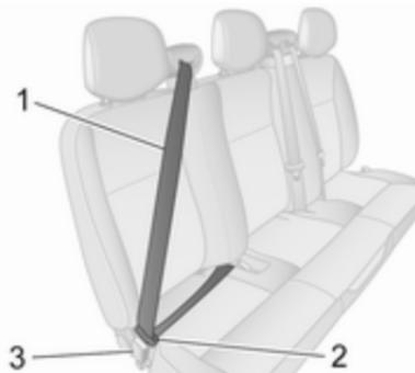
Pour déverrouiller, appuyer sur le bouton rouge de la boucle de ceinture de sécurité 3 pour relâcher la plaque de verrouillage 2.
