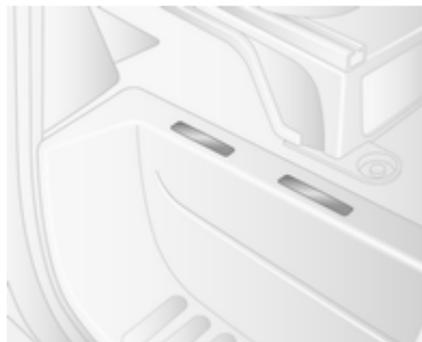
Le NIV peut également être lu derrière un cache en plastique amovible sur le seuil de porte avant droit. Déclipser les couvercles à l'aide d'un tournevis à lame plate pou y accéder.
