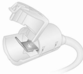
Si la batterie du véhicule est déchargée, la borne de démarrage par câbles auxiliaires permet le démarrage du véhicule sans devoir accéder à la batterie à l'intérieur du véhicule.
