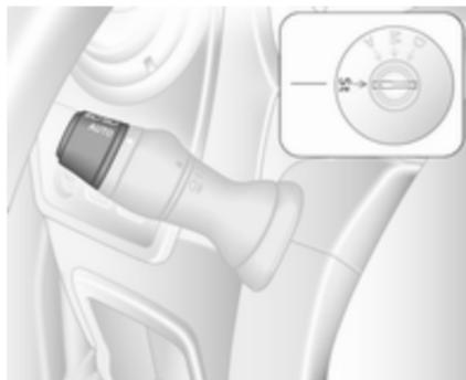
Quand la commande automatique des feux est activée et que le moteur tourne, le système bascule entre feux de jour (si montés) et phares selon les conditions d'éclairage.
