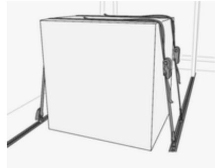
Le chargement maximal des longerons de charge de plancher est de 500 daN/700 mm.
