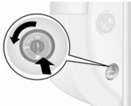
Contact coupé, ouvrir la porte avant, pousser le commutateur et le tourner dans le sens inverse des aiguilles d'une montre sur la position **OFF**.
