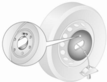
Lors de la remise en place d'une roue de secours, serrer d'abord la plaque de fixation (véhicules à roues arrière jumelées) et fixer à l'aide de l'écrou.
