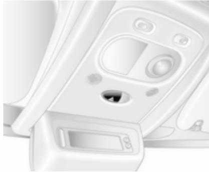
Pour les enclencher, appuyer sur
