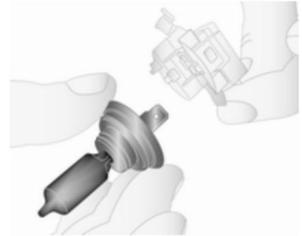
5. Séparer l'ampoule de sa douille et mettre une ampoule neuve.
