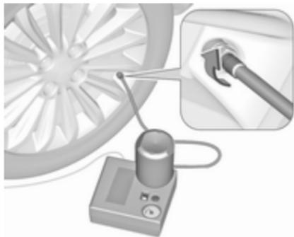
7. Visser le flexible de remplissage de produit d'étanchéité sur la valve du pneu.
