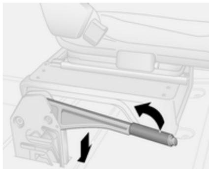
Selon le véhicule, le levier de frein de stationnement se rétracte en position horizontale, même lorsque le frein de stationnement est appliqué.
