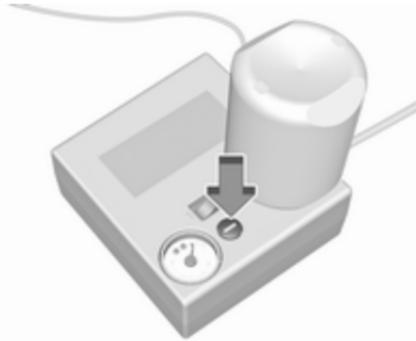
14. La pression des pneus prescrite devrait être atteinte dans les dix minutes. Pression des pneus ⇨ 262. Une fois la pression adéquate obtenue, arrêter le compresseur en plaçant le commutateur à bascule en position O.
