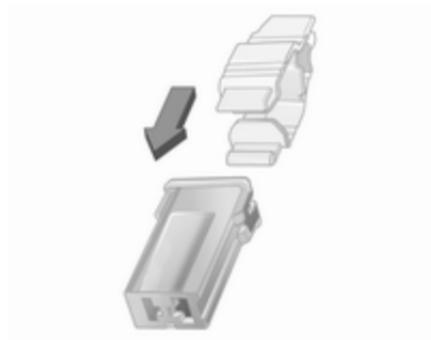
Pour faciliter le remplacement des fusibles, une pince à fusibles se trouve dans la boîte à fusibles du tableau de bord.
