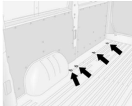
Les anneaux d'arrimage sont disposés dans le coffre pour maintenir le chargement en place en utilisant des sangles de serrage ou un filet à bagages.
