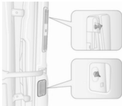
1. Enlever les panneaux de garnissage supérieur et inférieur du montant arrière.
