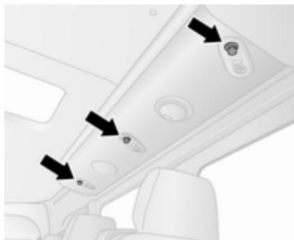
Les bouches d'aération réglables sont situées sur le cadre de toit au-dessus des sièges. Tourner le dispositif de réglage pour augmenter/diminuer l'air vers le siège concerné.
