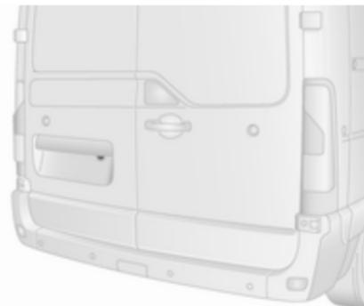
La caméra est normalement installée sur les portes arrière/hayon, sous la moulure de la plaque minéralogique.
