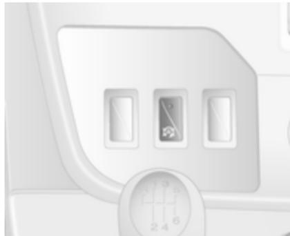
Pour désactiver manuellement le système d'arrêt-démarrage, appuyer sur
