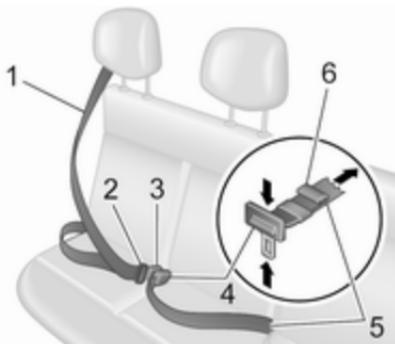
Retirer la sangle 1 de l'enrouleur, la guider non tordue à travers la carrosserie et vérifier si la plaque de verrouillage 2 est complètement engagée dans sa boucle 3 en tirant sur la plaque de verrouillage 2.
