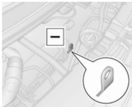
10. Raccorder le câble noir d'alimentation **-** à un point de masse du véhicule, par ex. le bloc moteur ou un boulon de fixation du moteur.
