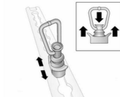
Les anneaux d'arrimage amovibles peuvent être assujettis sur le côté, au sol ou sur les longerons du toit. Se reporter au système flexible de compartimentage du coffre, plus loin pour plus d'information.
