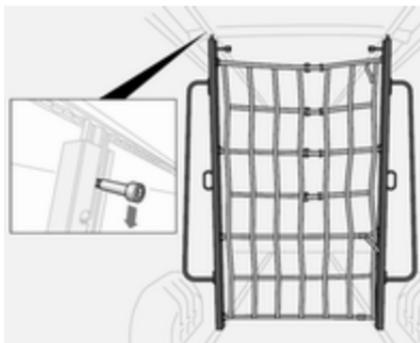
Pour la déplacer, abaisser le verrou afin de la déverrouiller et la positionner à l'endroit requis. Vérifier que le verrou s'engage entièrement et que la paroi est bien droite.
