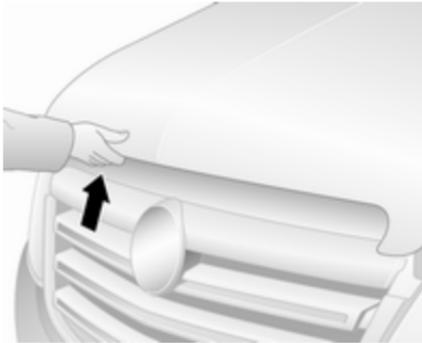
Tirer le verrou de sécurité, situé légèrement sur la gauche et ouvrir le capot moteur.
