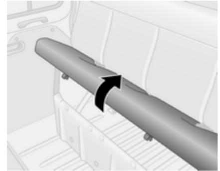
Soulever la base du siège à l'avant et le déposer pour accéder à l'espace de rangement sous le siège de banquette.
