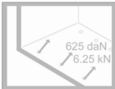
La force maximale appliquée sur les anneaux d'arrimage ne doit pas dépasser 625 daN/6,25 kN/6 250 N.
