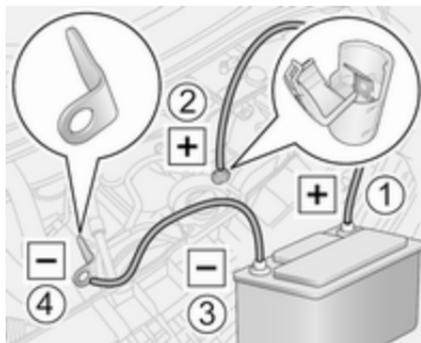
Séquence de raccordement des câbles :
