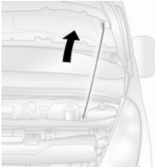
Sortir la barre de soutien de son support, puis la fixer au crochet de droite sous le capot moteur.
