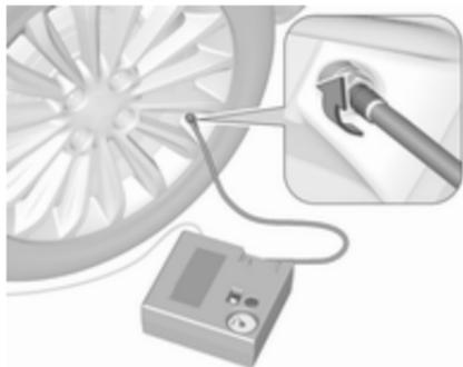
19. Reprendre la route sans délai afin que le produit d'étanchéité se répartisse uniformément dans le pneu. Après un trajet d'environ dix km, mais pas plus de dix minutes, s'arrêter et contrôler la pression du pneu à l'aide du compresseur. À cet effet, visser directement le flexible d'air sur la valve du pneu et le compresseur.
