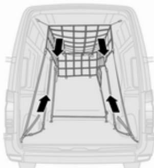
Abaisser le filet de sécurité du toit et la fixer aux anneaux d'arrimage dans le plancher du véhicule ⇨ 78.
