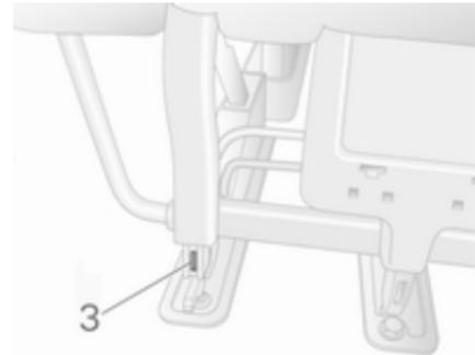
Le siège se verrouille automatiquement et les goupilles **3** disparaissent à la vue, indiquant que le siège est verrouillé.
