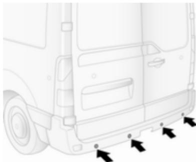
Le système se compose de quatre capteurs de stationnement à ultrasons disposés dans le pare-chocs arrière.
