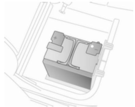
En fonction de l'équipement auxiliaire du véhicule, certains modèles peuvent disposer d'une batterie supplémentaire montée sous le siège avant droit.
