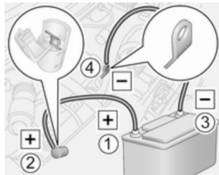
Selon le modèle, la borne de démarrage par câbles auxiliaires peut être placée du côté droit ou du côté gauche du compartiment moteur.
