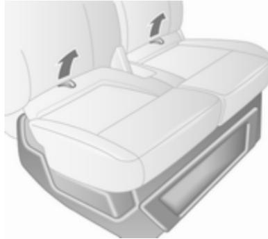
En utilisant les deux boucles de l'assise de siège du passager, tirer l'assise vers l'avant pour accéder au rangement situé sous le siège.
