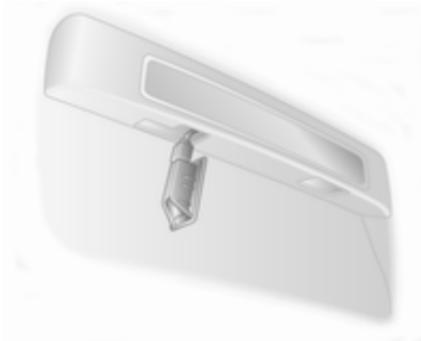
1. Détacher l'ensemble de lampes à l'aide d'un tournevis à lame plate.
