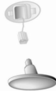
2. Débrancher le connecteur de l'ensemble de lampes.
