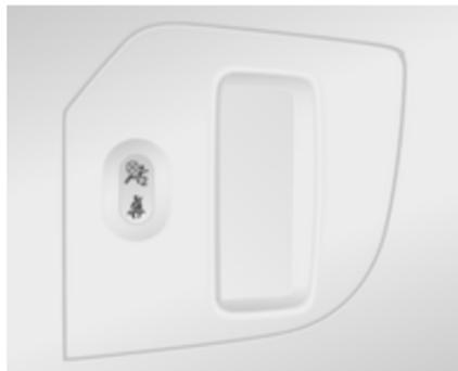
Les airbags du siège de passager avant sont désactivés et ne se déploieront pas en cas de collision. Le témoin
