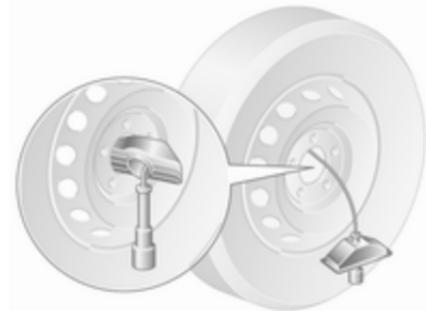
Placer la roue debout, déclipser le dispositif de maintien de la jante de roue et relâcher la roue du câble et du dispositif de maintien raccordé en faisant passer ces composants par le centre de la roue.
