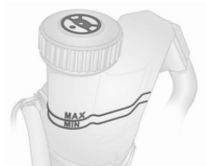
Si le niveau de liquide dans le réservoir descend sous le repère **MIN**, prendre contact avec un atelier.
