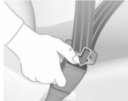
Pour détacher la ceinture, appuyer sur le bouton rouge de la boucle de ceinture. La ceinture de sécurité s'enroule automatiquement.
