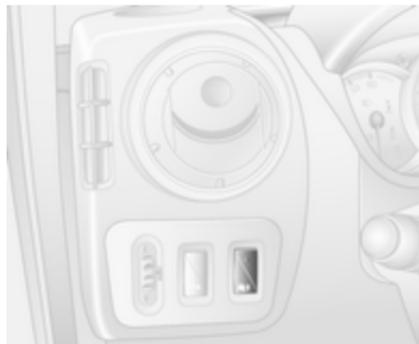
Si nécessaire, en cas de routes couvertes de boue ou de neige ou sur sol meuble, le système antipatinage (TC) peut être désactivé pour améliorer la traction :
