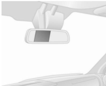
L'affichage de la caméra arrière est automatiquement activé lorsque la marche arrière est engagée. Jusqu'à ce qu'un signal sonore de confirmation retentisse.
