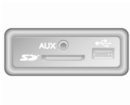
Dans l'unité d'Infotainment (ou sur le tableau de bord) se trouve une prise USB  $\Psi$  destinée au branchement de sources audio externes et de dispositifs de chargement.
