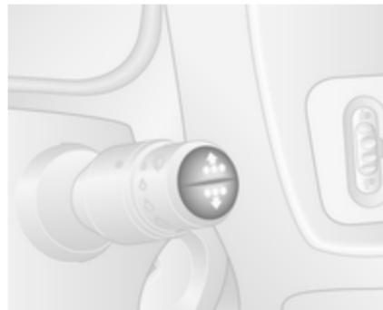
Afficher la fonction d'horloge en enfonçant à plusieurs reprises le bouton à l'extrémité de la manette d'essuie-glace. Lorsque l'heure clignote (après environ deux secondes) :
