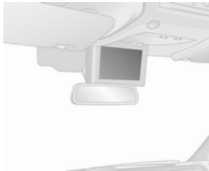
Sur les véhicules équipés d'un système de navigation, l'affichage de la caméra arrière est montré sur l'écran d'affichage de l'Infotainment System.
