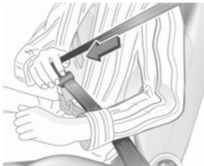
Tirer la ceinture hors de l'enrouleur, la guider sur le corps sans la vriller et insérer la plaque de verrouillage dans la boucle.
