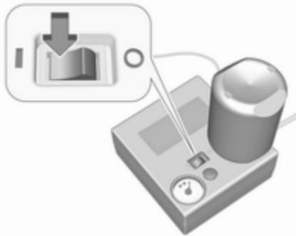
11. Placer le commutateur à bascule du compresseur en position I. Le pneu est rempli de produit d'étanchéité.
