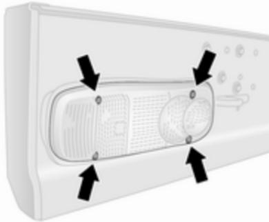
1. Déposer les quatre vis de la lentille.
