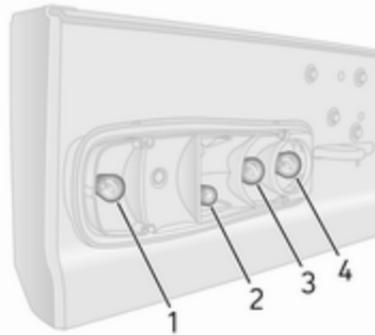
3. Pousser légèrement l'ampoule dans la douille, la tourner dans le sens antihoraire, l'enlever puis la remplacer par une neuve.
