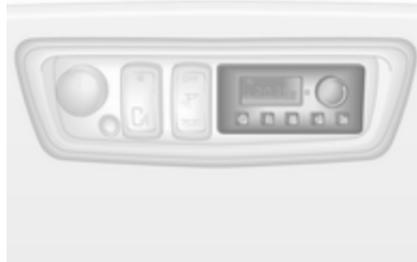
Si le moteur est coupé, l'arrière de l'habitacle peut être chauffé à l'aide du chauffage supplémentaire par l'intermédiaire des bouches d'aération inférieures.
