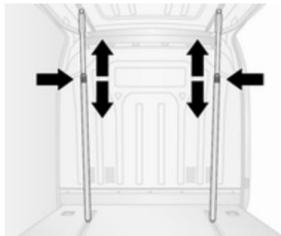
Les barres télescopiques de blocage peuvent être utilisées en position verticale, assujetties au plancher et aux longerons du toit
