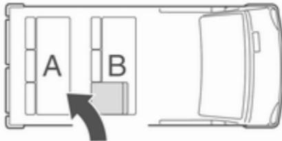
En reposant les sièges, toujours vérifier que la rangée avec le siège d'accès rabattable **B** est correctement positionnée devant la rangée de sièges fixes **A**.
