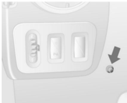
Selon la version, le chauffage auxiliaire peut également être commuté en position de marche pour la dernière durée ou la durée par défaut 30 minutes ou coupé immédiatement, en utilisant le bouton du tableau de bord. La diode du bouton confirme l'opération.
