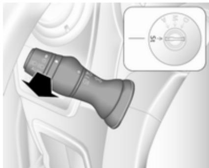
Les phares s'allument pendant 30 secondes environ après avoir stationné le véhicule et activé le système.
