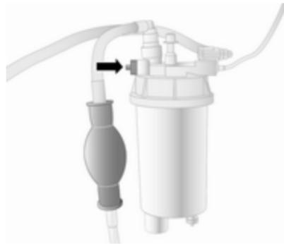
En cas de panne sèche, il sera nécessaire de purger l'air du circuit d'alimentation en gazole (diesel).
