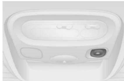
Le système d'avertissement de franchissement de ligne est activé en appuyant sur
