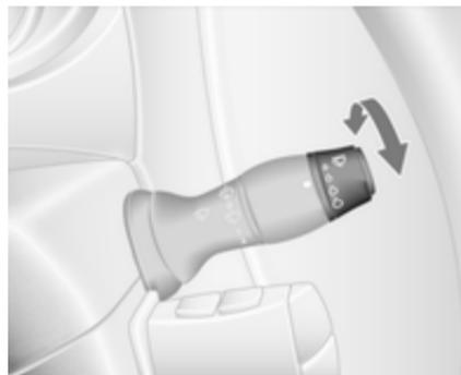
Faire tourner la molette de réglage pour régler le délai entre les balayages :
