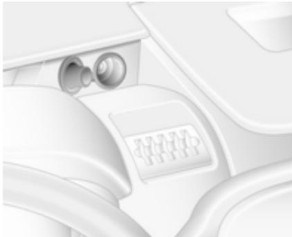
Des prises de courant 12 V se trouvent au sommet du tableau de bord ou à côté du levier de vitesses.
