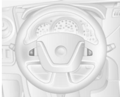
Le régulateur de vitesse et le limiteur de vitesse peuvent être réglés à l'aide des commandes au volant.
