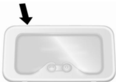
1. Enlever l'ensemble de lampes à l'aide d'un tournevis à lame plate.
