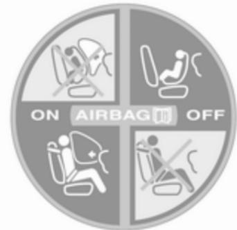
Le système d'airbag de passager avant peut être désactivé via un commutateur placé sur le côté du tableau de bord.
