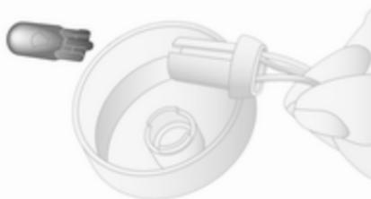
5. Séparer l'ampoule de sa douille et mettre une ampoule neuve.
