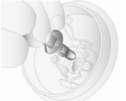
3. Relâcher l'agrafe à ressort et extraire la douille d'ampoule du boîtier du réflecteur.
