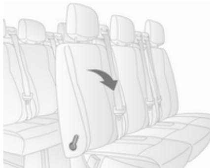
Pour faciliter l'accès aux sièges de la 3ème rangée (s'ils sont présents), ouvrir la porte latérale coulissante et tirer le levier de déverrouillage du siège d'accès rabattable de la 2ème rangée et rabattre le dossier du siège vers l'avant. Si nécessaire, détacher les ceintures de sécurité de leurs boucles.
