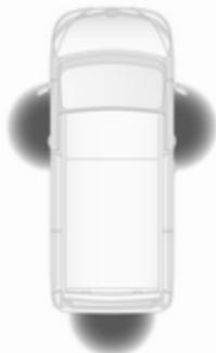
En mode mains-libres, la clé électronique doit se trouver à l'extérieur du véhicule, à une distance d'environ 1 m des portes avant ou du compartiment de chargement.
