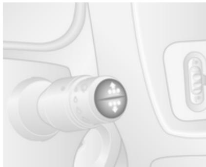
Selon le véhicule, les fonctions suivantes peuvent être sélectionnées en appuyant plusieurs fois sur l'extrémité de la manette d'essuie-glace :
