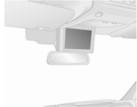
Sur les véhicules équipés d'un système de navigation, l'affichage de la caméra arrière est montré sur l'écran d'affichage de l'écran d'affichage d'informations.
