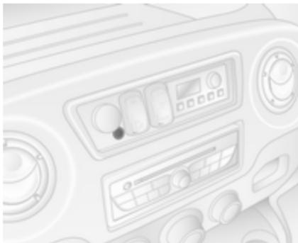
Le témoin s'allume pendant le fonctionnement de la marche latérale électrique. S'il reste allumé avec la porte fermée, la marche n'est pas rétractée ou la porte n'a pas été complètement verrouillée.
