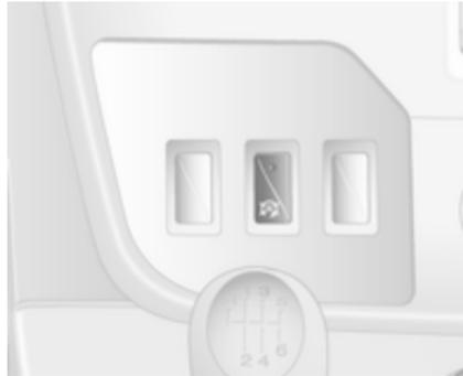
Pour désactiver manuellement le système d'arrêt-démarrage, appuyer sur
