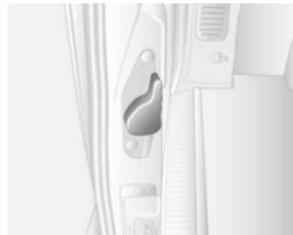
La porte arrière gauche est également déverrouillée en utilisant le levier du bord intérieur de la porte.
