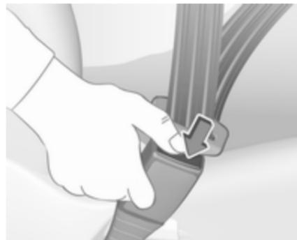
Pour détacher la ceinture, appuyer sur le bouton rouge de la boucle de ceinture. La ceinture de sécurité s'enroule automatiquement.
