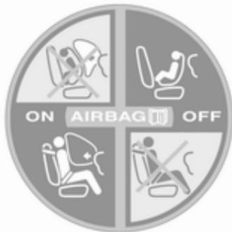
Le système d'airbag de passager avant peut être désactivé via un commutateur placé sur le côté du tableau de bord.
