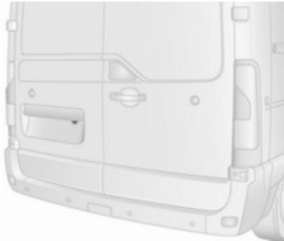
La caméra est normalement installée sur les portes arrière, sous la moulure de la plaque minéralogique.
