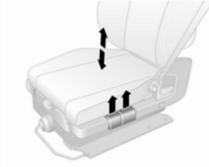
Tirer la manette de déverrouillage avant pour régler la hauteur de la partie avant du siège.
