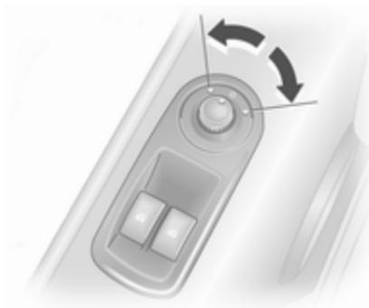
Mettre le contact pour opérer les rétroviseurs extérieurs.
