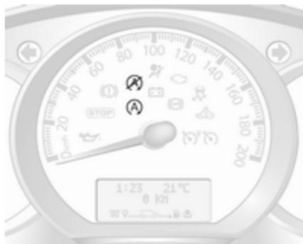
Un arrêt automatique est indiqué lorsque **A** s'allume en vert sur le combiné d'instruments ⇨ 109.
