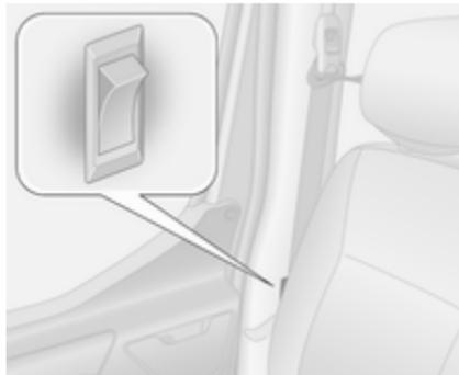
L'interrupteur général se trouve sur la partie inférieure du pied de porte du côté droit, derrière un panneau de garniture.
