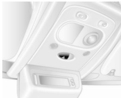
Pour les enclencher, appuyer sur
