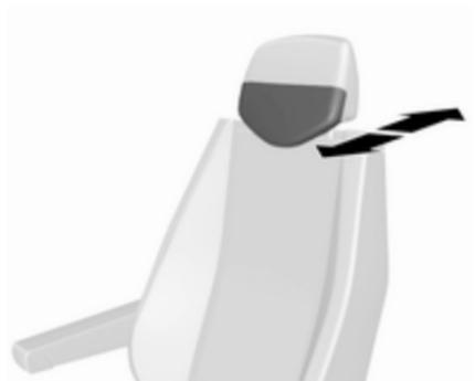
En fonction de la version, les appuis-tête peuvent également être inclinés vers l'avant ou vers l'arrière. Pousser ou tirer la partie inférieure de l'appui-tête pour l'ajuster.
