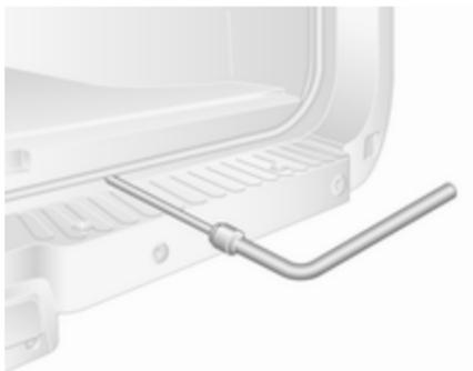
Serrer ensuite le câble à l'aide de la clé de roue et des adaptateurs en l'insérant dans la fente illustrée ci-dessus et en tournant la clé en sens antihoraire jusqu'à ce que la roue soit totalement relevée et fixée.
