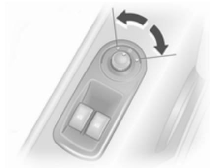
Sélectionner le rétroviseur extérieur concerné et le régler en faisant pivoter la commande.
