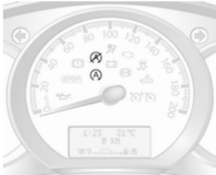
Un arrêt automatique est indiqué lorsque le témoin (A) s'allume en vert sur le combiné d'instruments.
