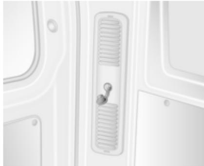
En fonction du véhicule, une prise supplémentaire peut se trouver à l'arrière du véhicule.
