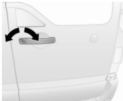
Pour déverrouiller manuellement les portes arrière, faire tourner la clé dans la serrure de la porte arrière droite. Ouvrir la porte en tirant la poignée.
