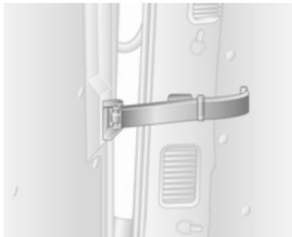
Pour ouvrir les portes à 180° ou plus (en fonction du modèle), libérer les limiteurs d'ouverture des loquets dans les cadres de porte et ouvrir les portes à la position souhaitée.
