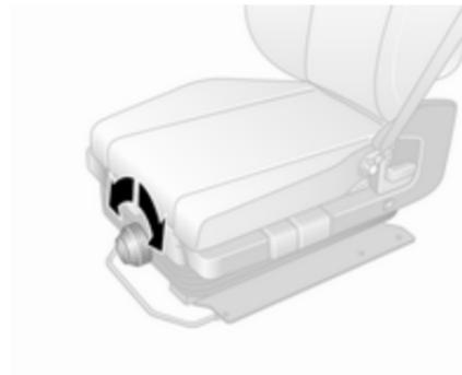
Pour ajuster le niveau de sensibilité du siège à suspension.
