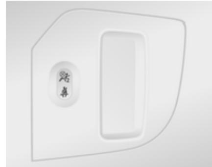
Les airbags du siège de passager avant sont désactivés et ne se déploieront pas en cas de collision. Le témoin
