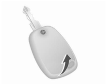
Enlever la vis et ouvrir le logement de pile en introduisant une pièce de monnaie dans la rainure et en la pivotant.
