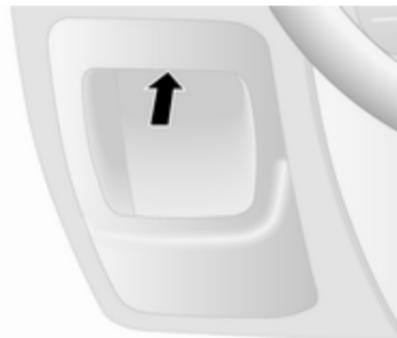
Située derrière le panneau de garnissage du tableau de bord, côté gauche. Tirer sur la partie supérieure du panneau de garnissage pour l'enlever.
