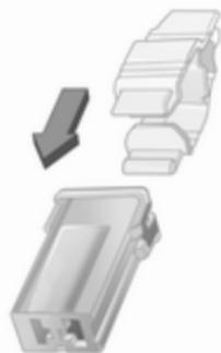
Pour faciliter le remplacement des fusibles, une pince à fusibles se trouve dans la boîte à fusibles du tableau de bord.
