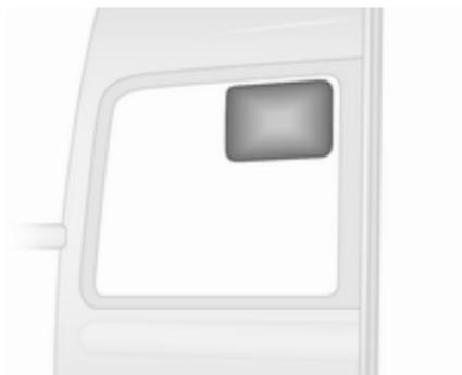
Une lentille de recul peut être placée sur la lunette arrière.
