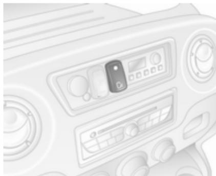
Le véhicule étant arrêté et le frein de stationnement serré, appuyer sur le commutateur du tableau de bord pour ouvrir automatiquement la porte coulissante électrique. La diode du commutateur clignote pendant le fonctionnement.
